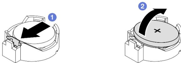
Figura 57. Remoção de uma bateria CMOS
