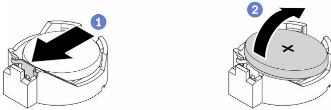
Figura 38. Extracción de la batería CMOS
