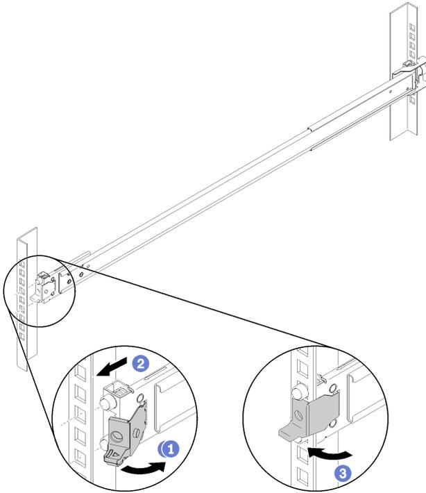
**Nota:** Cuando instale el riel en el bastidor vertical, utilice el riel izquierdo como riel superior y el riel derecho como riel inferior. Los métodos de instalación son los mismos en los dos bastidores.
