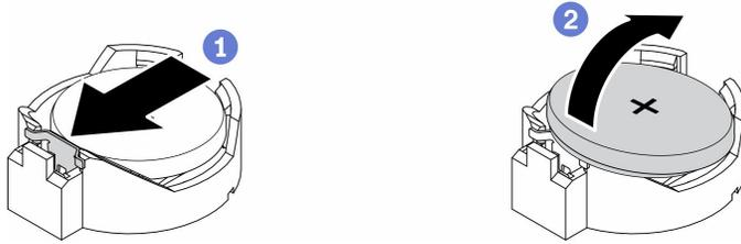
Figure 38. Retrait de la pile CMOS
