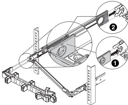
**5.** Placez le bras de routage des câbles sur la barre de support et fermez le support d'arrêt.
