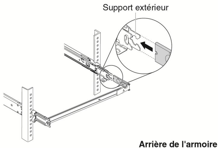
**4.** Raccordez les supports de montage du bras de routage des câbles à la glissière.
