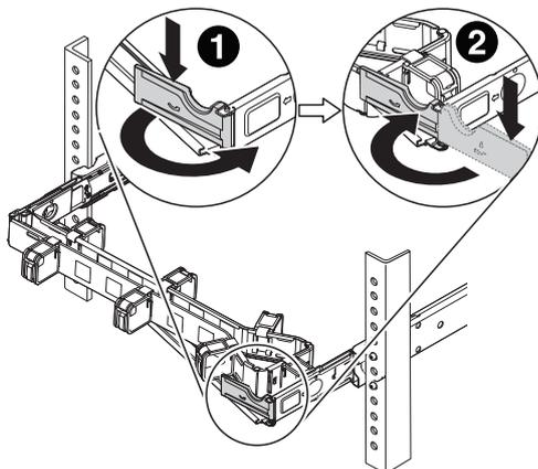
**6.** Branchez les cordons d'alimentation et autres câbles à l'arrière du serveur. Ouvrez les supports de câbles sur le bras de routage des câbles, acheminez les câbles et fermez les supports de câbles.
