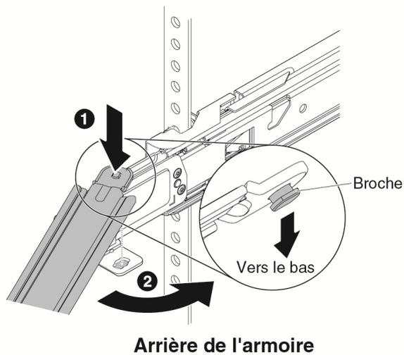
**3.** Raccordez le support de montage sur la barre de support au support de montage externe à l'arrière de la glissière.
