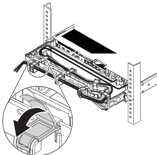
**7.** Utilisez les sangles pour câbles fournies pour fixer les câbles. Les câbles doivent être regroupés à l'aide d'une sangle afin de permettre un déplacement correct.
