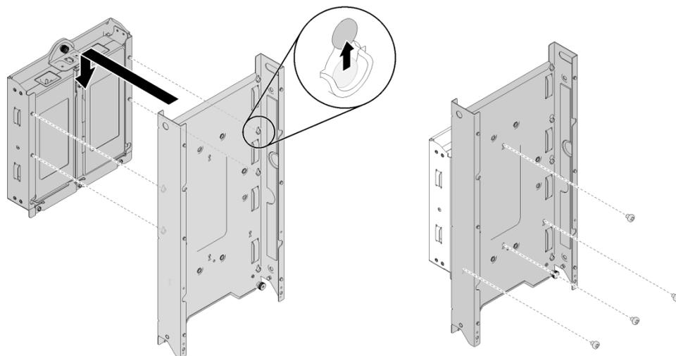
2. Fissare i due fermi della guida DIN sulle guide in posizione inclinata.
