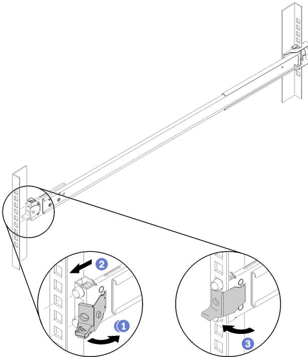
**Nota:** Quando si installa la guida sul rack verticale, utilizzare la guida sinistra come guida superiore e la guida destra come guida inferiore. I metodi di installazione sono identici per entrambi i rack.
