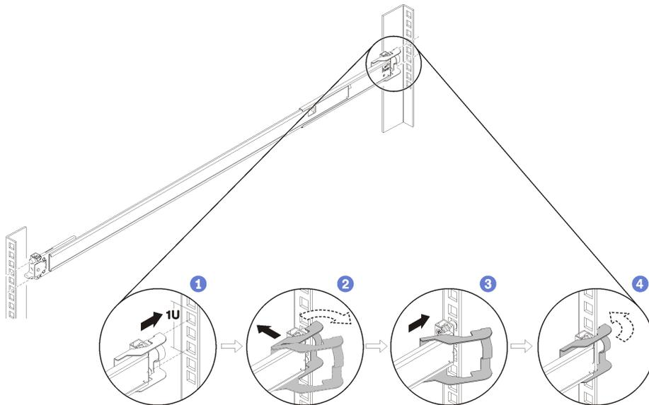
**Nota:** Quando si installa la guida sul rack verticale, utilizzare la guida sinistra come guida superiore e la guida destra come guida inferiore. I metodi di installazione sono identici per entrambi i rack.
