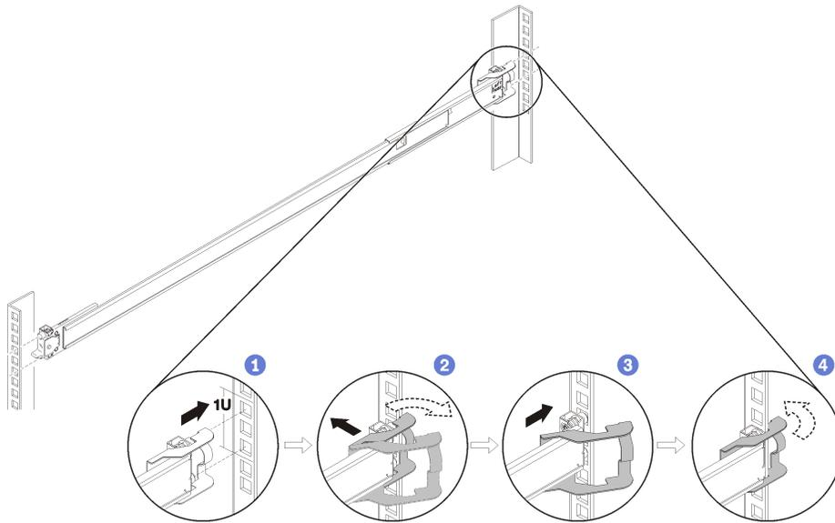
**Примечание:** При установке направляющей в стойку с вертикальной установкой оборудования используйте левую направляющую в качестве верхней, а правую — в качестве нижней. Способы установки в обеих стойках одинаковы.
