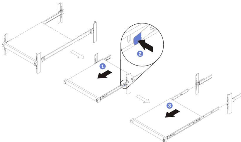
**Примечание:** Для снятия системы со стойки с вертикальной установкой оборудования выполните те же действия.
