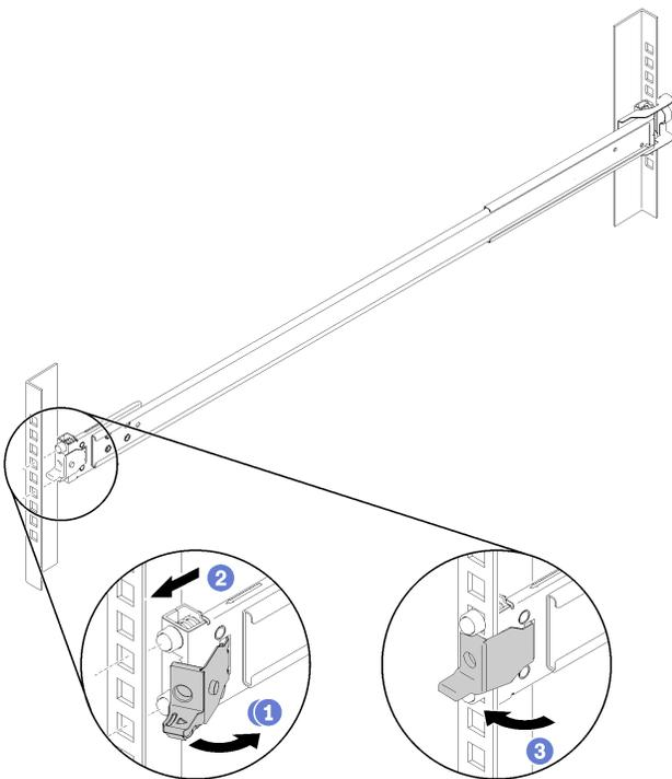
**Примечание:** При установке направляющей в стойку с вертикальной установкой оборудования используйте левую направляющую в качестве верхней, а правую — в качестве нижней. Способы установки в обеих стойках одинаковы.
