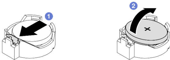
Figura 119. Extracción de la batería CMOS
