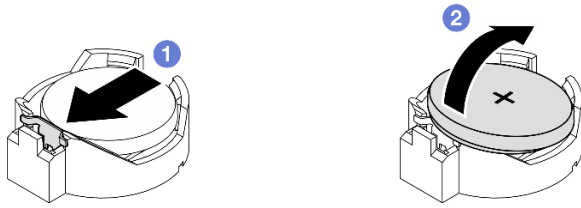
Figura 118. Extracción de la batería CMOS
