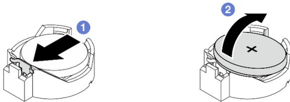
Figura 139. Extracción de la batería CMOS
