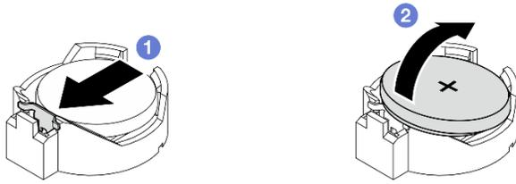
Figura 138. Extracción de la batería CMOS
