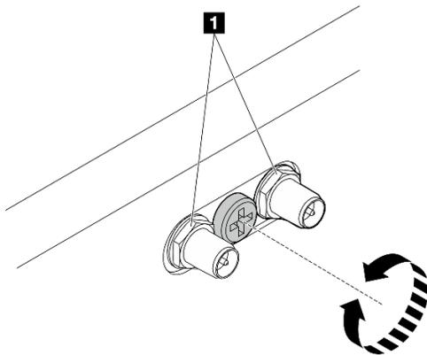
Figure 19. Raccourcissement des connecteurs SMA
