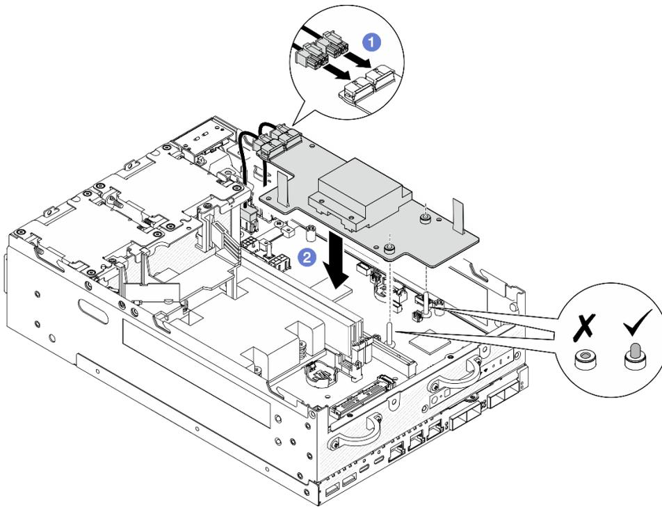
Figure 212. Installation de la carte de module d'alimentation
