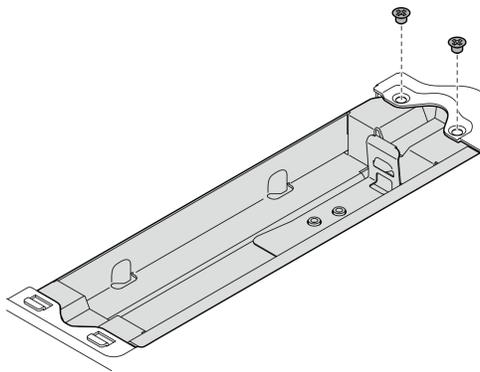
Figure 232. Retrait de l'boîtier du module de géolocalisation
