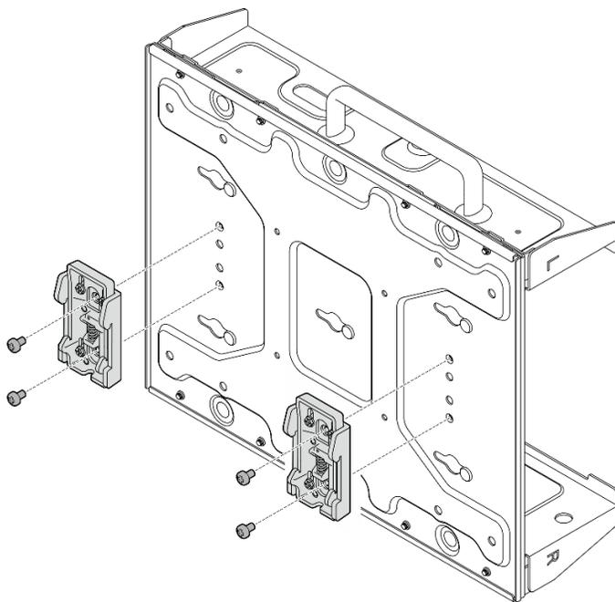
Figure 53. Retrait des clips de la glissière DIN
