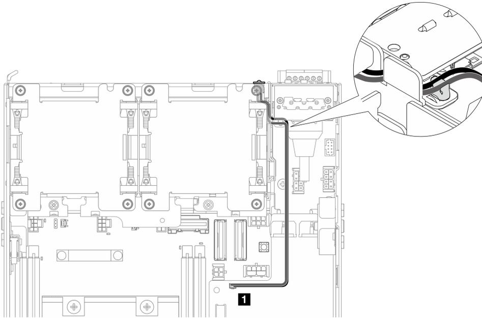
Figure 208. Câble de la LED de la PMB
