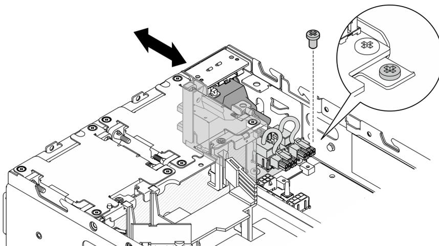
Figure 204. Installation du module PIB
