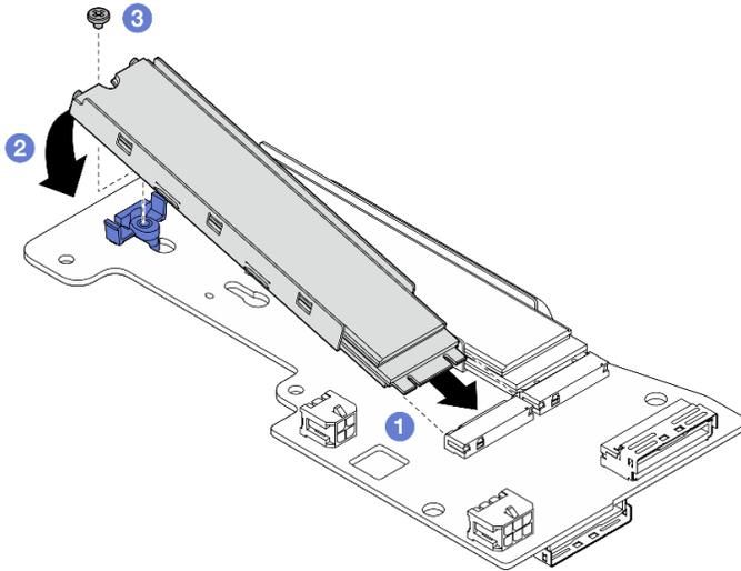
Figure 116. Installation d'une unité M.2
