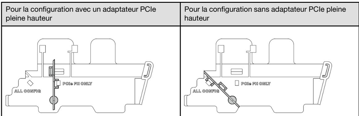
Etape 4. Alignez l'avant de l'assemblage de carte mezzanine avec le bord du châssis ; ensuite, abaissez l'assemblage de carte mezzanine sur le nœud.
