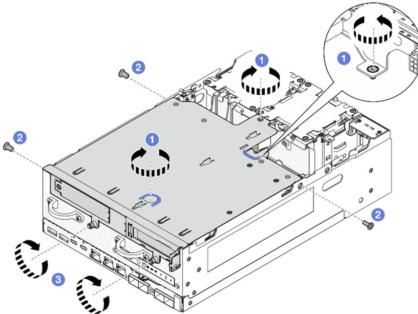
Figure 265. Fixer l'assemblage de carte mezzanine
