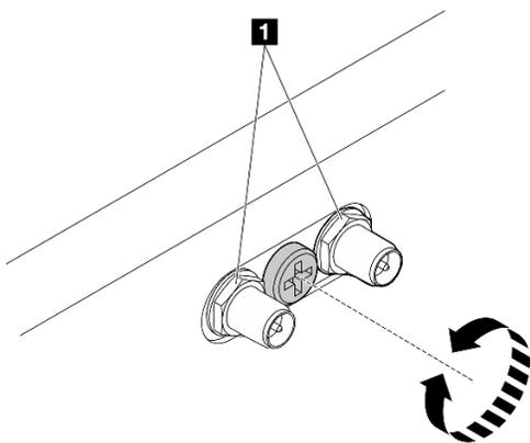
Figure 30. Raccourcissement des connecteurs SMA
