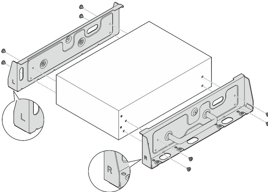
Figure 40. Installation des supports latéraux avec des vis
