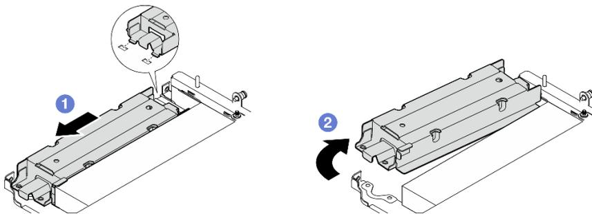
Figure 233. Retrait de l'boîtier du module de géolocalisation
