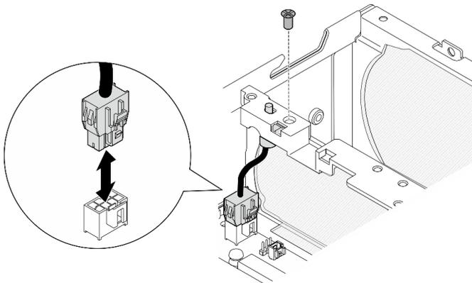
Figure 122. Retrait du commutateur d'orientation du ventilateur
