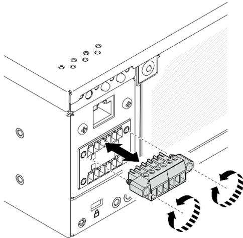
Figure 339. Installation de l'embase
