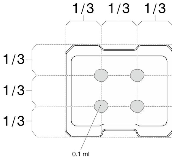
Figure 218. Forme correcte de la pâte thermoconductrice
