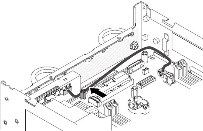
Figure 341. Cheminement des câbles du panneau opérateur avant
