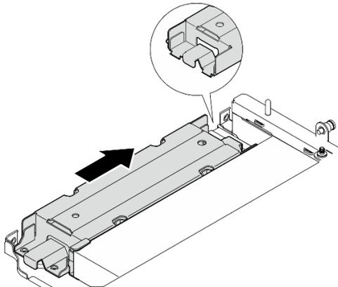
Figure 257. Installation du boîtier du module de géolocalisation
