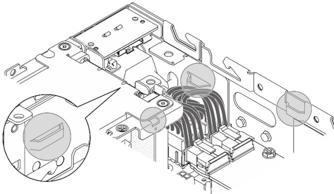
Figure 213. Les emplacements pour la grille d'aération PMB
