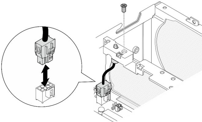
Figure 125. Installation du commutateur de direction du ventilateur
