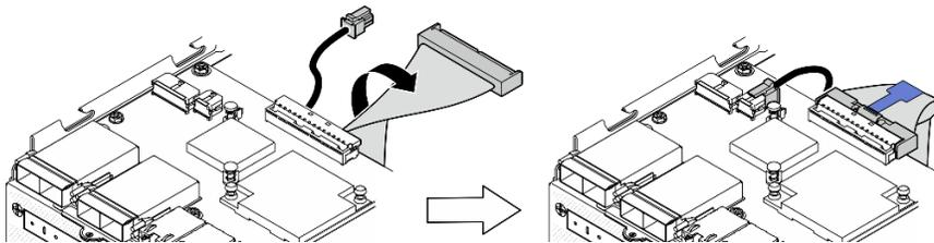
Figure 161. Connexion des câbles de la carte d'E/S
