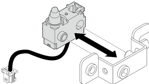
Figure 145. Insertion du commutateur d'intrusion dans le support
