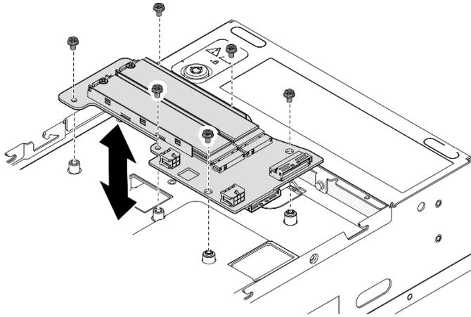
Figure 113. Retrait de l'adaptateur câblé M.2 inférieur
