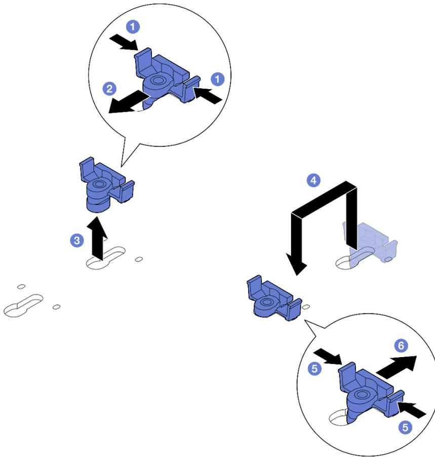
Figure 114. Ajustez le crochet de retenue M.2
