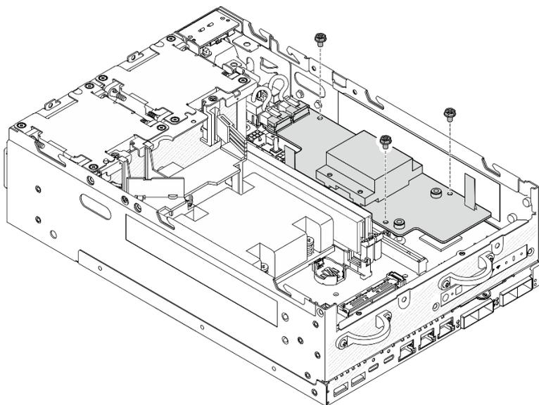
Figure 214. Fixation de la carte de module d'alimentation
