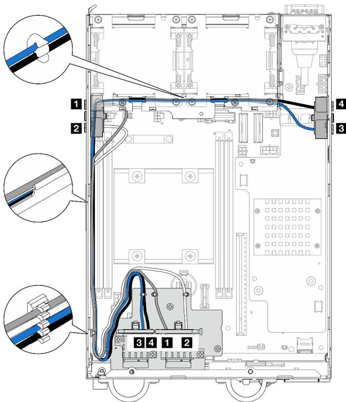
Figure 342. Cheminement du câble d'antenne WLAN
