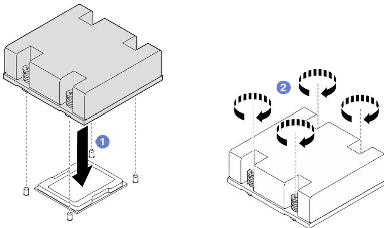
Figure 219. Installation du dissipateur thermique de processeur
