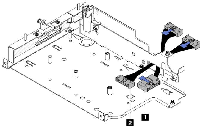
Figure 247. Câble de signal de l'adaptateur câblé M.2
