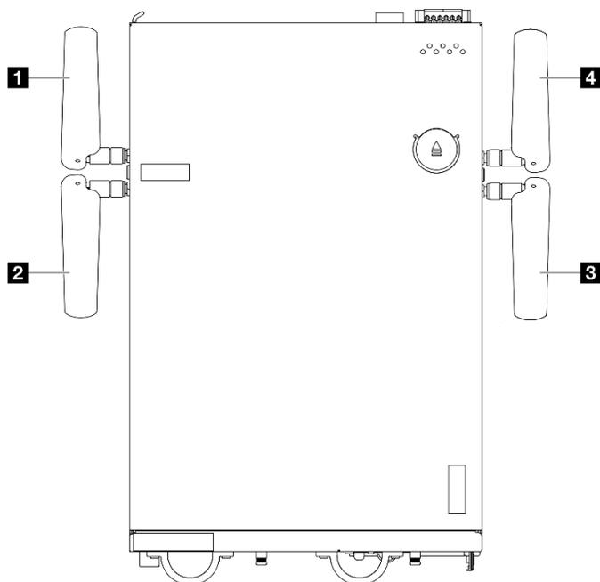
Figure 352. Emplacements des antennes WLAN
