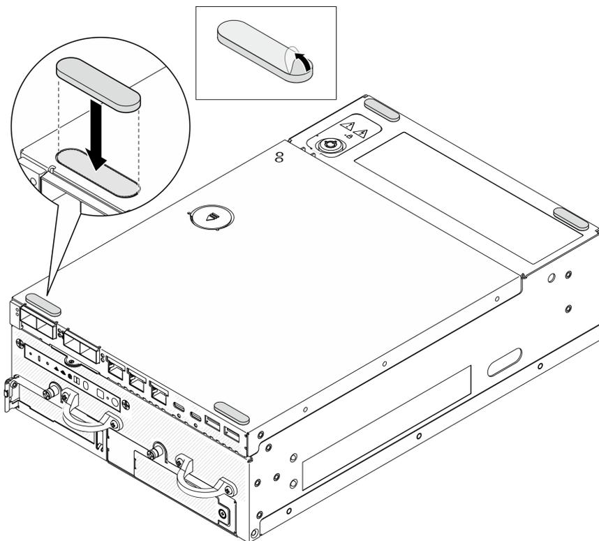
Figure 271. Installation des pieds en caoutchouc
