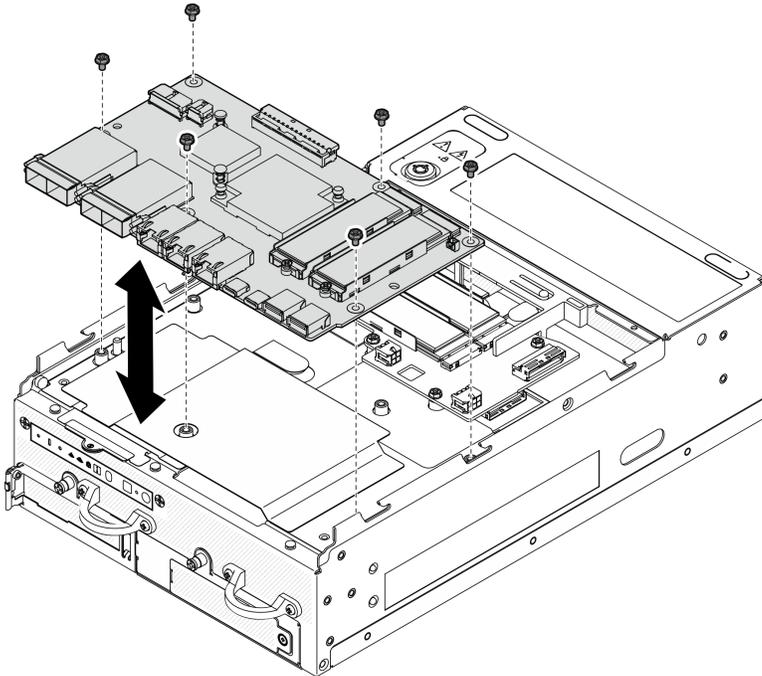
Figure 160. Installation de la carte de module d'E/S
