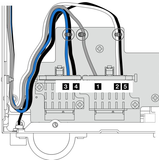
Figure 334. Cheminement des câbles pour l'adaptateur sans fil
