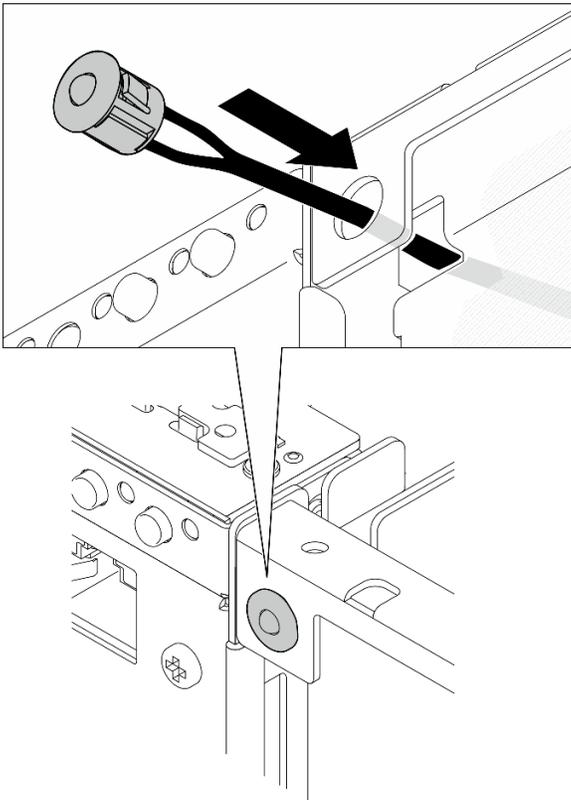
Figure 199. Installation du câble du voyant d'état PMB
