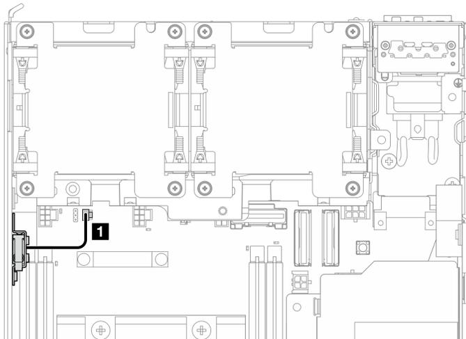
Figure 147. Cheminement des câbles du commutateur d'intrusion supérieur
