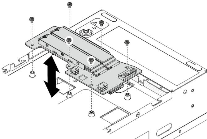
Figure 115. Installation de l'adaptateur câblé M.2 inférieur
