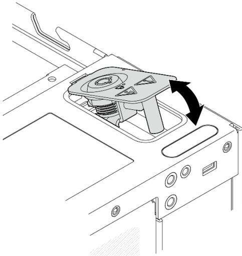
Figure 166. Retrait du verrou de sécurité du système
