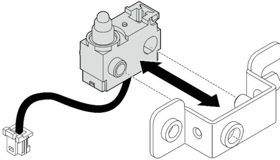
Figure 151. Insertion du commutateur d'intrusion dans le support
