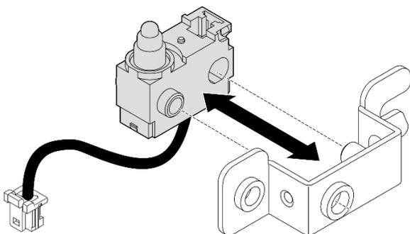
Figure 150. Séparation du commutateur d'intrusion du support
