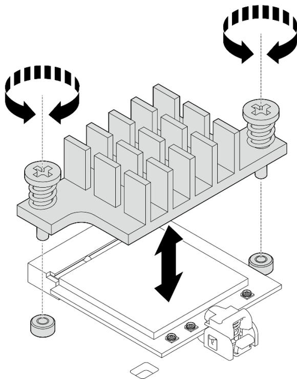
Figure 289. Installation du dissipateur thermique du module WLAN/Bluetooth
