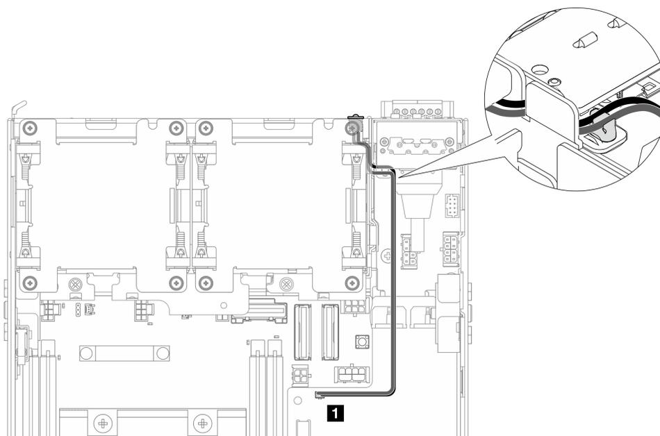
Figure 215. Câble de la LED de la PMB
