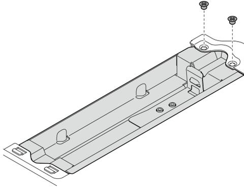
Figure 258. Installation du boîtier du module de géolocalisation
