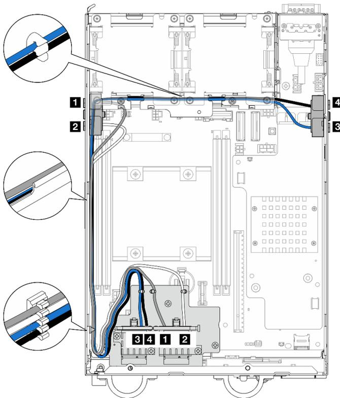
Figure 327. Cheminement de câble pour les assemblages SMA
