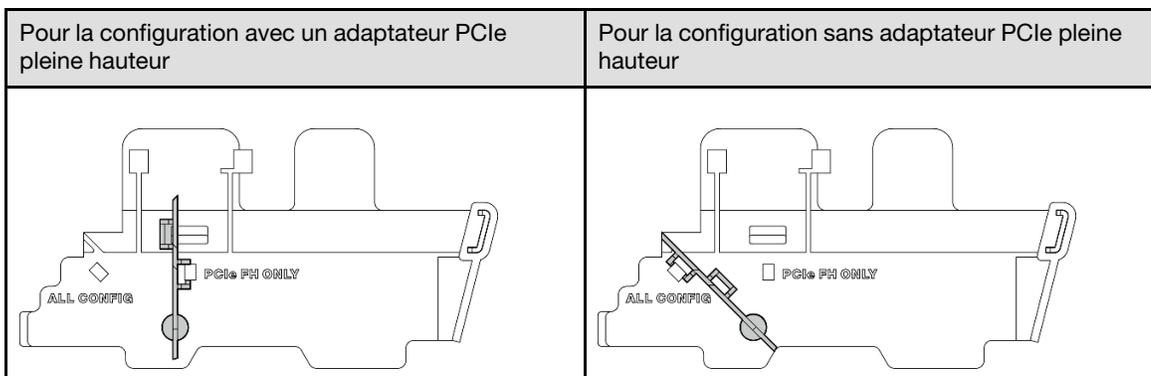
Etape 3. Alignez l'avant de l'assemblage de carte mezzanine avec le bord du châssis ; ensuite, abaissez l'assemblage de carte mezzanine sur le nœud.
