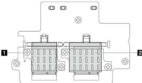
**1** Module x86 WLAN (avec deux connecteurs de câble)
