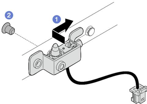
Figure 152. Installation du commutateur d'intrusion avec câble
