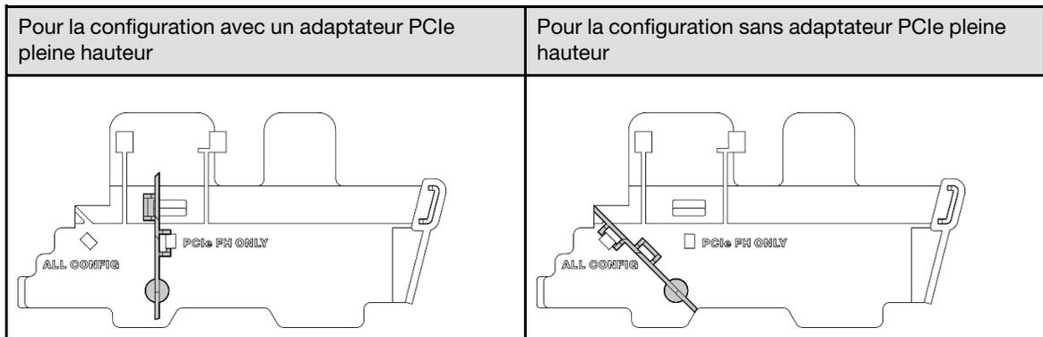
Etape 3. Alignez l'avant de l'assemblage de carte mezzanine avec le bord du châssis ; ensuite, abaissez l'assemblage de carte mezzanine sur le nœud.
