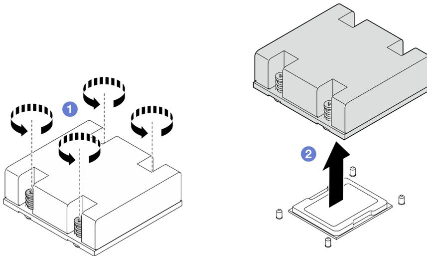
Figure 217. Retrait du dissipateur thermique de processeur
