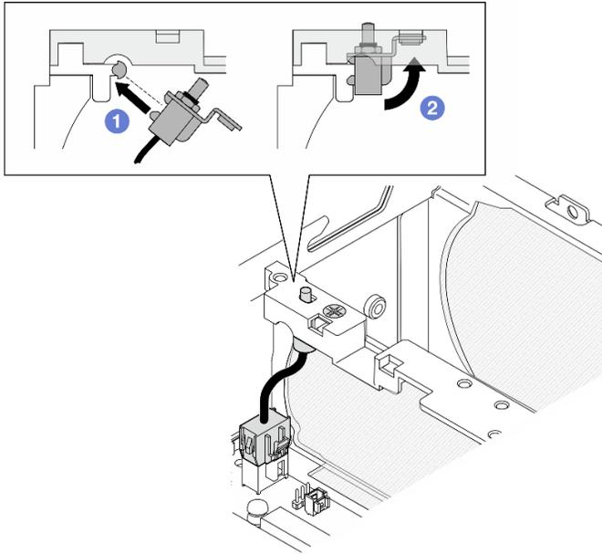
Figure 124. Installation du commutateur d'intrusion avec câble
