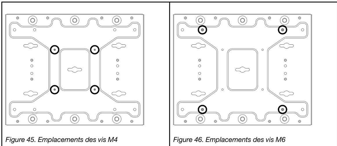
Figure 45. Emplacements des vis M4
