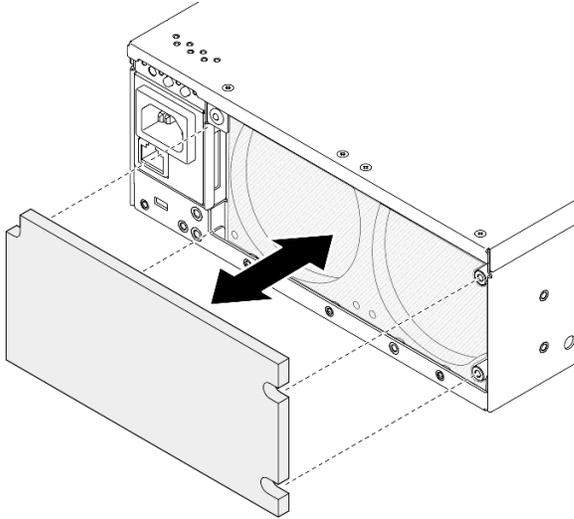
Figure 74. Installation du filtre anti-poussière
