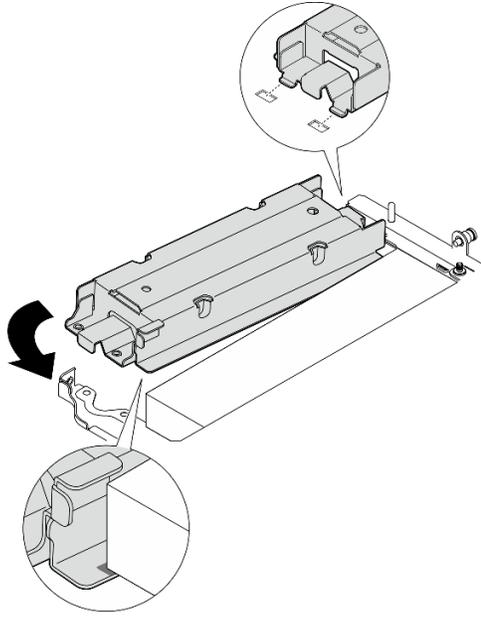
Figure 256. Installation du boîtier du module de géolocalisation
