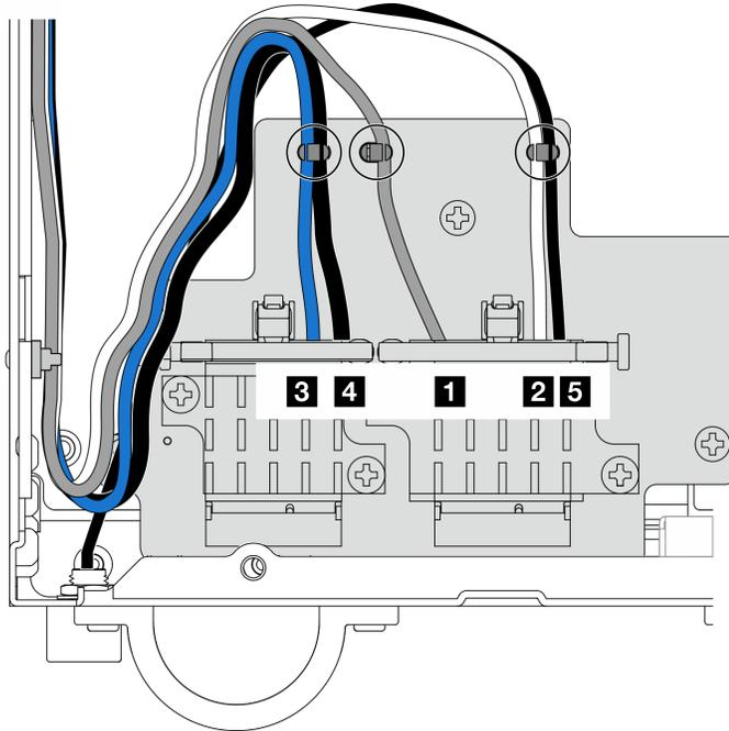
Figure 330. Cheminement des câbles pour l'adaptateur sans fil
