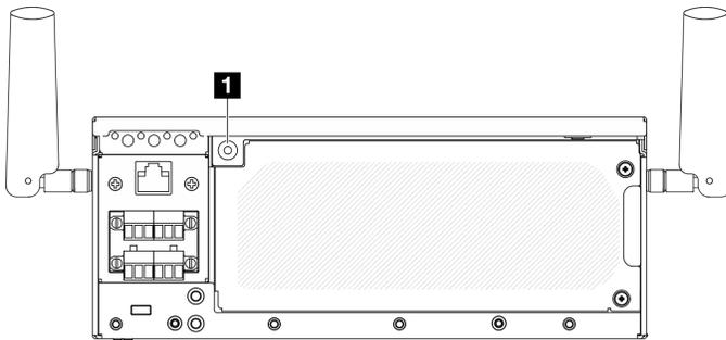
그림 17. PMB 상태 LED
