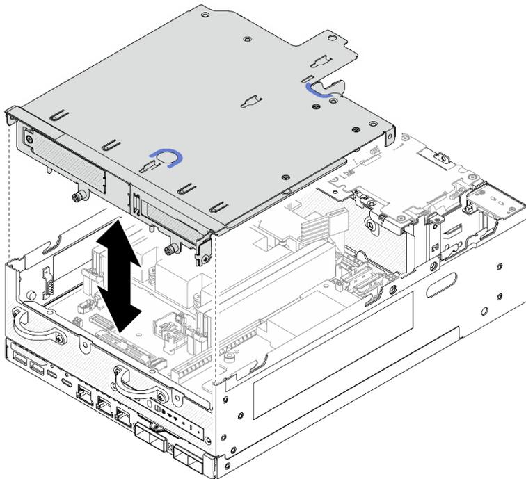
Figura 266. Abaixando o conjunto de placa riser
