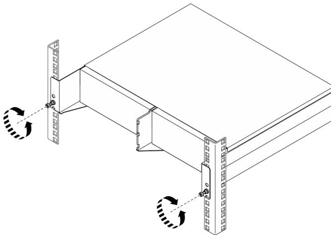
Figura 7. Desencaixando o gabinete do rack
