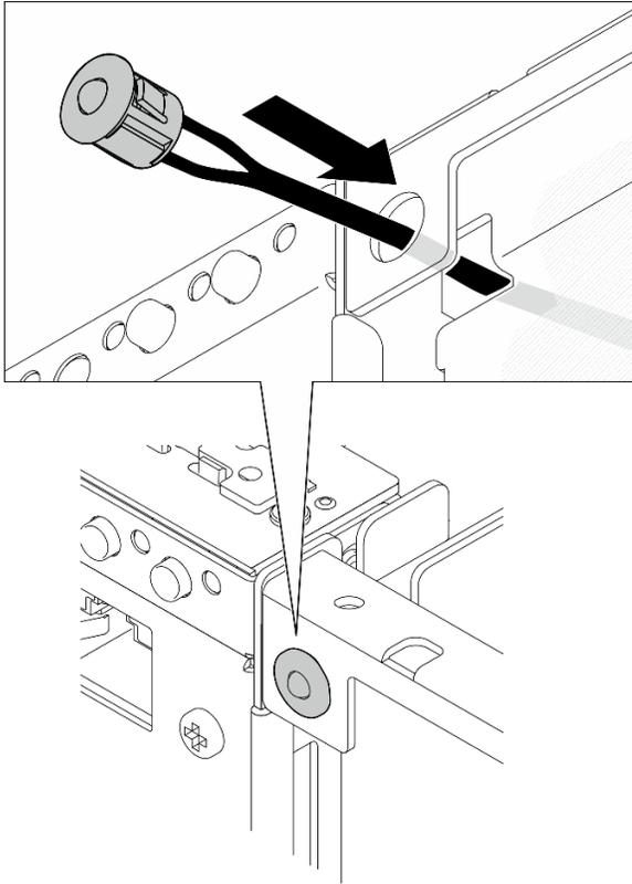
*Figura 199. Instalando o cabo de LED de status da PMB*
