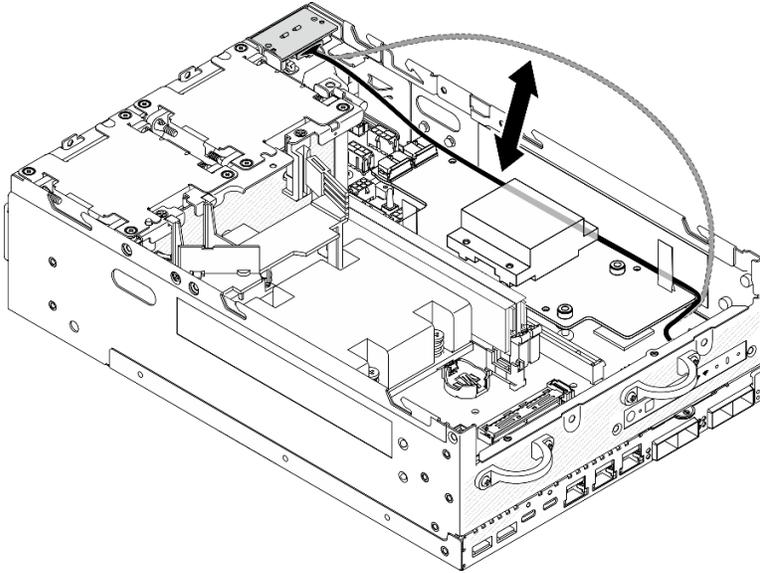
Figura 216. Colocando o cabo de sinal
