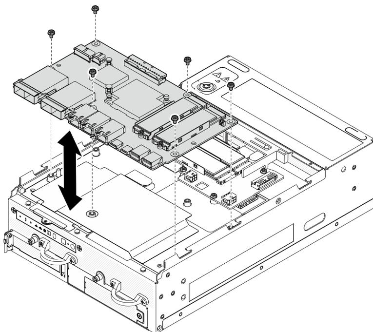
Figura 155. Removendo a placa do módulo de E/S
