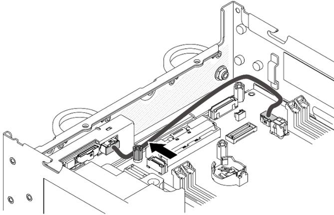
Figura 341. Roteamento de cabos do painel frontal do operador
