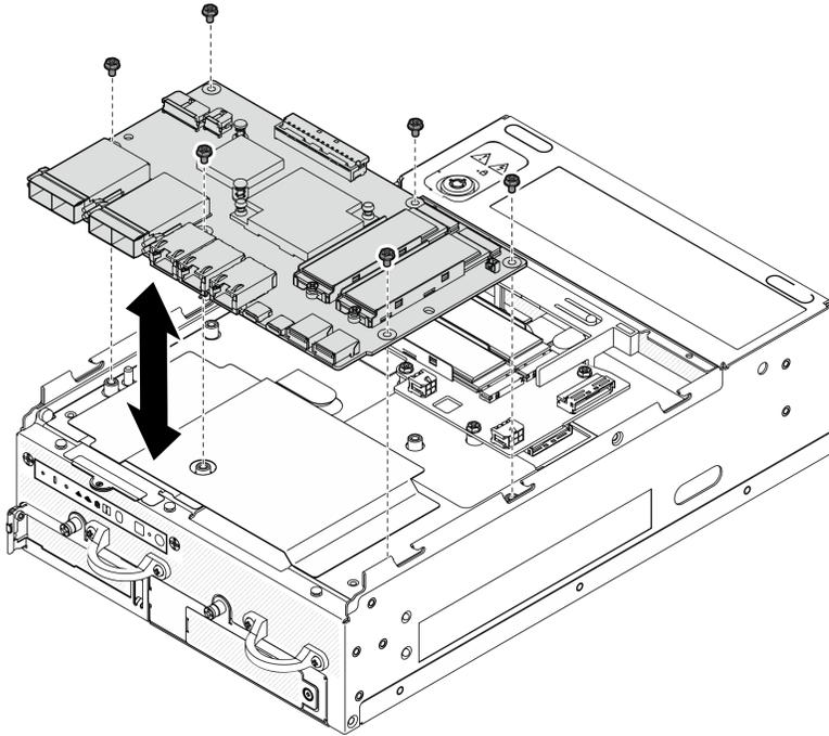
Figura 160. Instalando a placa do módulo de E/S
