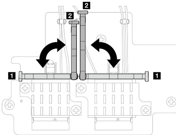
Figura 108. Girando o retentor do cabo
