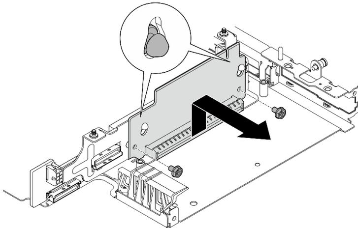
Figura 240. Removendo a placa riser
