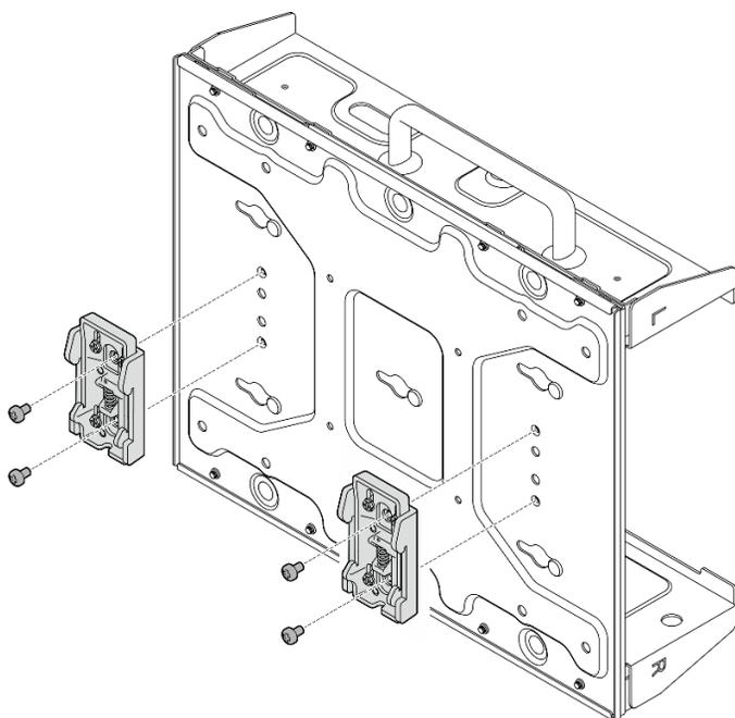
Figura 53. Removendo as presilhas do trilho DIN
