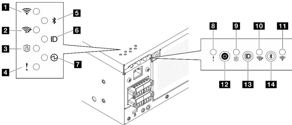
Figura 350. LEDs do painel traseiro do operador
