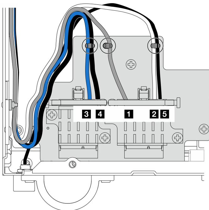
Figura 334. Roteamento de cabos do adaptador sem fio
