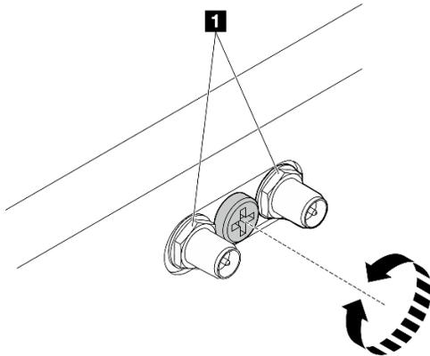
Figura 19. Encurtando os conectores da SMA
