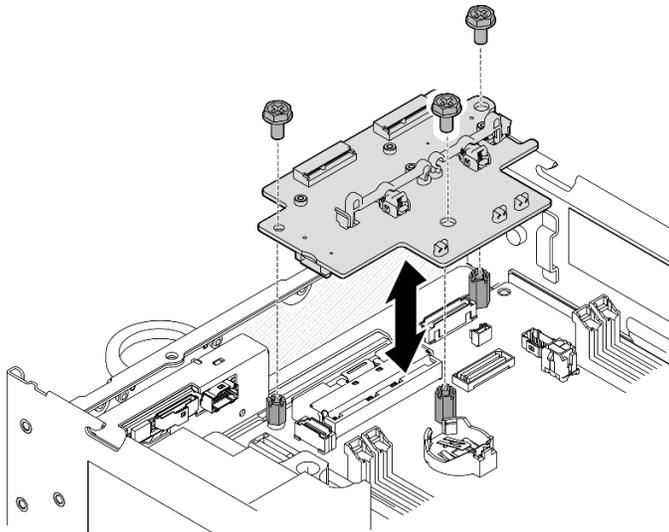
Figura 284. Instalando o adaptador sem fio
