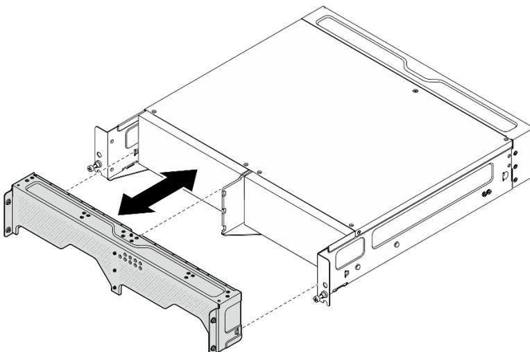
Figura 67. Removendo o suporte de remessa
