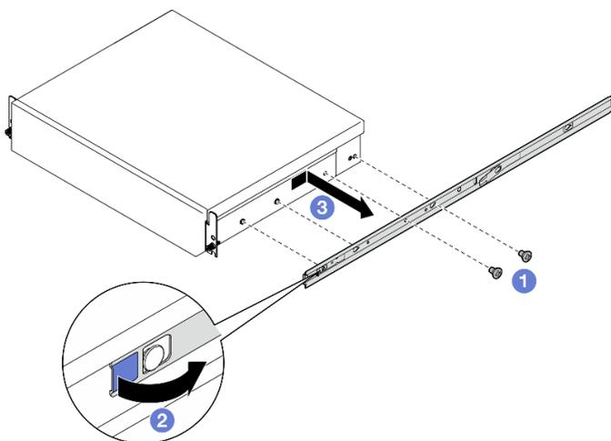
Figura 9. Removendo o trilho interno
