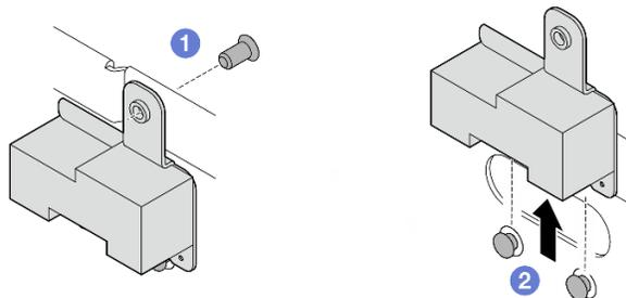
Figura 300. Removendo o preenchimento SMA
