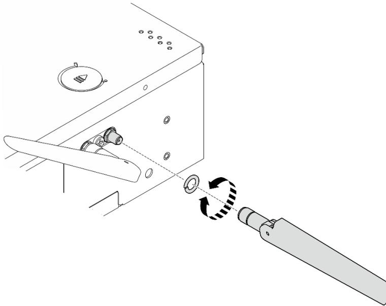
Figura 338. Instalando uma antena WLAN
