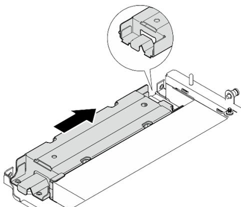
Figura 257. Instalando a gaiola de módulo de rastreamento geográfico
