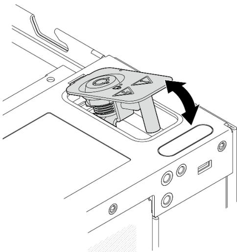
Figura 166. Removendo a fechadura de segurança do sistema
