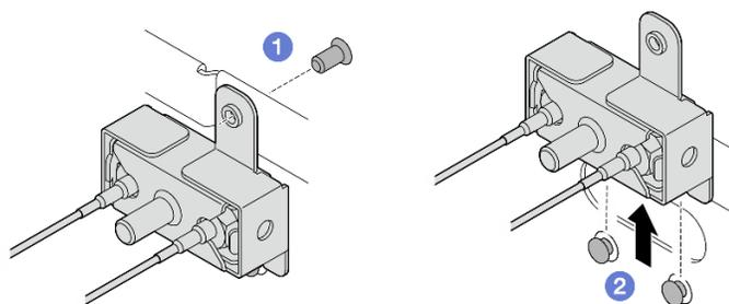
Figura 306. Removendo o conjunto SMA
