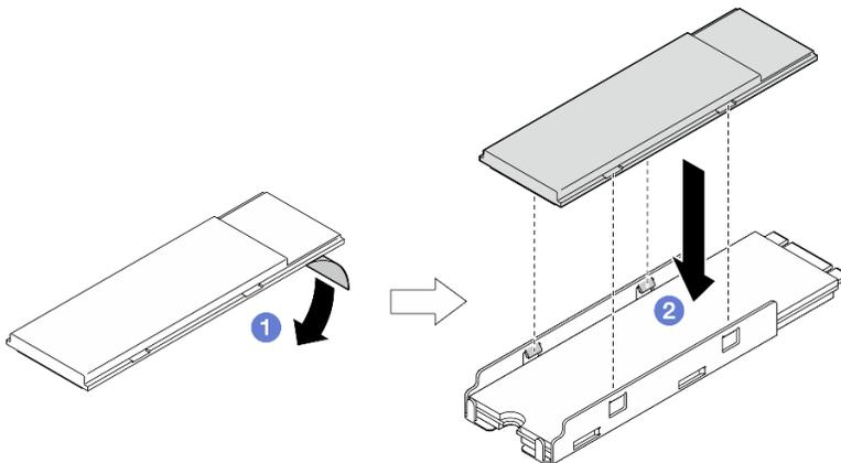
Figura 175. Instalando o dissipador de calor M.2
