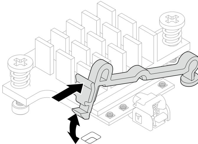
Figura 301. Levantando o retentor de cabo
