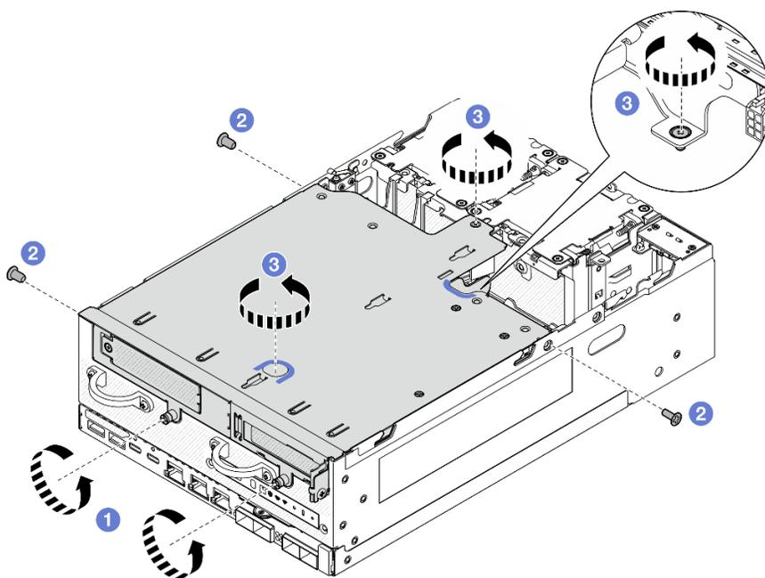
Figura 222. Desencaixando o conjunto de placa riser
