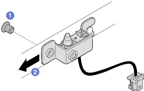
Figura 143. Removendo a chave de intrusão com cabo
