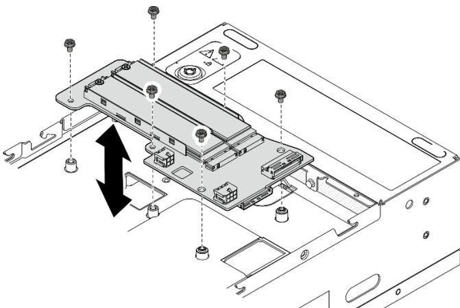
Figura 113. Removendo o adaptador cabeado M.2 inferior
