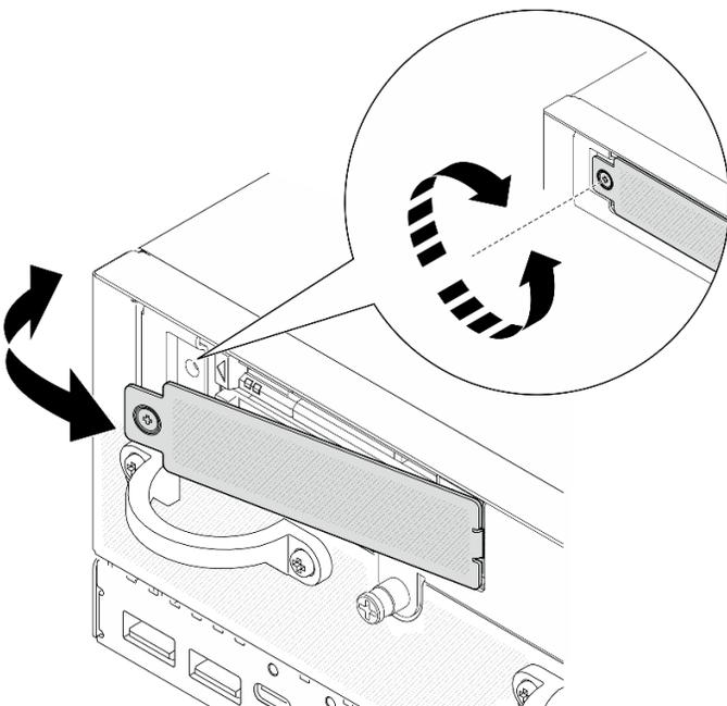
Figura 81. Instalando o painel
