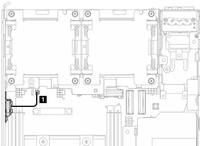
Figura 147. Roteamento de cabos da chave de intrusão superior
