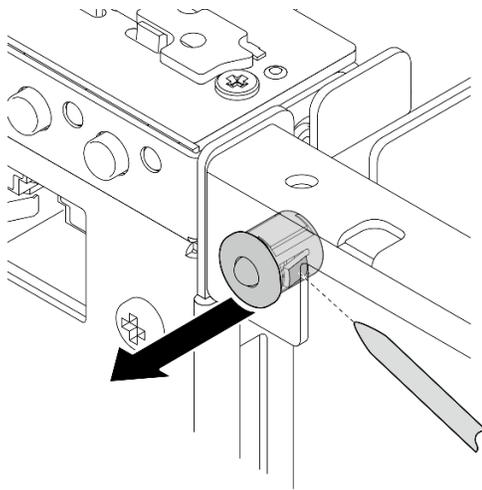
Figura 198. Removendo o cabo de LED de status da PMB
