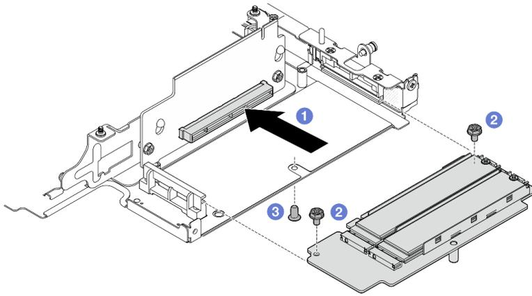
Figura 243. Instalando o adaptador M.2
