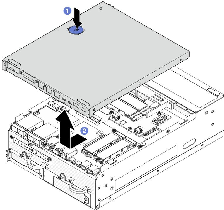
Figura 191. Removendo a tampa inferior
