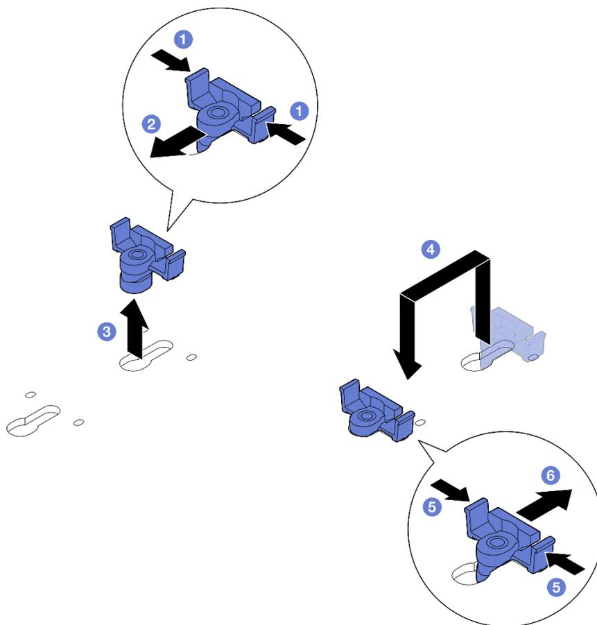
Figura 114. Ajustando o retentor M.2
