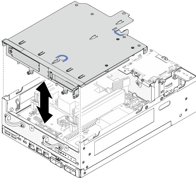
Figura 260. Abaixando o conjunto de placa riser
