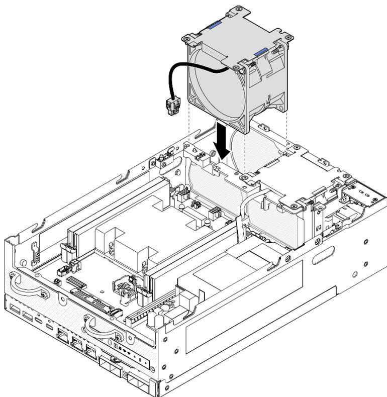
*Figura 128.* Instalando o módulo de ventilador
