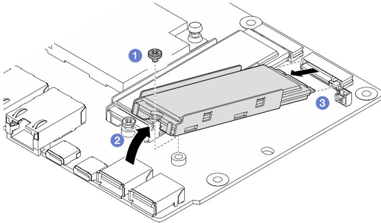
Figura 154. Removendo uma unidade M.2
