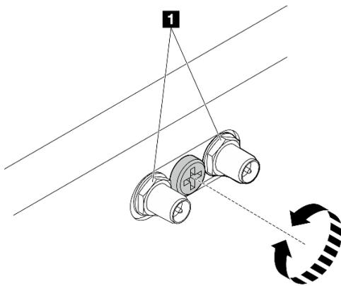
Figura 310. Encurtando os conectores da SMA
