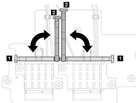
Figura 304. Girando o retedor do cabo
