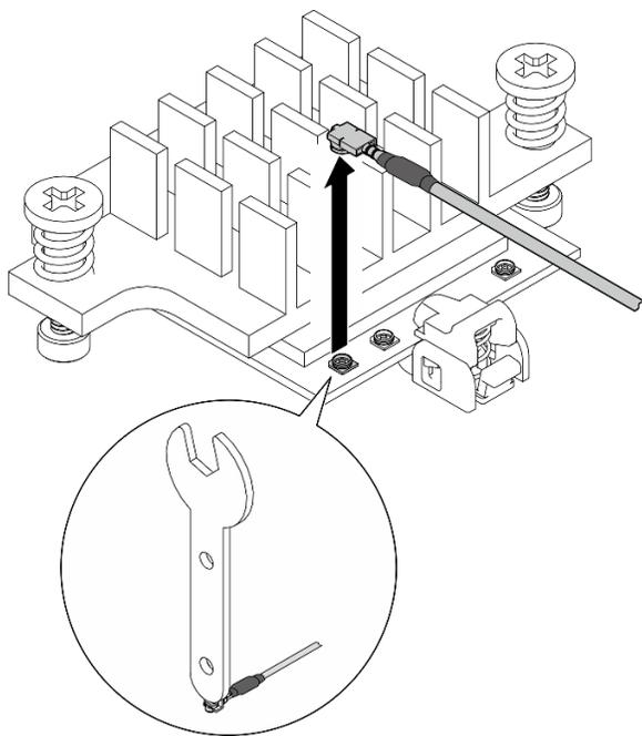
Figura 303. Desconectando o cabo
