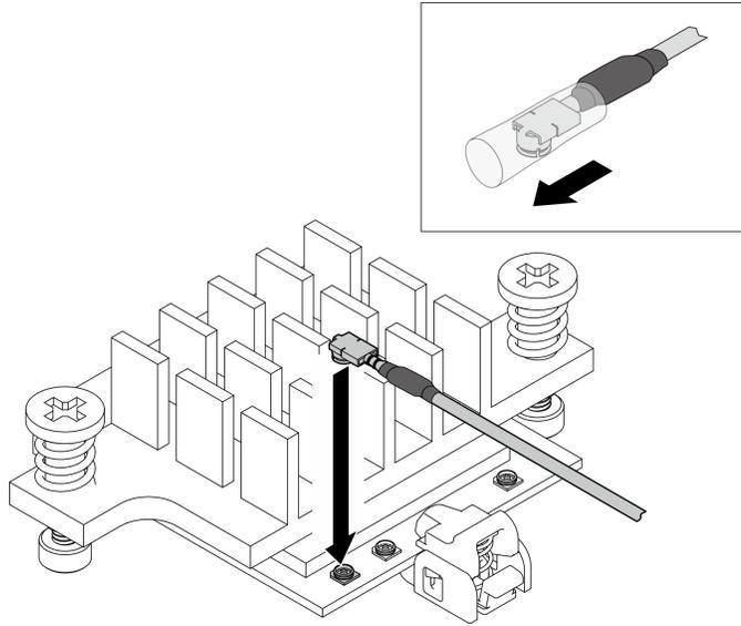
Figura 107. Conectando o cabo
