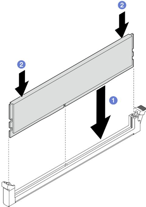
Figura 181. Instalando um módulo de memória
