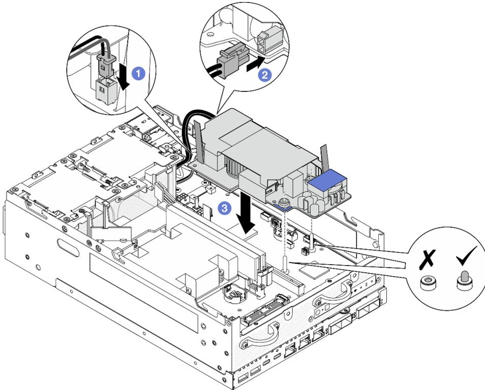
Figura 138. Instalando a unidade de fonte de alimentação interna
