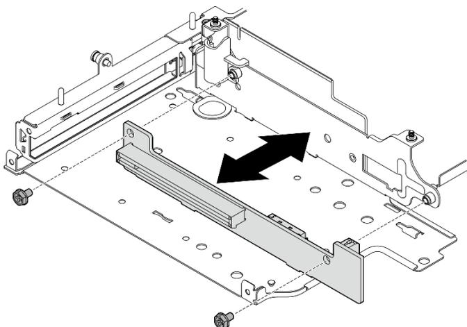
Figura 254. Instalando a placa riser
