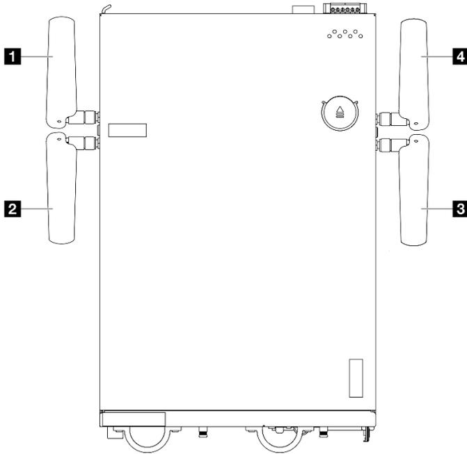
Figura 336. Locais das antenas WLAN
