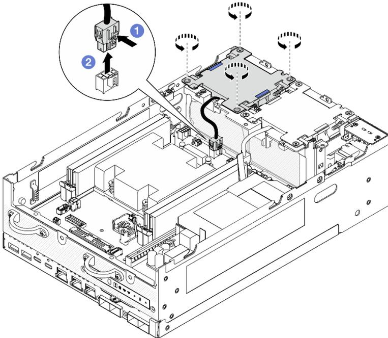
Figura 126. Removendo o módulo de ventilador
