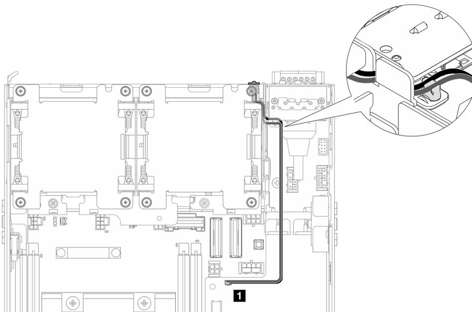
Figura 196. Cabo de LED de status da PMB conectado à placa do módulo de energia CC (DC PMB)
