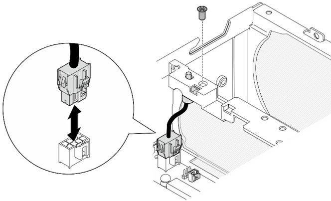
Figura 122. Removendo a chave de direção do ventilador
