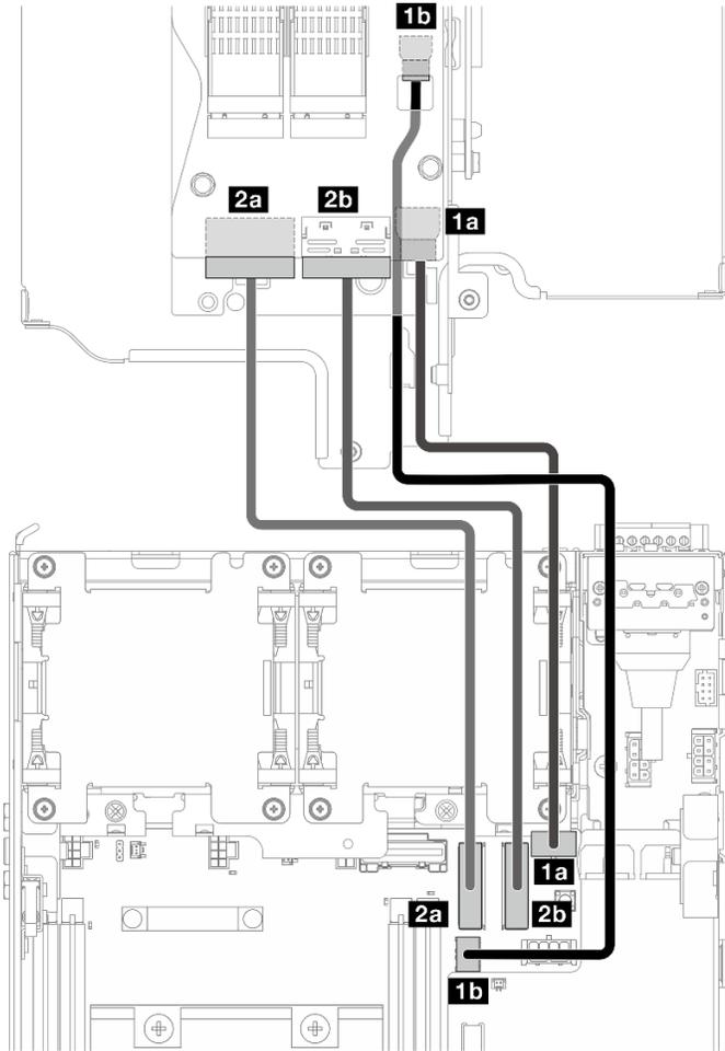
**Nota:** Ao conectar o cabo **2** ao adaptador cabeado M.2, conclua o procedimento em "[Instalar o conjunto M.2](#)" na página 208 para rotear o cabo corretamente.
