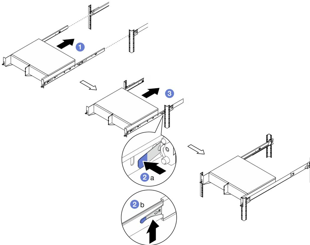
Figura 17. Instalando o gabinete no rack
