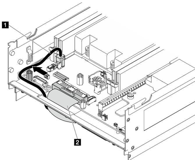
Figura 158. Roteamento de cabos da placa de E/S
