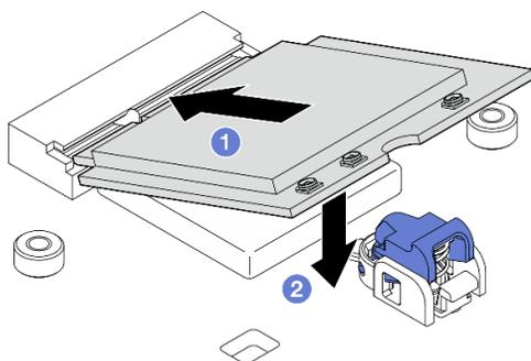
Figura 287. Instalando o módulo WLAN/Bluetooth
