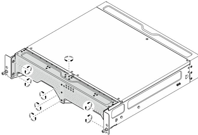
*Figura 2. Soltando os parafusos*
