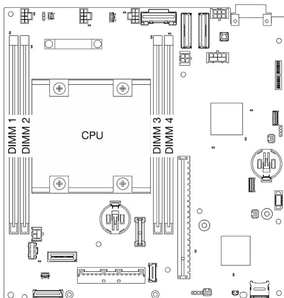
Figura 179. Layout de módulos de memória e processadores
