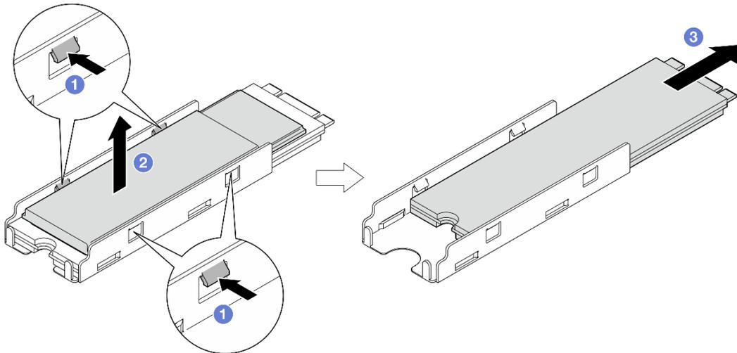
Figura 173. Removendo o dissipador de calor M.2
