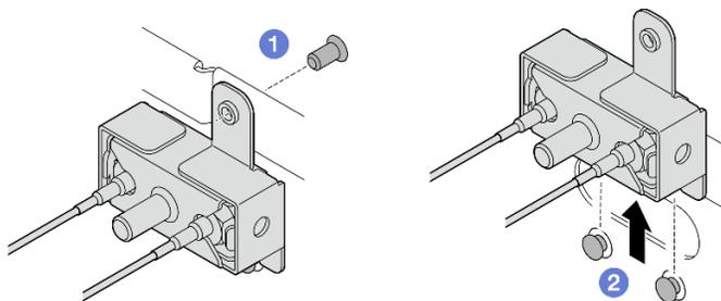
Figura 317. Removendo o conjunto SMA
