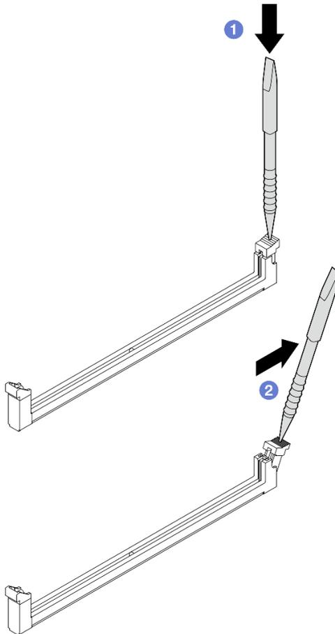
Figura 180. Abrindo o clipe de retenção
