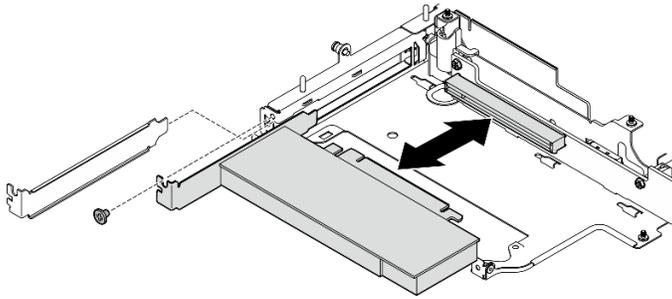
Figura 234. Removendo o adaptador PCIe
