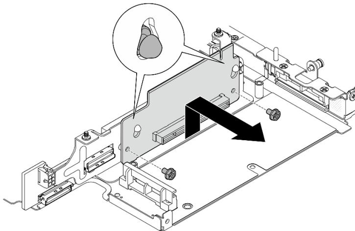
Figura 237. Removendo a placa riser
