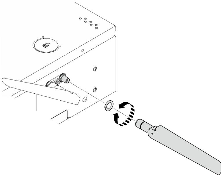
Figura 296. Removendo uma antena WLAN
