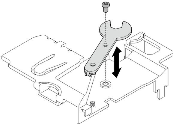
Figura 102. Desencaixando a chave
