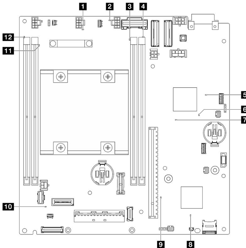
Figura 351. LEDs da placa-mãe
