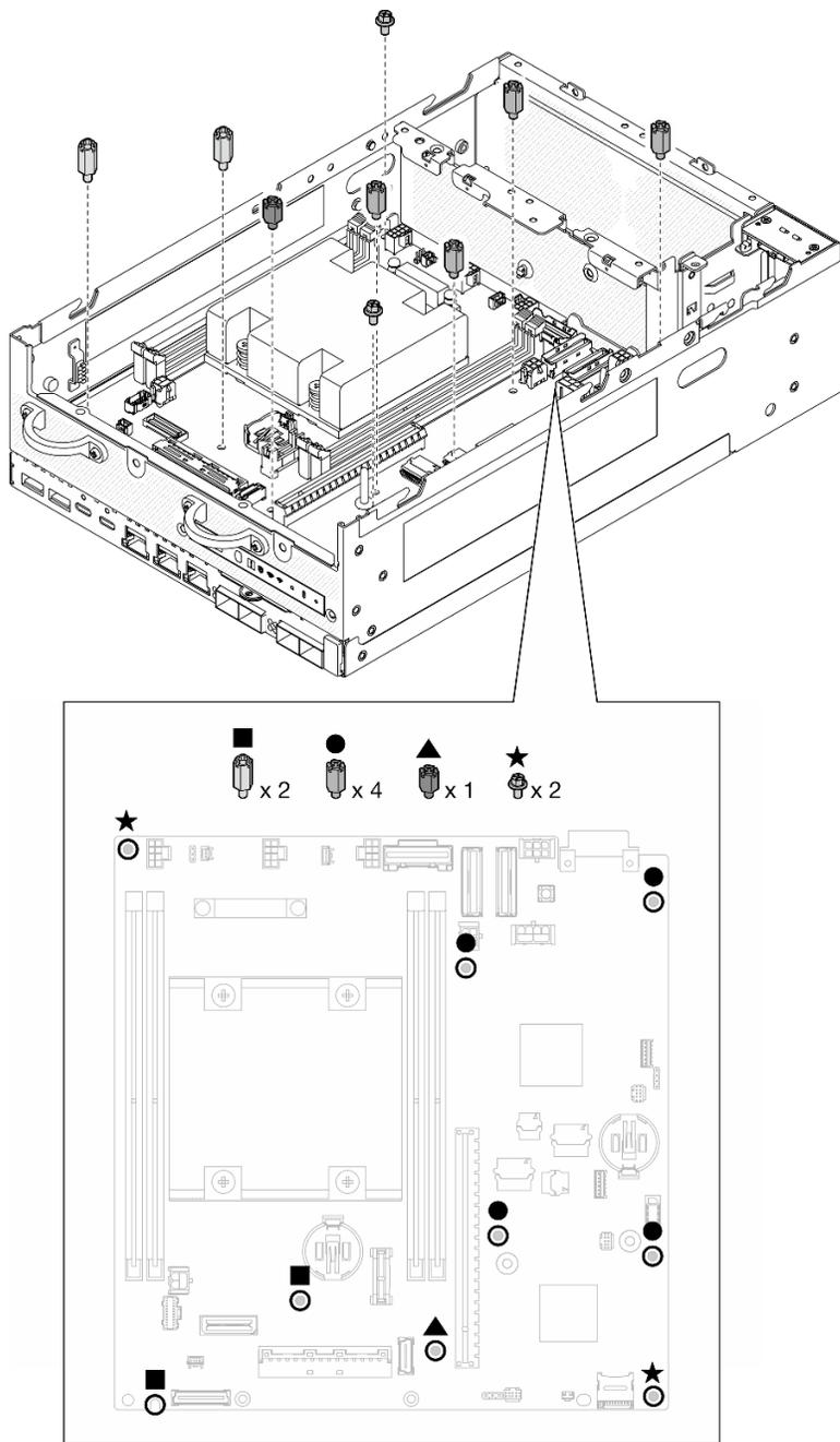
Figura 272. Os parafusos e os suportes na placa-mãe
