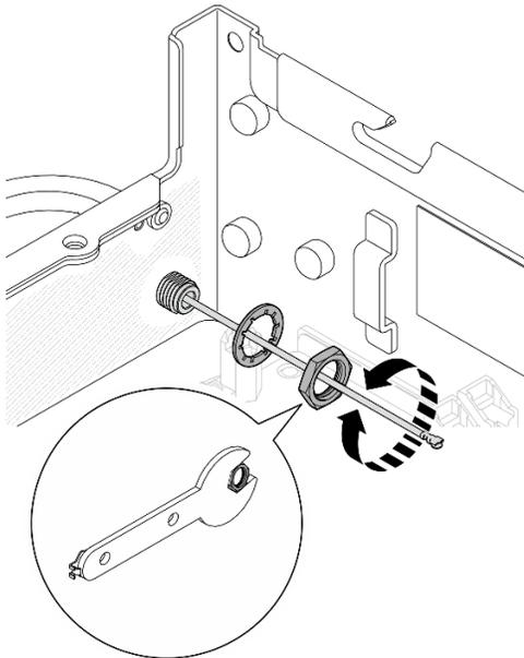
Figura 104. Instalando a antena Bluetooth
