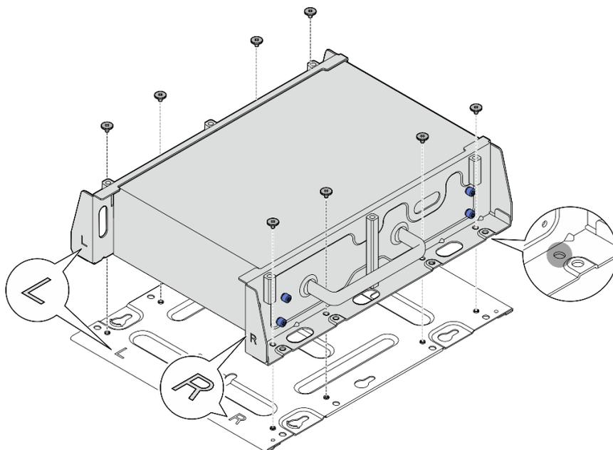
Figura 54. Removendo a placa inferior
