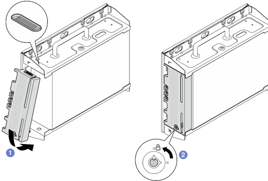
Figura 65. Instalando o painel de segurança
