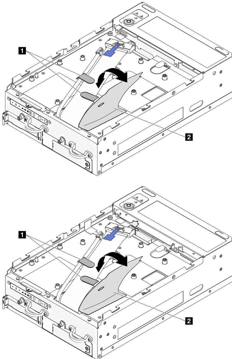
Figura 159. Roteamento de cabos da placa de E/S
