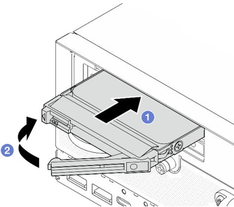
Figura 79. Instalando uma unidade de 7 mm
