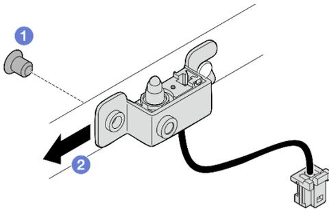
Figura 149. Removendo a chave de intrusão com cabo
