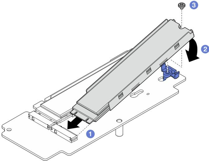
Figura 241. Instalando uma unidade M.2
