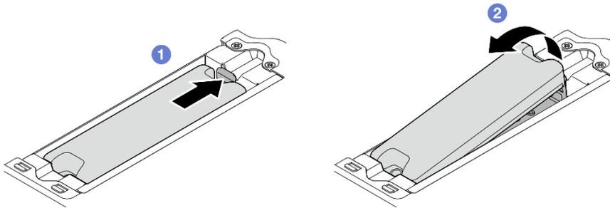
Figura 231. Removendo a módulo de rastreamento geográfico
