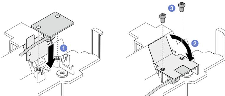
Figura 90. Instalando a placa do sensor de fluxo de ar
