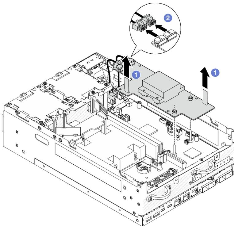
Figura 210. Removendo a placa do módulo de energia
