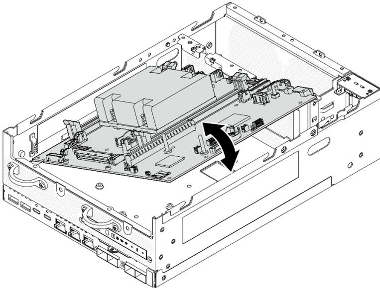
Figura 273. Removendo a placa-mãe
