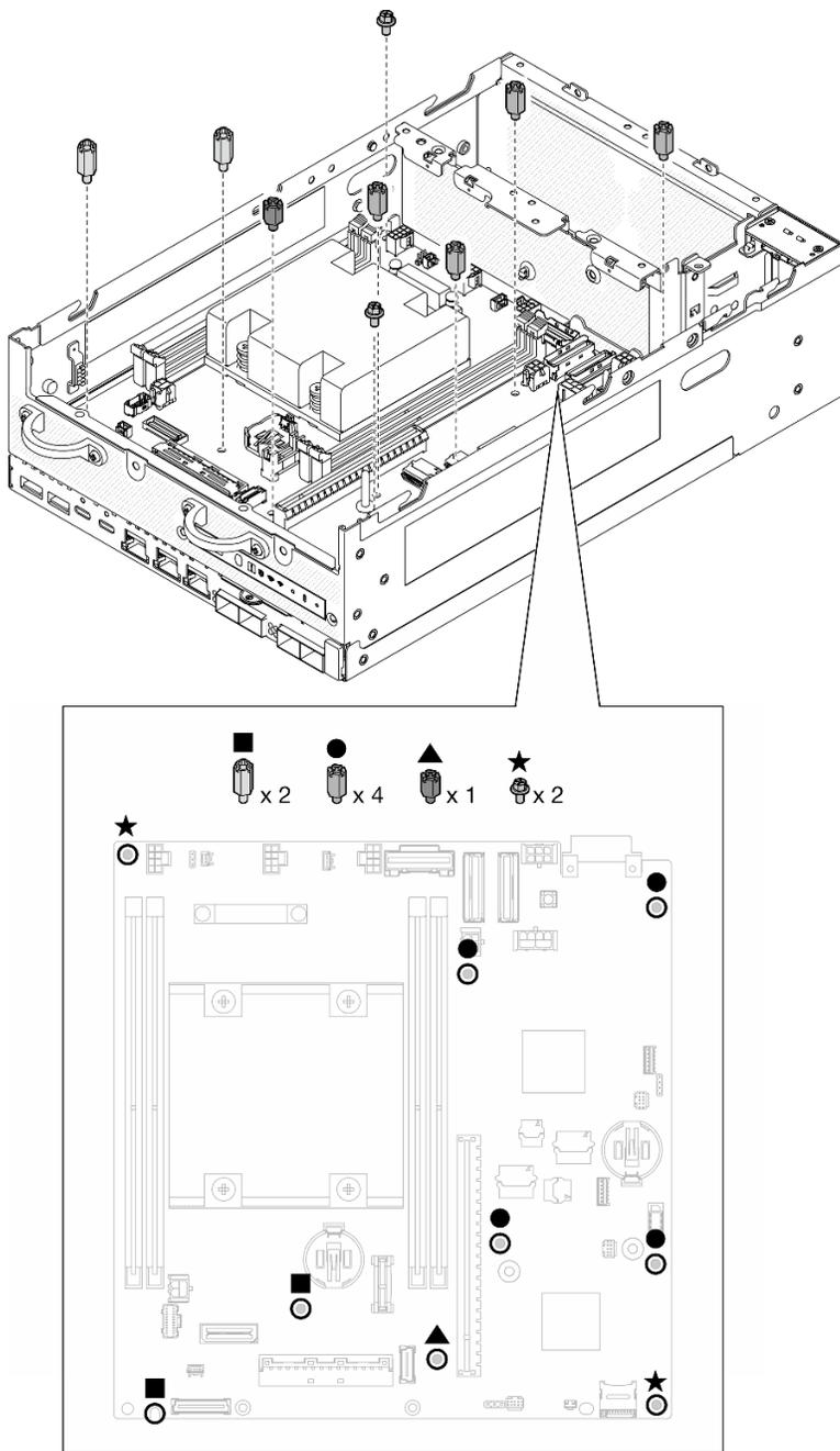
Figura 275. Os parafusos e os suportes na placa-mãe
