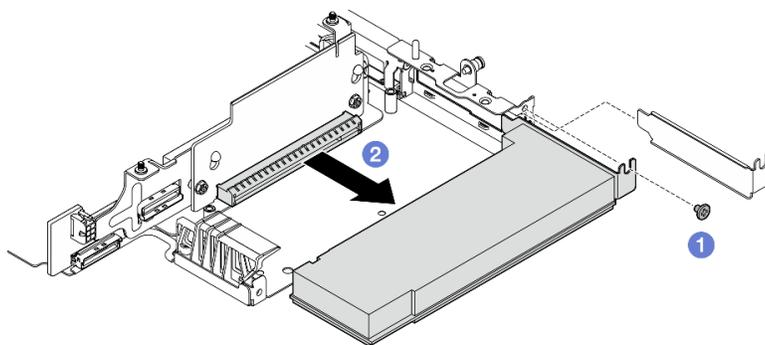
Figura 239. Removendo o adaptador PCIe
