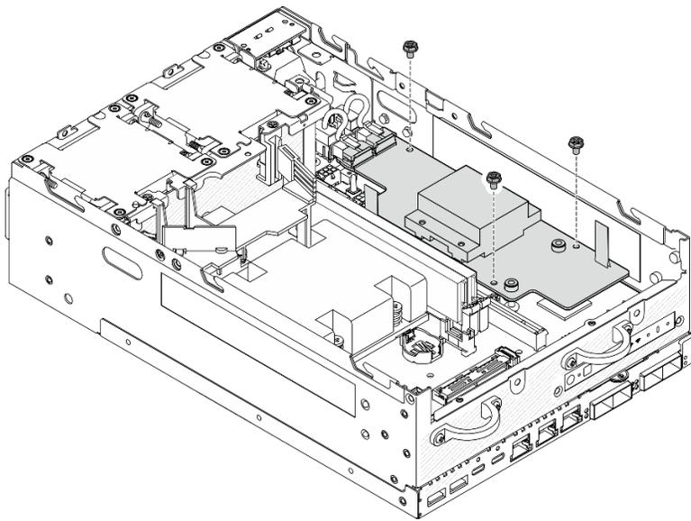
Figura 214. Prendendo a placa do módulo de energia
