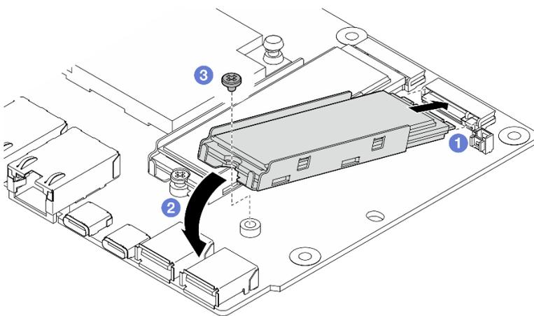
Figura 162. Instalando uma unidade M.2
