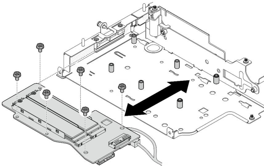
Figura 248. Instalando o adaptador M.2
