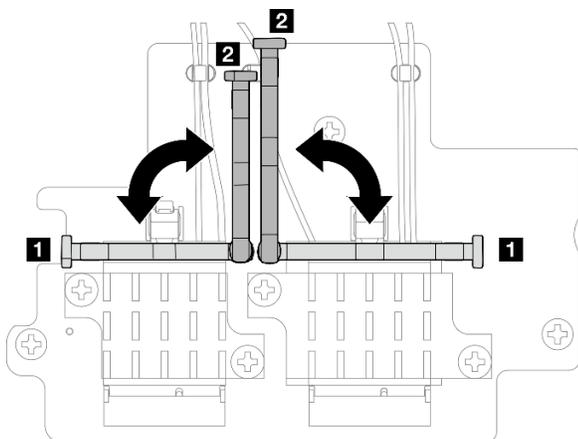
Figura 313. Girando o retentor do cabo
