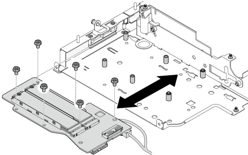
Figura 225. Removendo o adaptador cabeado M.2
