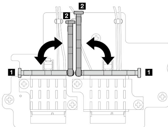
Figura 279. Girando o retentor do cabo
