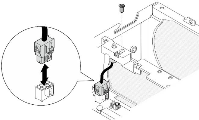
Figura 125. Instalando a chave de direção do ventilador
