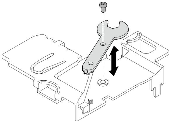
Figura 298. Desencaixando a chave
