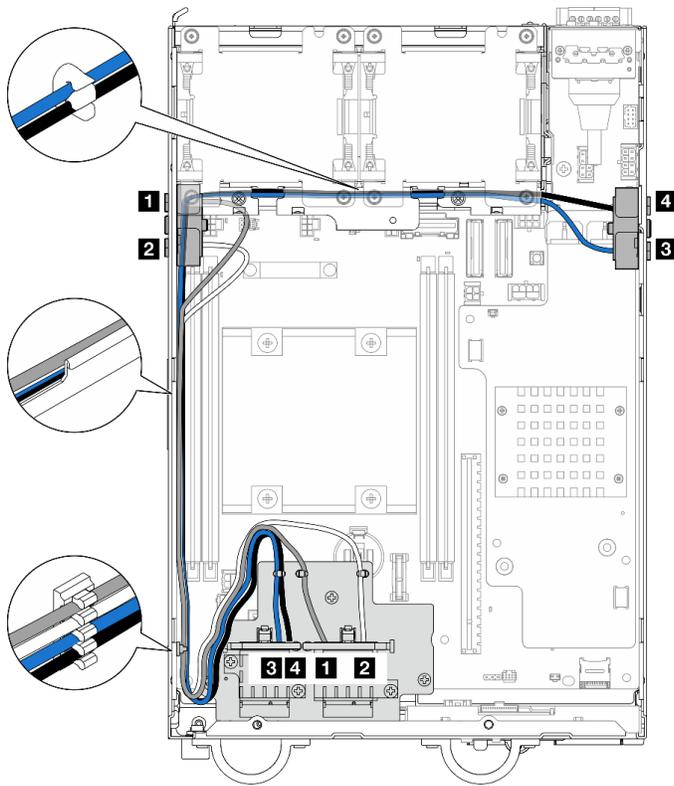
Figura 342. Roteamento de cabos da antena WLAN
