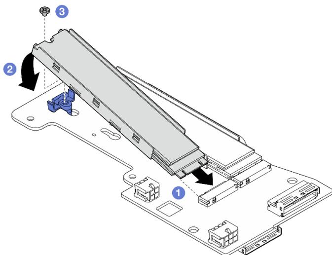
Figura 246. Instalando uma unidade M.2
