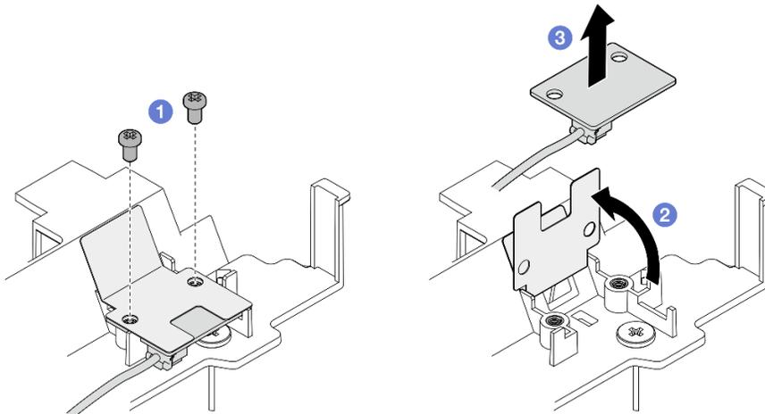
Figura 88. Removendo a placa do sensor de fluxo de ar
