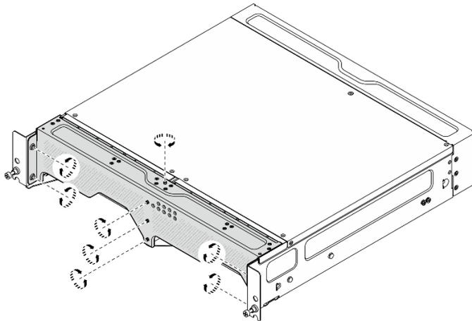
Figura 25. Apertando os parafusos
