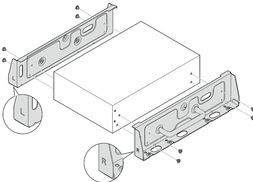
Figura 32. Soltando os parafusos para remover os suportes laterais
