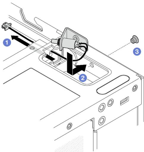
Figura 169. Instalando a chave de posição travada com cabo
