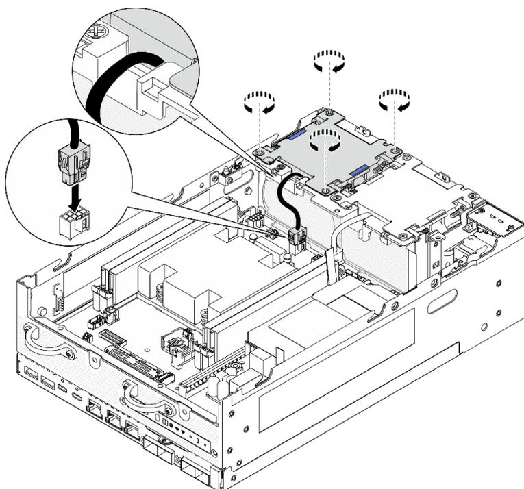
Figura 129. Instalando o módulo de ventilador
