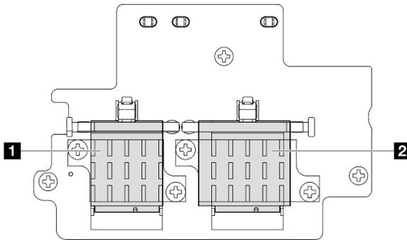
**1** Módulo WLAN x86 (com dois conectores de cabo)
