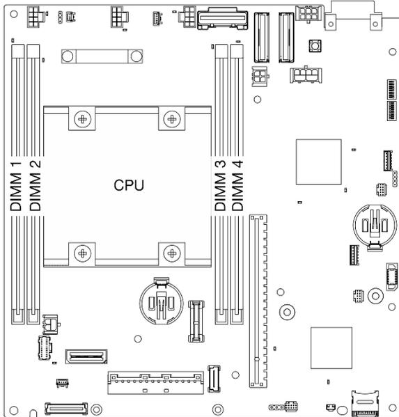
Figura 176. Layout de módulos de memória e processadores
