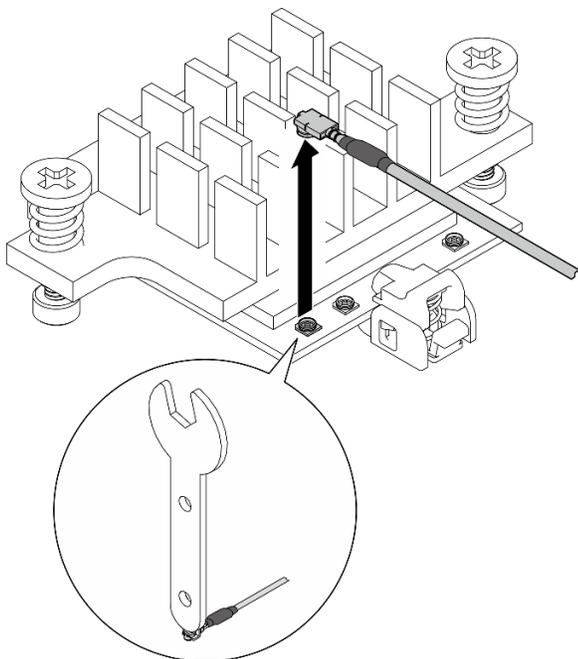
Figura 314. Desconectando o cabo
