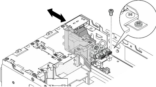
Figura 202. Removendo o módulo DC PIB
