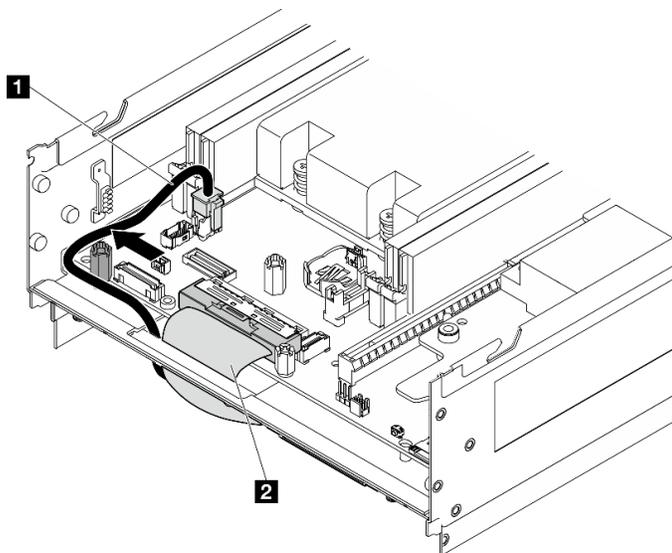
Figura 276. Roteamento de cabos da placa de E/S
