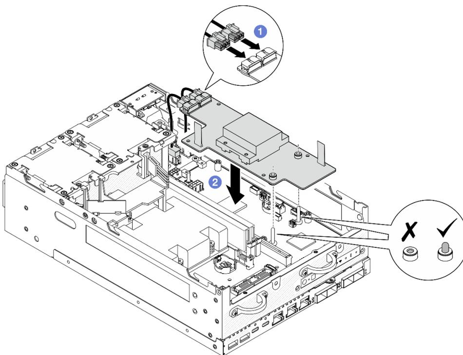
Figura 212. Instalando a placa do módulo de energia
