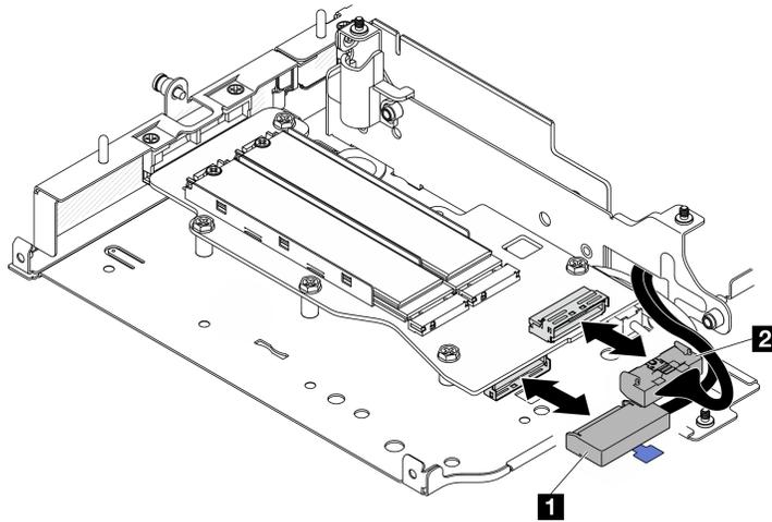
Figura 249. Desconectando o cabo de sinal
