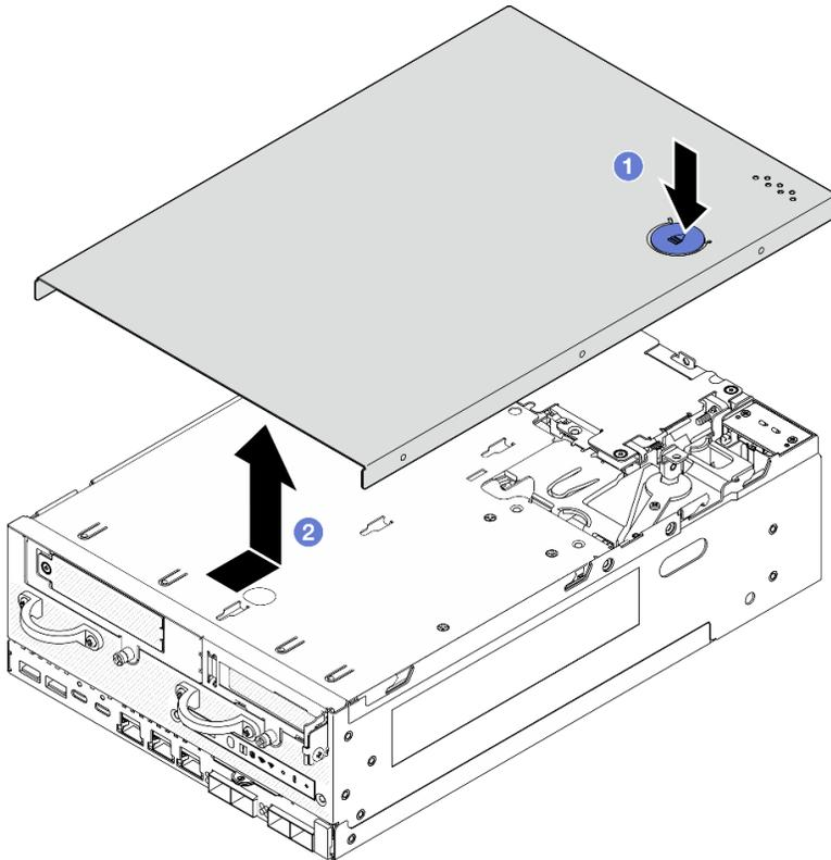
Figura 185. Removendo a tampa superior
