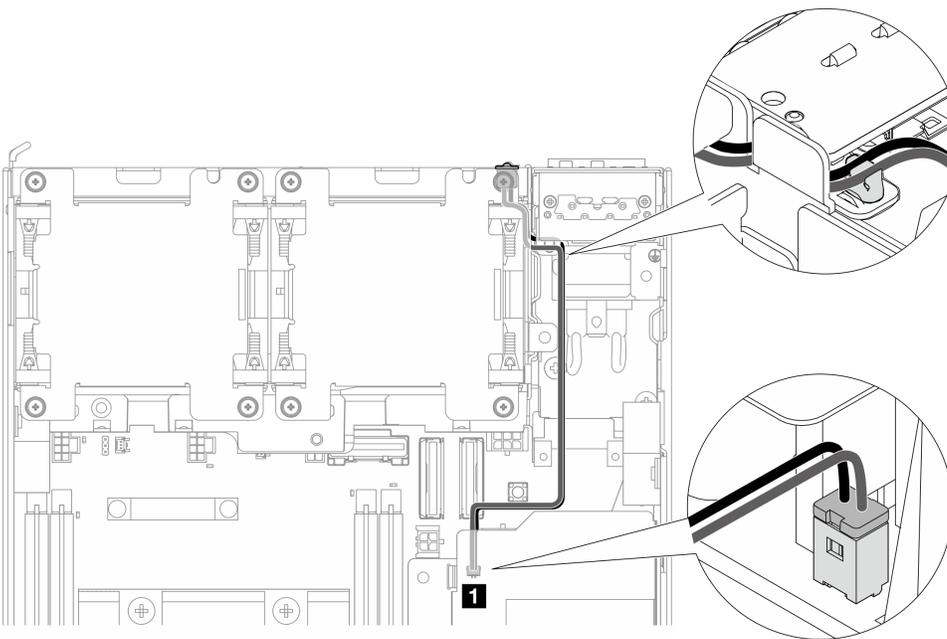
Figura 201. Cabo de LED de status da PMB conectado à unidade de fonte de alimentação interna (AC PMB)
