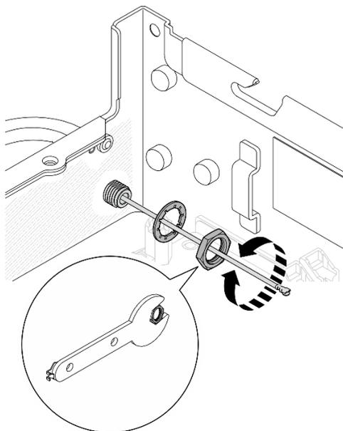
*Figura 99. Removendo a antena Bluetooth*
