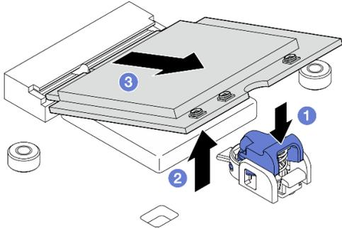
Figura 282. Removendo o módulo WLAN/Bluetooth
