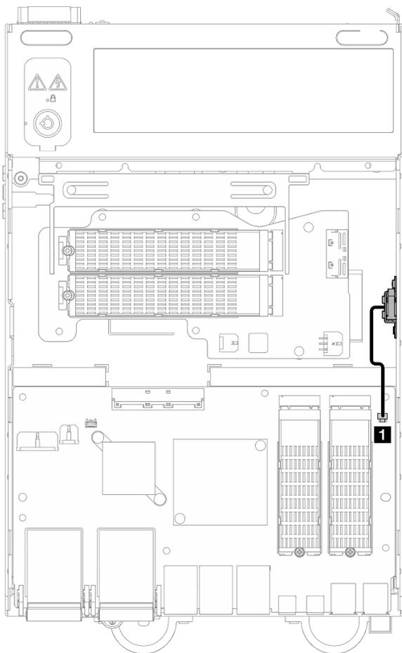
Figura 153. Roteamento do cabo da chave de intrusão inferior
