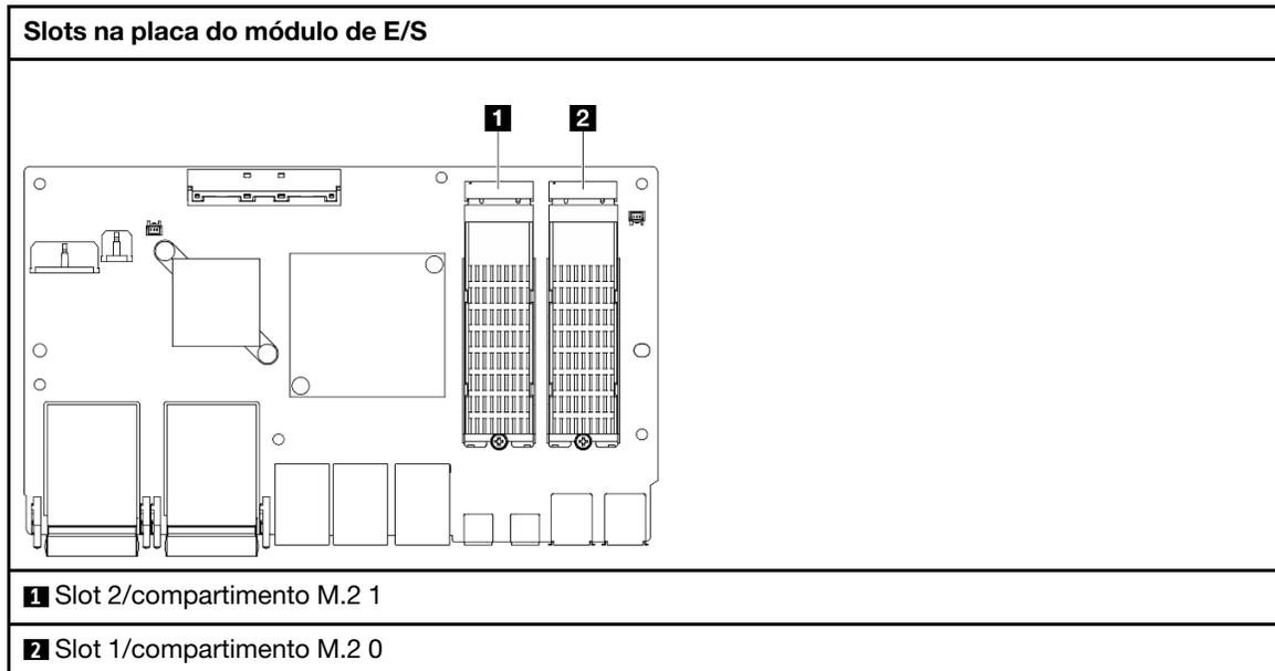
Etapa 2. Se necessário, instale um dissipador de calor M.2 na unidade M.2 a ser instalada. Consulte ["Instalar um dissipador de calor M.2" na página 144.](#)
