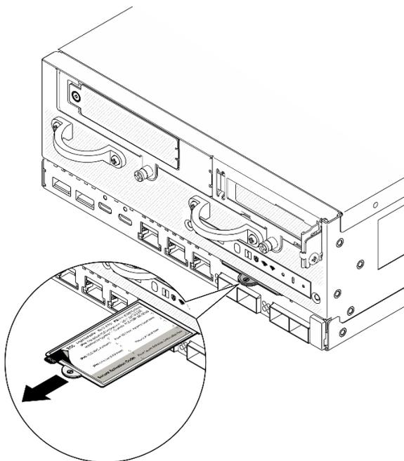
Figura 277. Etiqueta de acesso à rede do Lenovo XClarity Controller na guia de informações removível
