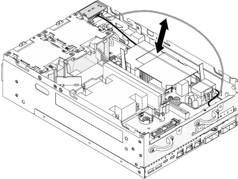
Figura 137. Colocando o cabo de sinal
