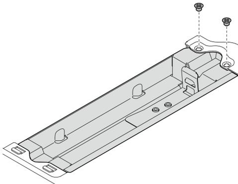
Figura 232. Removendo a gaiola de módulo de rastreamento geográfico
