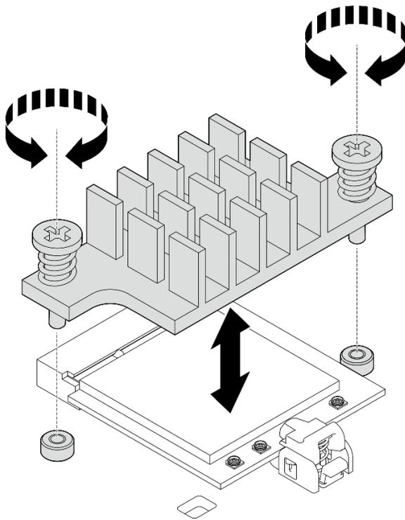
Figura 289. Instalando o dissipador de calor do módulo WLAN/Bluetooth
