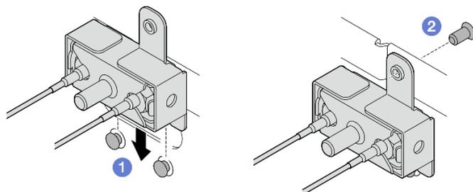
Figura 326. Instalando o conjunto SMA
