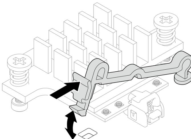
Figura 312. Levantando o retentor de cabo
