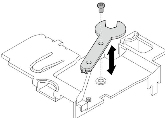
Figura 92. Desencaixando a chave
