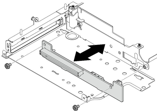
Figura 235. Removendo a placa riser
