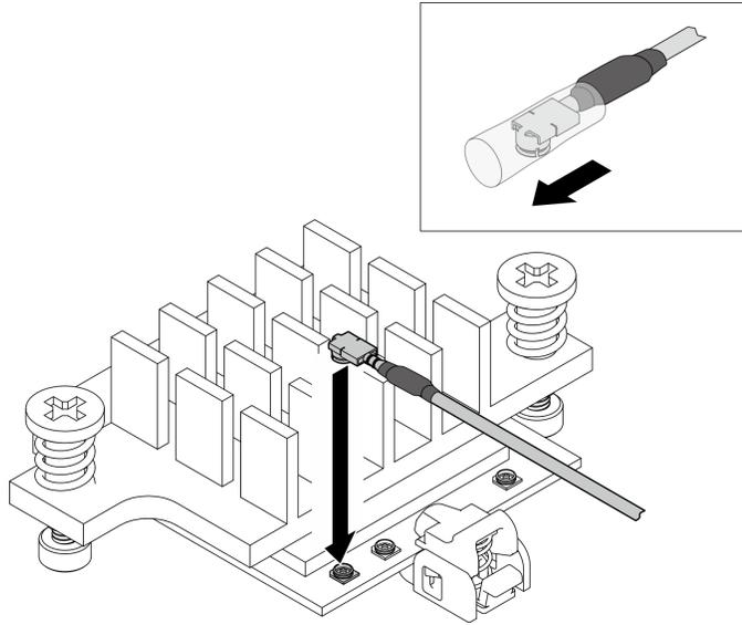
Figura 291. Conectando o cabo
