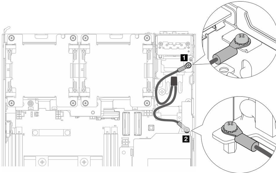
Figura 133. Desconectando os cabos de aterramento
