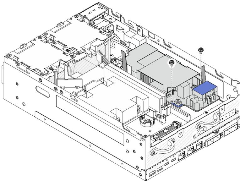
Figura 139. Apertando os parafusos
