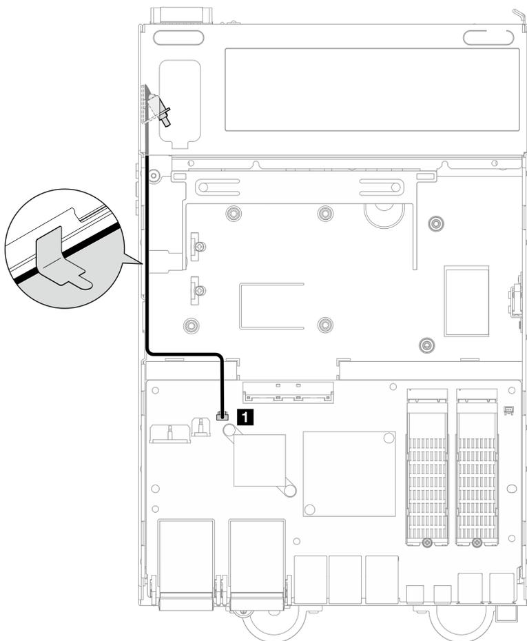
Figura 170. Roteamento de cabos da chave de posição travada
