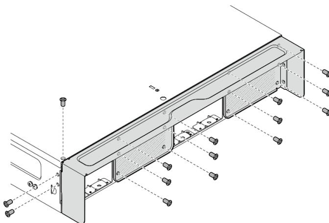
Figura 13. Apertando os parafusos
