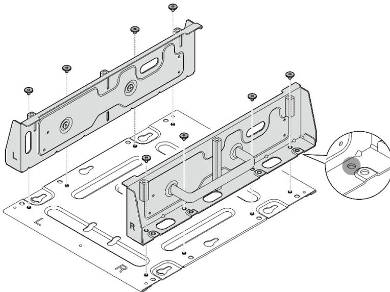
Figura 59. Desmontando o suporte do nó
