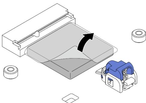
Figura 286. Removendo o filme do painel térmico
