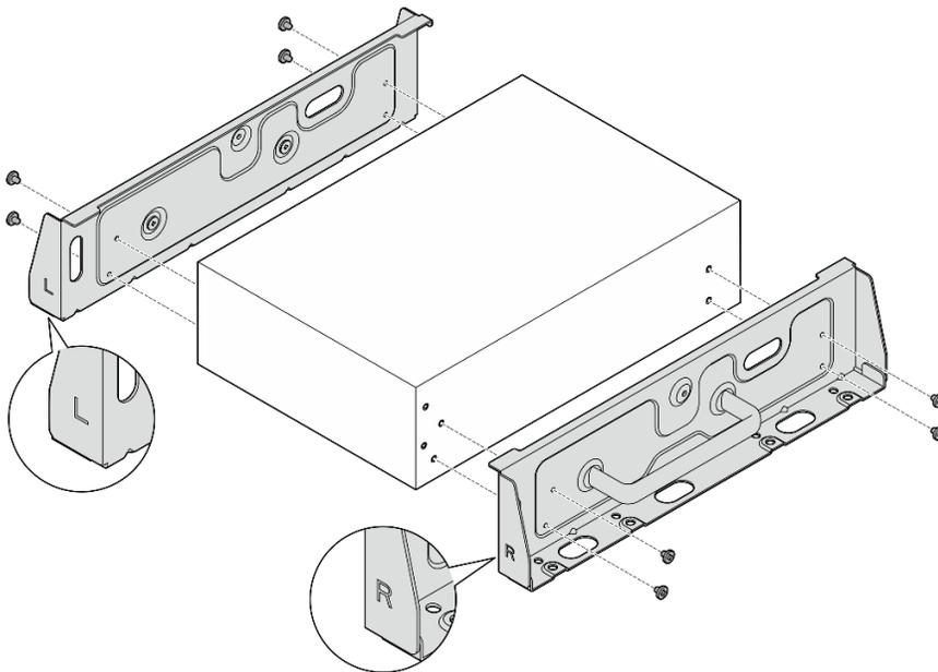
Figura 40. Instalando os suportes laterais com parafusos
