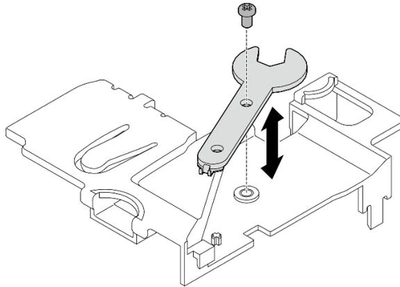
Figura 322. Desencaixando a chave
