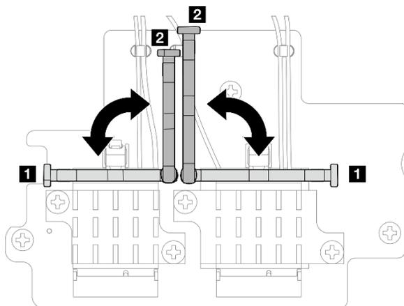
Figura 315. Girando o retentor do cabo
