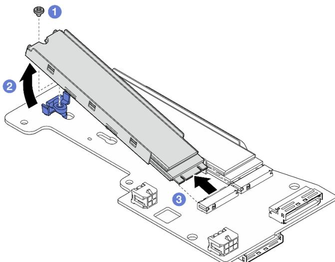
Figura 112. Removendo uma unidade M.2
