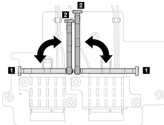
Figura 302. Girando o retentor do cabo
