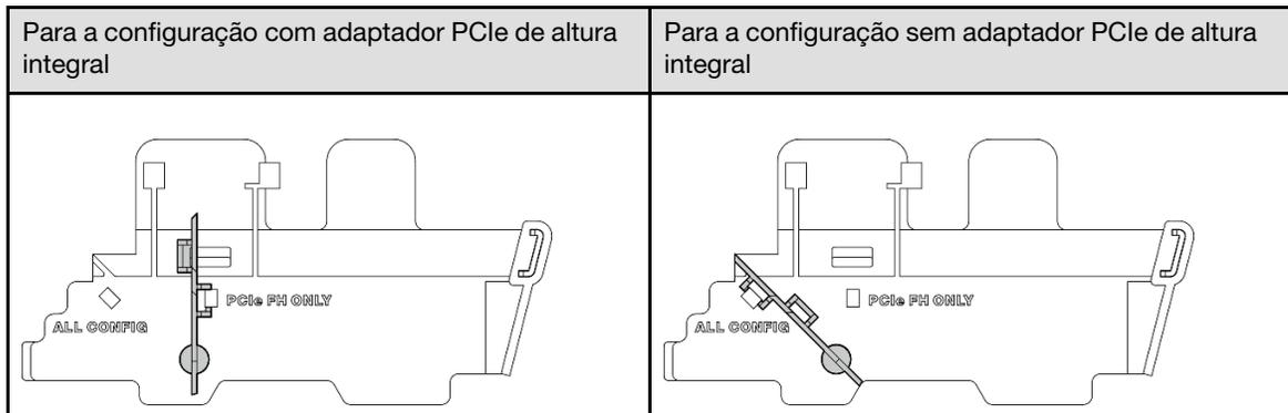
Etapa 3. Alinhe a parte frontal do conjunto da placa riser com a borda do chassi; em seguida, abaixe o conjunto da placa riser para o nó.
