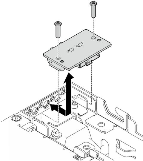
Figura 221. Instalando o painel traseiro do operador
