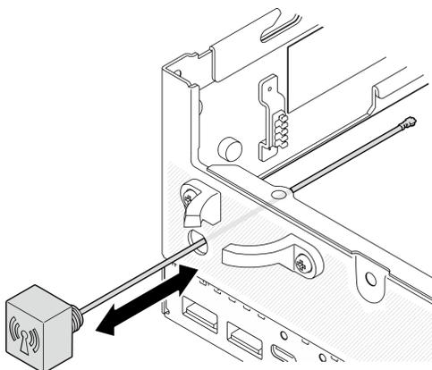
Figura 100. Removendo a antena Bluetooth
