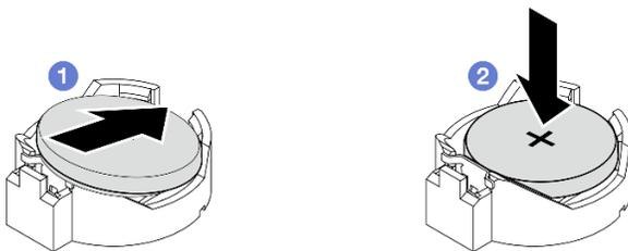
Figura 121. Instalando a bateria do CMOS
