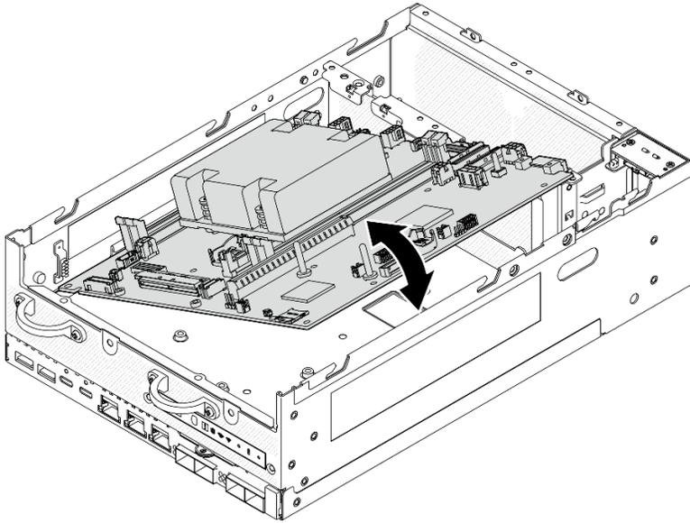
*Figura 274. Instalando a placa-mãe*
