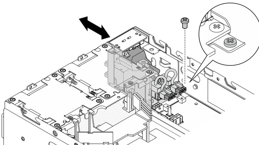
Figura 204. Instalando o módulo PIB
