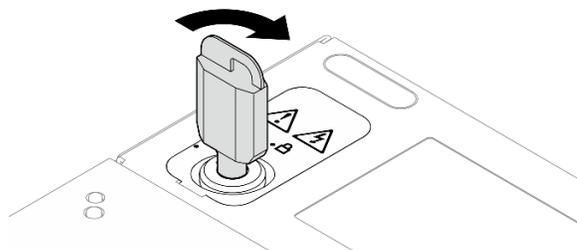
Figura 195. Travando a fechadura
