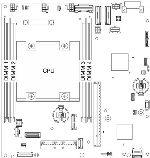
Figura 1. Layout de módulos de memória e processadores
