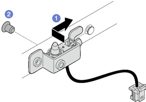
Figura 146. Instalando a chave de intrusão com cabo
