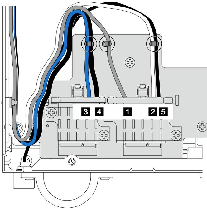
Figura 330. Roteamento de cabos do adaptador sem fio
