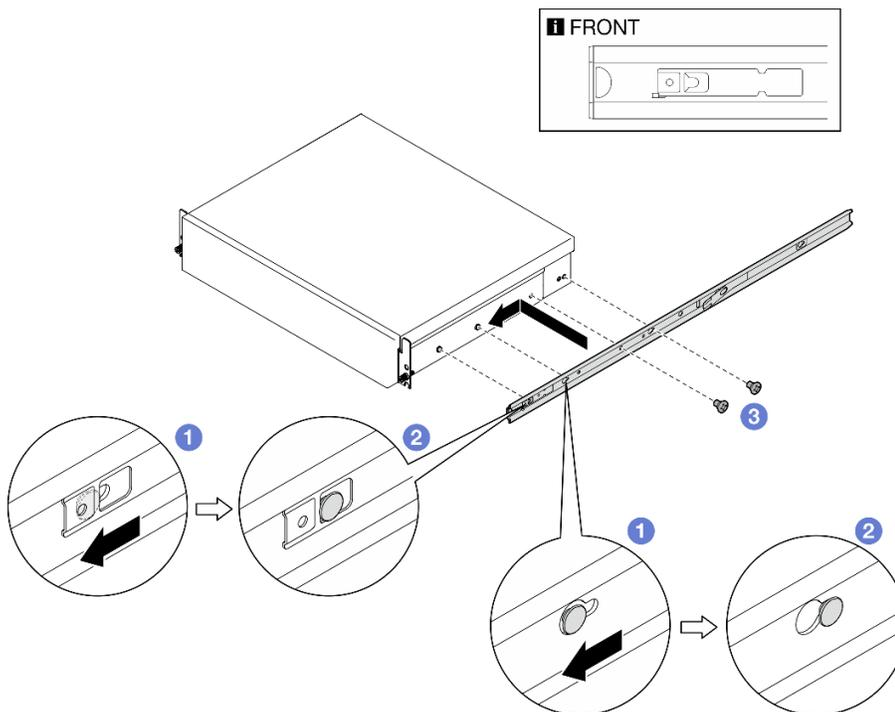
Figura 16. Instalando o trilho interno
