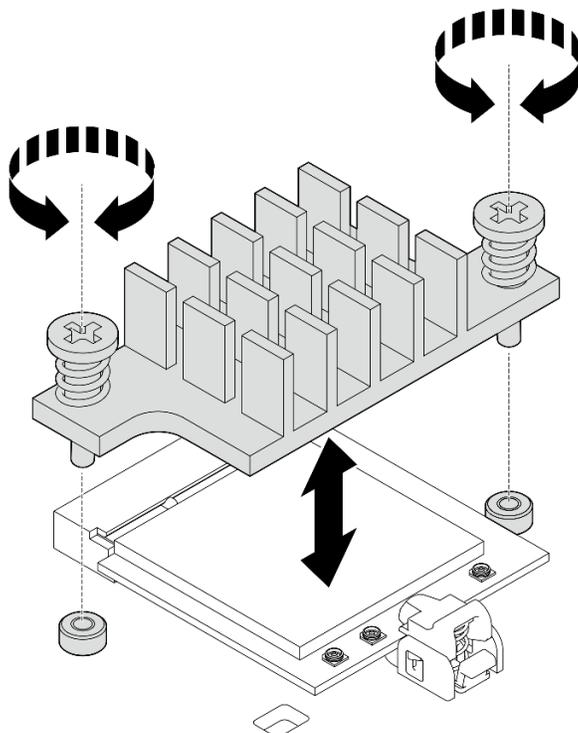
Figura 281. Removendo o dissipador de calor do módulo WLAN/Bluetooth
