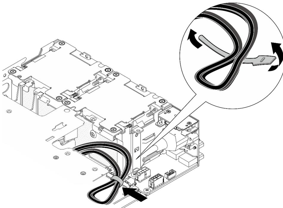
Figura 269. Roteamento de cabos do conjunto de placa riser
