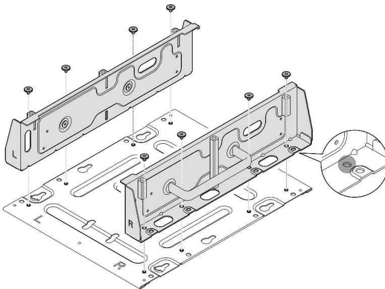
*Figura 38. Desmontando o suporte do nó*
