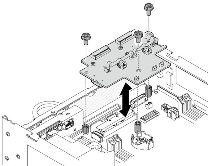
Figura 110. Instalando o adaptador sem fio
