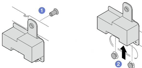
Figura 311. Removendo o preenchimento SMA
