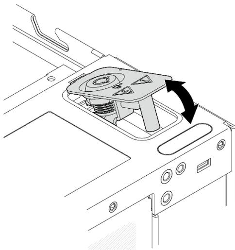
Figura 171. Instalando a fechadura de segurança do sistema
