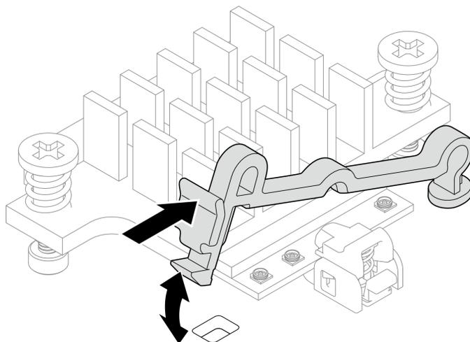
Figura 328. Levantando o retentor de cabo
