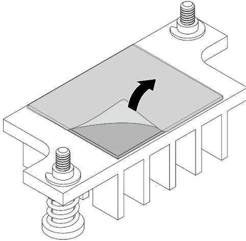
Figura 288. Removendo o filme do painel térmico
