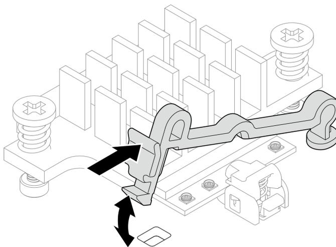
*Figura 98. Inserindo o retentor do cabo*
