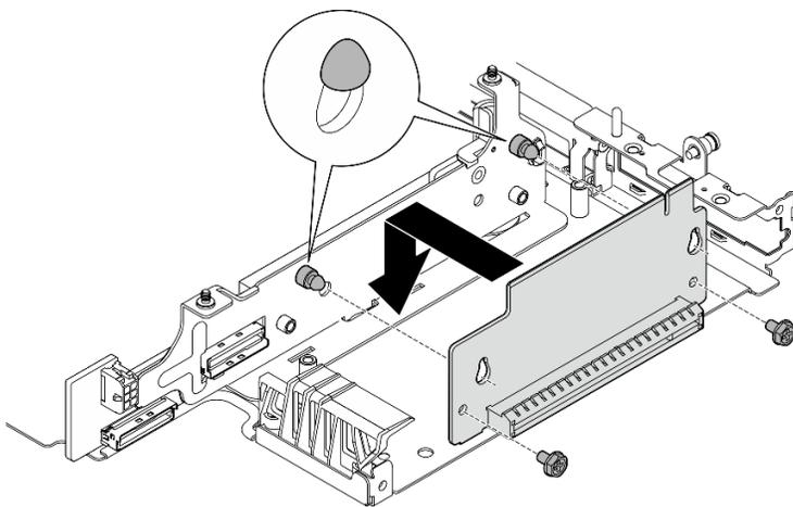
Figura 244. Instalando a placa riser
