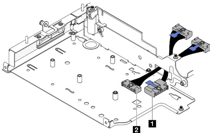
Figura 247. Cabo de sinal do adaptador cabeado M.2
