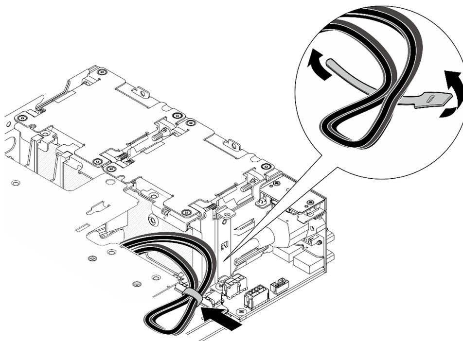
Figura 262. Roteamento de cabos do conjunto de placa riser
