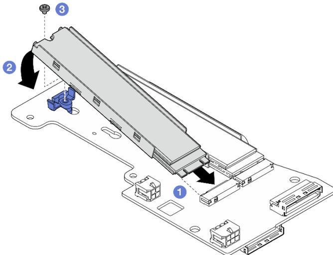
Figura 116. Instalando uma unidade M.2
