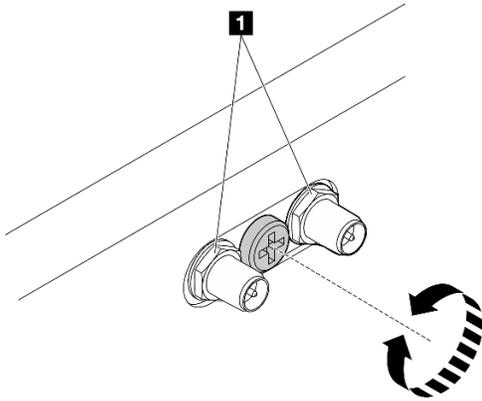
Figura 39. Encurtando os conectores da SMA
