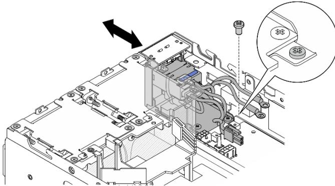
Figura 206. Instalando o módulo PIB
