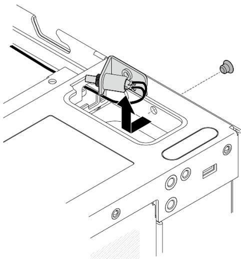
Figura 168. Removendo a chave de posição travada com cabo
