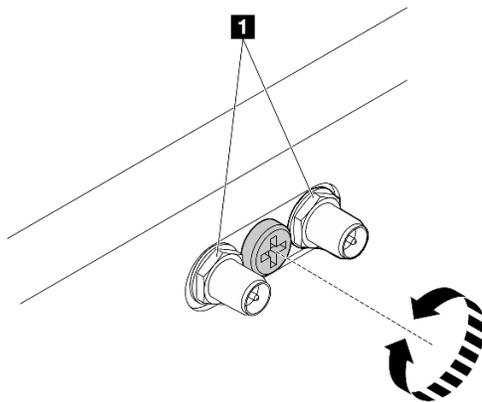
Figura 299. Encurtando os conectores da SMA
