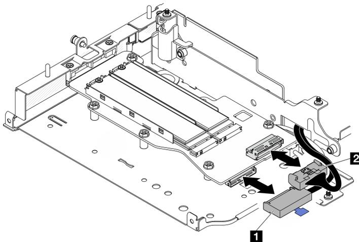
Figura 224. Desconectando o cabo de sinal
