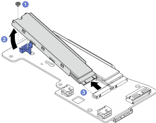
Figura 226. Removendo uma unidade M.2
