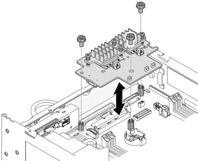
Figura 93. Levantando o adaptador sem fio
