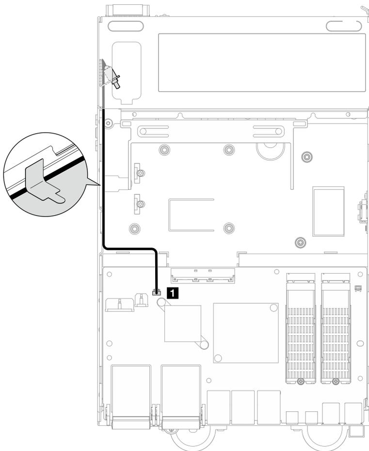
Figura 167. Roteamento de cabos da chave de posição travada
