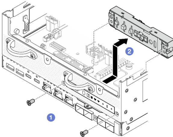
Figura 130. Removendo o painel frontal do operador
