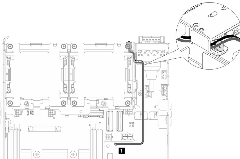
Figura 200. Cabo de LED de status da PMB conectado à placa do módulo de energia CC (DC PMB)
