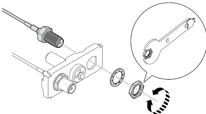
Figura 325. Fixando dos cabos ao suporte
