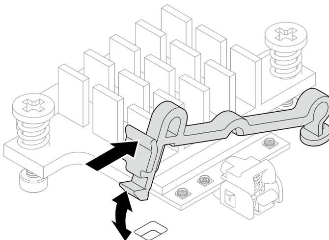
Figura 333. Inserindo o retentor do cabo
