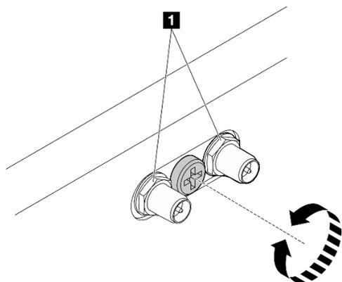
Figura 52. Encurtando os conectores da SMA
