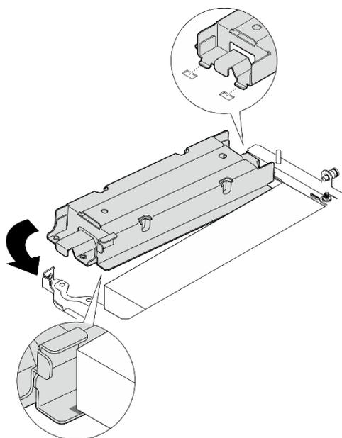
Figura 256. Instalando a gaiola de módulo de rastreamento geográfico
