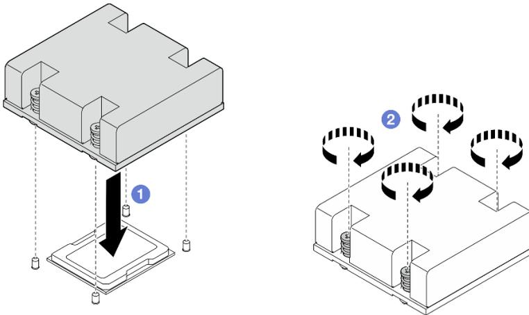
Figura 219. Instalando o dissipador de calor do processador
