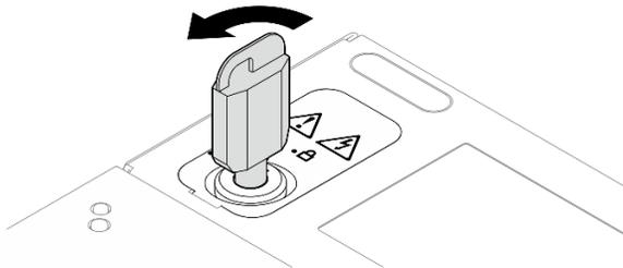
*Figura 187. Destravando a fechadura*
