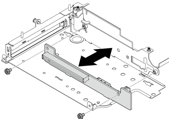
Figura 250. Instalando a placa riser
