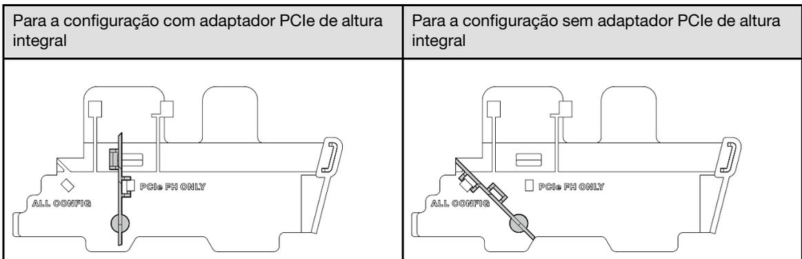
Etapa 4. Alinhe a parte frontal do conjunto da placa riser com a borda do chassi; em seguida, abaixe o conjunto da placa riser para o nó.
