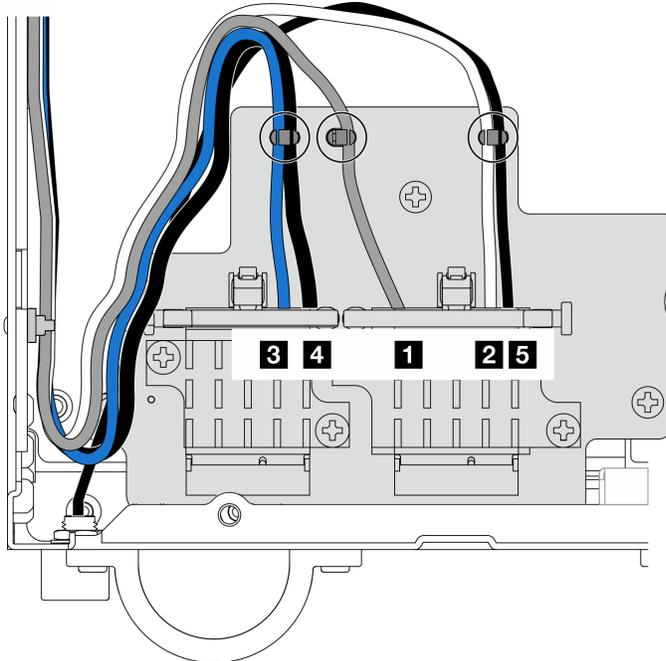
Figura 343. Roteamento de cabos das antenas WLAN e Bluetooth
