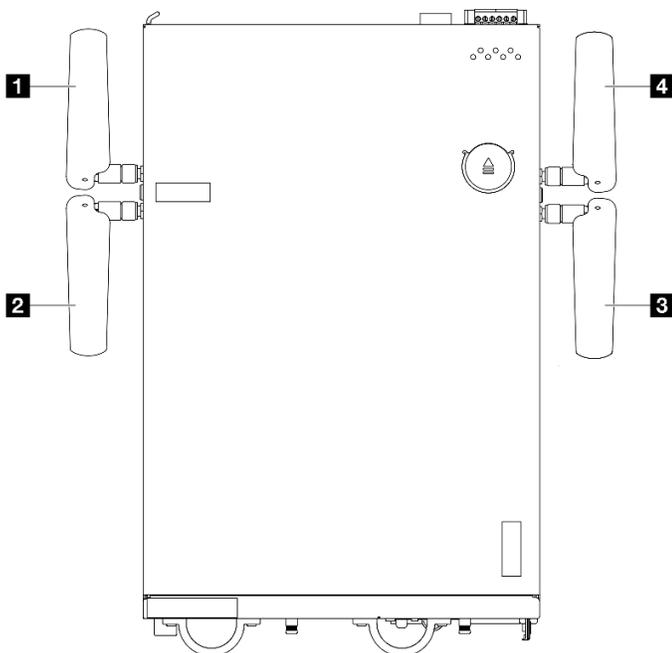
Figura 295. Locais das antenas WLAN
