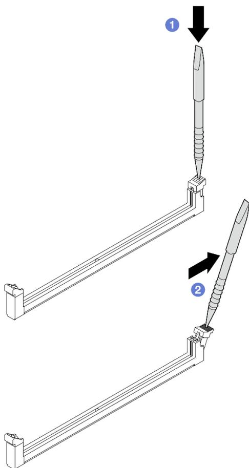
Figura 177. Abrindo o clipe de retenção
