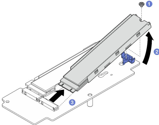
Figura 238. Removendo uma unidade M.2
