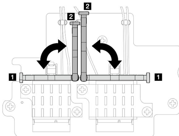
Figura 97. Girando o retedor do cabo
