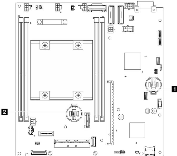
Figura 120. Localizações da bateria CMOS na placa-mãe
