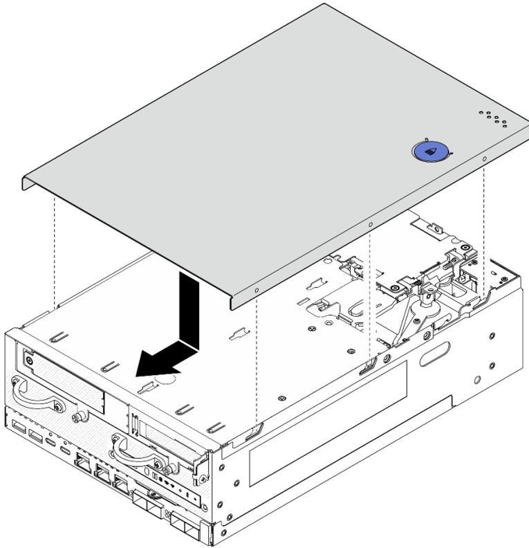
Figura 188. Instalando a tampa superior
