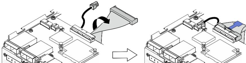
Figura 161. Conectando os cabos da placa de E/S
