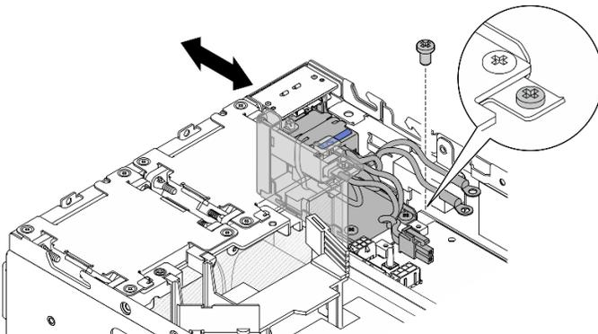
Figura 203. Removendo o módulo AC PIB
