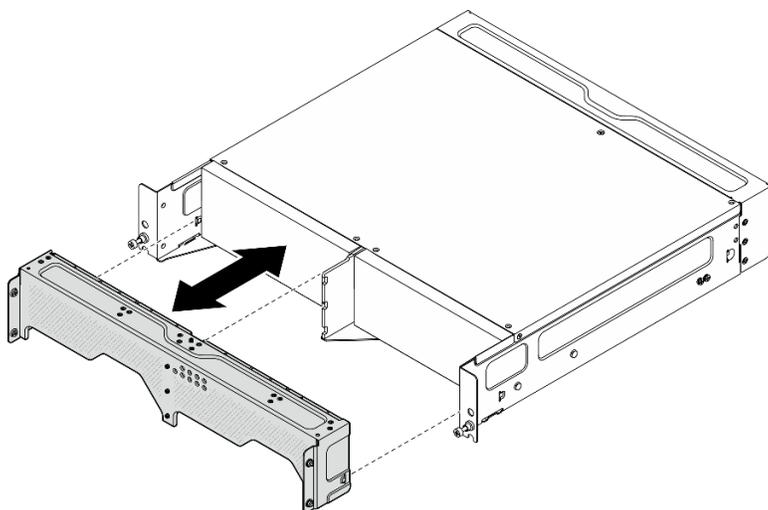
Figura 70. Instalando o suporte de remessa
