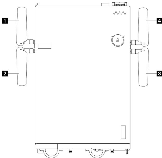
Figura 352. Locais das antenas WLAN
