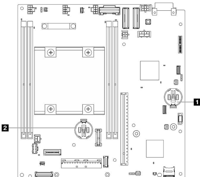
Figura 117. Localizações da bateria CMOS na placa-mãe
