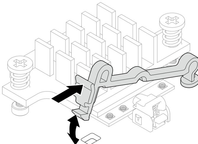
Figura 316. Inserindo o retentor do cabo
