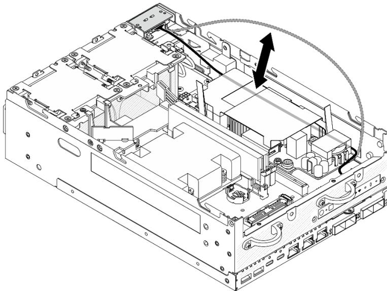
*Figura 132. Colocando o cabo de sinal*
