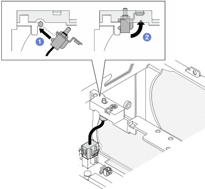
Figura 124. Instalando a chave de intrusão com cabo
