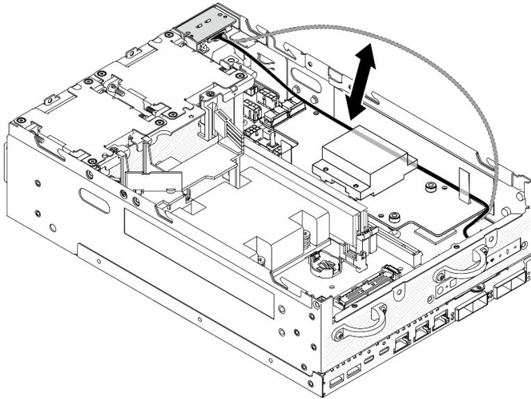
Figura 211. Colocando o cabo de sinal
