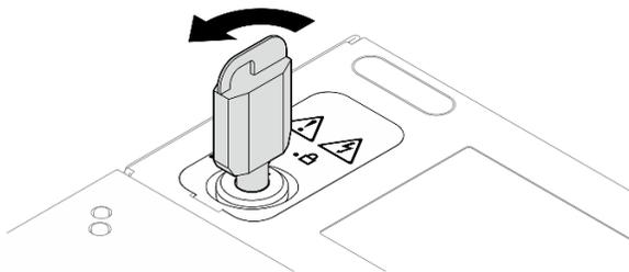
Figura 193. Destravando a fechadura
