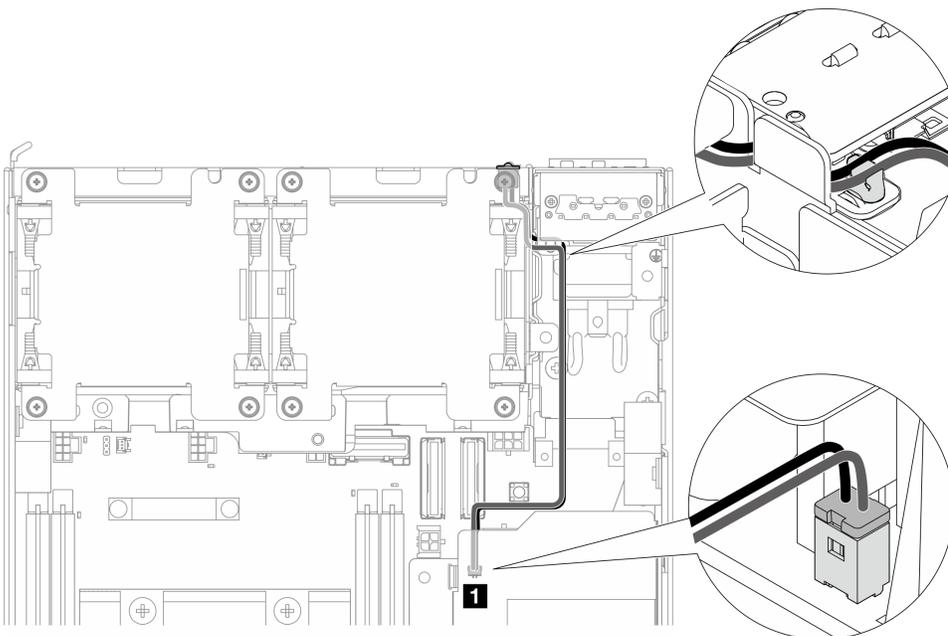
Figura 197. Cabo de LED de status da PMB conectado à unidade de fonte de alimentação interna (AC PMB)
