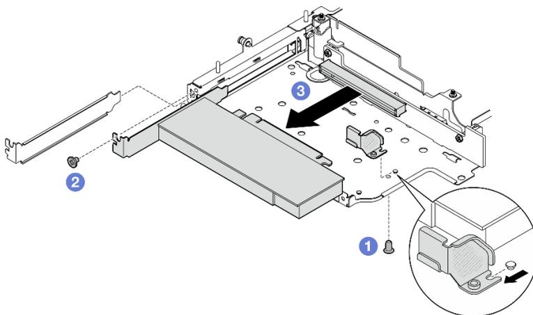
Figura 227. Removendo o adaptador PCIe
