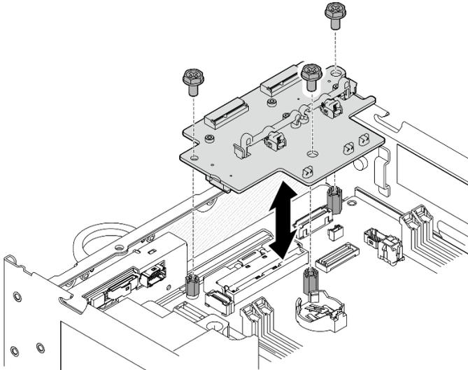
Figura 283. Removendo o adaptador sem fio
