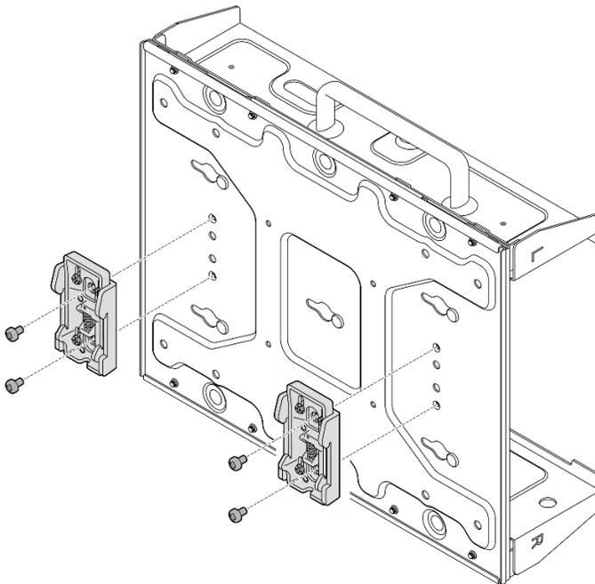
Figura 63. Instalando as presilhas do trilho DIN
