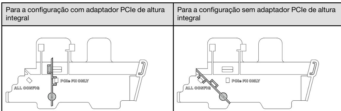
Etapa 3. Alinhe a parte frontal do conjunto da placa riser com a borda do chassi; em seguida, abaixe o conjunto da placa riser para o nó.
