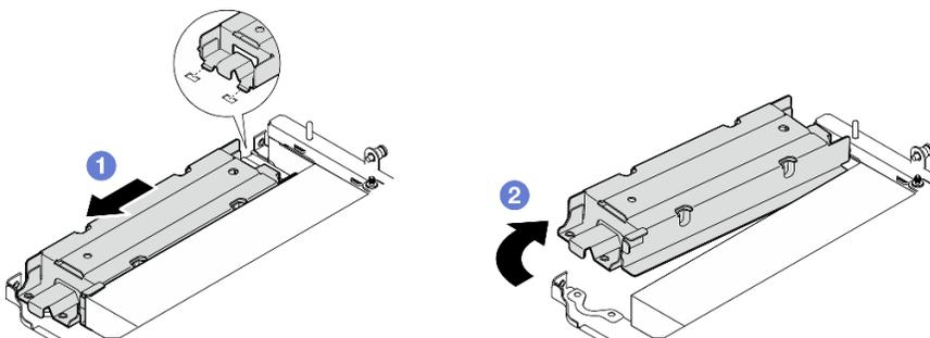
Figura 233. Removendo a gaiola de módulo de rastreamento geográfico
