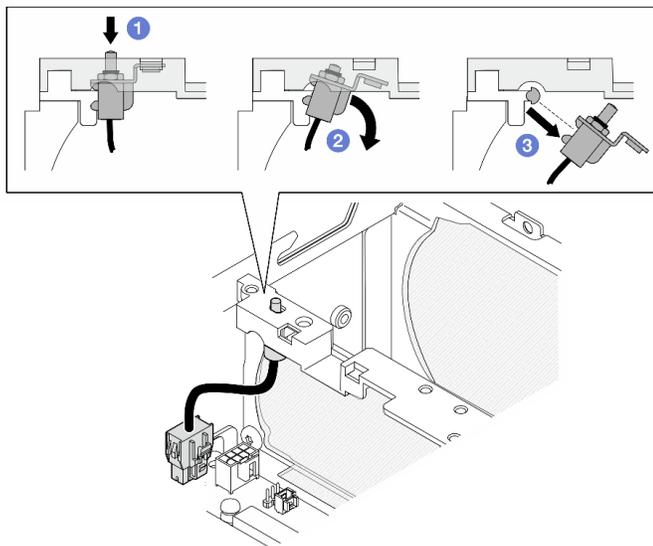
Figura 123. Removendo a chave de direção do ventilador
