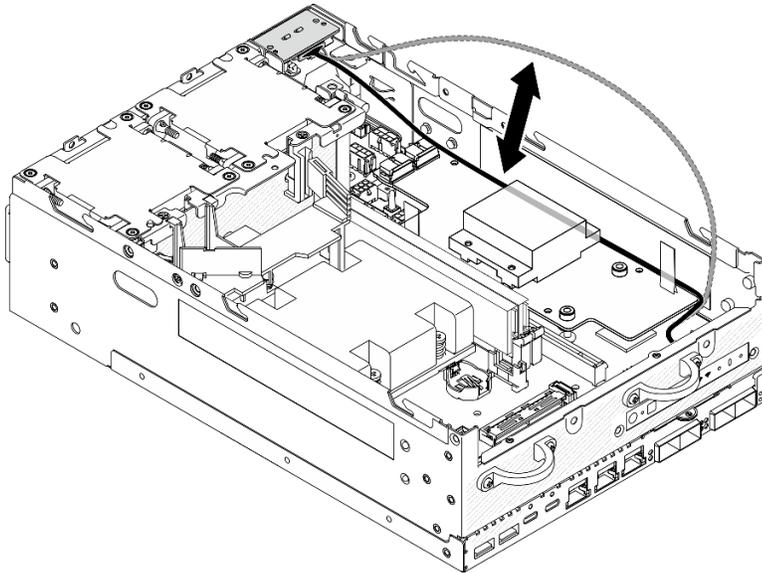
Figura 207. Colocando o cabo de sinal
