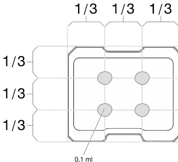
Figura 218. Formato adequado da graxa térmica
