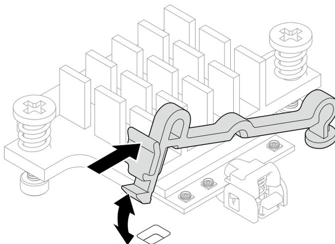
Figura 305. Inserindo o retentor do cabo
