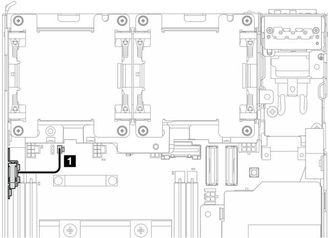
Figura 142. Roteamento de cabos da chave de intrusão superior
