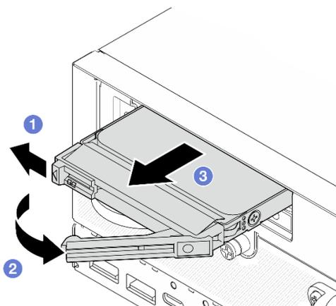
Figura 77. Removendo uma unidade de 7 mm
