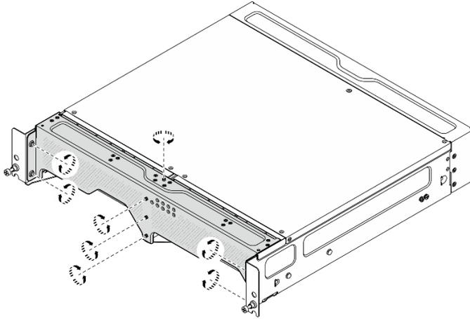
Figura 71. Apertando os parafusos
