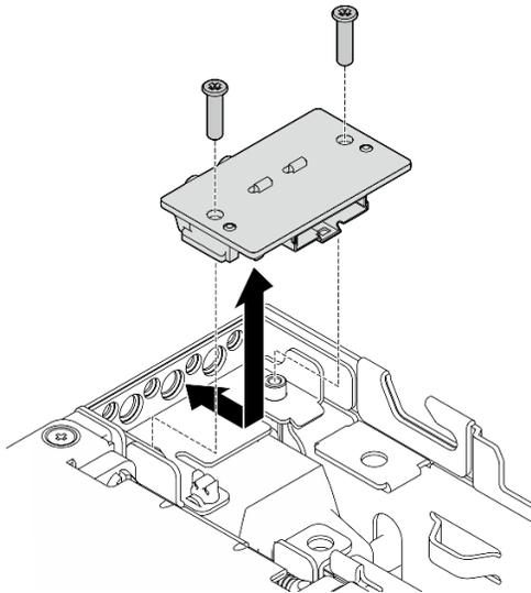
Figura 220. Removendo o painel traseiro do operador
