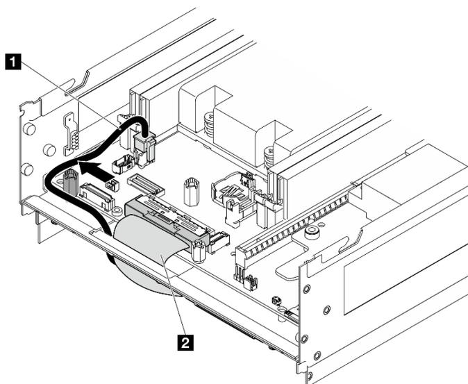
Figura 157. Roteamento de cabos da placa de E/S
