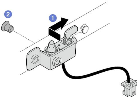
Figura 152. Instalando a chave de intrusão com cabo
