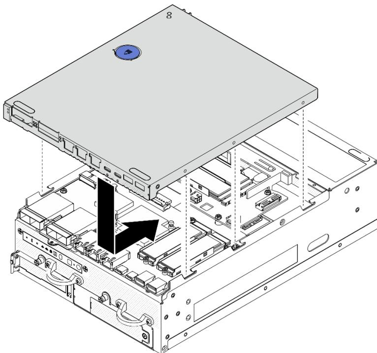
Figura 194. Instalando a tampa inferior
