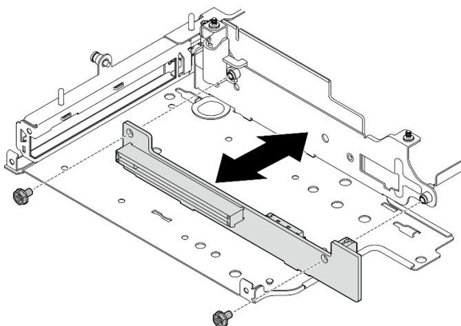
Figura 228. Removendo a placa riser
