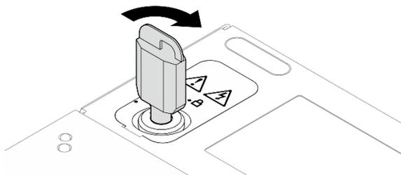
Figura 186. Travando a fechadura
