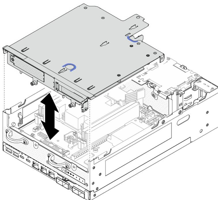
Figura 263. Abaixando o conjunto de placa riser
