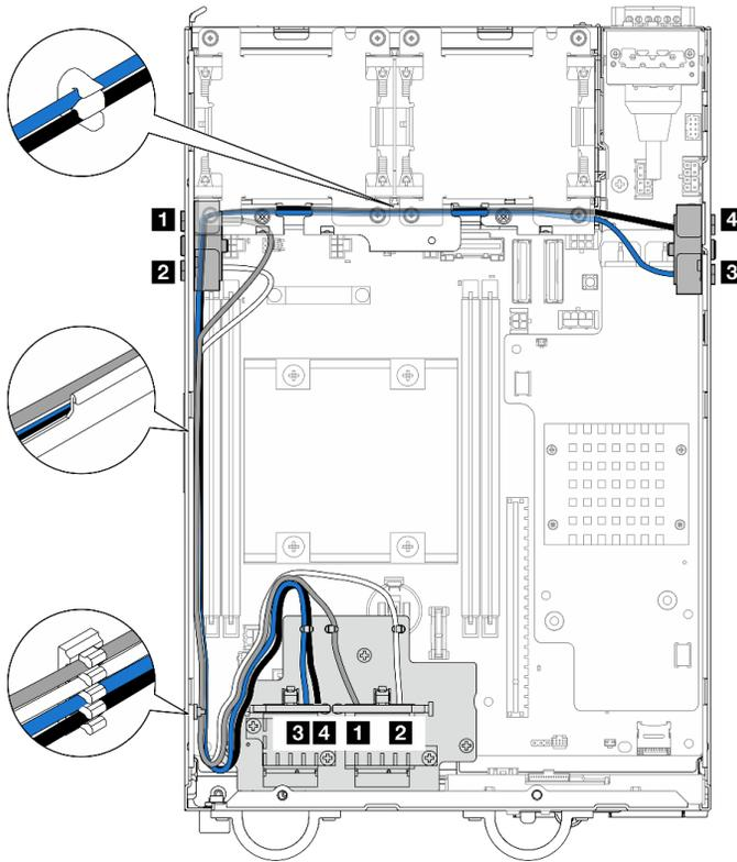
Figura 327. Roteamento de cabos dos conjuntos SMA
