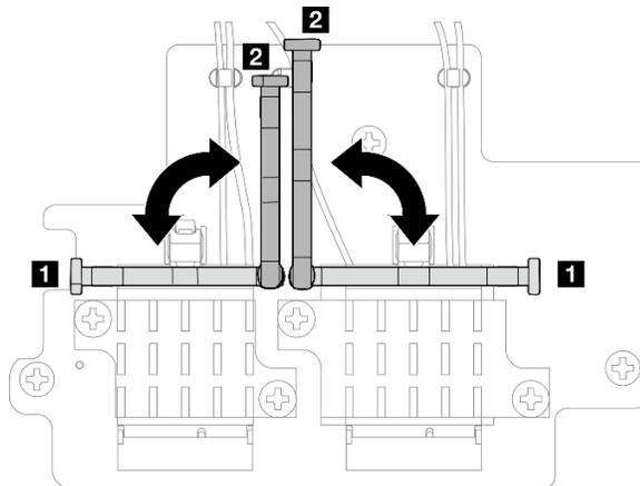
Figura 332. Girando o retentor do cabo
