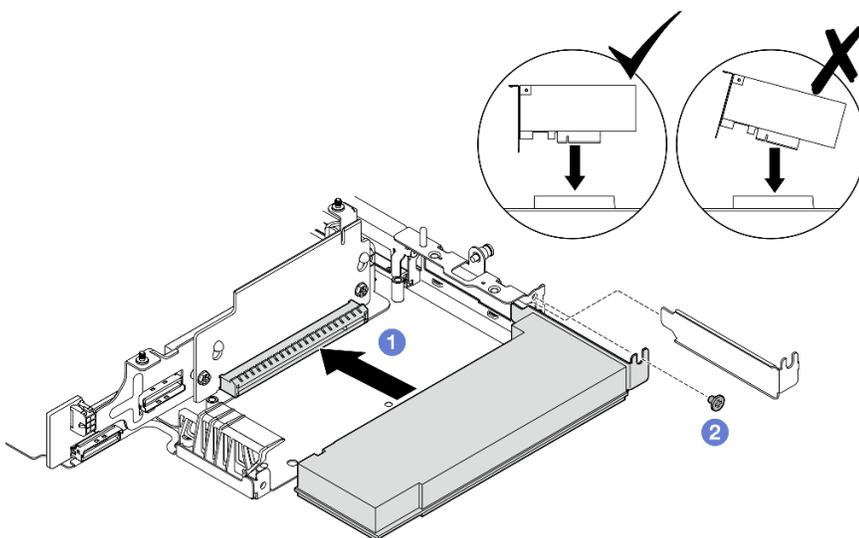
Figura 245. Instalando o adaptador PCIe
