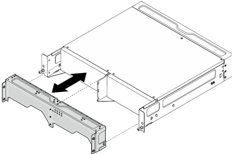
Figura 24. Instalando o suporte de remessa
