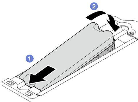
Figura 259. Instalando a módulo de rastreamento geográfico
