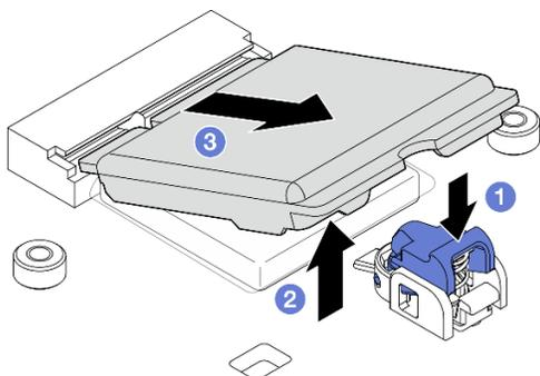
Figura 285. Removendo a tampa simulada
