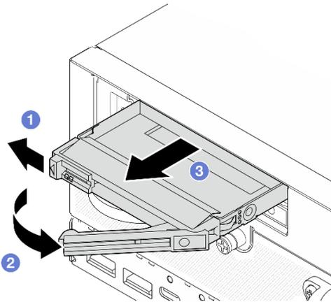
Figura 78. Removendo um preenchimento de unidade
