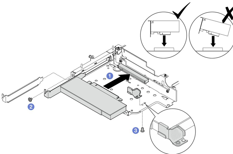
Figura 251. Instalando o adaptador PCIe
