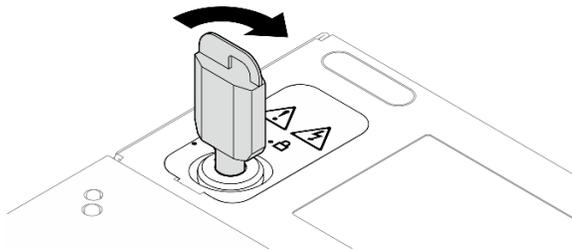
Figura 192. Travando a fechadura
