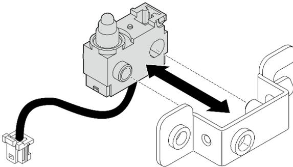
Figura 144. Separando a chave de intrusão do suporte
