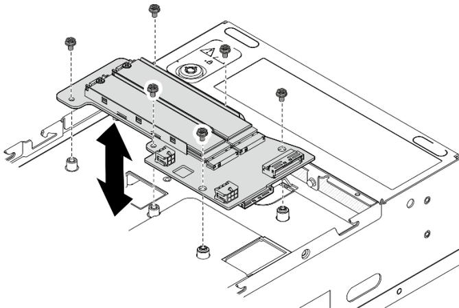
Figura 115. Instalando o adaptador cabeado M.2 inferior
