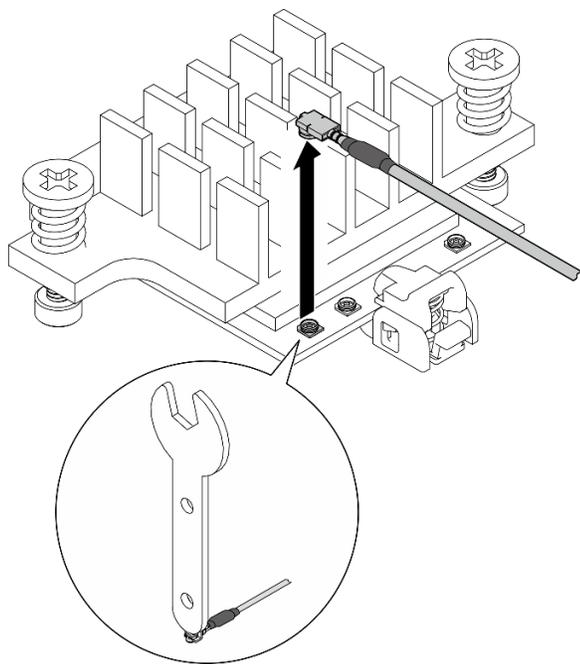
Figura 96. Desconectando o cabo
