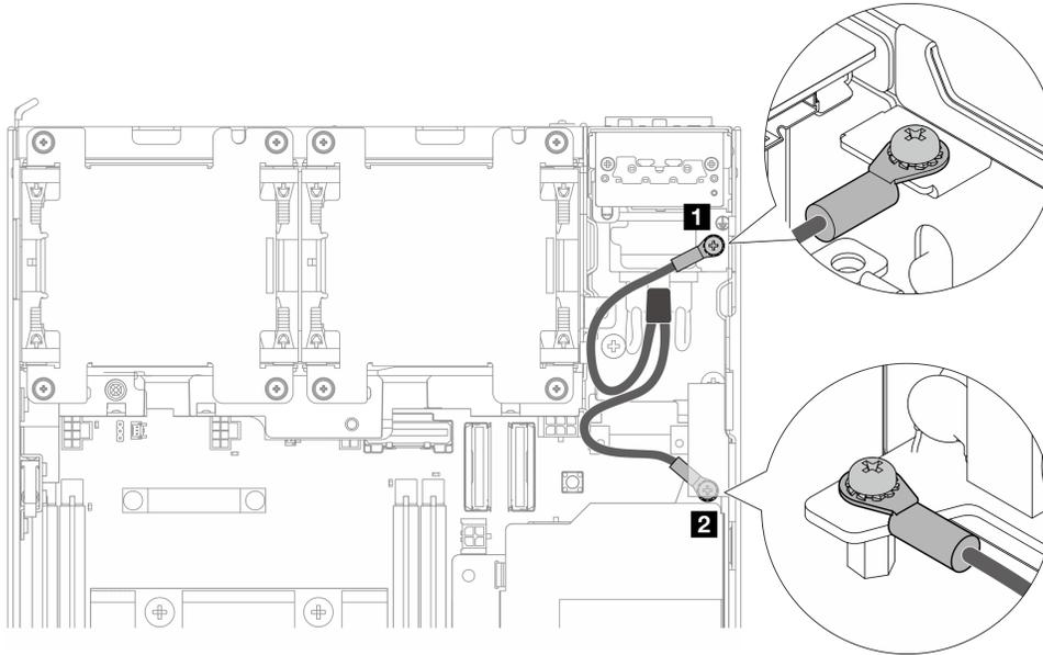
Figura 140. Conectando o cabo de aterramento
