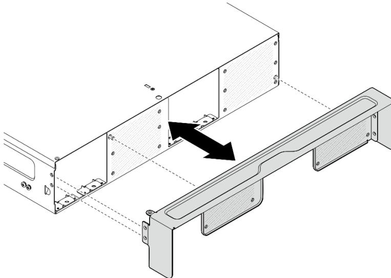
Figura 11. Removendo o suporte de remessa
