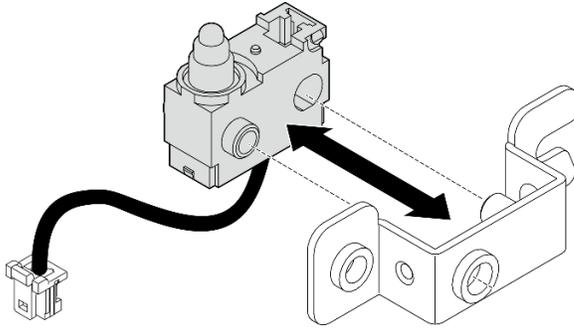
Figura 150. Separando a chave de intrusão do suporte
