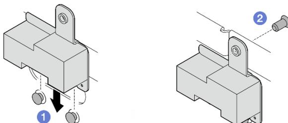
Figura 321. Instalando o preenchimento da SMA
