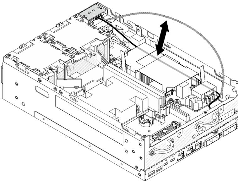
Figura 141. Colocando o cabo de sinal
