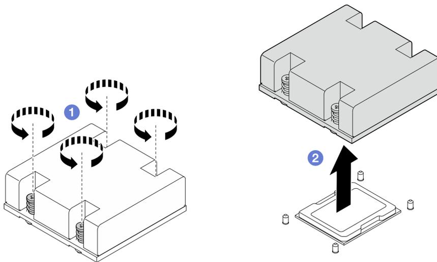
Figura 217. Removendo o dissipador de calor do processador
