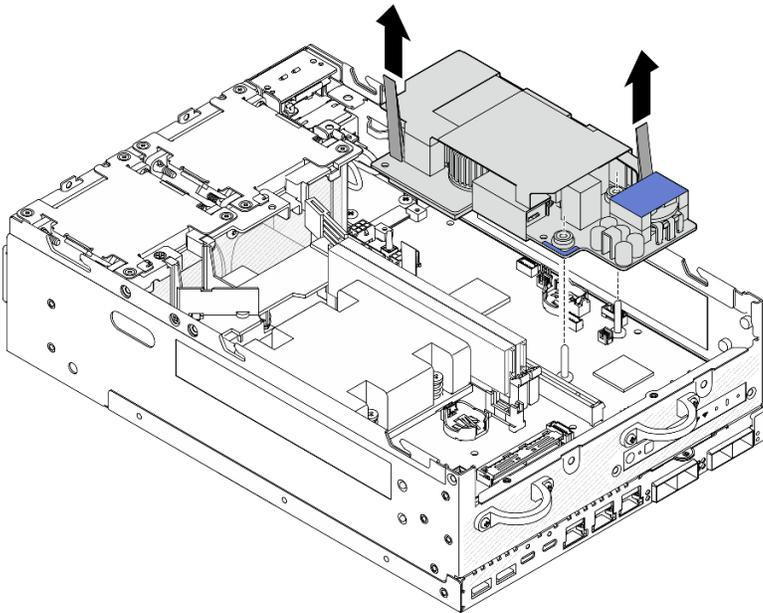
Figura 136. Removendo a unidade da fonte de alimentação interna
