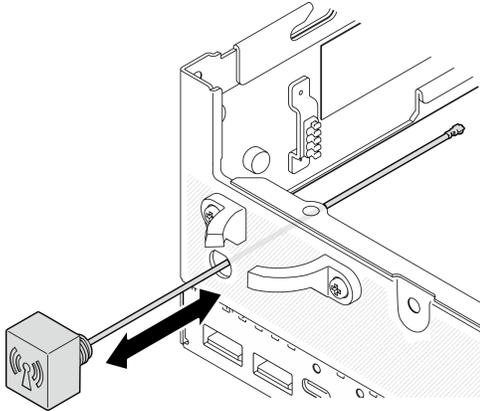
Figura 103. Instalando a antena Bluetooth
