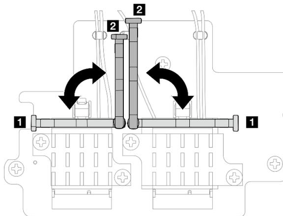
Figura 329. Girando o retentor do cabo
