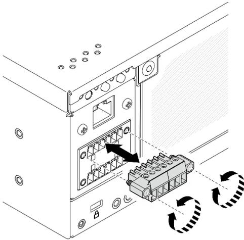
Figura 339. Instalando o cabeçote
