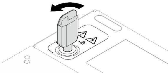
Figura 184. Destravando a fechadura
