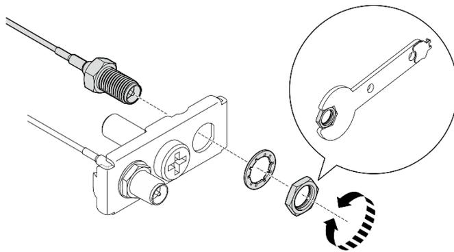
Figura 319. Soltando os cabos do suporte
