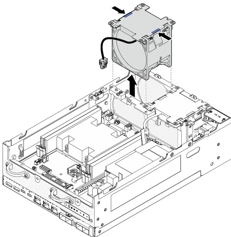
Figura 127. Removendo o módulo de ventilador
