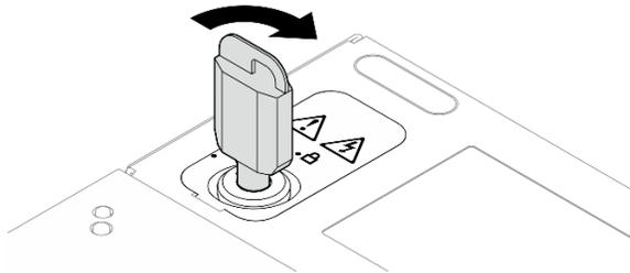
Figura 189. Travando a fechadura
