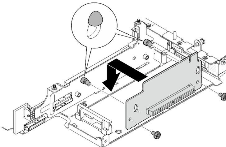
Figura 242. Instalando a placa riser
