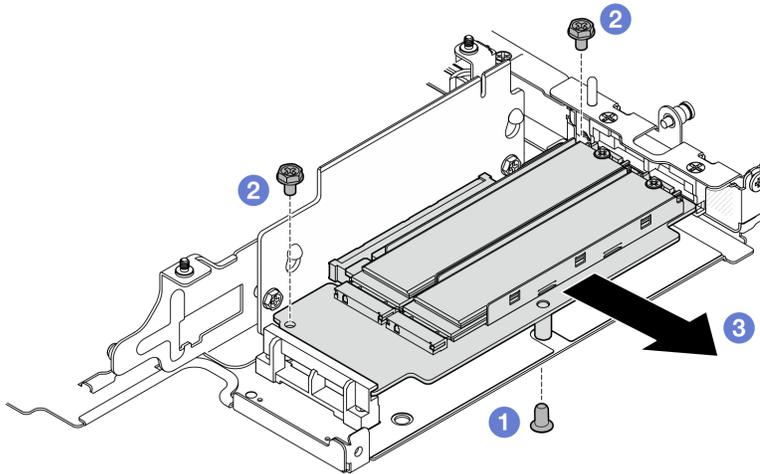
Figura 236. Removendo o adaptador M.2
