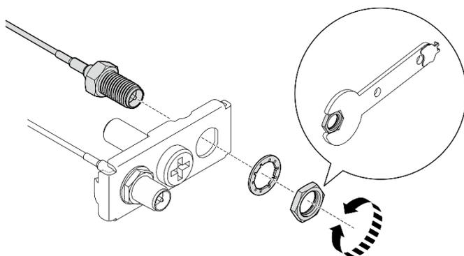
Figura 308. Soltando os cabos do suporte
