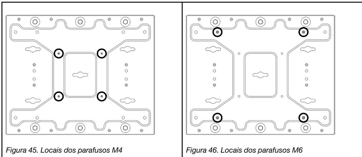
Figura 45. Locais dos parafusos M4
