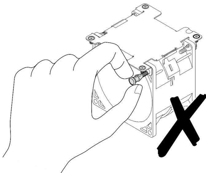
**NÃO** desmonte o módulo do ventilador. Tentar desmontar o módulo do ventilador pode causar danos aos componentes.
