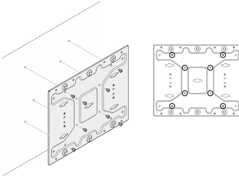
Figura 29. Removendo a placa de montagem na parede
