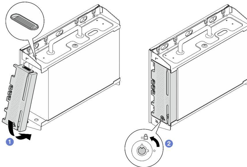
Figura 49. Instalando o painel de segurança
