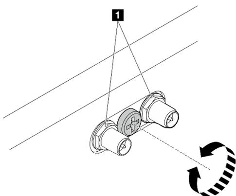
Figura 30. Encurtando os conectores da SMA
