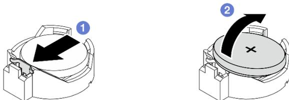
Figura 138. Removendo a bateria CMOS
