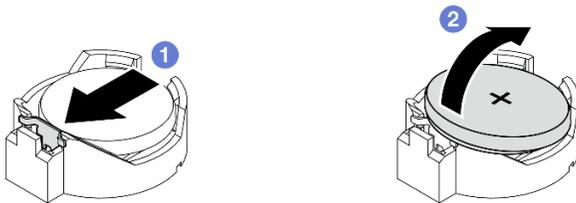
Figura 139. Removendo a bateria CMOS
