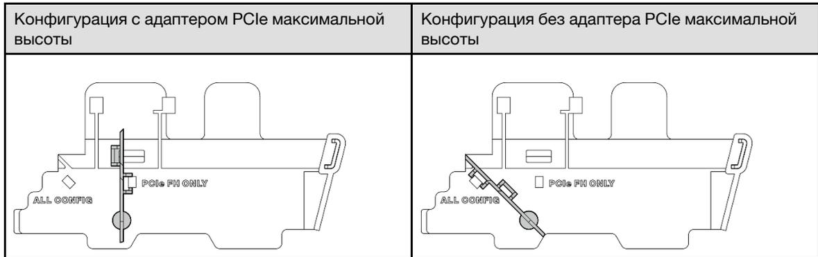
Шаг 3. Совместите переднюю часть блока платы-адаптера Riser с краем рамы; затем опустите блок платы-адаптера Riser в узел.
