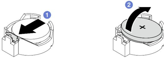
Рис. 118. Снятие батарейки CMOS
