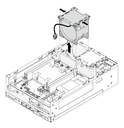
Figure 129. Removing the fan module
