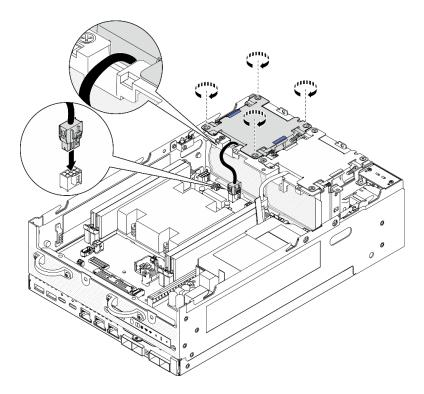
Figure 131. Installing the fan module
