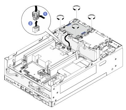
Figure 128. Removing the fan module
