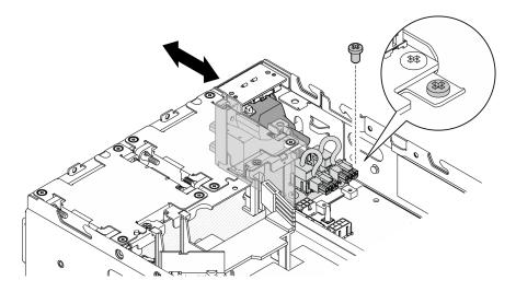
Figure 206. Installing the PIB module
