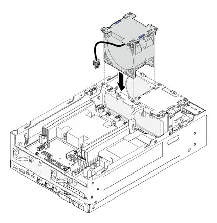
Figure 130. Installing the fan module
