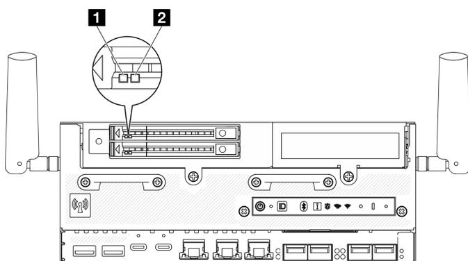
圖例 15. 硬碟 LED
