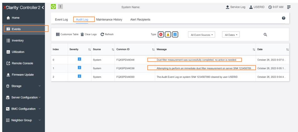
圖例 28. 灰塵過濾器測量事件
