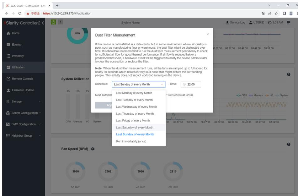
圖例 27. 灰塵過濾器測量設定
