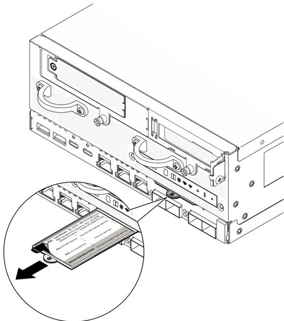
圖例 24. 拉出式資訊標籤上的 Lenovo XClarity Controller 網路存取標籤
