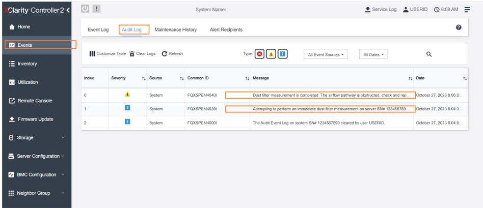
圖例 29. 灰塵過濾器測量事件
