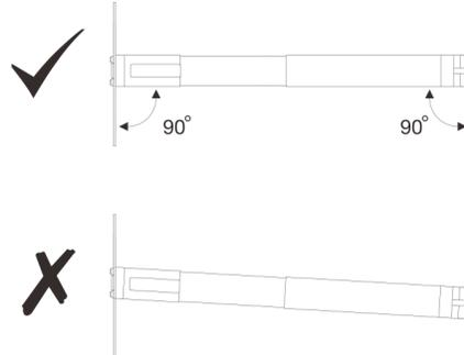
Schritt 2. Öffnen Sie die vordere Montagehalterung und richten Sie die vorderen Stifte der äußeren Schiene an den Bohrungen im Rack aus. Ziehen Sie die äußere Schiene in die angezeigte Richtung, bis die Stifte in den entsprechenden Bohrungen sitzen.
