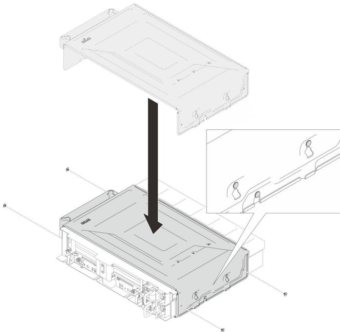
Schritt 3. Halten Sie die Baugruppe am oberen Griff und senken Sie sie in den Bodenständer. Befestigen Sie dann jede Seite der Baugruppe mit zwei **großen** M3-Schrauben am Server.
