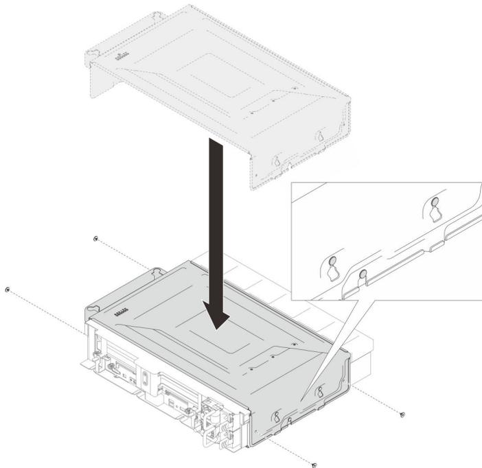
Paso 3. Sostenga el asa superior y baje el conjunto al soporte del piso. A continuación, fije cada lado del conjunto al soporte del servidor con dos tornillos M3 **grandes**.
