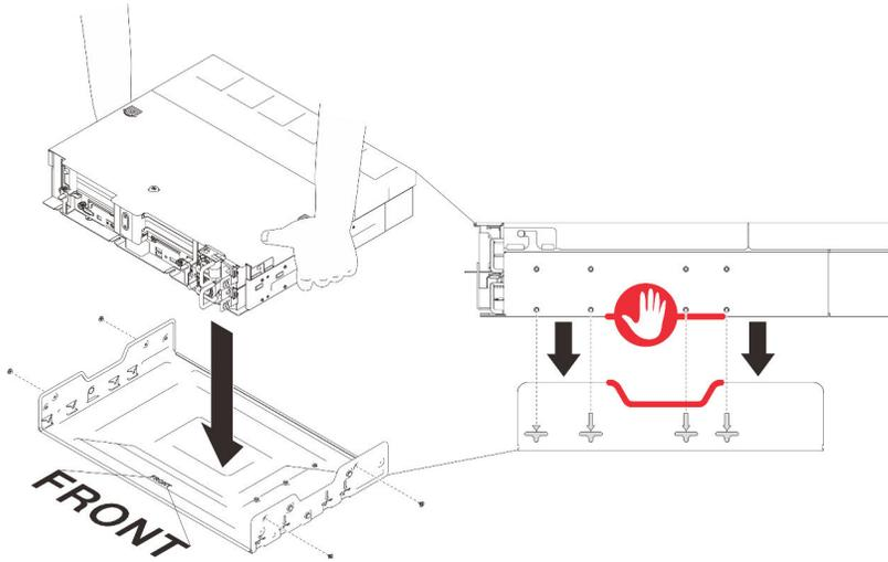
**Nota:** Asegúrese de sostener la parte central de ambos lados del servidor para evitar lesiones.
