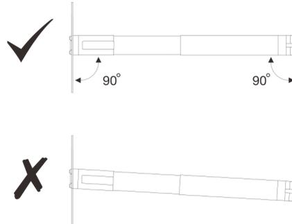
Étape 2. Ouvrez le support de montage avant et alignez les broches avant de la glissière externe sur les trous de l'armoire. Tirez la glissière externe comme indiqué, jusqu'à ce que les broches soient insérées dans les trous correspondants.
