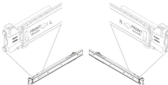
랙에 뒷면 마운팅 브래킷 설치: 1단계. 바깥쪽 레일의 뒤쪽 끝에 있는 핀을 랙 뒷면의 구멍에 맞추십시오. 2단계. 레일을 살짝 옆으로 움직여 뒷면 마운팅 브래킷을 프레임에 건 다음, 그림과 같이 바깥쪽 레일을 바깥쪽으로 미십시오. 3단계. 핀이 랙의 해당 구멍에 삽입될 때까지 레일을 밀어 넣으십시오. 4단계. 바깥쪽 레일의 뒤쪽 끝이 자동으로 제자리에 잡깁니다.
