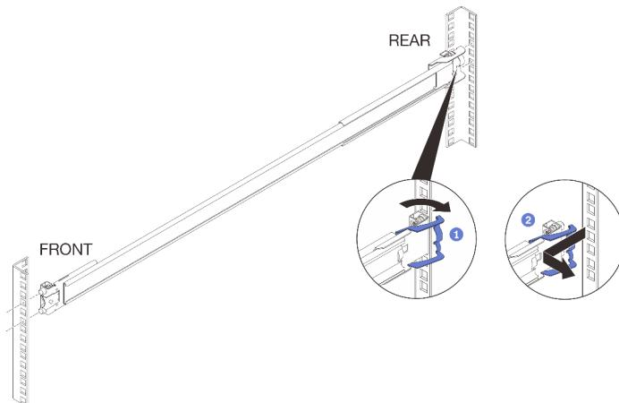
**Повторите предыдущие действия, чтобы снять переднюю и заднюю крепежные скобы другой**
