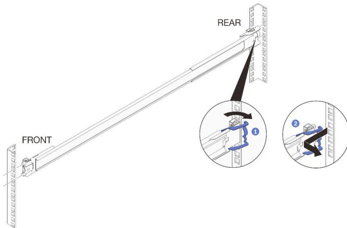
重复上述步骤，卸下另一根导轨的前端和后端安装支架。
