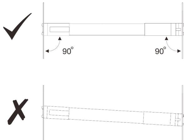
步骤 2. 按所示方向推动外侧导轨，直至将销钉插入相应的孔。
