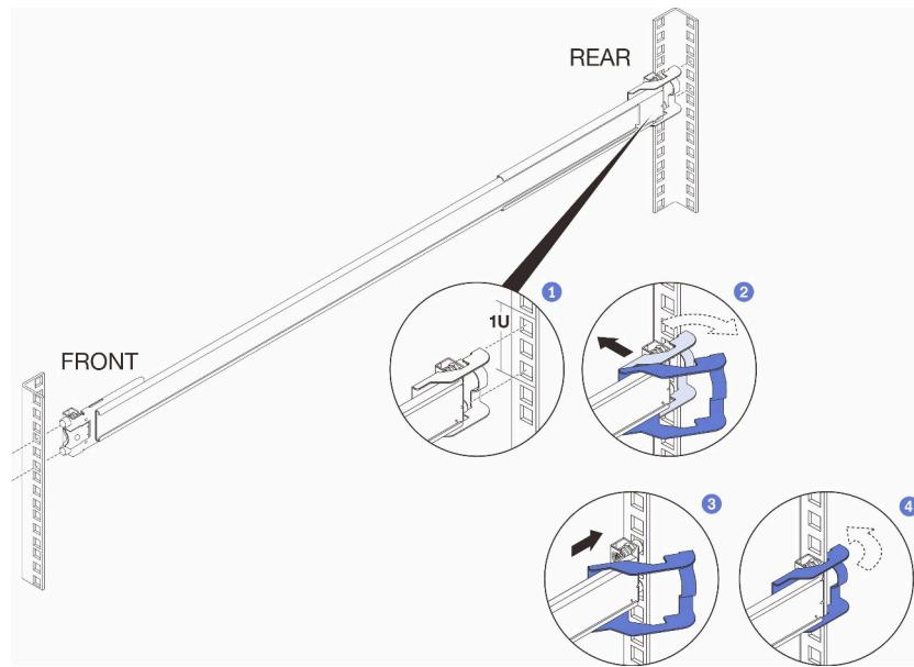
将前端安装支架安装到机架上：
