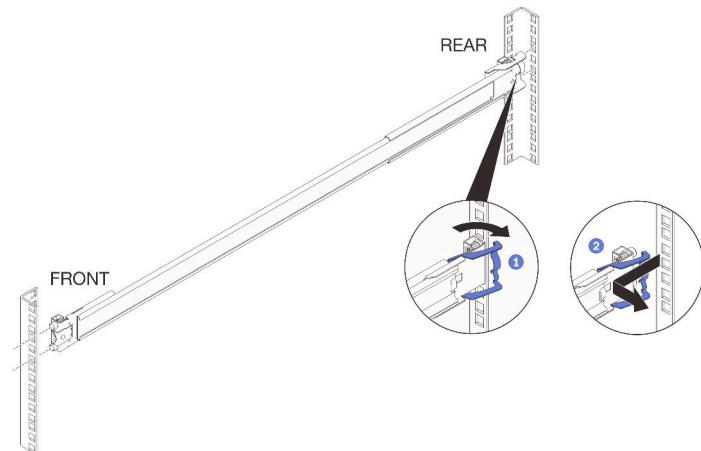
重複上述步驟，卸下另一個滑軌的前裝載托架和後裝載托架。
