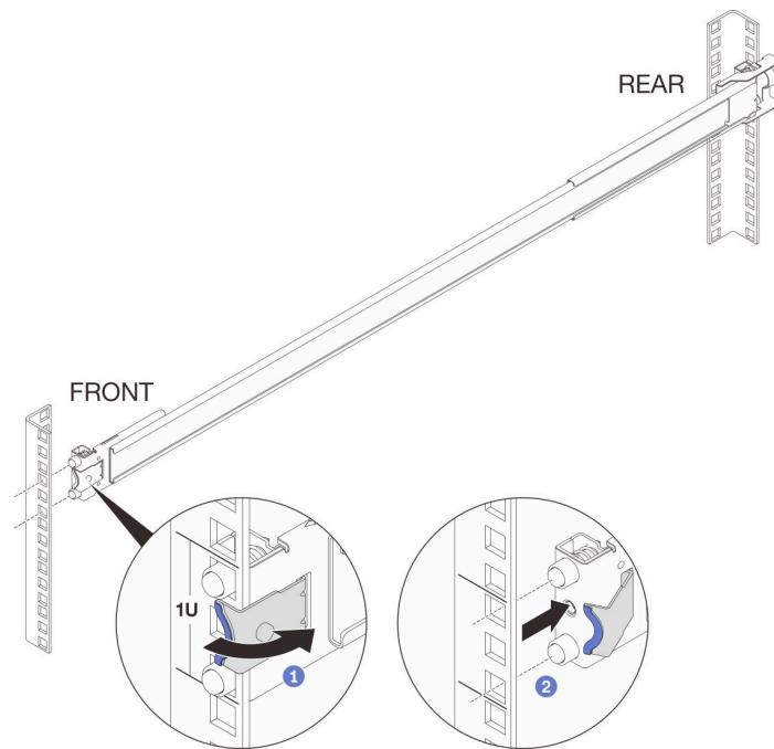
將後裝載托架從機架卸下：步驟 1.打開後裝載托架。步驟 2. 將滑軌稍微移到旁邊，以使插腳從框架上鬆開。如圖所示向外拉動滑軌。
