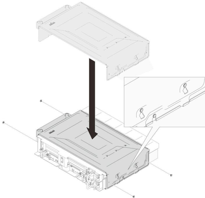
步驟 3. 握住頂部把手，將組件放入落地立架中。然後，將組件兩側固定到伺服器立架上，每一側使用兩個 M3 大螺絲。
