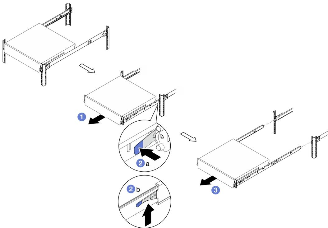
Figura 4. Extracción del servidor del bastidor
