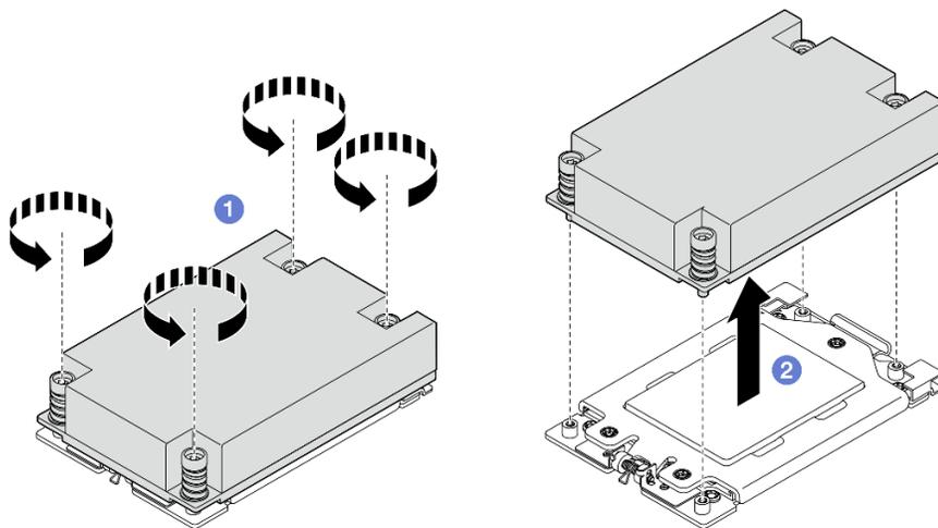
Figura 156. Extracción del disipador de calor de 1U
