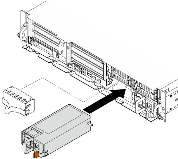
Figura 155. Instalación de una unidad de fuente de alimentación
