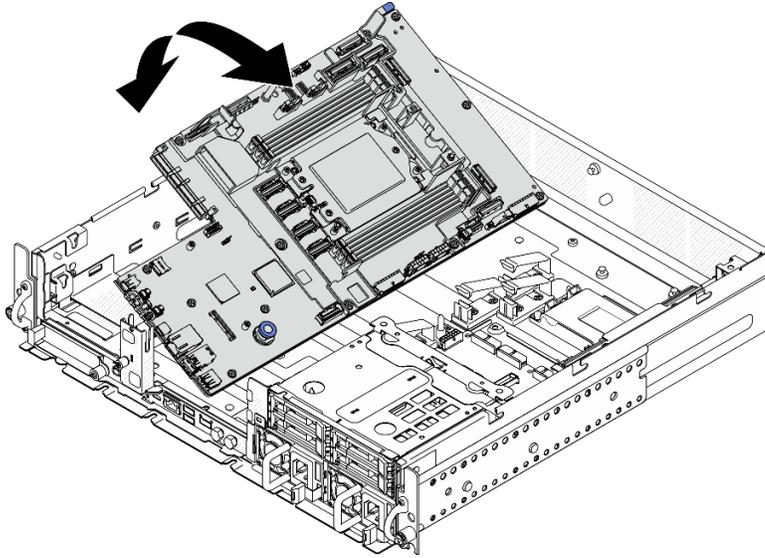
*Figura 188. Instalación de la placa del sistema*
