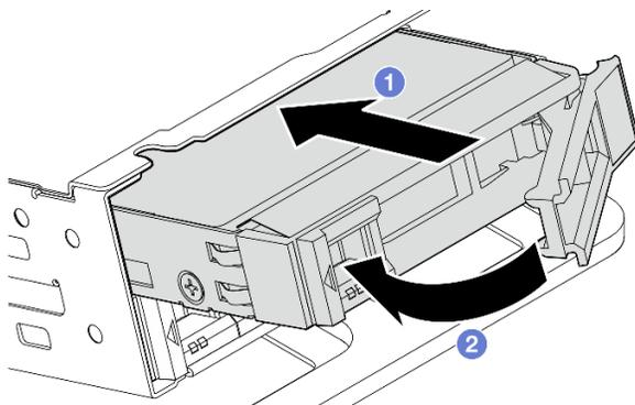
Figura 77. Instalación de una unidad interna
