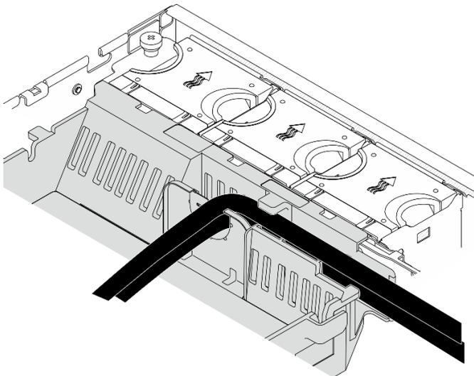
Figura 138. Cables de alimentación de GPU en el deflector de aire del procesador
