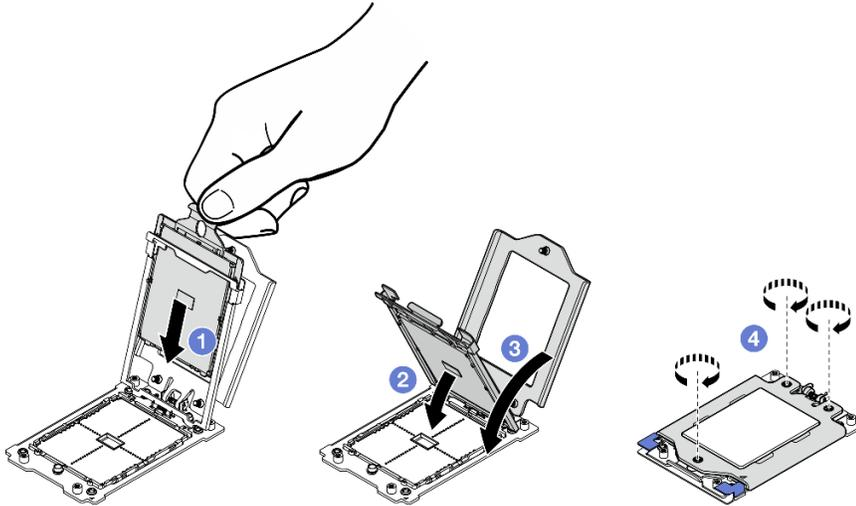
Figura 159. Instalación de un procesador
