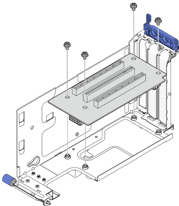
Figura 147. Instalación de la tarjeta de expansión
