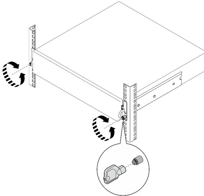
Figura 24. Fijación del servidor en el bastidor: soportes EIA de seguridad
