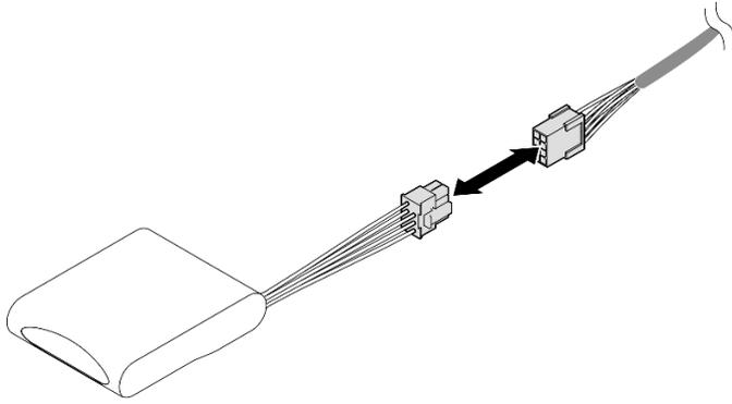
Figura 170. Conexión del cable de extensión
