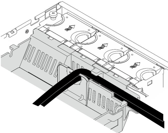
Figura 210. Cables de alimentación de GPU en el deflector de aire del procesador
