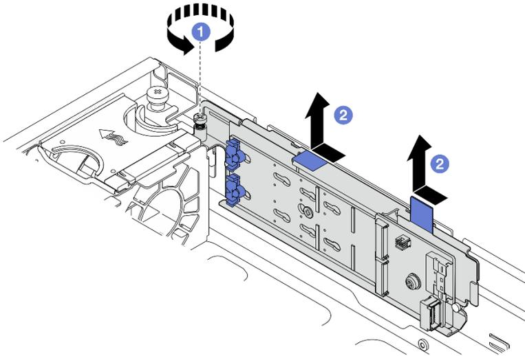
Figura 81. Extracción del conjunto de placas posteriores de M.2
