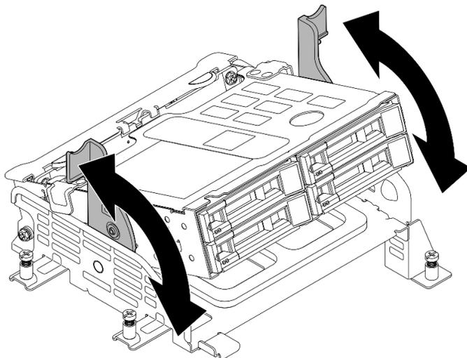
Figura 76. Girar el compartimiento de la unidad interna
