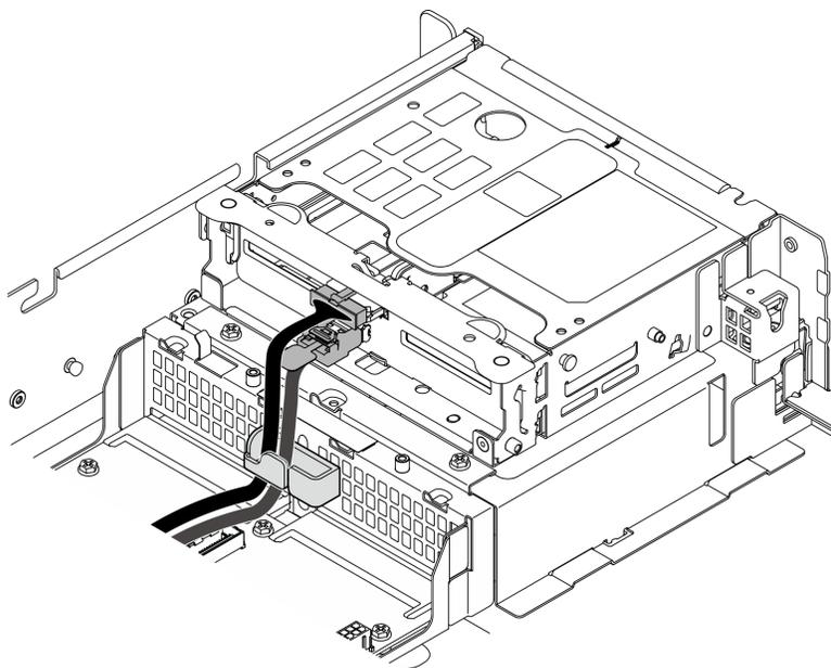
Figura 224. Disposición de los cables de la placa posterior de la unidad frontal
