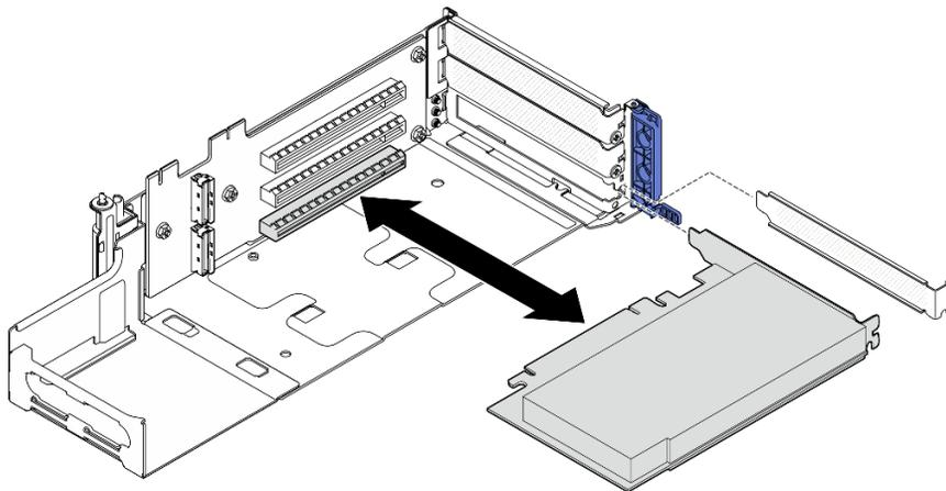
Figura 118. Extracción de un adaptador PCIe del compartimiento de expansión PCIe 1
