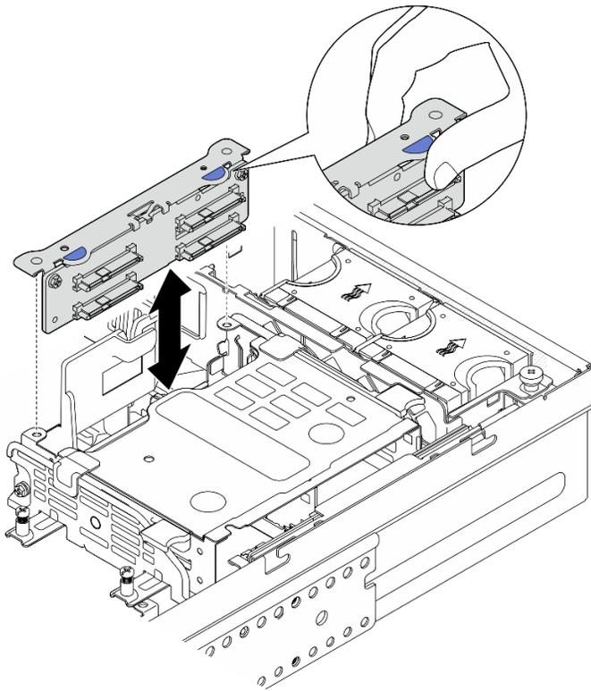
*Figura 73. Instalación de la placa posterior de la unidad interna*
