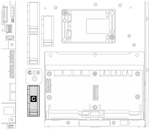
Figura 214. Clip para cables C
