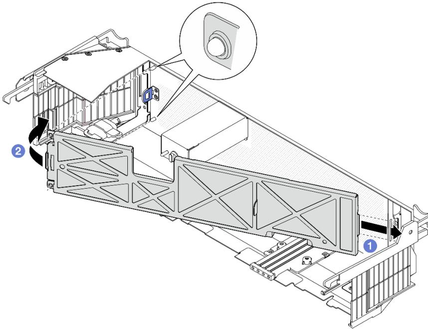
Figura 173. Instalación del filtro de polvo
