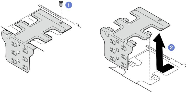
Figura 115. Extracción de la abrazadera de soporte lateral
