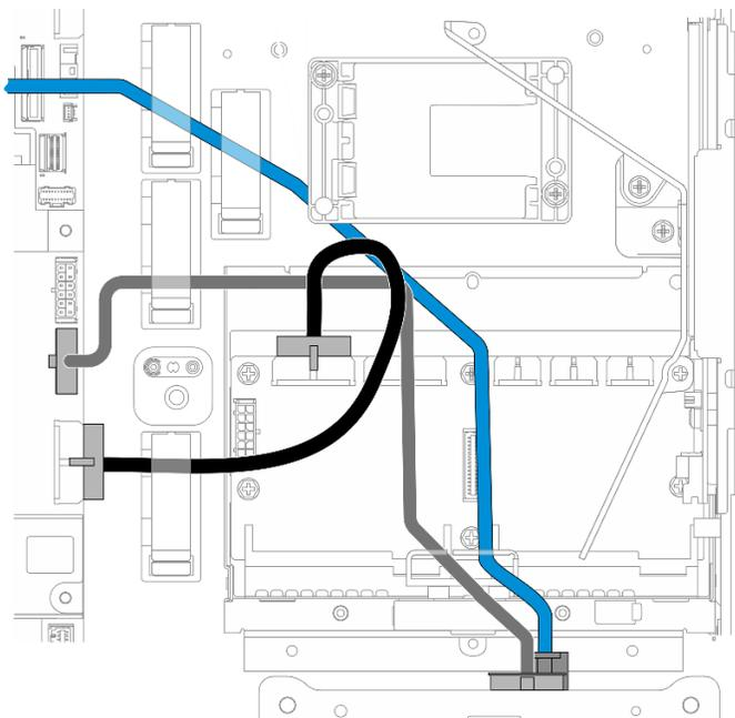
Figura 225. Disposición de los cables de la placa posterior de la unidad frontal
