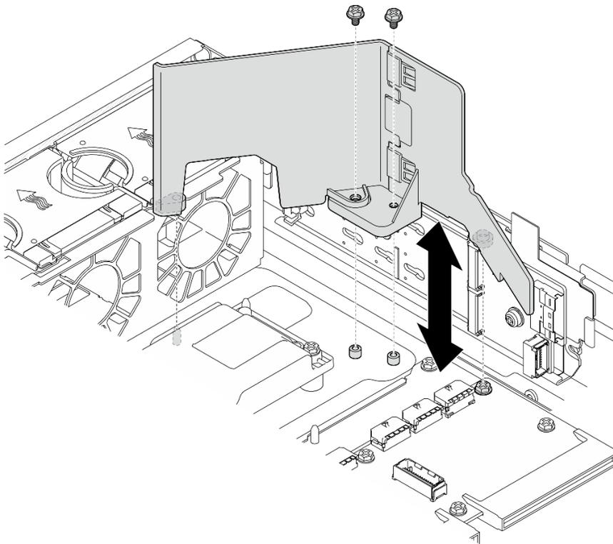
Figura 30. Instalación del deflector de aire M.2 para la configuración sin compartimiento de la unidad interna
