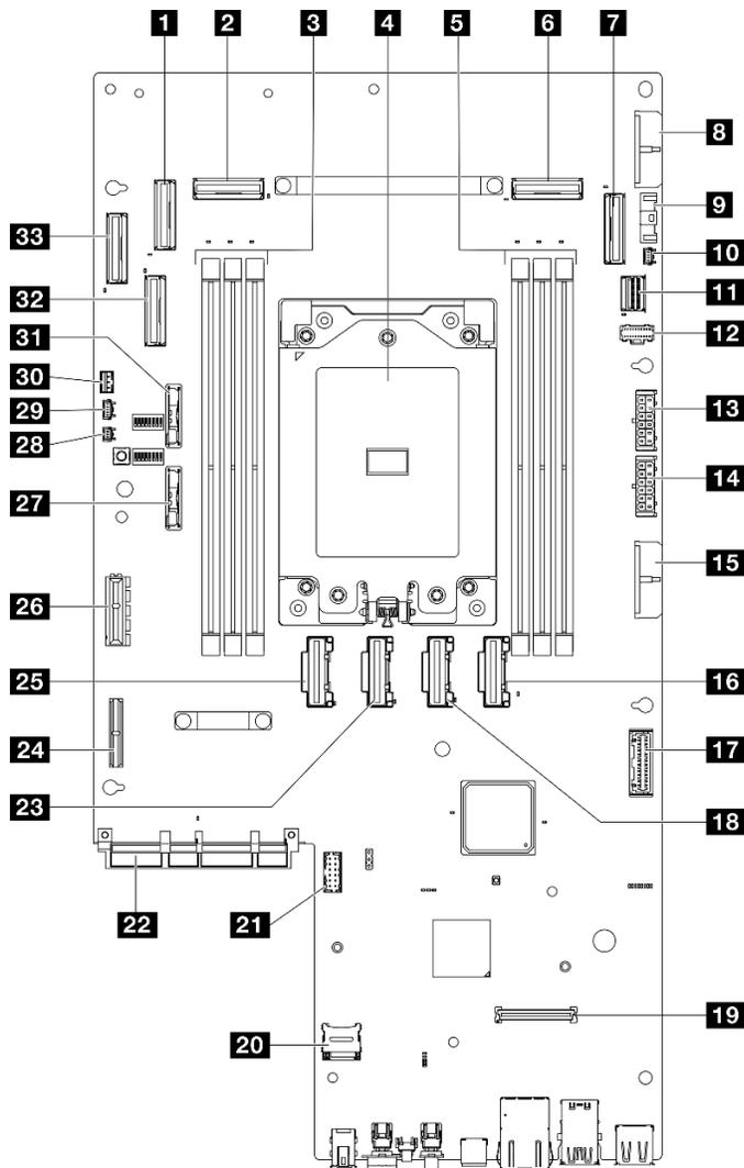
Figura 228. Conectores de la placa del sistema
