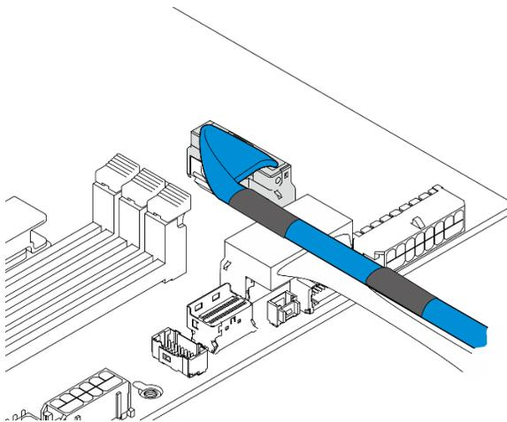
Figura 219. Cables de señal de BP interno
