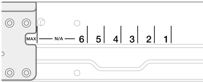
Figura 13. Marca de profundidad para los soportes EIA
