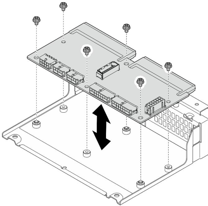
Figura 153. Instalación de la placa de distribución de alimentación
