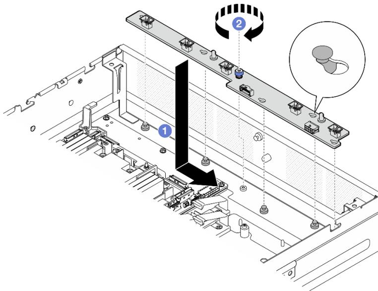
Figura 52. Instalación de la placa de control del ventilador
