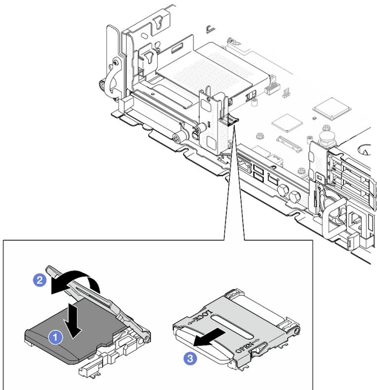
Figura 101. Instalación de la tarjeta MicroSD
