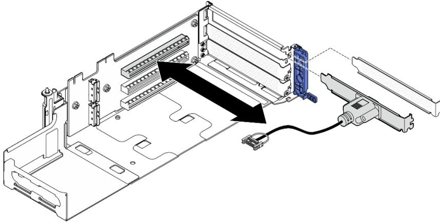
Figura 181. Extracción del módulo de puerto serie
