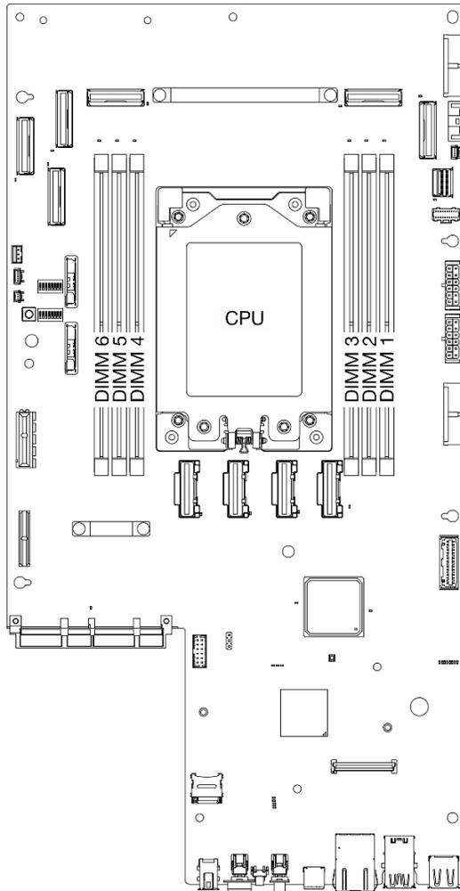
Figura 96. Diseño de los módulos de memoria y el procesador
