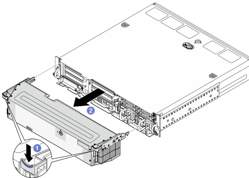
Figura 171. Extracción del marco biselado de seguridad
