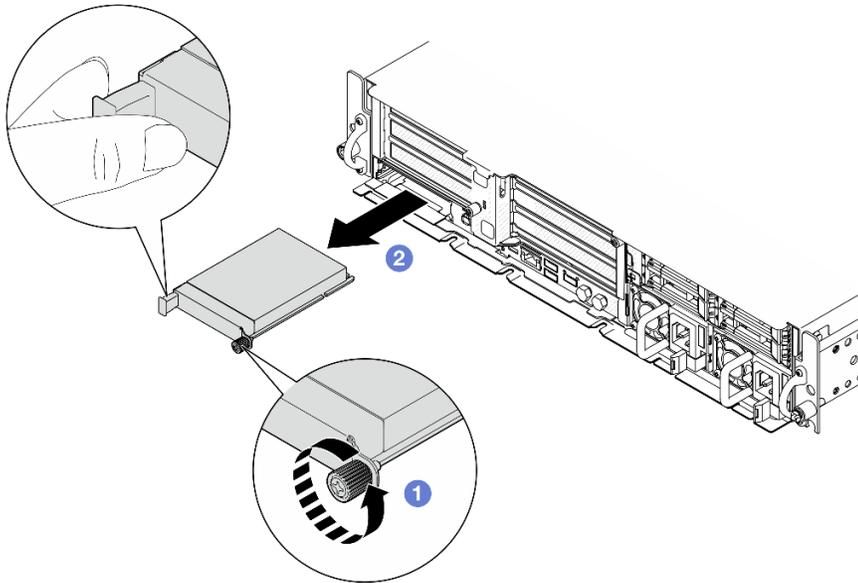
Figura 102. Extracción del módulo de OCP
