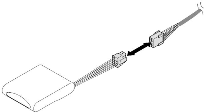
Figura 164. Desconexión del cable de extensión
