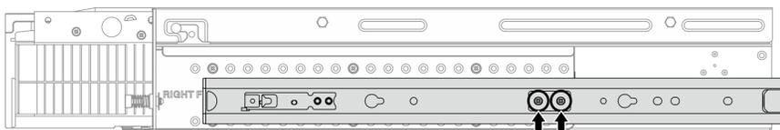
Figura 9. Dos tornillos para el riel interno de Kit de rieles de fricción de 1000 mm ThinkEdge v2
