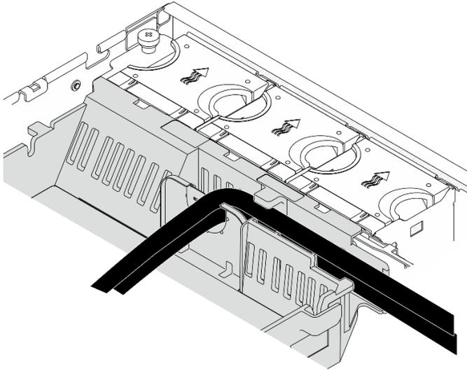
Figura 134. Cables de alimentación de GPU en el deflector de aire del procesador
