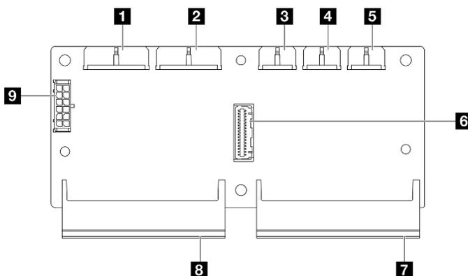
Figura 197. Conectores de placa de distribución de alimentación
