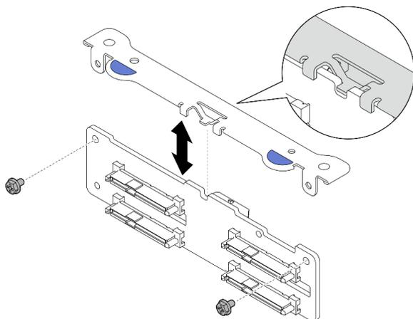
Figura 58. Fijación de la placa posterior en el soporte de la placa posterior
