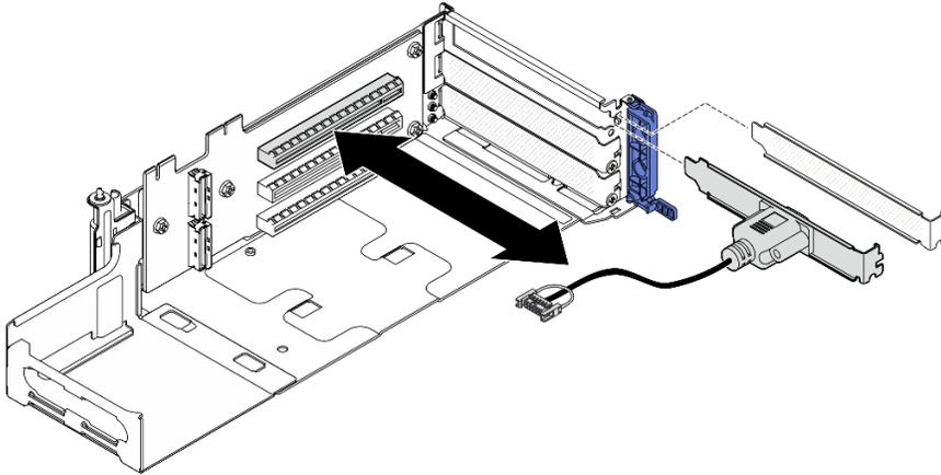
Figura 182. Instalación del módulo de puerto serie
