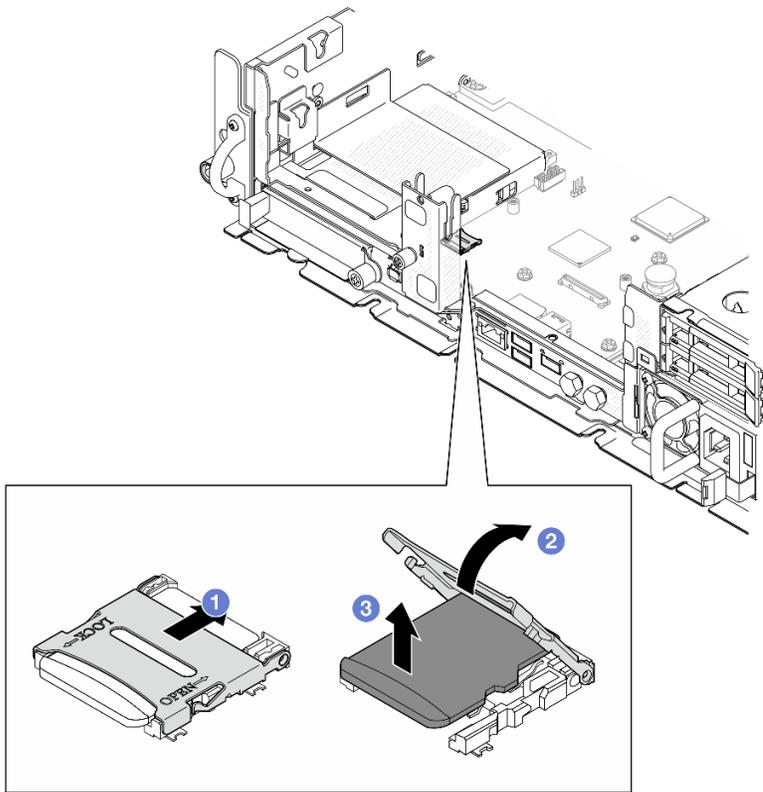
Figura 100. Extraer la tarjeta MicroSD
