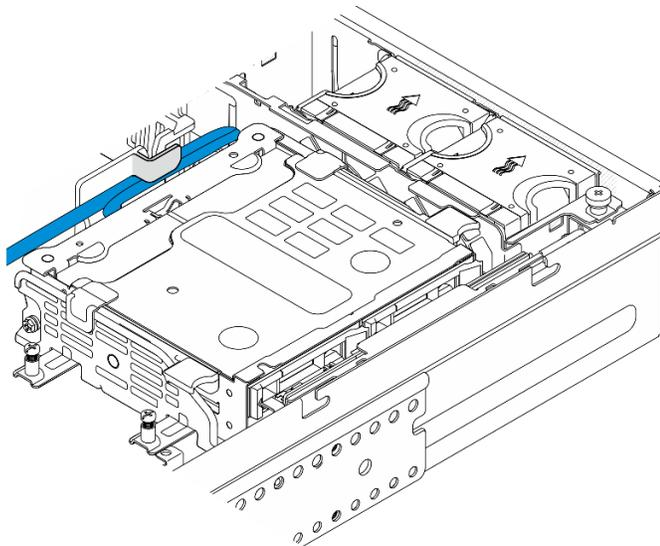
Figura 110. Cables asegurados por el clip para cables del deflector de aire del procesador
