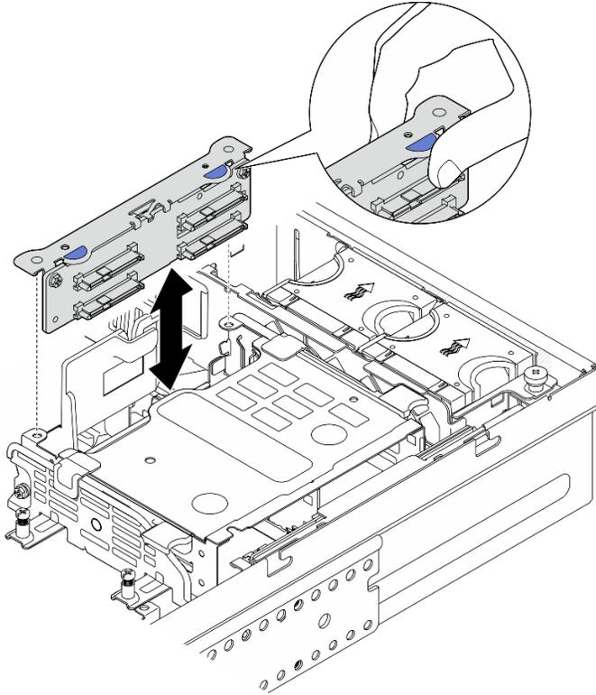
Figura 66. Extracción de la placa posterior de la unidad interna
