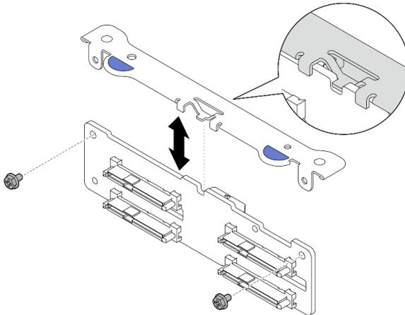
Figura 67. Separación de la placa posterior de la unidad del soporte de la placa posterior
