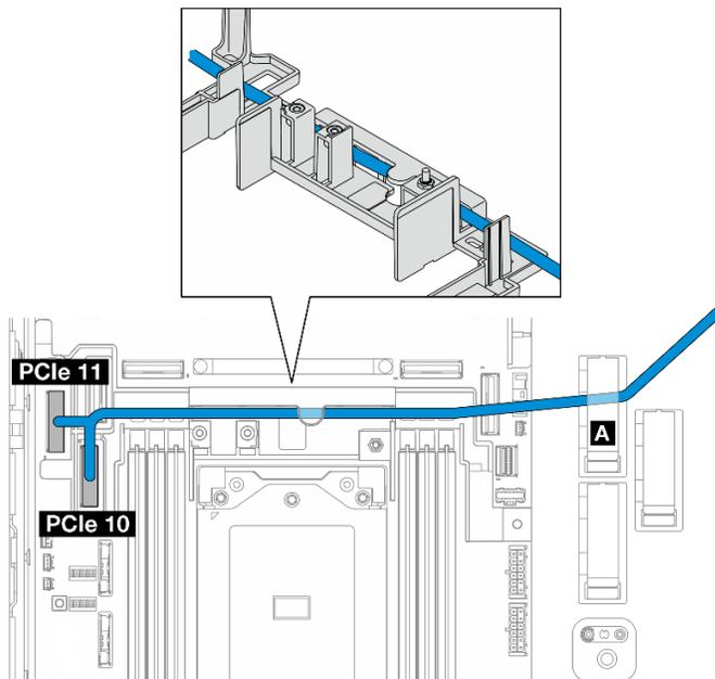
2. Disponga el cable de señal de BP interno a través de la pared para cable; luego, fíjelo en el clip para cables **A**.
