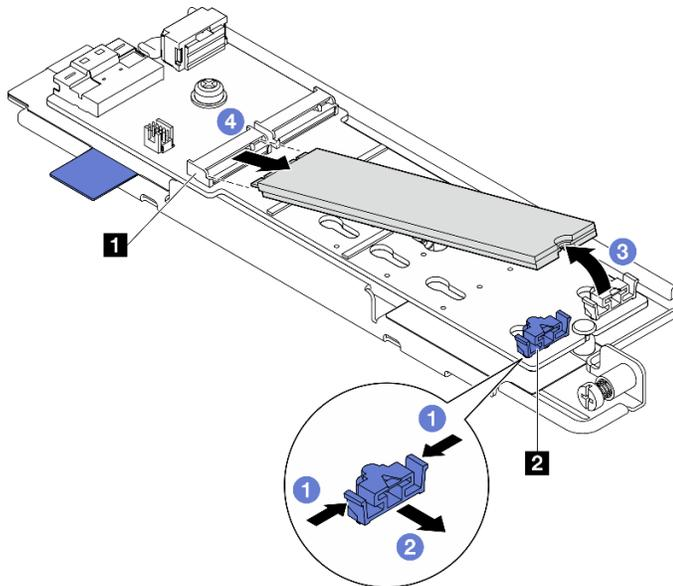
Figura 85. Extracción de una unidad M.2
