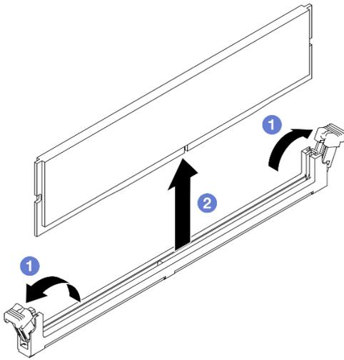
Figura 97. Extracción de un módulo de memoria
