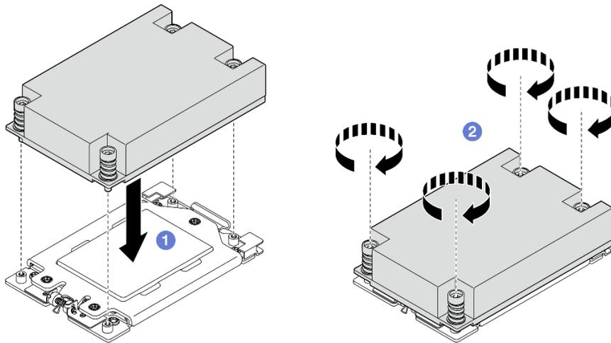
Figura 161. Instalación del disipador de calor de 1U
