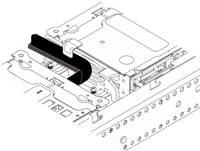
Figura 75. Disposición de los cables de la placa posterior de la unidad frontal
