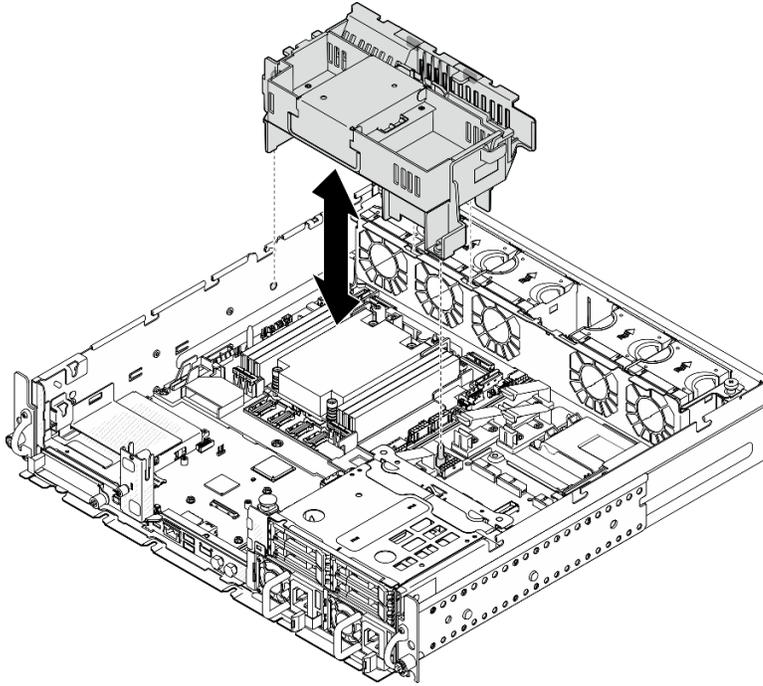
Figura 31. Extracción del deflector de aire para el dissipador de calor de 1U
