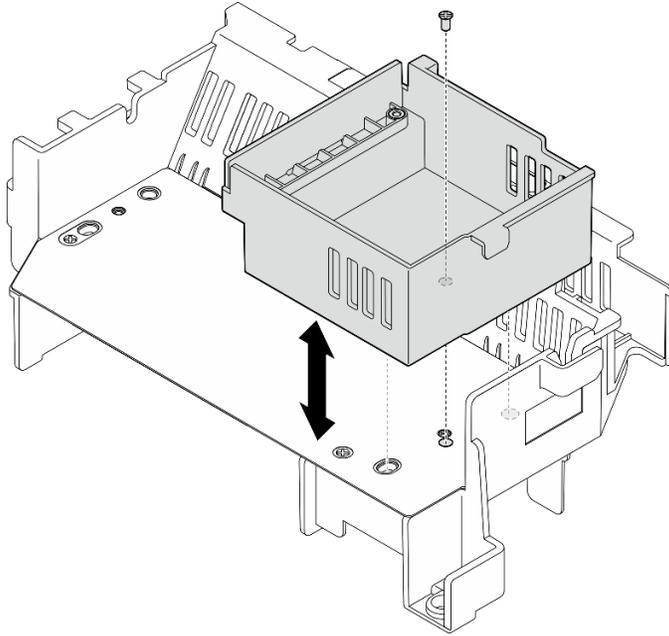
Figura 34. Sustitución del relleno de extensión 2
