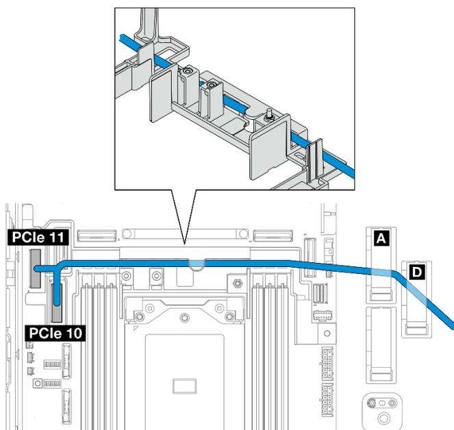
Figura 220. Cable de señal de BP frontal
