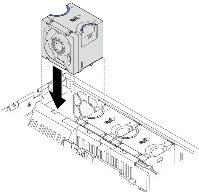
Figura 49. Instalación de un ventilador
