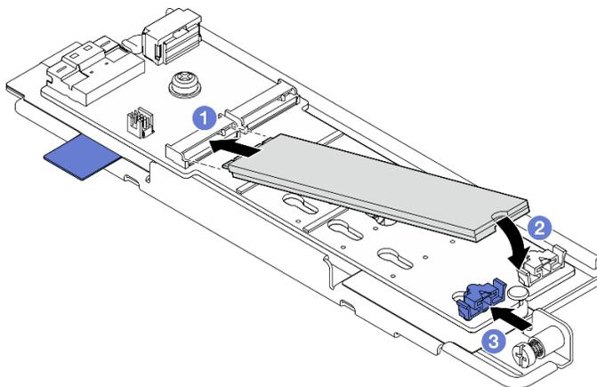
Figura 92. Instalación de una unidad M.2
