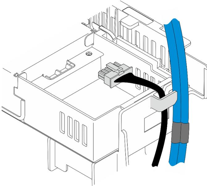
*Figura 72. Cables de la placa posterior interna en el clip de cable*
