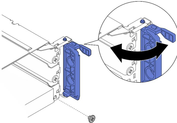
Figura 183. Instalación de los tornillos de sujeción
