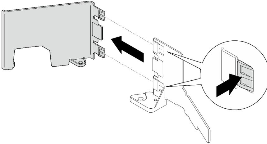
Figura 27. Separación de las piezas del deflector de aire M.2
