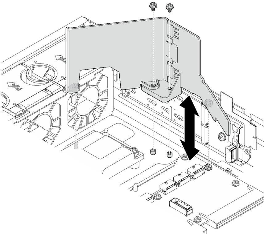
Figura 26. Extracción del deflector de aire M.2 para la configuración sin compartimiento de la unidad interna
