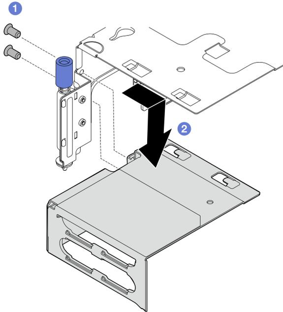
Figura 121. Extracción del amplificador de la expansión de PCIe 2
