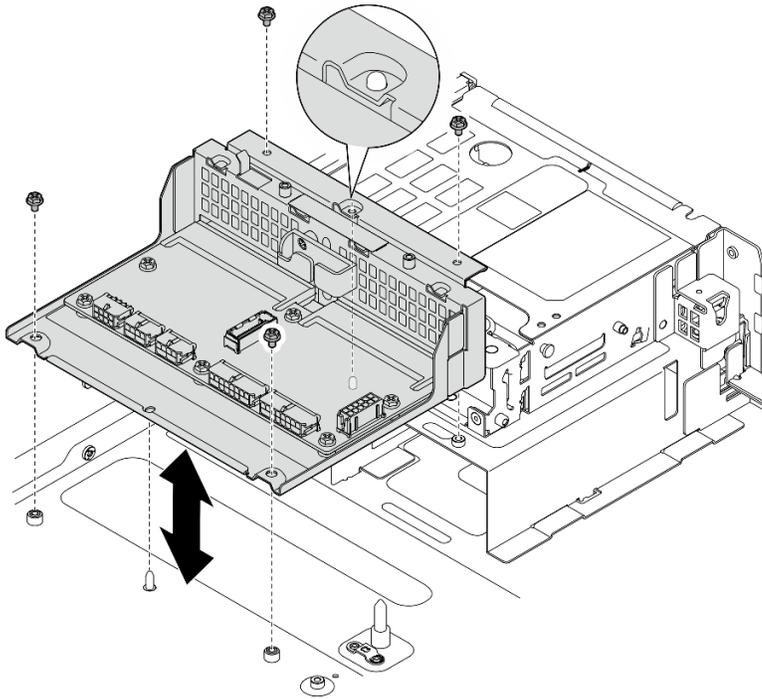
Figura 152. Instalación del compartimiento para PDB
