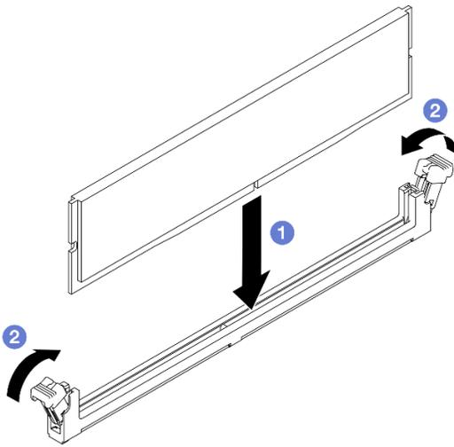
Figura 99. Instalación de un módulo de memoria
