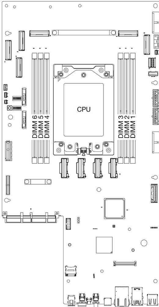
Figura 1. Diseño de los módulos de memoria y el procesador
