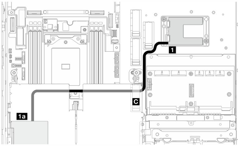
Figura 211. Adaptador RAID en expansión de PCIe 1
