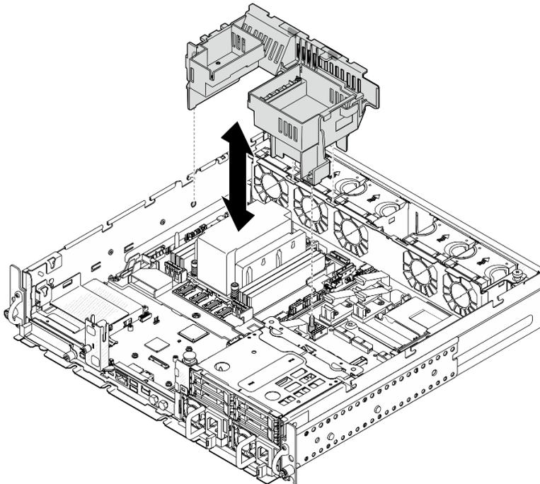
Figura 32. Extracción del deflector de aire para el dissipador de calor 2U
