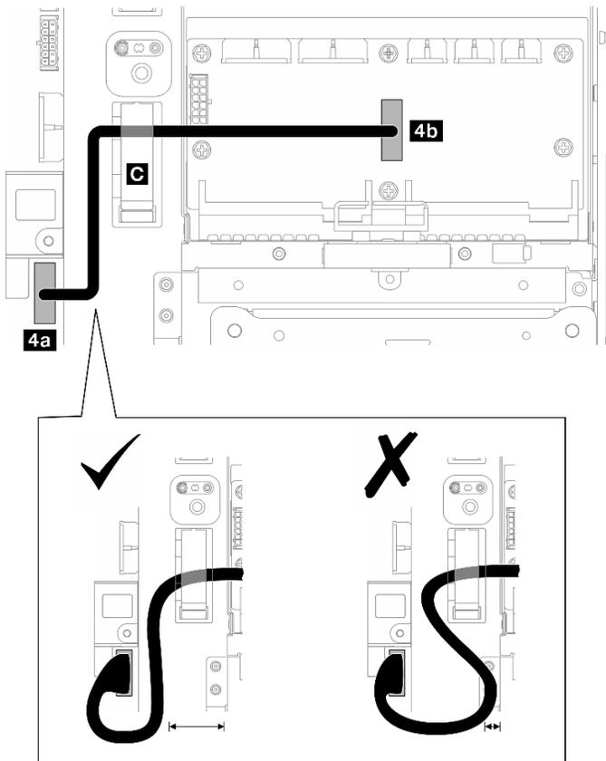
Figura 204. Disposición de los cables de banda lateral de PDB
