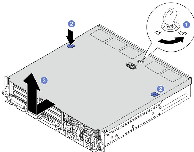
Figura 192. Extracción de la cubierta superior
