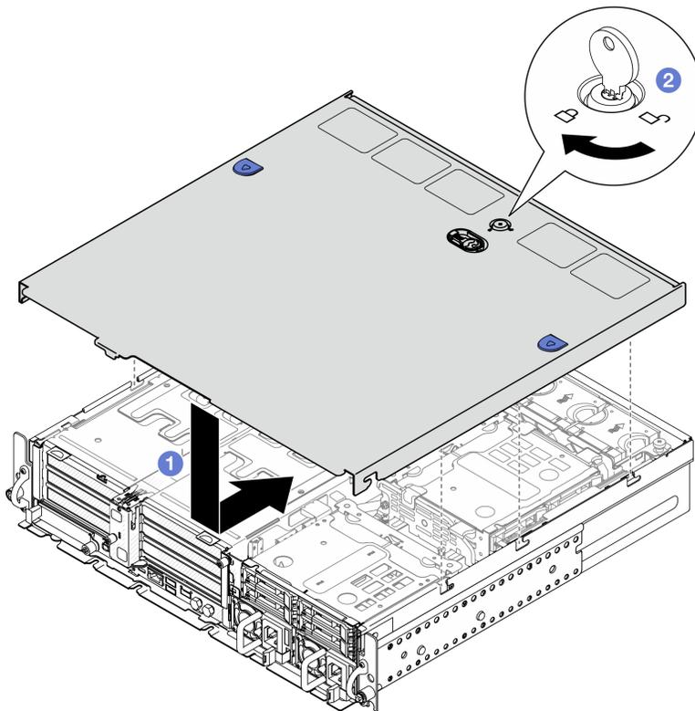
Figura 193. Instalación de la cubierta superior
