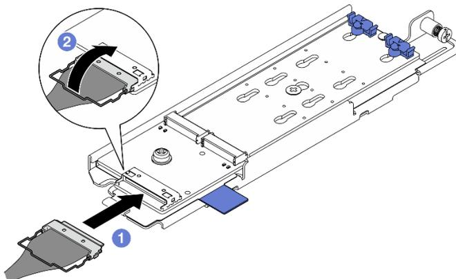
Figura 94. Conexión del cable a la placa posterior SATA/NVMe M.2
