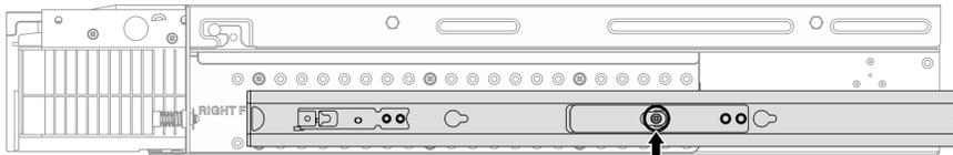
Figura 19. Un tornillo para el riel interno de Kit de rieles de fricción de 2 columnas ThinkEdge
