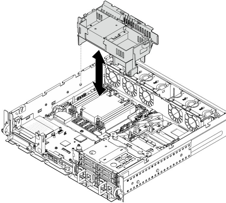
Figura 36. Instalación del deflector de aire para el dissipador de calor de 1U
