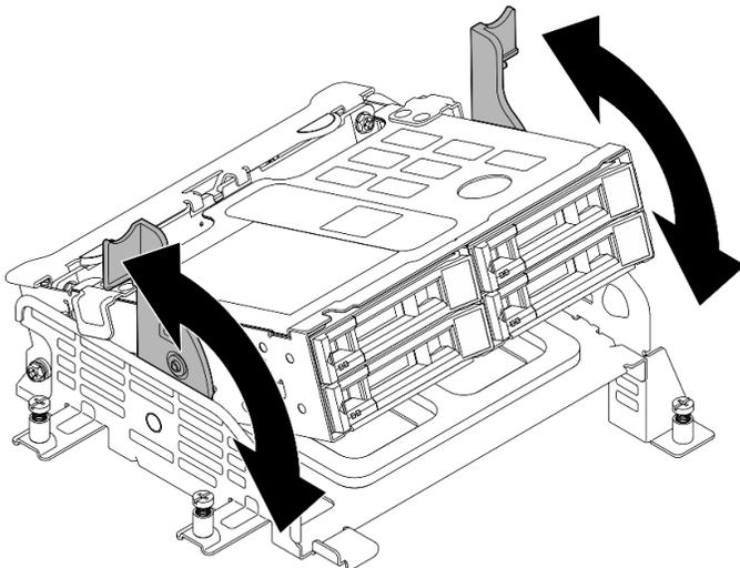
Figura 63. Girar el compartimiento de la unidad interna
