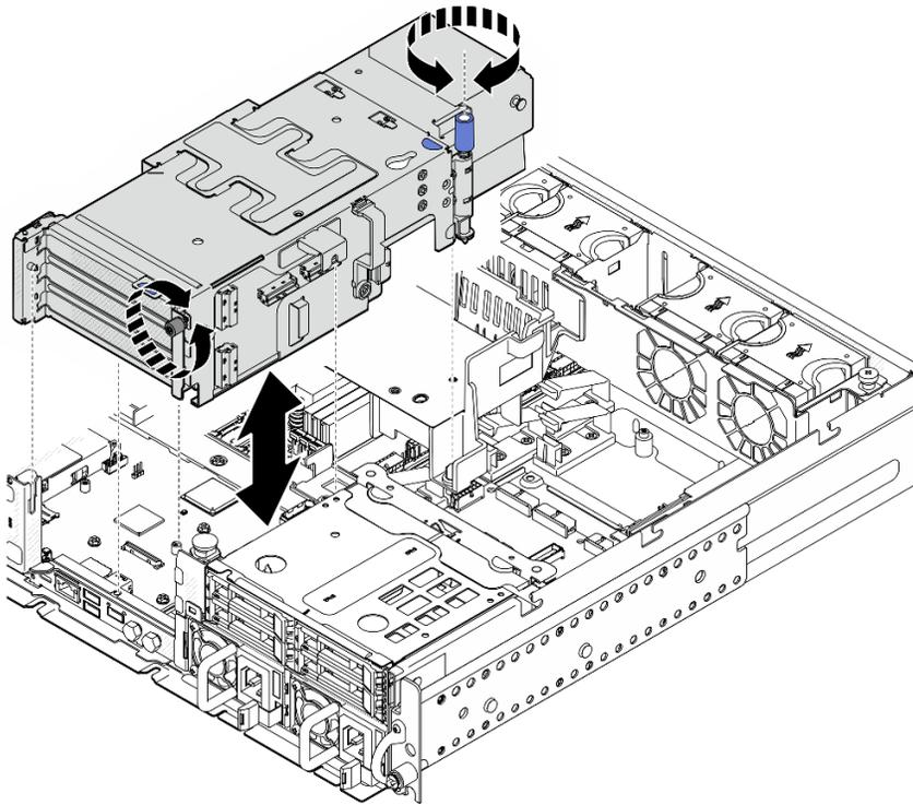
Figura 137. Instalación de la expansión de PCIe 2
