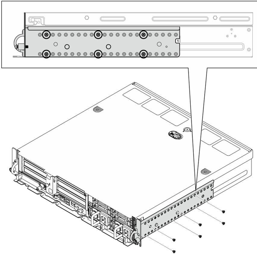
Figura 11. Profundidad regular 1 a 6 del soporte EIA: seis tornillos
