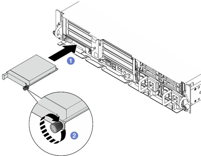
Figura 105. Instalación del módulo de OCP
