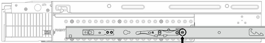
Figura 18. Un tornillo para el riel interno de Kit de rieles de rodamiento de bolas para bastidor de 600 mm ThinkEdge
