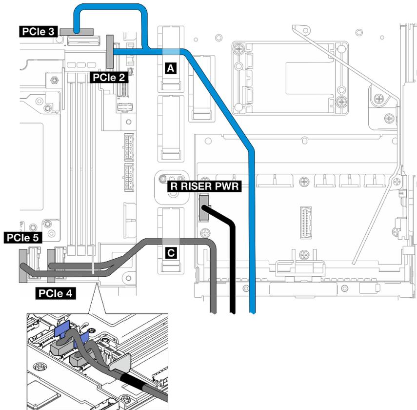
Figura 209. Disposición de los cables de la expansión de PCIe 2
