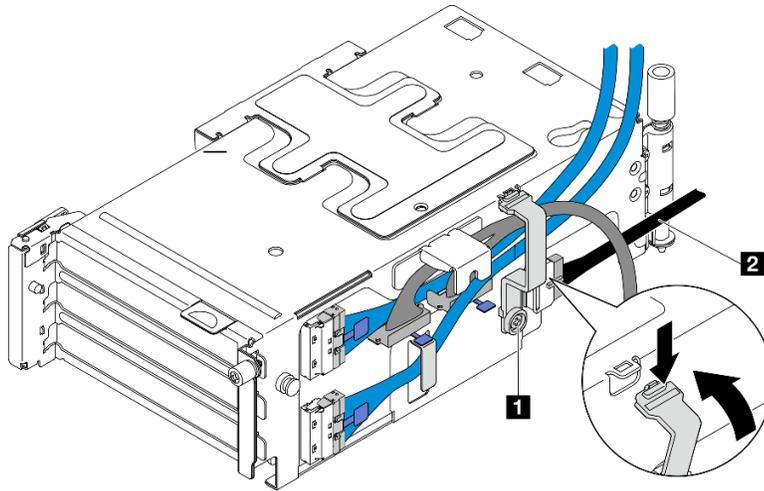
Figura 149. Disposición de los cables de la expansión de PCIe 2
