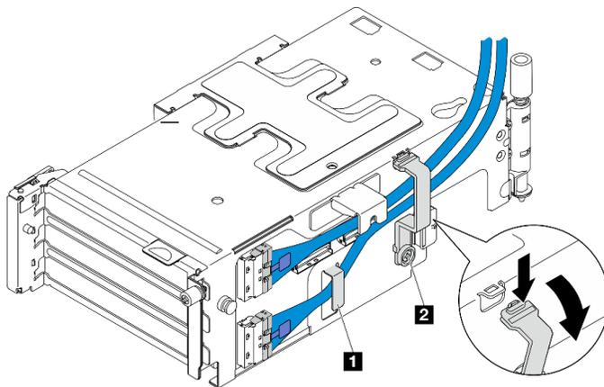
Figura 141. Disposición de los cables de la expansión de PCIe 2
