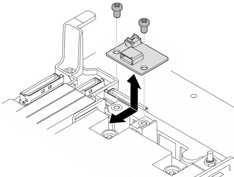
Figura 38. Extracción de la placa del sensor de flujo de aire
