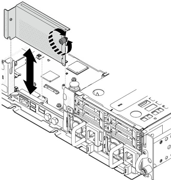
Figura 135. Extracción del relleno vacío de la tarjeta de expansión
