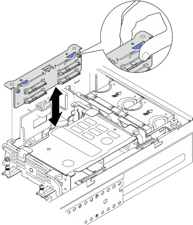
*Figura 139. Instalación de la placa posterior de la unidad interna*
