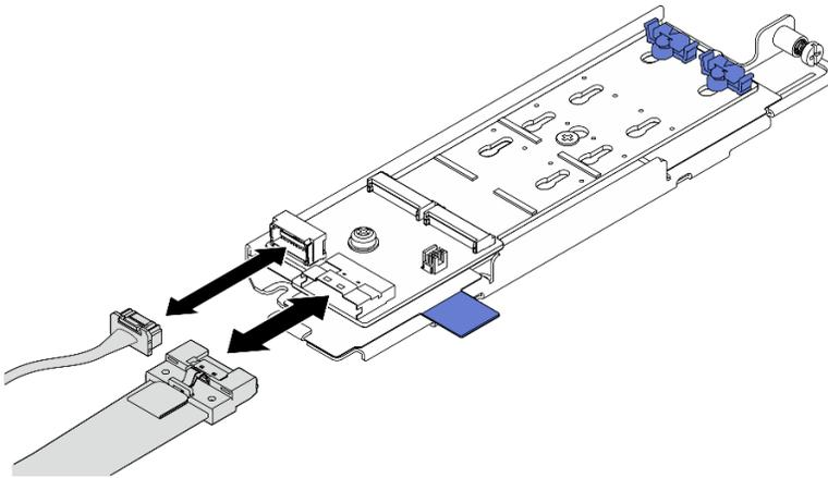
Figura 93. Conexión del cable a la placa posterior SATA/x4 NVMe M.2
