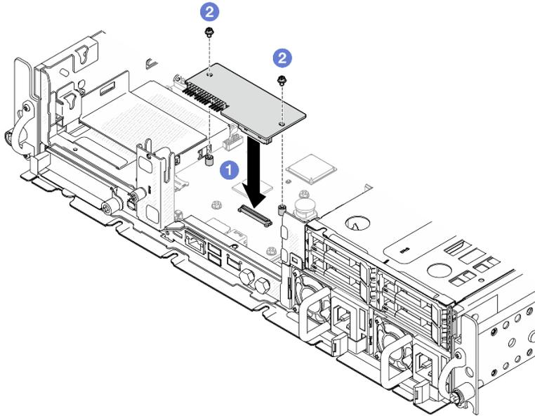
Figura 185. Instalación del firmware y el módulo de seguridad de RoT
