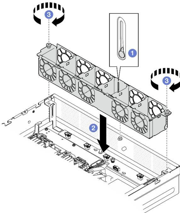
Figura 53. Instalación del compartimiento del ventilador
