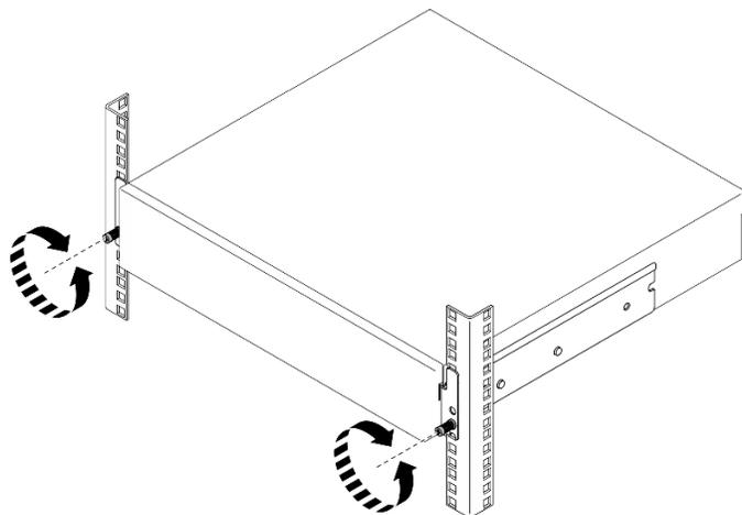
Figura 23. Fijación del servidor en el bastidor: soportes EIA estándar
