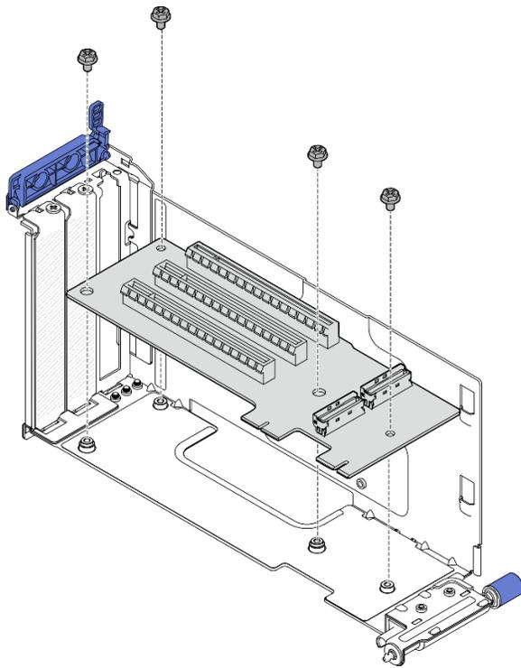
Figura 142. Extracción de la tarjeta de expansión de la expansión PCIe 1
