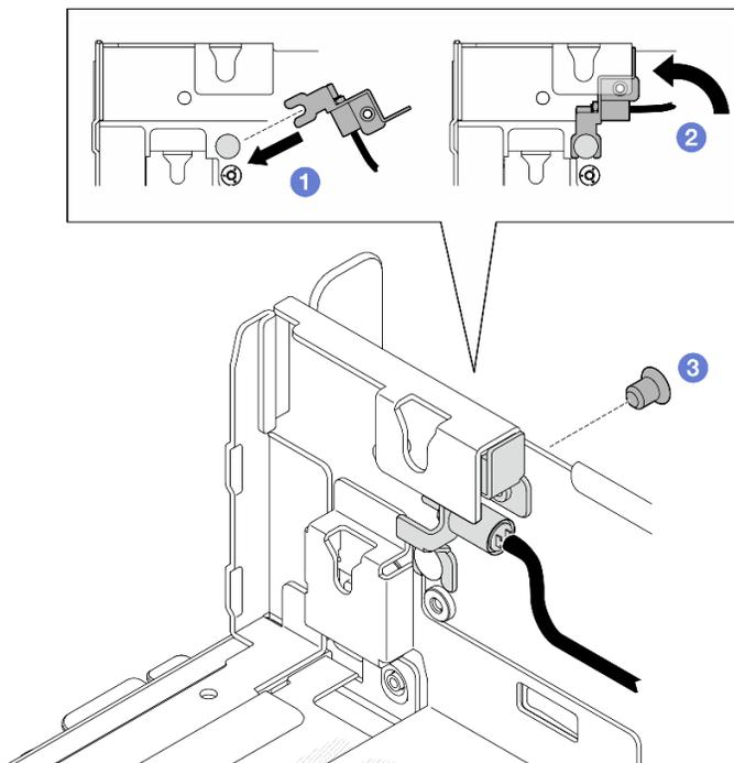
Figura 41. Instalación del conmutador de detección del marco biselado
