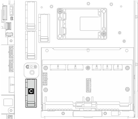
Figura 223. Clip para cables C
