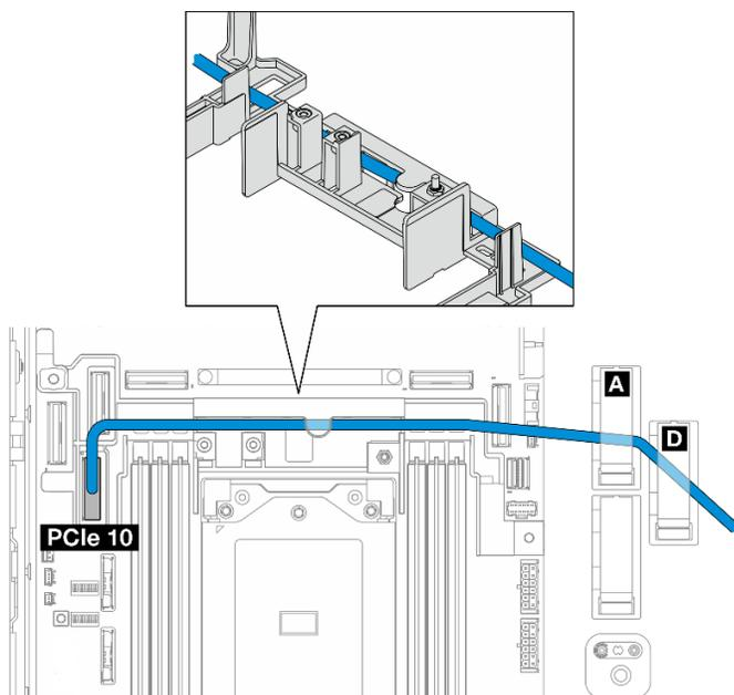
1. Conecte el cable de señal de BP al conector de PCIe 10 en la placa del sistema.
