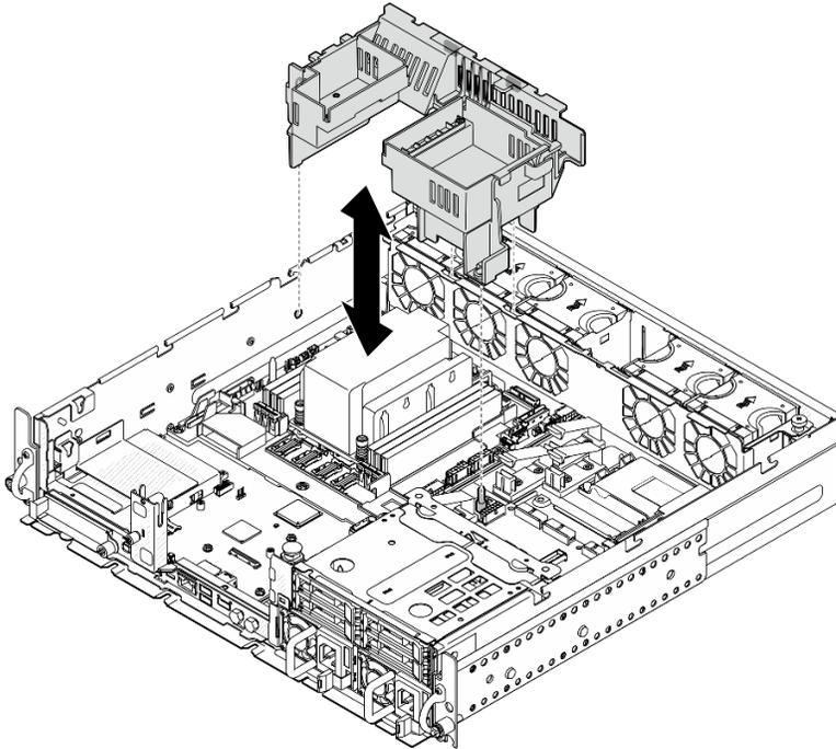
Figura 37. Instalación del deflector de aire para el dissipador de calor 2U
