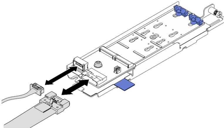
Figura 82. Desconexión del cable de la placa posterior SATA/x4 NVMe M.2
