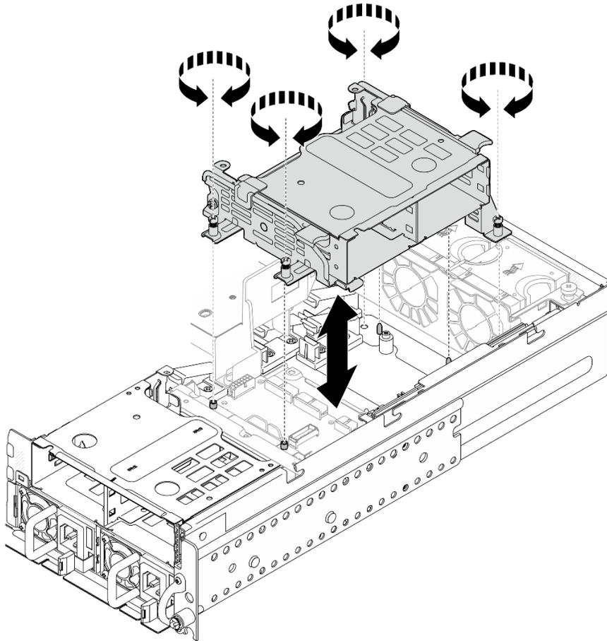
Figura 70. Instalación del compartimento de la unidad interna
