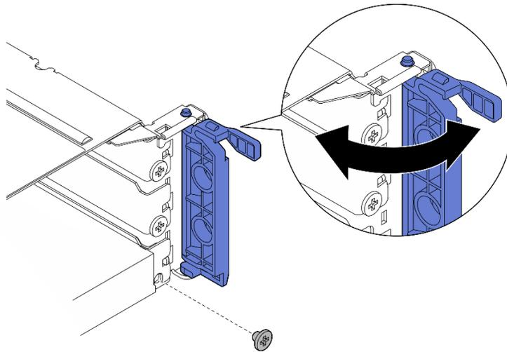
Figura 117. Extracción del tornillo de sujeción
