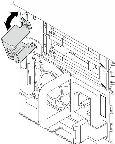
Figura 177. Extracción del soporte de bloqueo del marco biselado de seguridad
