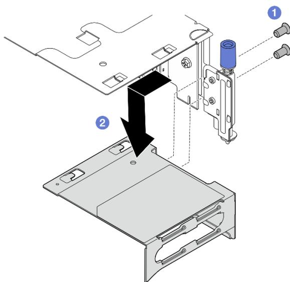
Figura 120. Extracción del amplificador de la expansión de PCIe 1
