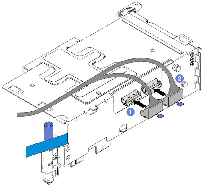
Figura 146. Disposición de los cables de la expansión de PCIe 1
