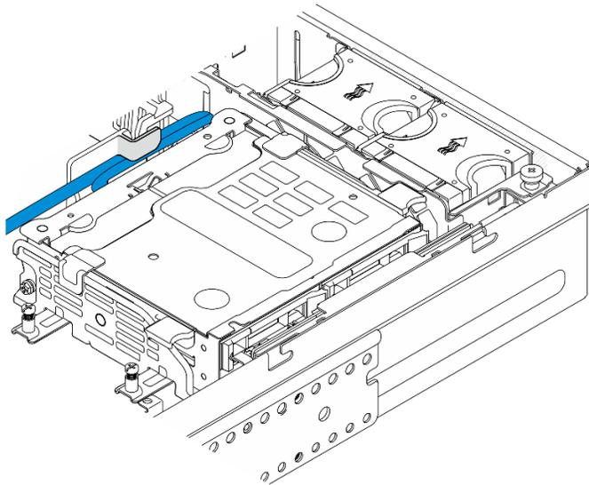
Figura 74. Disposición de los cables de la placa posterior de la unidad interna
