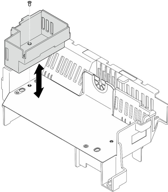
*Figura 33. Sustitución del relleno de extensión 1*
