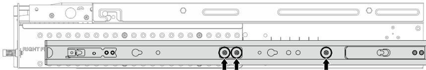
Figura 21. Tres tornillos para el riel interno de Kit de rieles de fricción de 1000 mm ThinkEdge v2
