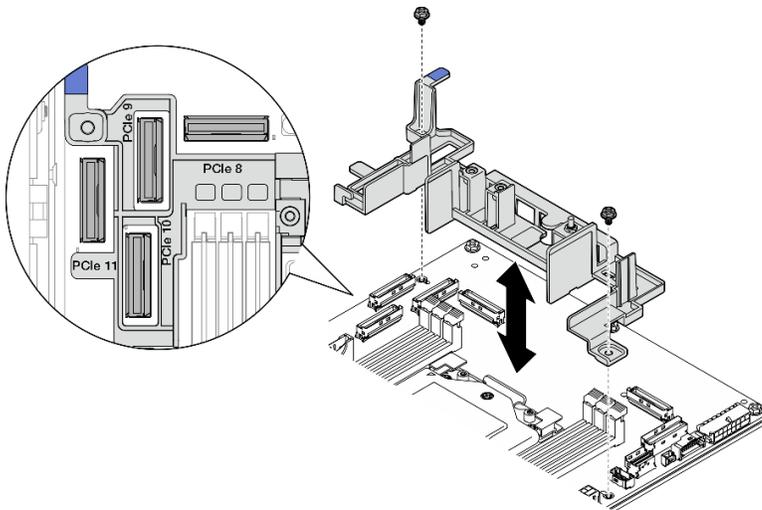
Figura 43. Instalación de la pared para cable
