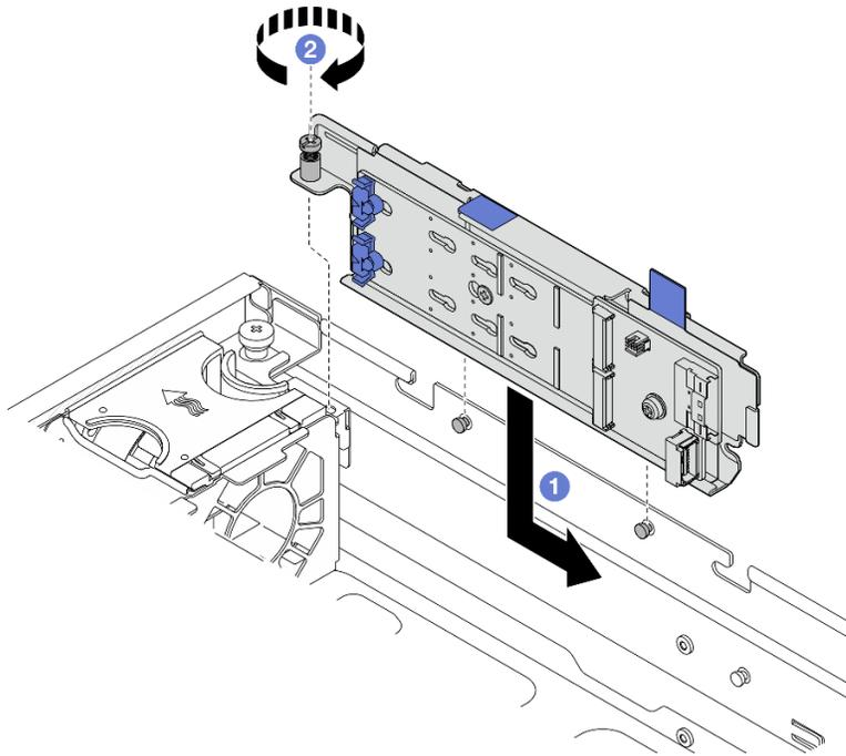
Figura 95. Instalación del conjunto de placas posteriores de M.2
