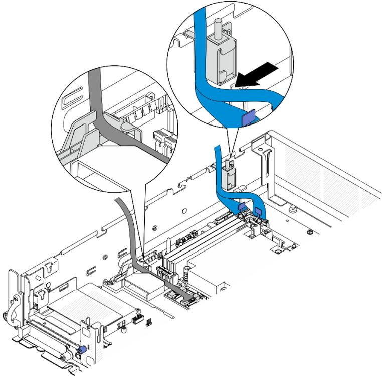
Figura 208. Disposición de los cables de la expansión de PCIe 1
