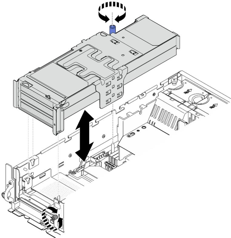
Figura 108. Levantar la expansión de PCIe 1
