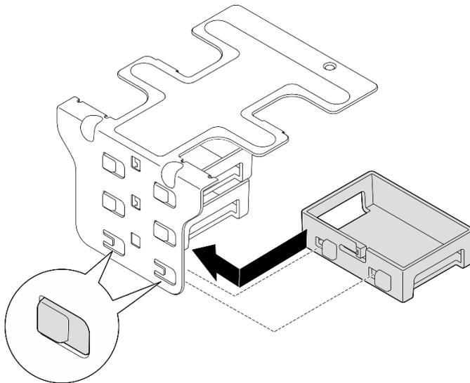
Figura 129. Instalación de un relleno de bajo perfil
