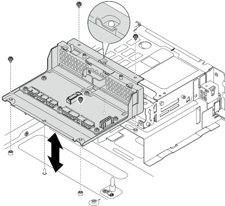
Figura 151. Extracción del compartimiento para PDB
