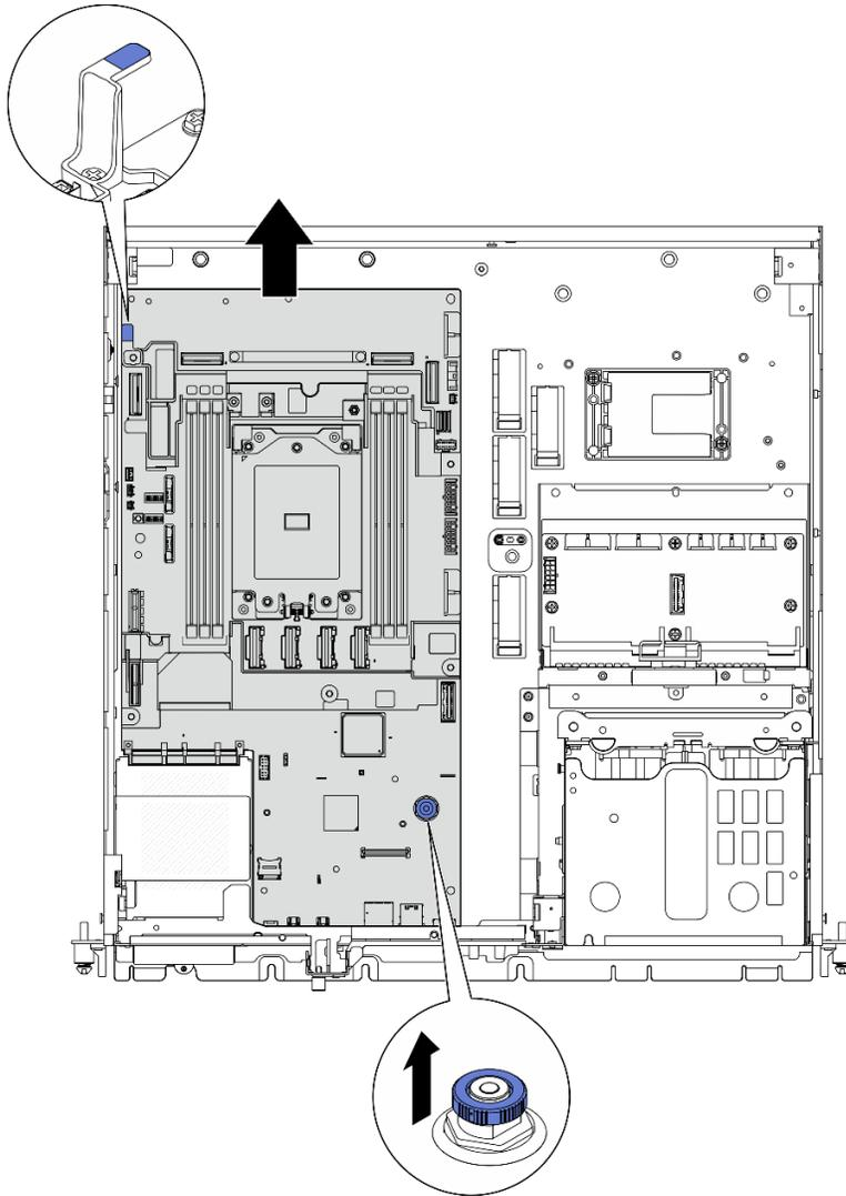
Figura 186. Desenganche de la placa del sistema
