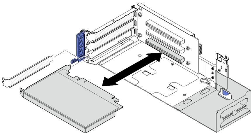
Figura 119. Extracción de un adaptador PCIe del compartimiento de expansión PCIe 2
