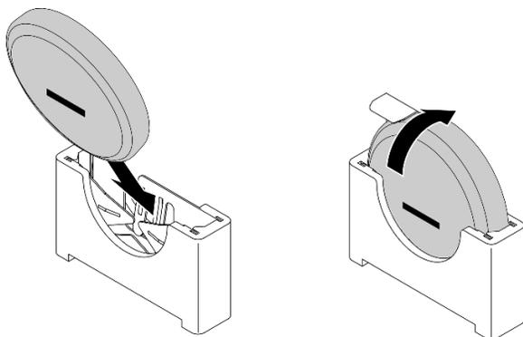
Figura 47. Instalación de la batería CMOS
