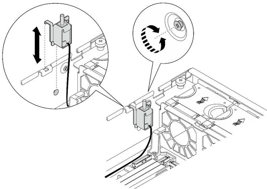
Figura 79. Extracción del conmutador de intrusión con cable
