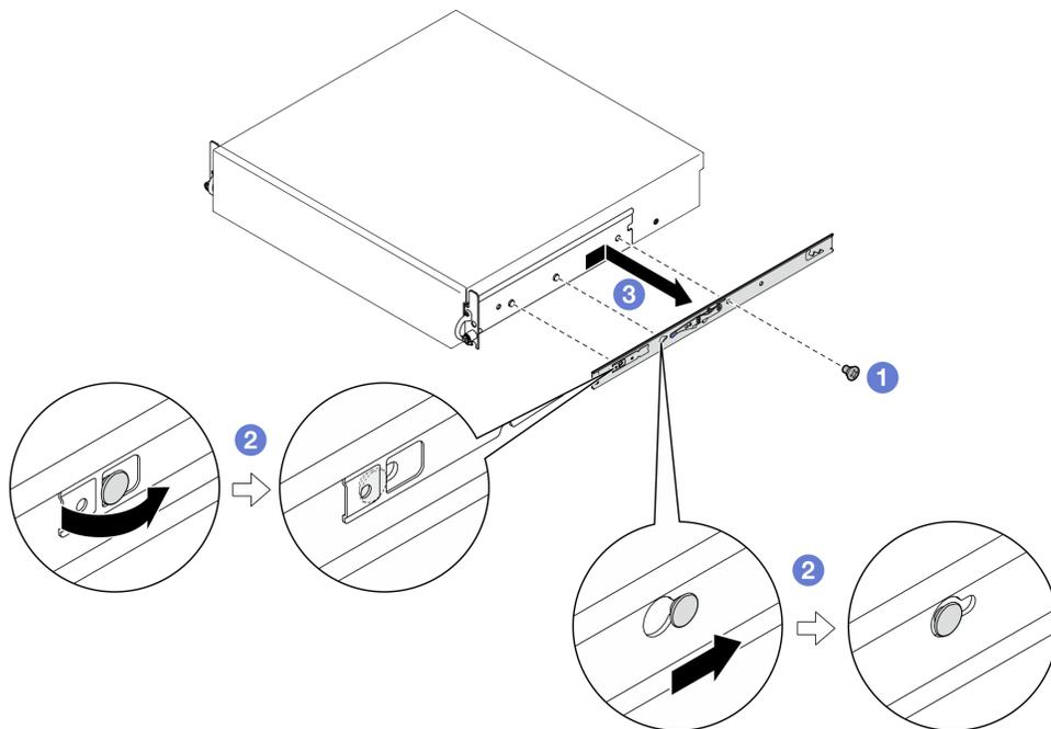
Figura 5. Extracción del riel interno
