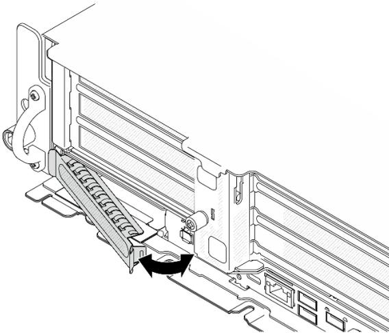
Figura 103. Instalación del relleno de OCP
