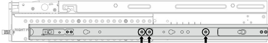
Figura 10. Tres tornillos para el riel interno de Kit de rieles de fricción de 1000 mm ThinkEdge v2
