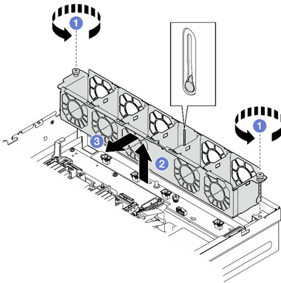
Figura 50. Extracción del compartimiento del ventilador
