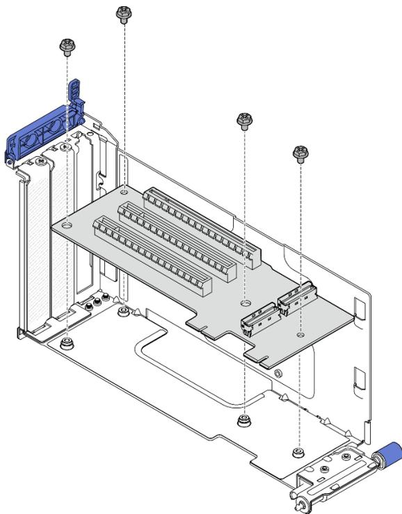
Figura 144. Instalación de la tarjeta de expansión
