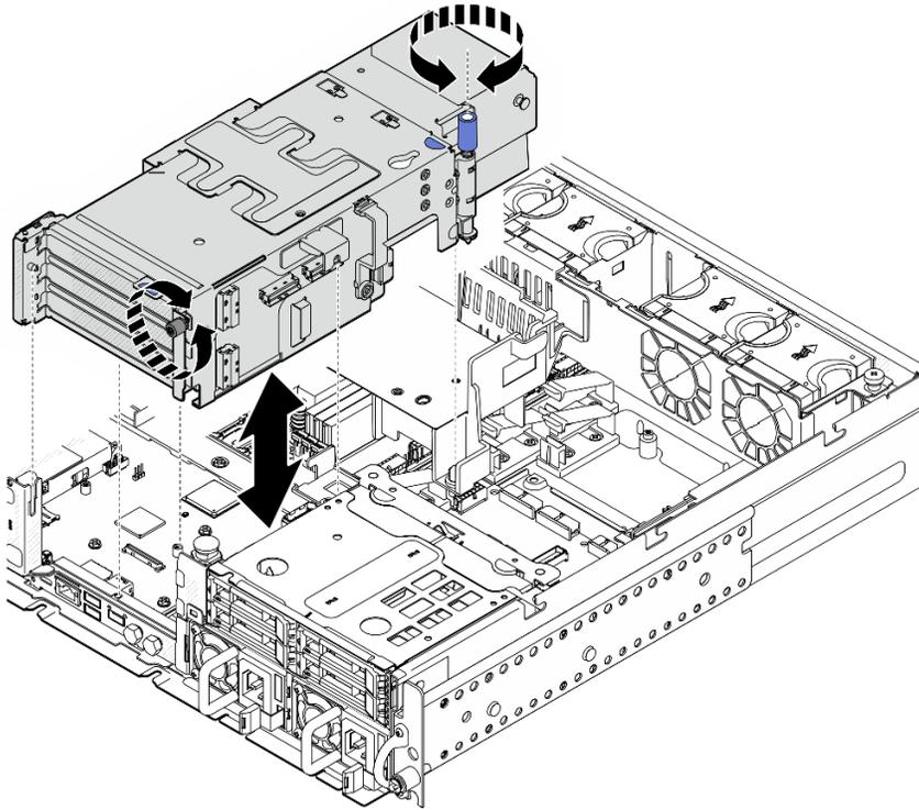
Figura 113. Levantar la expansión de PCIe 2
