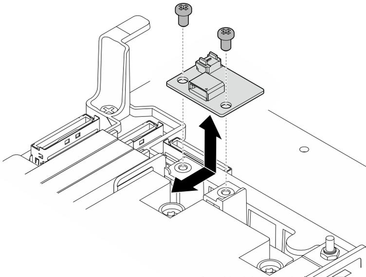
Figura 39. Instalación de la placa del sensor de flujo de aire
