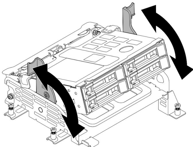
Figura 78. Girar el compartimento de la unidad interna
