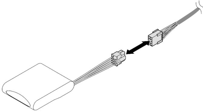
Figura 165. Conexión del cable de extensión
