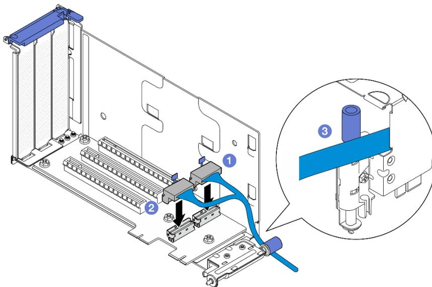
Figura 145. Disposición de los cables de la expansión de PCIe 1
