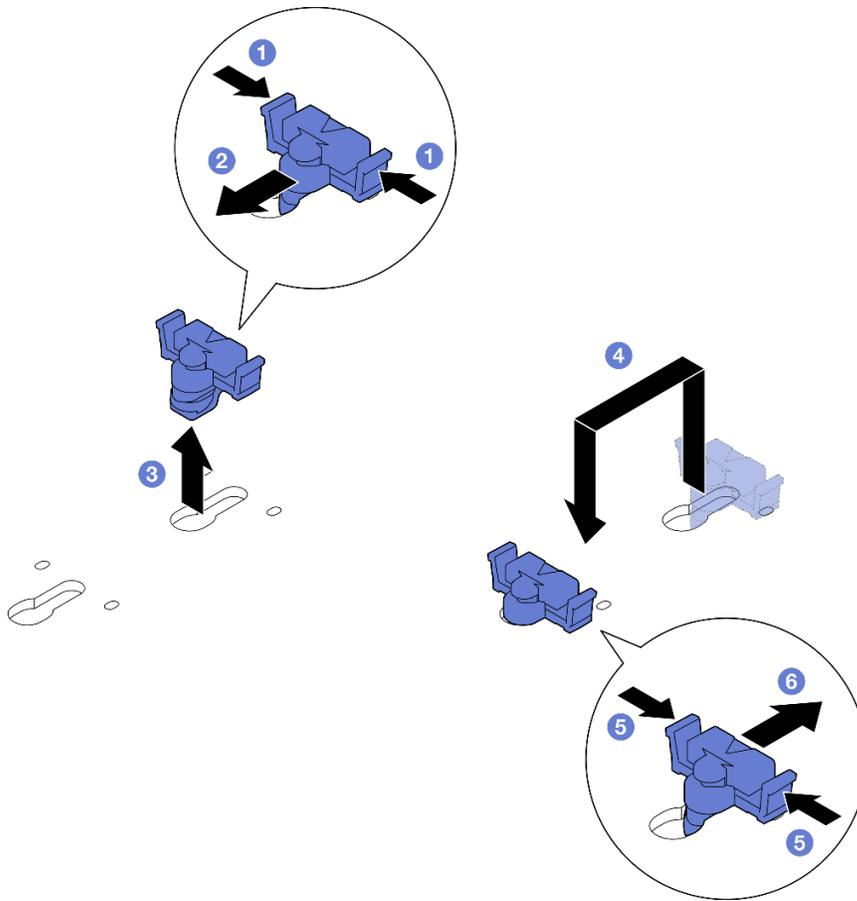
Figura 90. Ajuste del elemento de sujeción M.2
