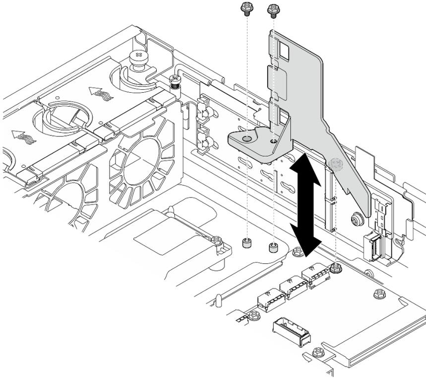
Figura 29. Instalación del deflector de aire M.2 para la configuración con compartimiento de la unidad interna
