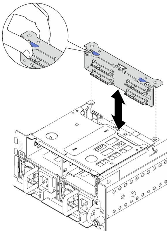
Figura 59. Instalación de la placa posterior de la unidad frontal
