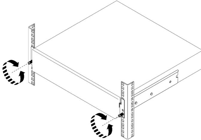
Figura 2. Desenganche del servidor del bastidor: soportes EIA estándar
