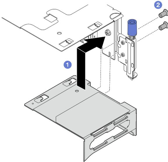
Figura 122. Instalación del amplificador de la tarjeta de expansión PCIe 1
