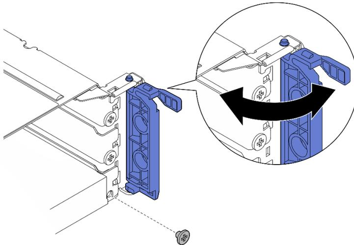
Figura 180. Extracción del tornillo de sujeción
