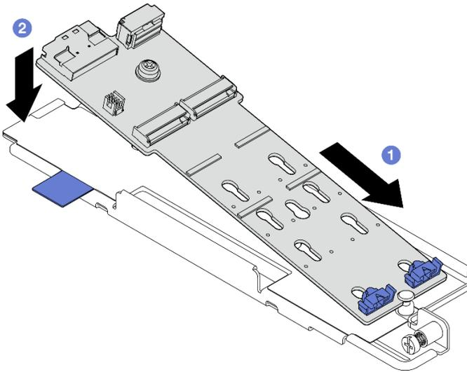
Figura 88. Instalación de la placa posterior M.2
