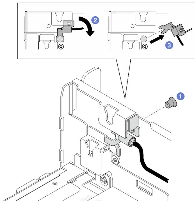
Figura 40. Extracción del conmutador de detección del marco biselado
