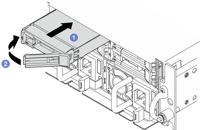
Figura 62. Instalación de una unidad de intercambio en caliente frontal
