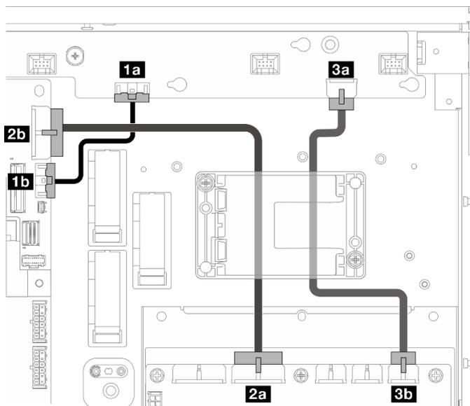
Figura 203. Disposición de los cables de PDB y FCB
