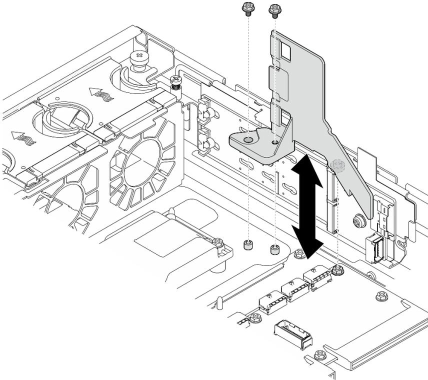
Figura 25. Extracción del deflector de aire M.2 para la configuración con compartimiento de la unidad interna
