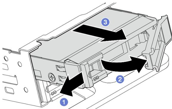
Figura 64. Extracción de una unidad interna
