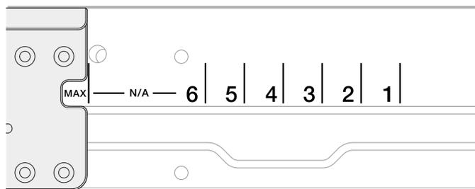
Figura 17. Marca de profundidad para los soportes EIA
