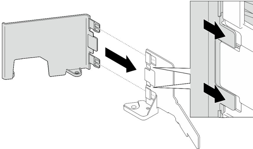
*Figura 28. Combinación de las piezas del deflector de aire M.2*
