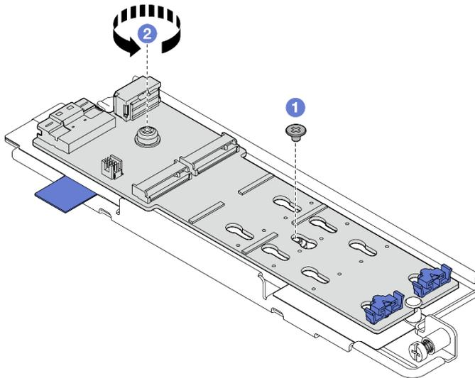
Figura 86. Extracción de la placa posterior M.2
