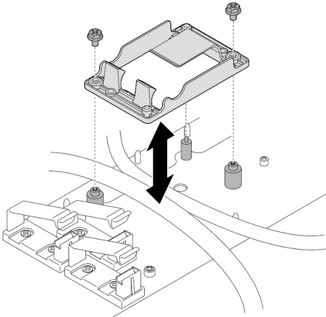
Figura 169. Instalación del soporte del módulo de alimentación flash RAID
