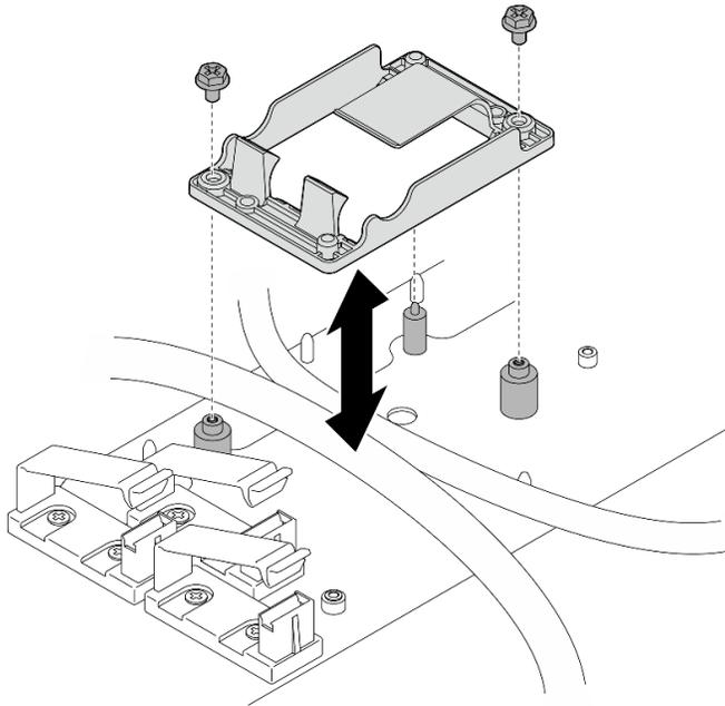
Figura 168. Extracción del soporte del módulo de alimentación flash RAID
