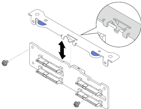
*Figura 57. Separación de la placa posterior de la unidad del soporte de la placa posterior*
