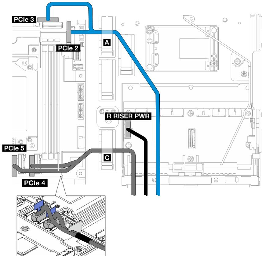
Figura 136. Disposición de los cables de la expansión de PCIe 2
