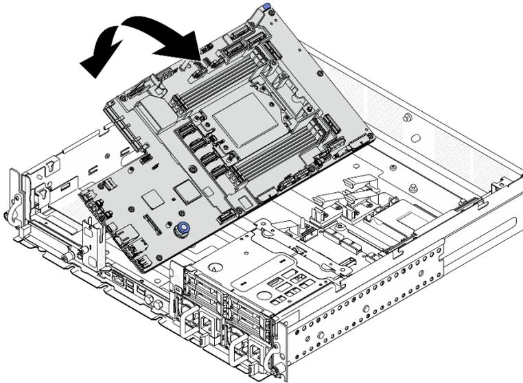
Figura 187. Extracción la placa del sistema
