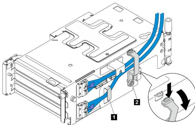
Figura 148. Disposición de los cables de la expansión de PCIe 2
