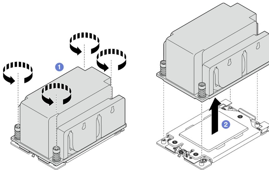
Figura 157. Extracción del disipador de calor 2U
