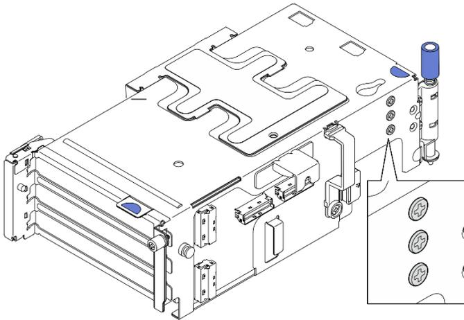
Figura 128. Tornillos de repuesto de la tarjeta de expansión PCIe 2
