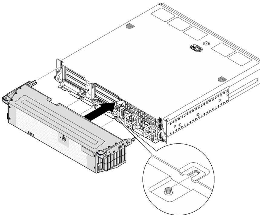
Figura 175. Instalación del marco biselado de seguridad
