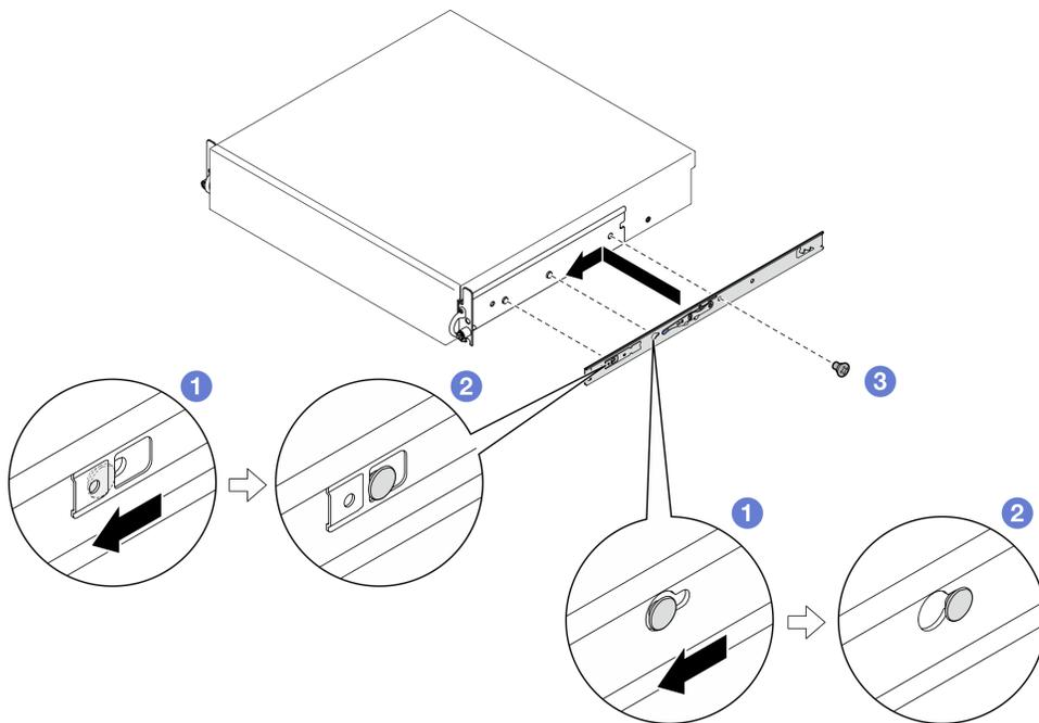
Figura 16. Instalación del riel interno
