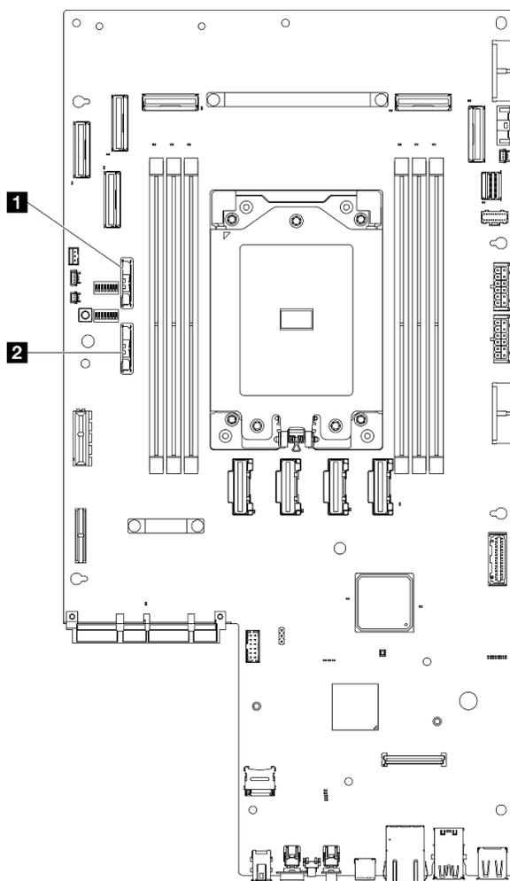
Figura 44. Ubicaciones de la batería de CMOS en la placa del sistema
