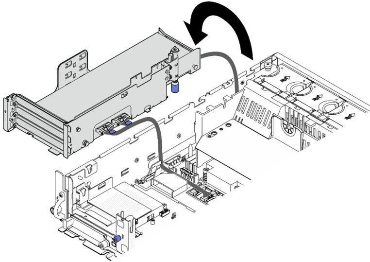
Figura 109. Colocar la expansión PCIe 1 a un lado del chasis
