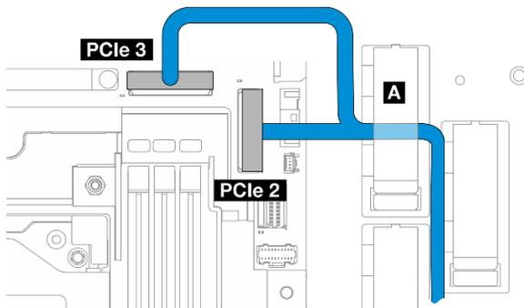
Figura 218. Cables de señal de BP interno
