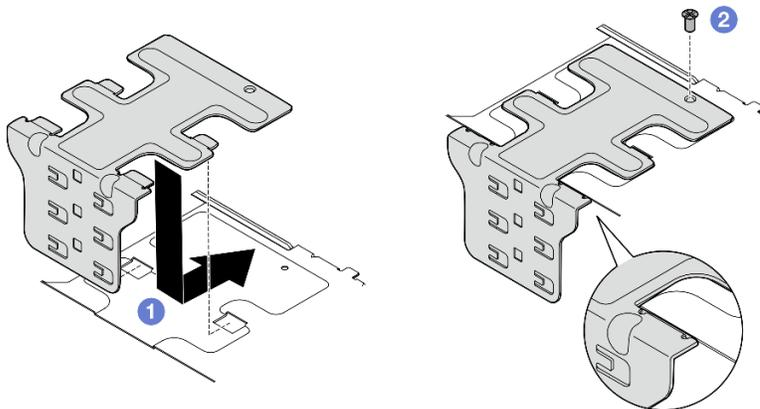
Figura 130. Instalación de la abrazadera de soporte lateral
