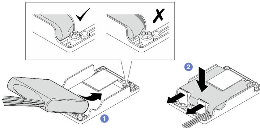
Figura 166. Instalación del módulo de alimentación flash RAID
