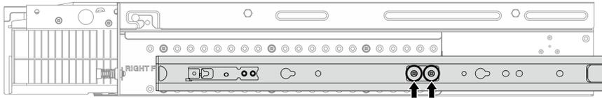
Figura 20. Dos tornillos para el riel interno de Kit de rieles de fricción de 1000 mm ThinkEdge v2
