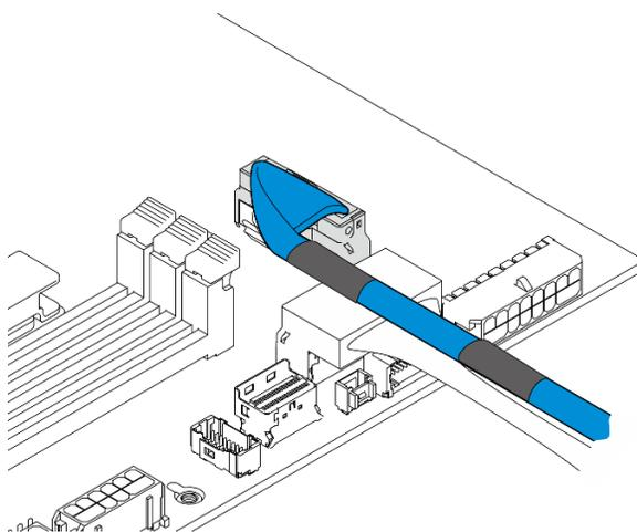
Figura 216. Cables de señal de BP interno
