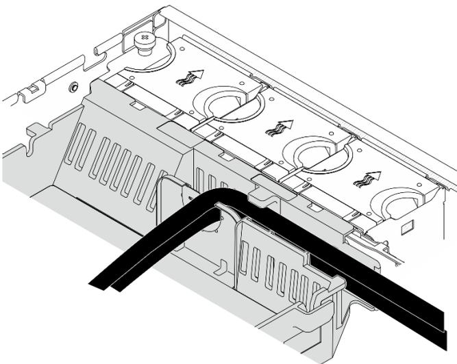
*Figura 112. Cables de alimentación de GPU en el deflector de aire del procesador*
