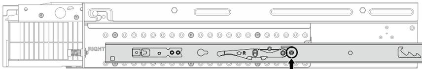
Figura 7. Un tornillo para el riel interno de Kit de rieles de rodamiento de bolas para bastidor de 600 mm ThinkEdge
