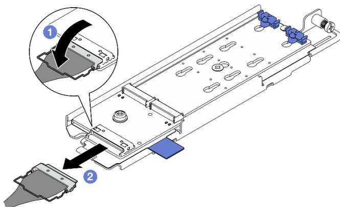
Figura 83. Desconexión del cable de la placa posterior SATA/NVMe M.2
