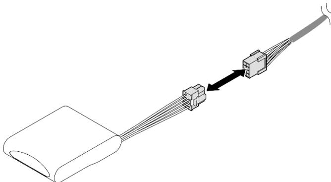
Figura 167. Desconexión del cable de extensión
