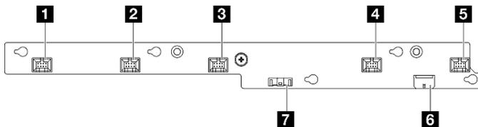
Figura 196. Conectores de la placa de control del ventilador
