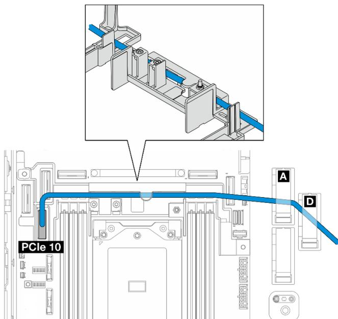
4. Disponga el cable de señal de BP frontal a través de la pared para cable; luego, fíjelo en el clip para cables **A** y **D**.
