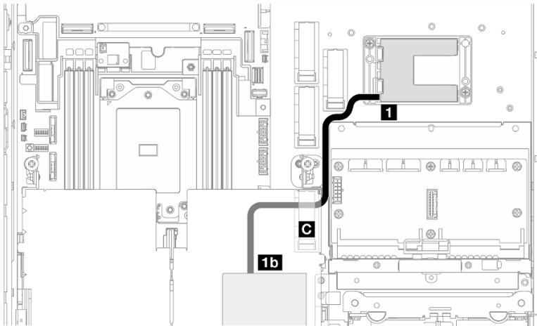
Figura 212. Adaptador RAID en expansión de PCIe 2
