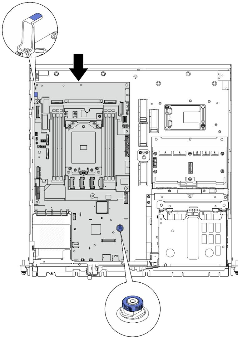
Figura 189. Fijación de la placa del sistema
