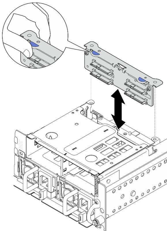
*Figura 56. Extracción de la placa posterior de la unidad frontal*
