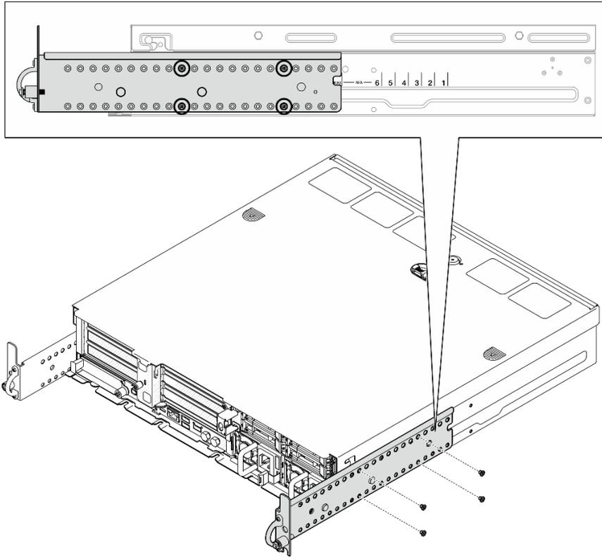
Figura 15. Profundidad máxima del soporte EIA para el marco biselado de seguridad: cuatro tornillos
