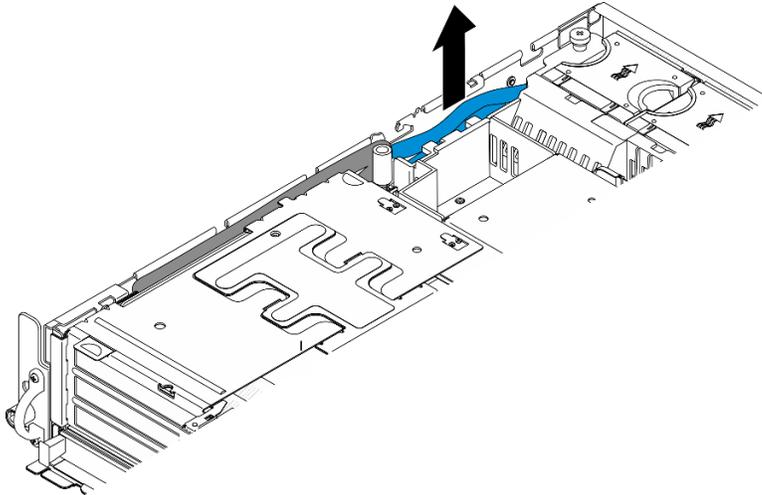
Figura 107. Desenganchar el cable de señal de la expansión PCIe 1
