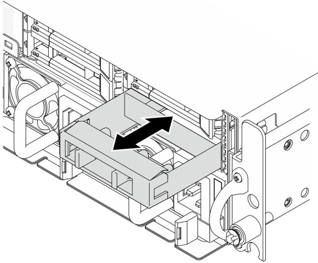
Figura 61. Extracción de un relleno de unidad
