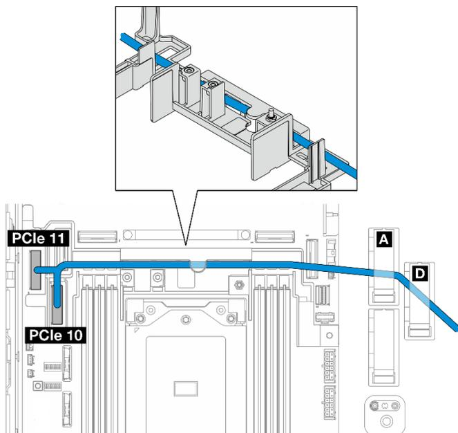
Figura 217. Cable de señal de BP frontal
