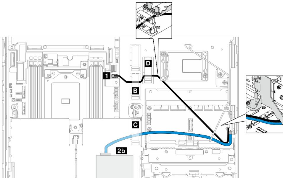
Figura 207. Adaptador RAID en expansión de PCIe 2
