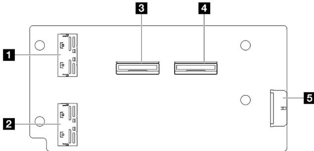
Figura 200. Tarjeta de expansión de PCIe 2
