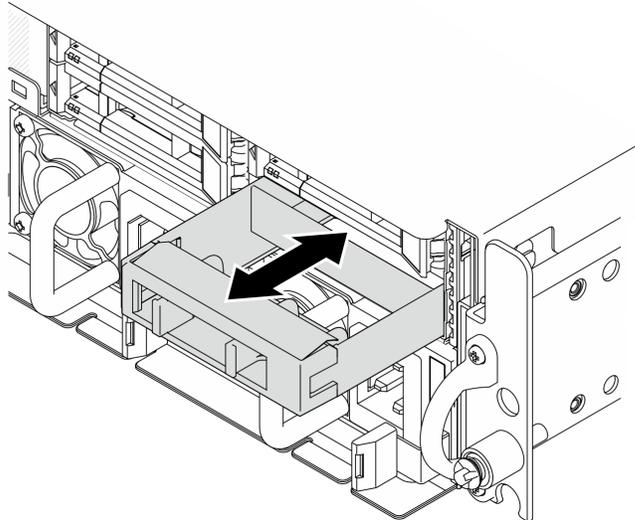
Figura 55. Instalación de un relleno de unidad
