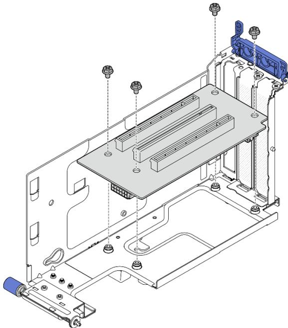
Figura 143. Extracción de la tarjeta de expansión de la expansión PCIe 2
