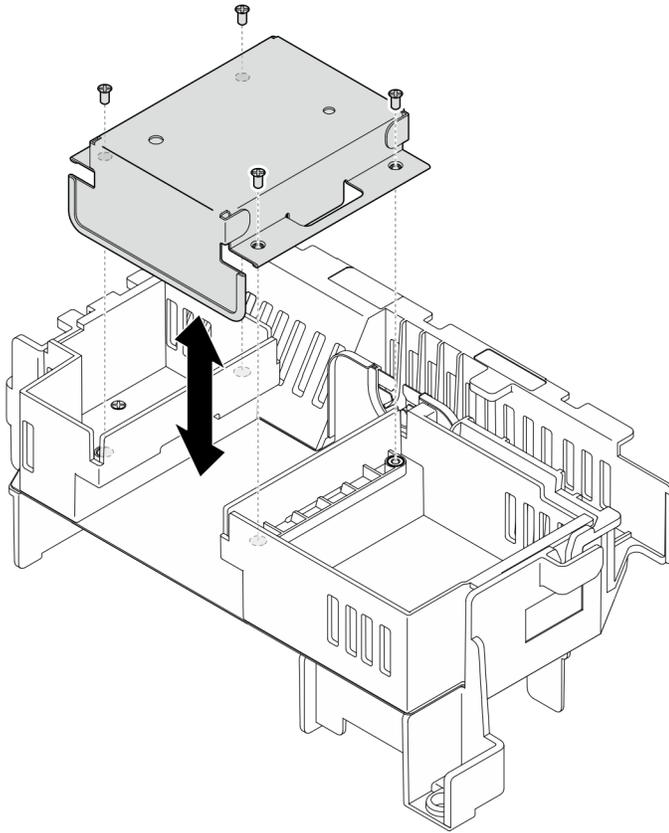
Figura 35. Sustitución del relleno central
