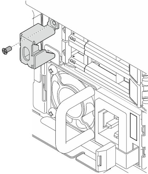
Figura 179. Instalación del soporte de bloqueo del marco biselado de seguridad
