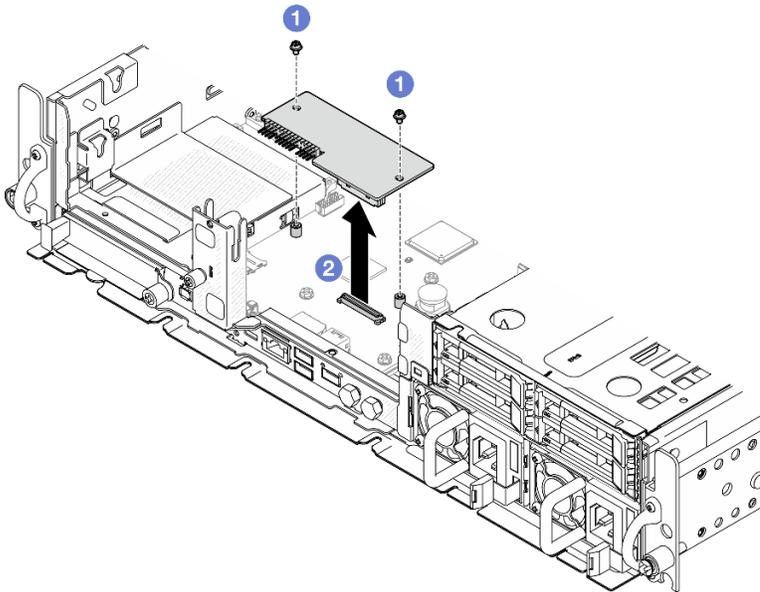
Figura 184. Extracción del firmware y módulo de seguridad de RoT
