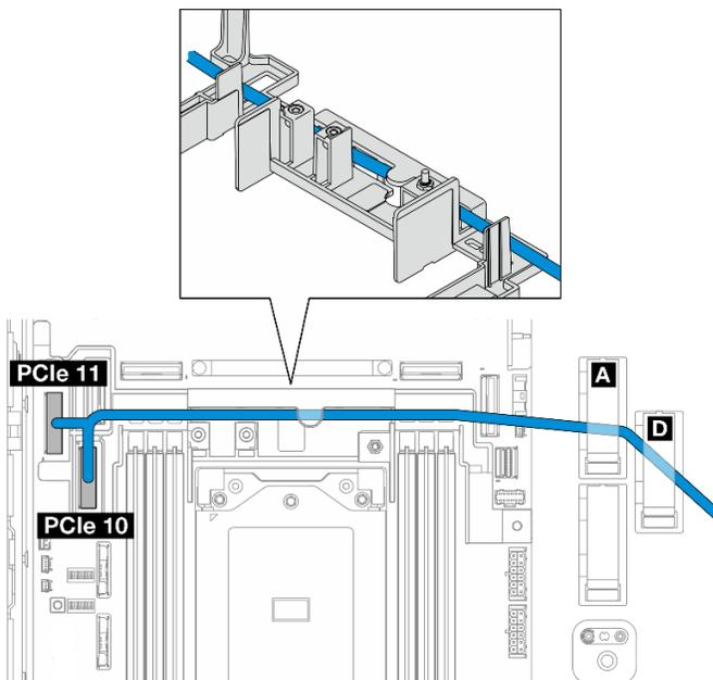
Figura 222. Cable de señal de BP frontal
