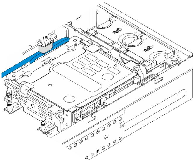
*Figura 65. Cables asegurados por el clip para cables del deflector de aire del procesador*
