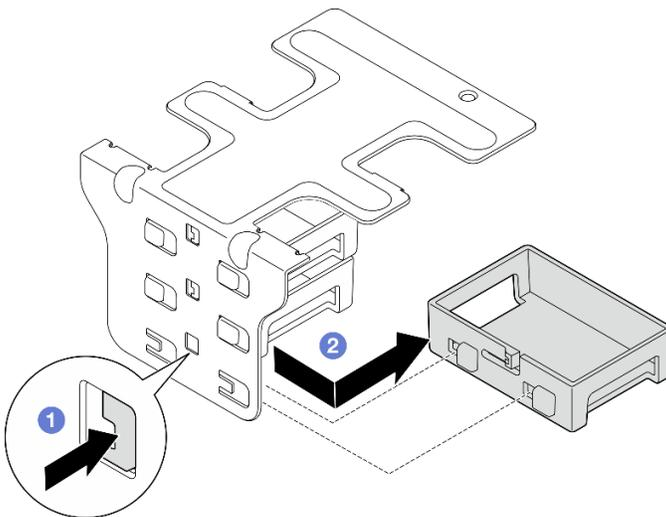
Figura 116. Extracción del relleno de bajo perfil
