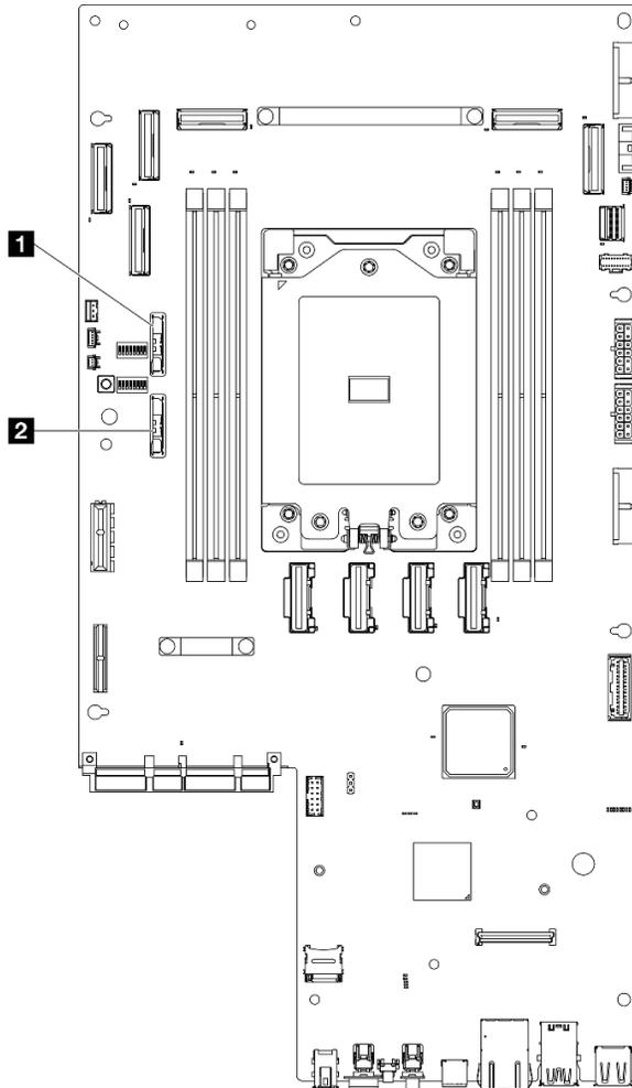
Figura 46. Ubicaciones de la batería de CMOS en la placa del sistema
