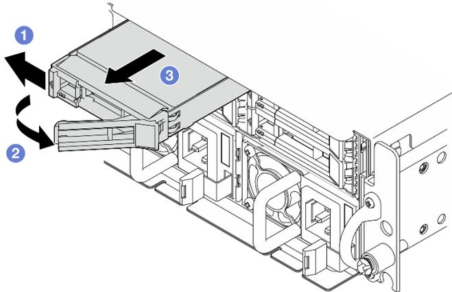
Figura 54. Extracción de una unidad de intercambio en caliente frontal
