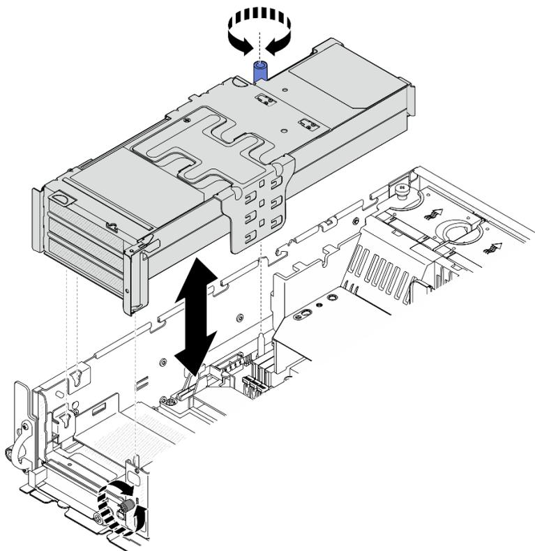
Figura 132. Instalación de la expansión de PCIe 1
