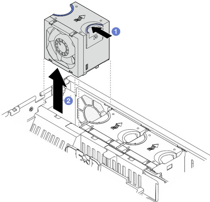
Figura 48. Extracción de un módulo de ventilador
