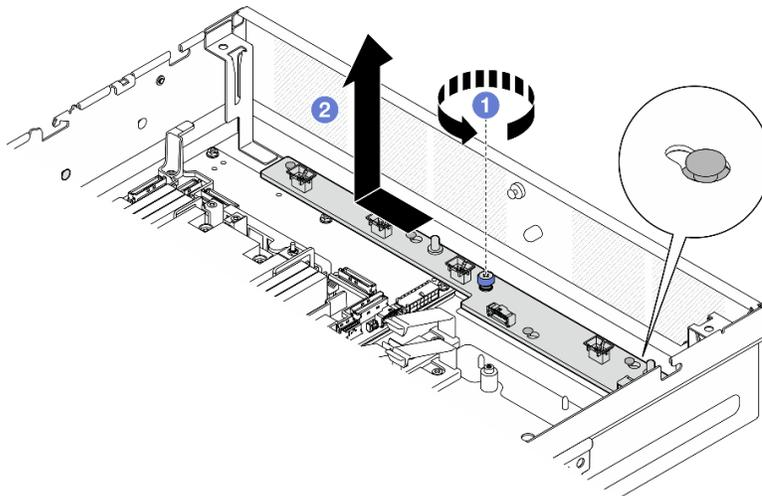
Figura 51. Extracción de la placa de control del ventilador
