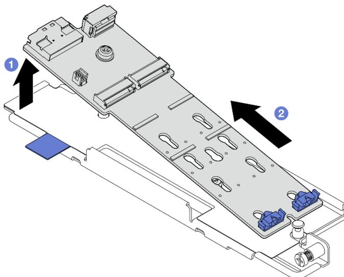
Figura 87. Extracción de la placa posterior M.2
