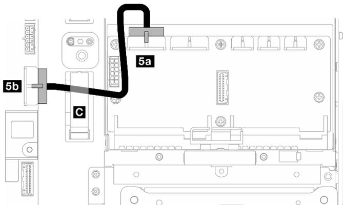
Figura 205. Disposición de los cables de alimentación de la placa del sistema 1
