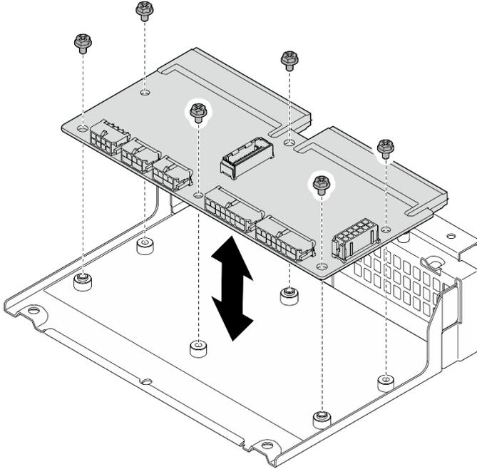
Figura 150. Extracción de la placa de distribución de alimentación
