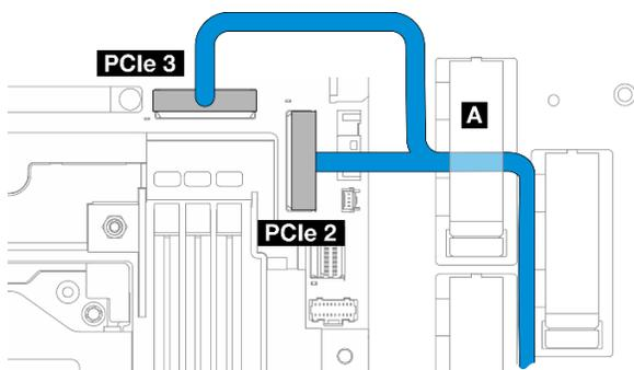
Figura 215. Cables de señal de BP interno
