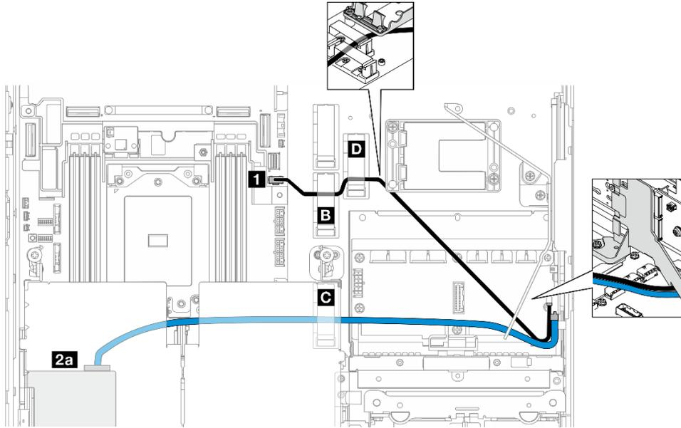
Figura 206. Adaptador RAID en expansión de PCIe 1
