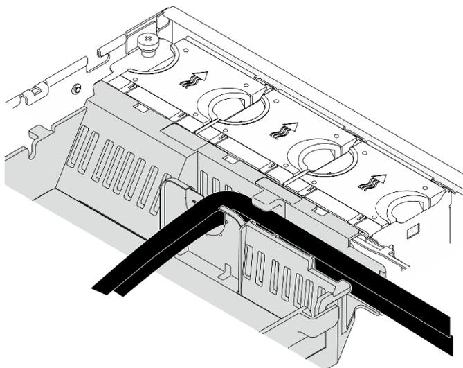
*Figura 106. Cables de alimentación de GPU en el deflector de aire del procesador*
