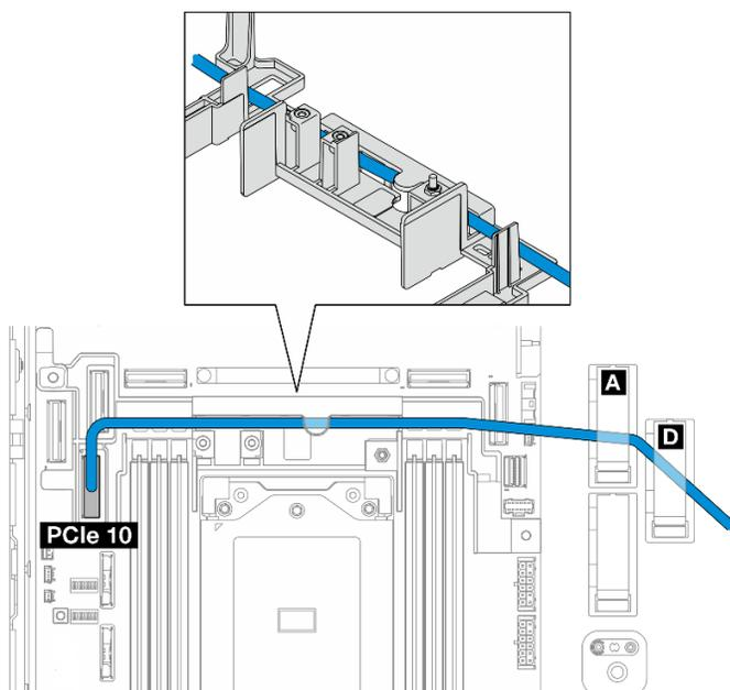
2. Disponga el cable de señal de BP frontal a través de la pared para cable; luego, fíjelo en el clip para cables **A** y **D**.
