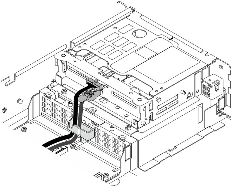
Figura 60. Disposición de los cables de la placa posterior de la unidad frontal
