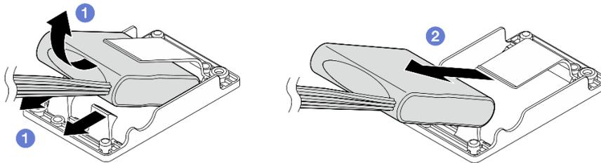
Figura 163. Extracción del módulo de alimentación flash RAID
