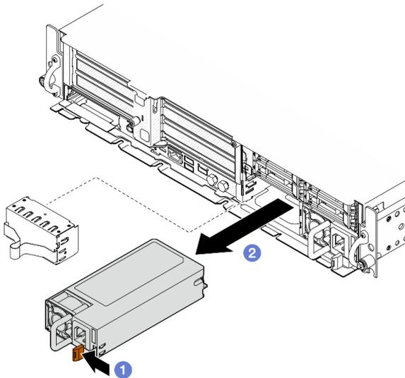
Figura 154. Extracción de la unidad de fuente de alimentación
