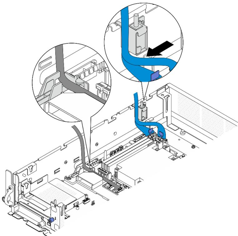
Figura 131. Disposición de los cables de la expansión de PCIe 1
