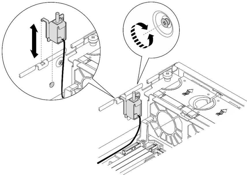
Figura 80. Instalación del conmutador de intrusión
