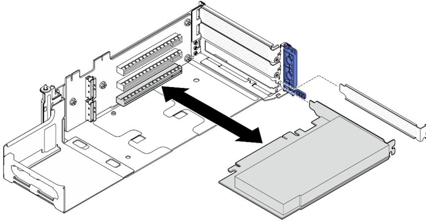
Figura 124. Instalación de un adaptador PCIe en la tarjeta de expansión PCIe 1
