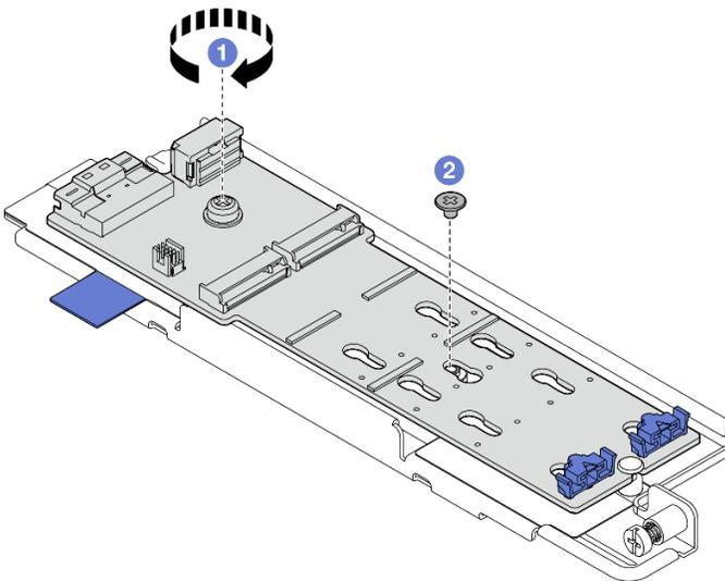
Figura 89. Instalación de la placa posterior M.2
