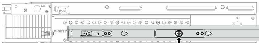
Figura 8. Un tornillo para el riel interno de Kit de rieles de fricción de 2 columnas ThinkEdge
