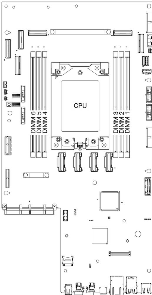
Figura 98. Diseño de los módulos de memoria y el procesador
