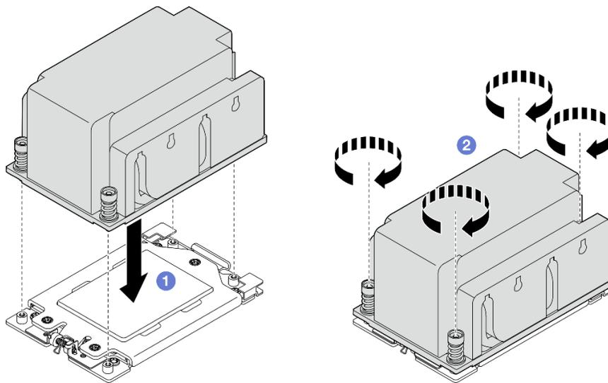
Figura 162. Instalación del disipador de calor 2U
