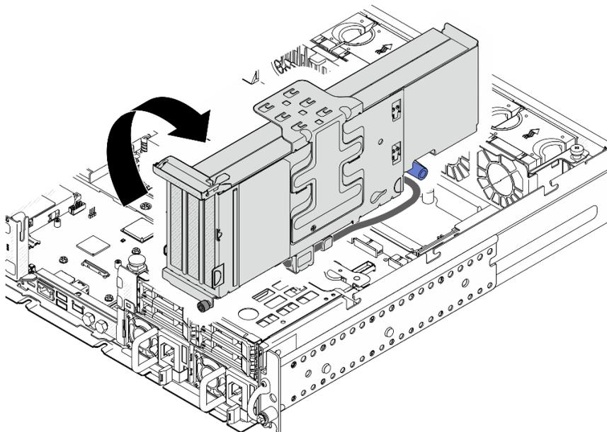
Figura 114. Colocar la expansión PCIe 2 a un lado del chasis
