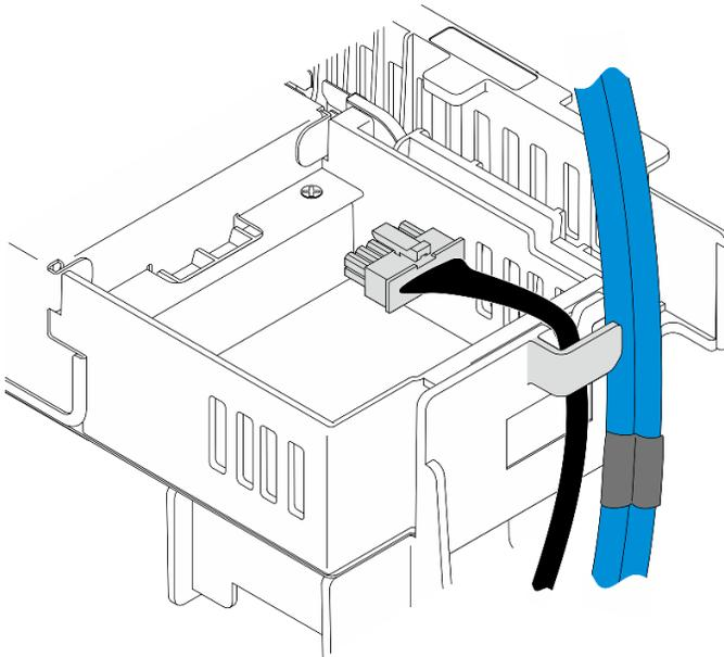
Figura 69. Cables de la placa posterior interna en el clip de cable
