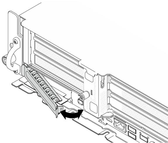
Figura 104. Extracción del relleno de OCP
