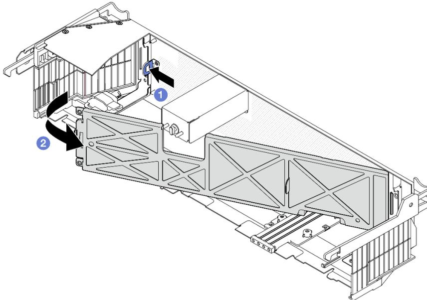
Figura 172. Extracción del filtro de polvo
