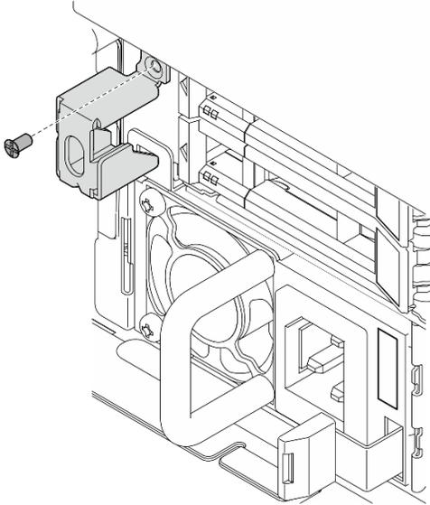
Figura 176. Extracción del soporte de bloqueo del marco biselado de seguridad
