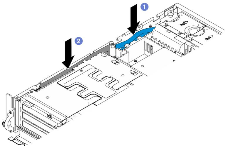
Figura 133. Disposición de los cables de señal de la tarjeta de expansión PCIe 1
