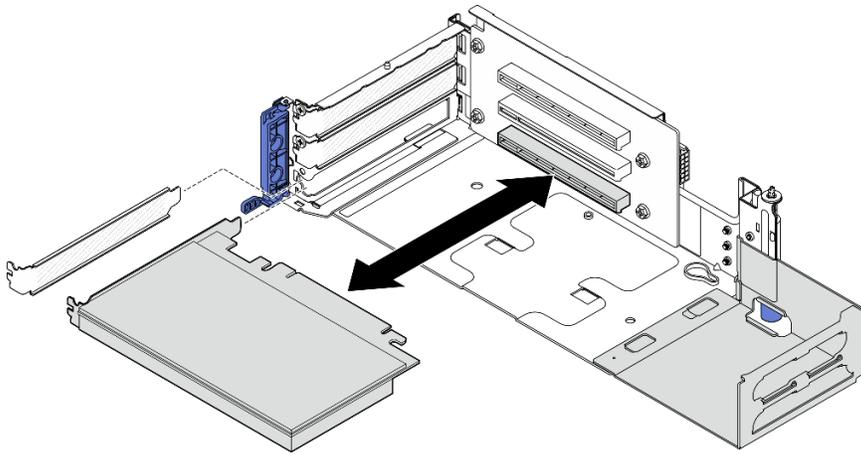
Figura 125. Instalación de un adaptador PCIe en la tarjeta de expansión PCIe 2
