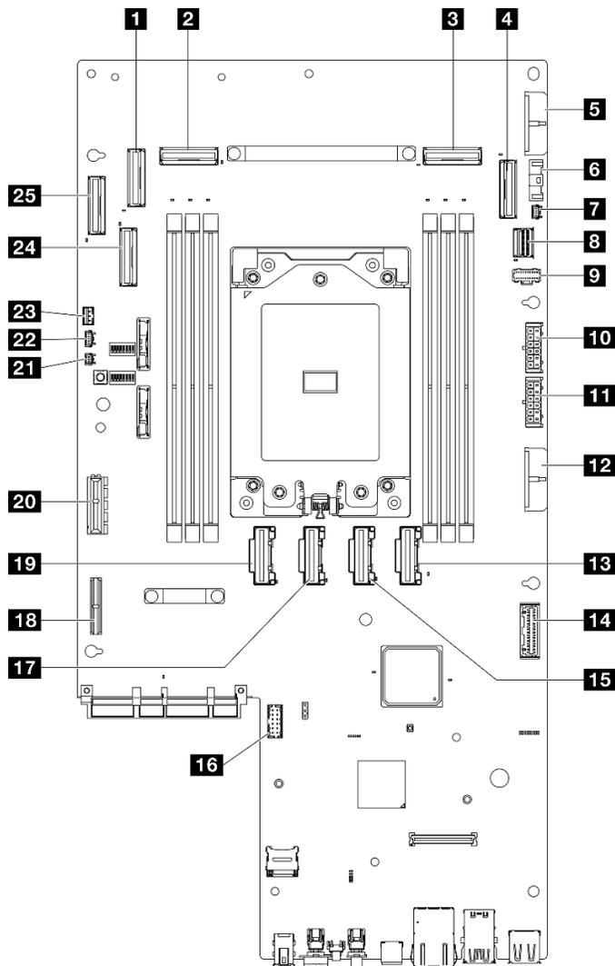
Figura 202. Conectores de la placa del sistema
