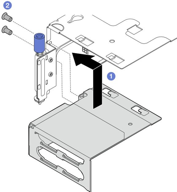
Figura 123. Instalación del amplificador de la tarjeta de expansión PCIe 2
