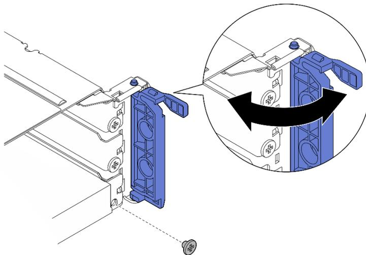
Figura 126. Instalación de los tornillos de sujeción
