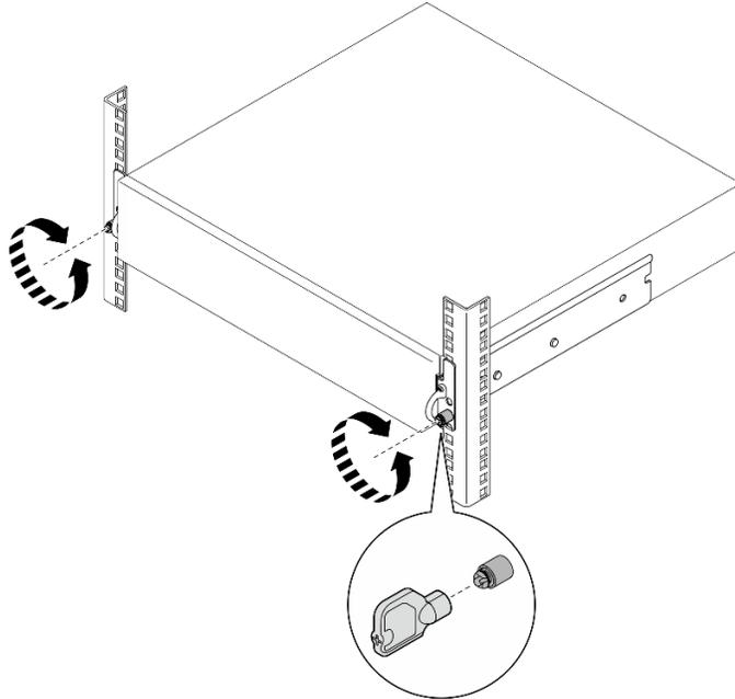
Figura 3. Desenganche del servidor del bastidor: soportes EIA de seguridad
