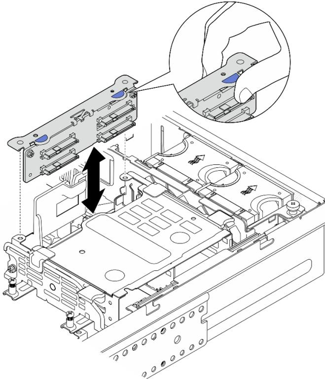
*Figura 111. Extracción de la placa posterior de la unidad interna*
