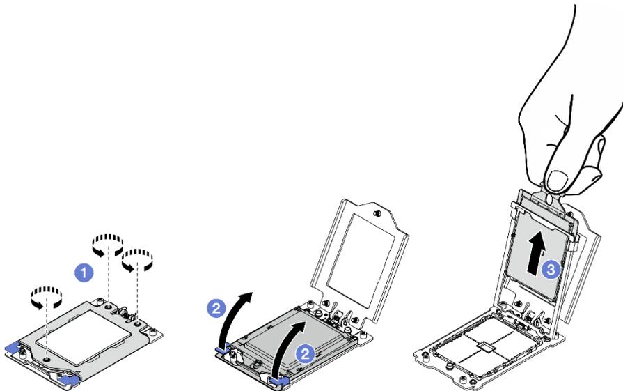
Figura 158. Extracción de un procesador
