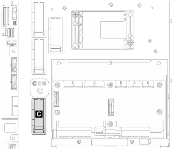
Figura 221. Clip para cables C
