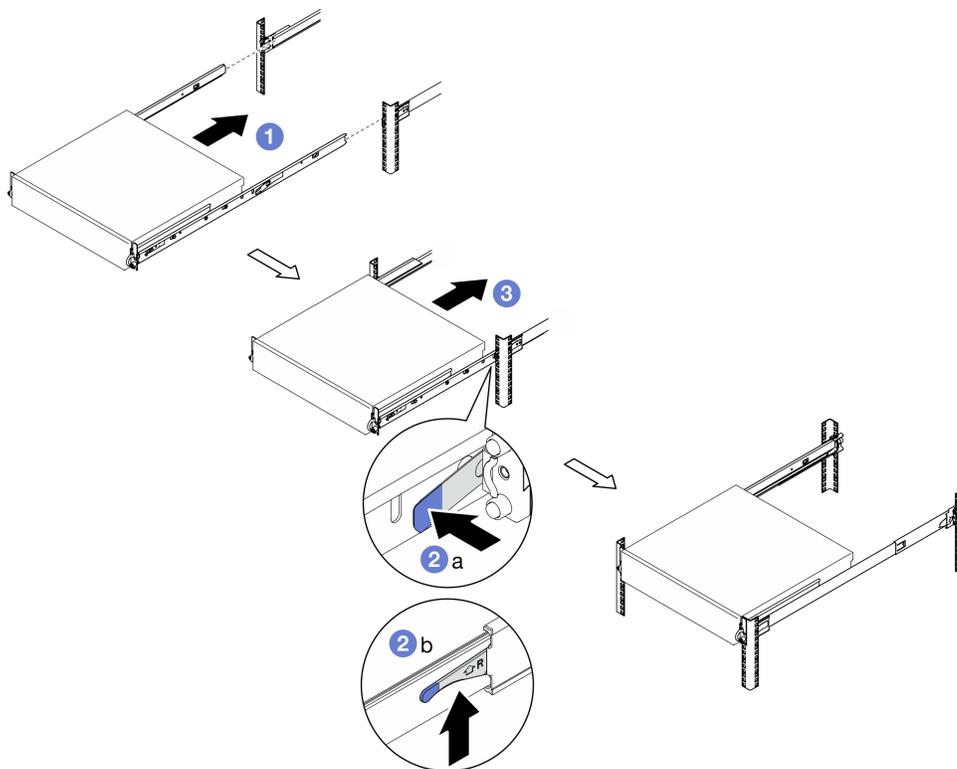
Figura 22. Instalación del servidor en el bastidor
