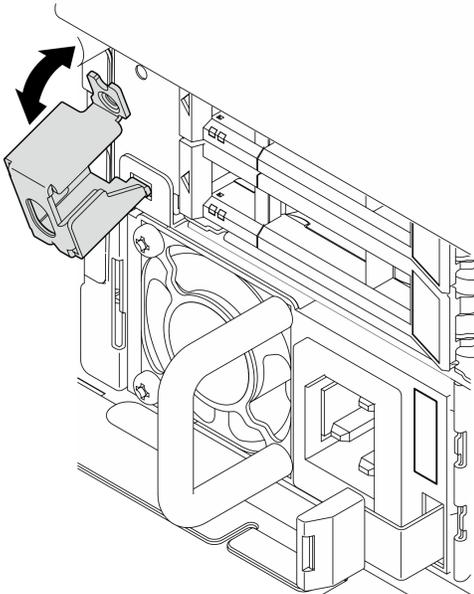
*Figura 178. Instalación del soporte de bloqueo del marco biselado de seguridad*
