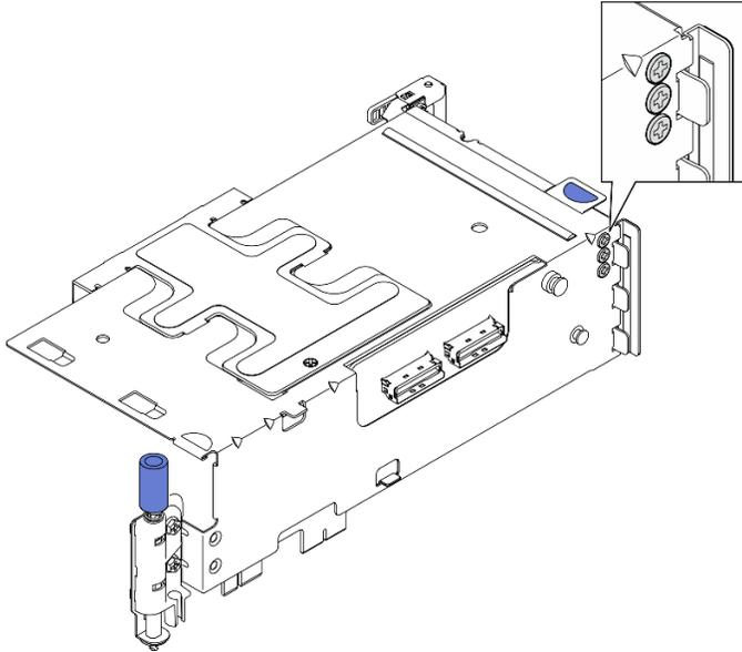
Figura 127. Tornillos de repuesto de la tarjeta de expansión PCIe 1
