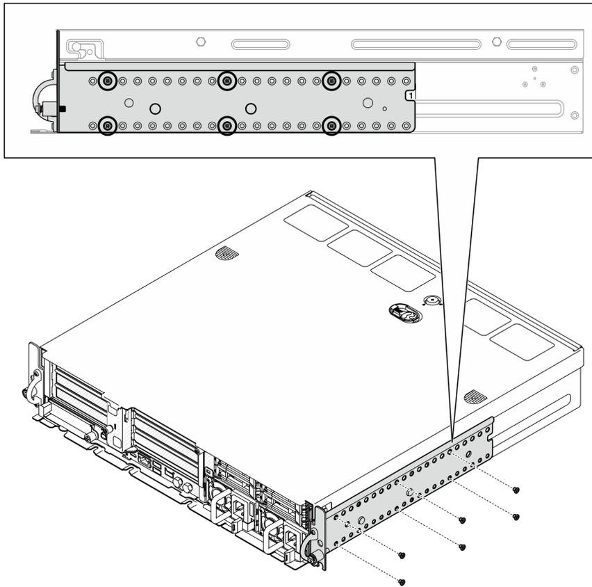
Figura 14. Profundidad regular 1 a 6 del soporte EIA: seis tornillos
