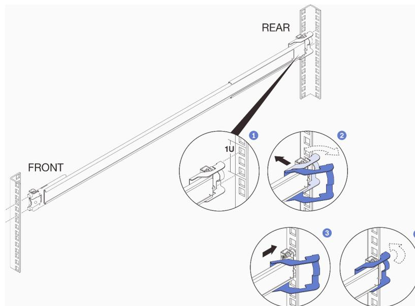
**Installez le support de montage avant sur l'armoire :**
