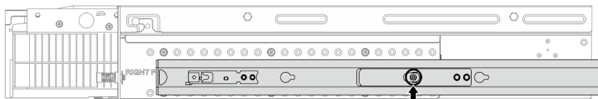
図8. ThinkEdge 2 ポスト・フリクシオン・レール・キットの内側レールに対してねじ1本
