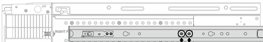
Figura 33. Dois parafusos do trilho interno de Kit de trilho de fricção ThinkEdge de 1.000 mm v2
