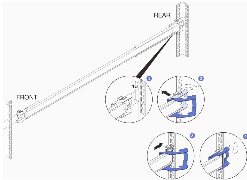
**将前端安装支架安装到机架上：**
