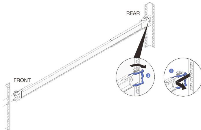
重复上述步骤，卸下另一根导轨的前端和后端安装支架。
