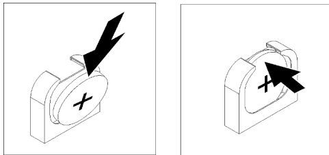
Abbildung 24. Einsetzen der CMOS-Batterie – CR2032
