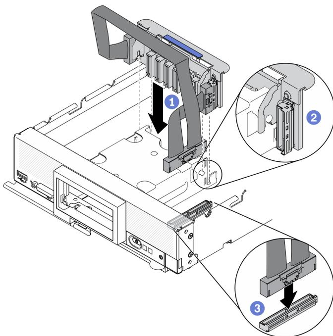
Figura 36. Installazione dell'insieme backplane EDSFF
