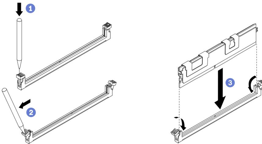
Figura 33. Installazione del modulo di memoria
