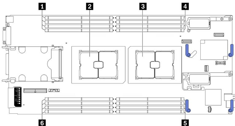
Figura 49. Modulo di memoria e posizione del processore
