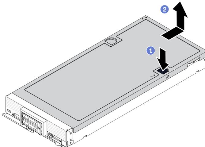
Figura 14. Rimozione del coperchio del nodo di elaborazione
