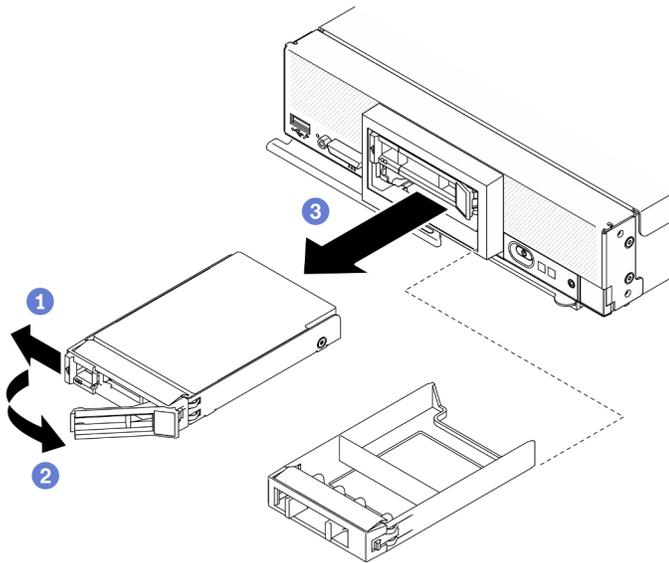
Figura 16. Rimozione di un'unità hot-swap da 2,5"
