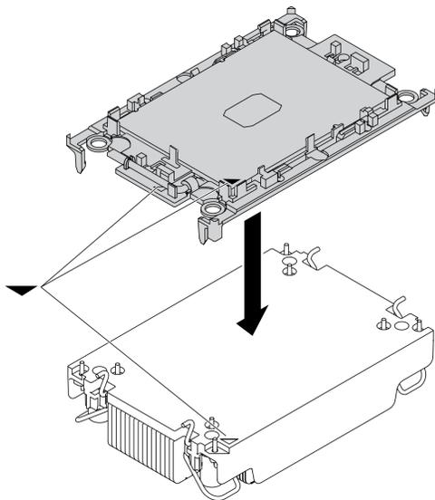
Figura 30. Assemblaggio del PHM
