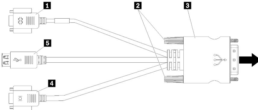
Figura 8. Connettori e componenti sul cavo KVM
