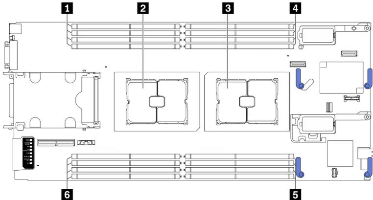
Figura 12. Modulo di memoria e posizione del processore
