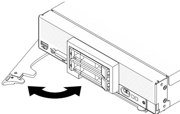
Figura 48. Installazione del nodo di elaborazione nello chassis
