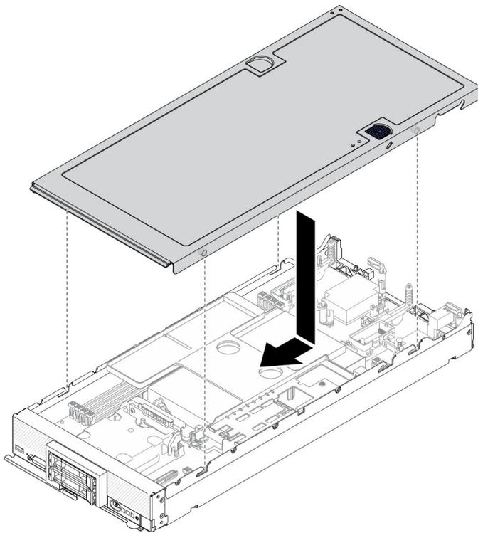
Figura 47. Installazione del coperchio del nodo di elaborazione
