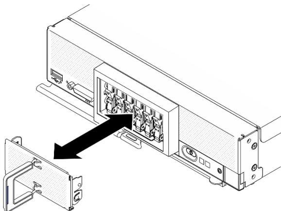
Figura 44. Installazione della mascherina del telaio unità EDSFF
