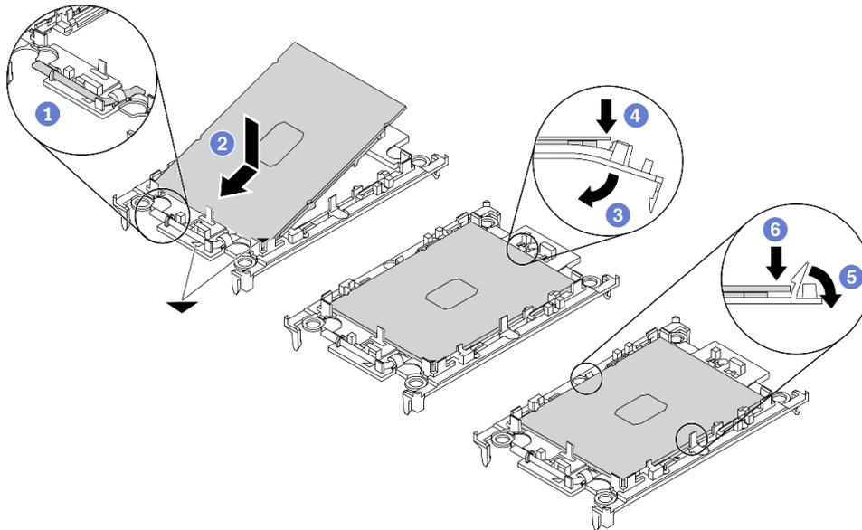
Figura 28. Installazione di una piastra del processore
