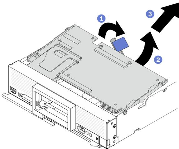
Figura 20. Rimozione dell'adattatore RAID
