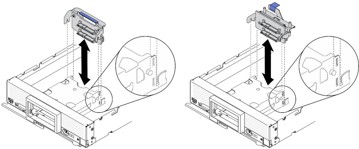
Figura 23. Rimozione del backplane dell'unità da 2,5"
