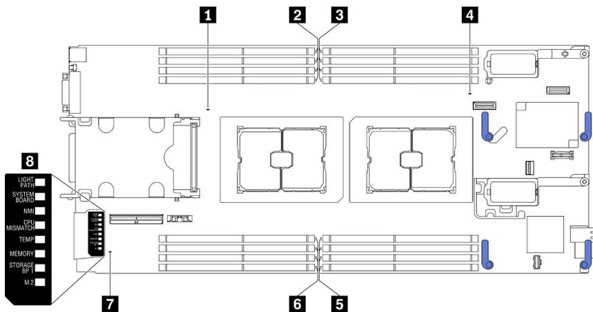
Figura 7. LED della scheda di sistema
