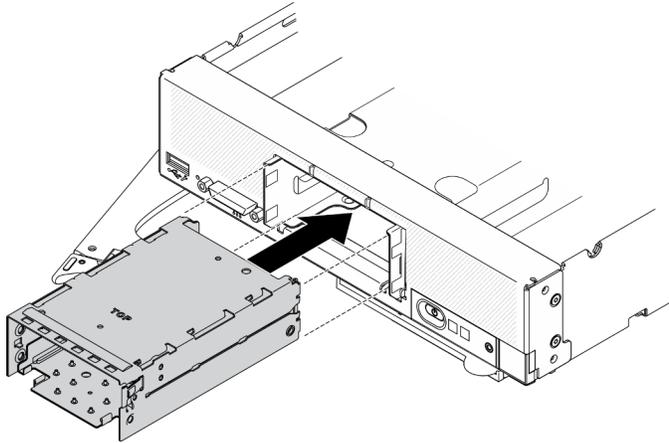
Figura 37. Installazione del telaio dello storage EDSFF
