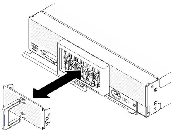
Figura 41. Rimozione della mascherina del telaio unità EDSFF
