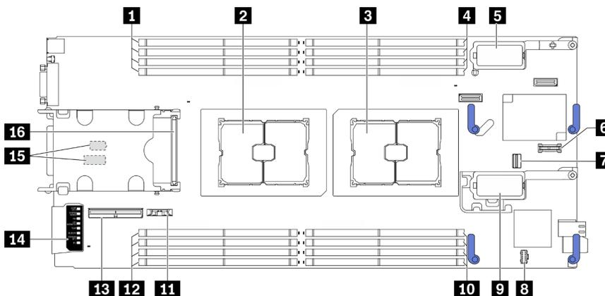
Figura 9. Connettori della scheda di sistema
