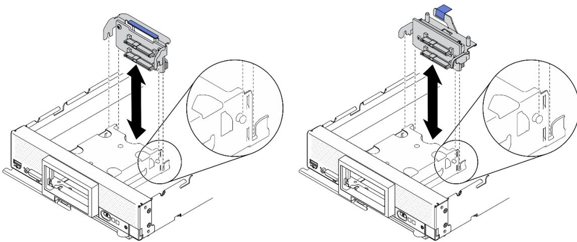
Figura 34. Installazione del backplane dell'unità da 2,5"
