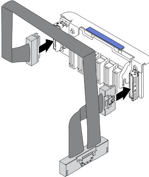
Figura 35. Collegamento del cavo al backplane dell'unità EDSFF
