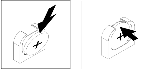
図23. CMOS バッテリー - CR2032 の取り付け
