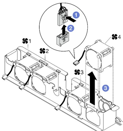
Рис. 30. Снятие вентилятора
