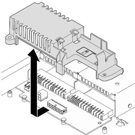
Рис. 87. Снятие кожуха платы распределения питания
