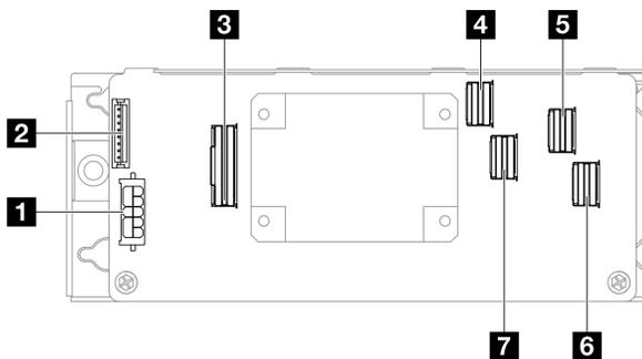
Рис. 123. Разъемы адаптера RAID 16i CFF
