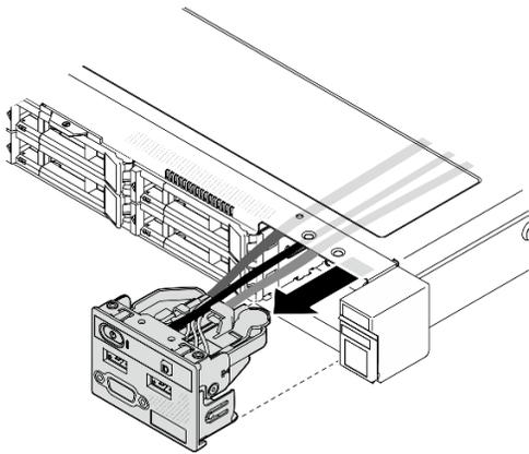
Рис. 35. Снятие переднего модуля ввода-вывода
