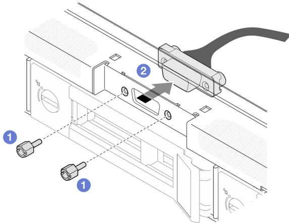
Рис. 119. Снятие кабеля VGA
