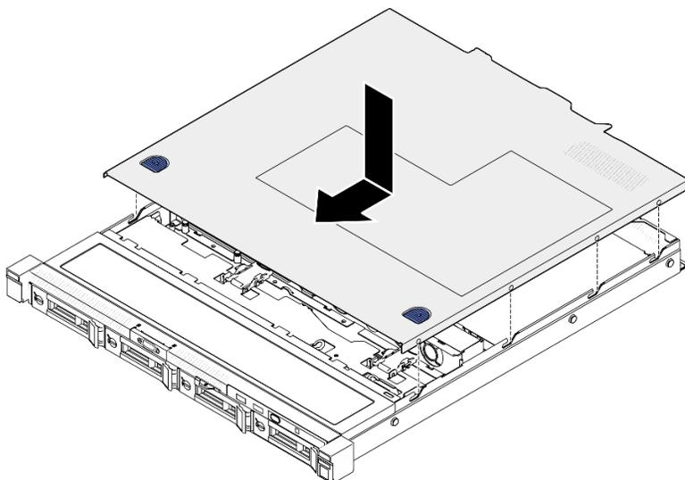
Рис. 115. Установка верхнего кожуха
