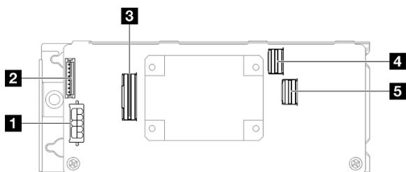
Рис. 122. Разъемы адаптера RAID 8i CFF
