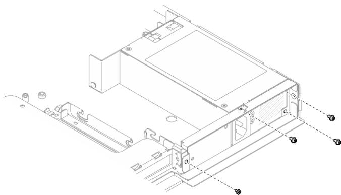
Рис. 80. Установка винтов задней скобы
