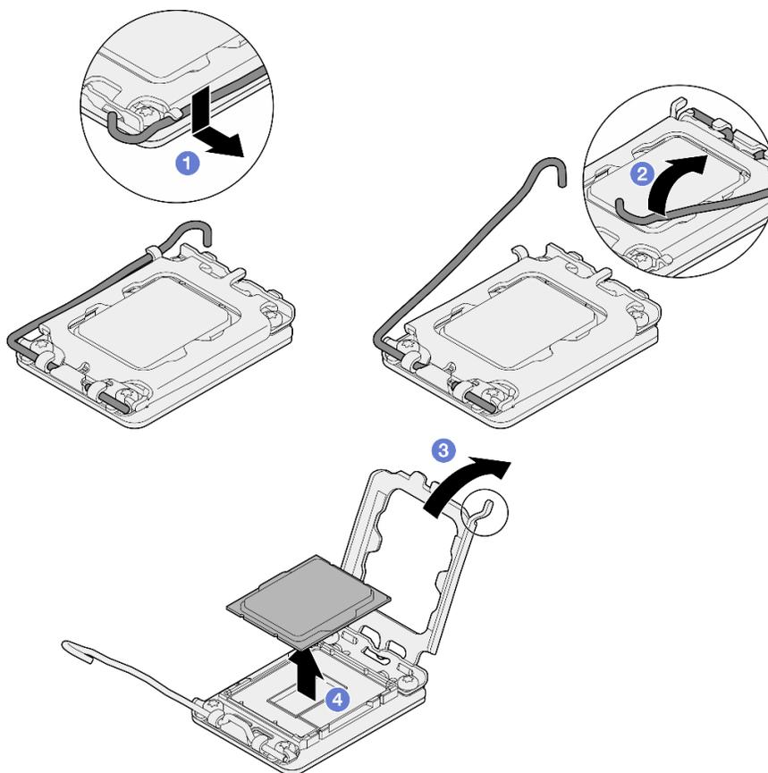
Рис. 94. Открытие фиксатора процессора
