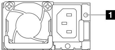
Рис. 157. Светодиодный индикатор оперативно заменяемого модуля блока питания
