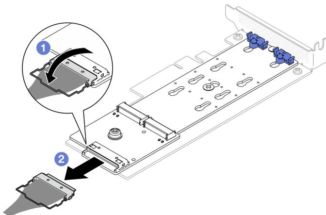
Рис. 52. Отключение кабеля от адаптера загрузки M.2 SATA/NVMe
