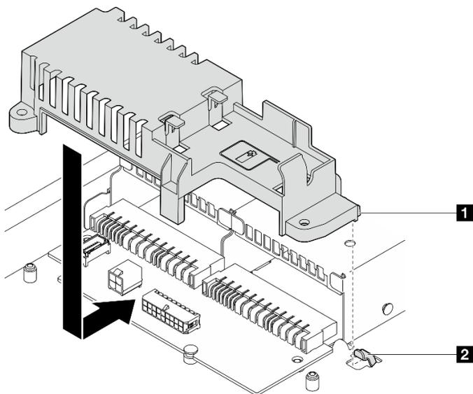
Рис. 92. Установка кожуха платы распределения питания
