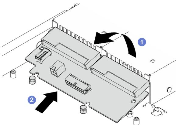
Рис. 89. Снятие платы распределения питания
