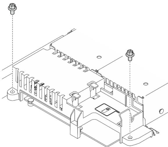
Рис. 86. Снятие винтов кожуха платы распределения питания
