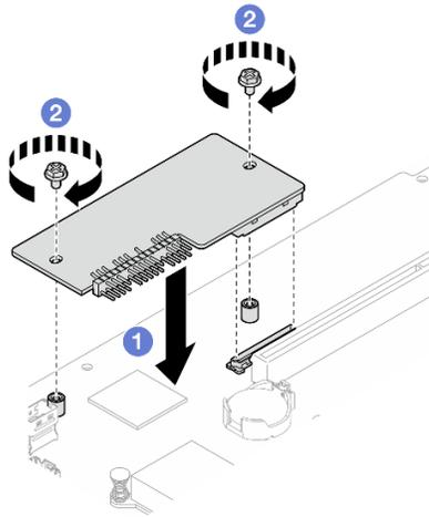
Рис. 109. Установка модуля безопасности микропрограммы и RoT
