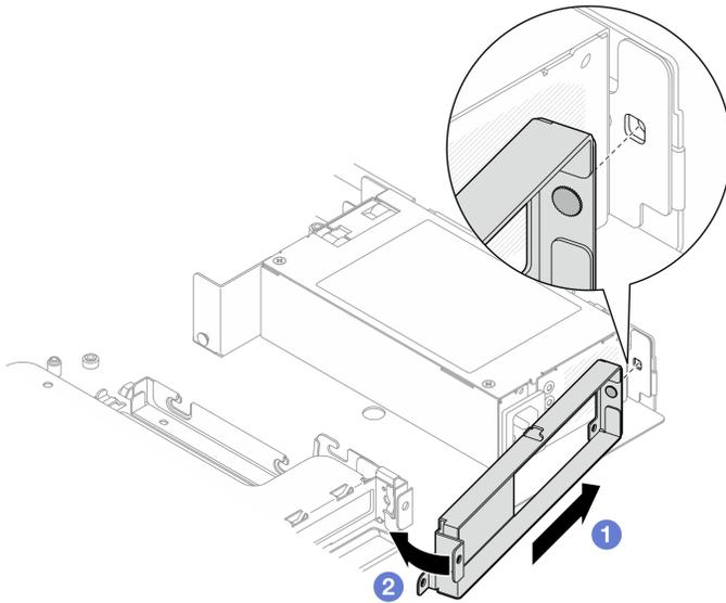
Рис. 79. Установка задней скобы
