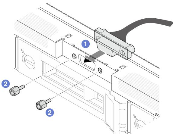
Рис. 120. Установка кабеля VGA
