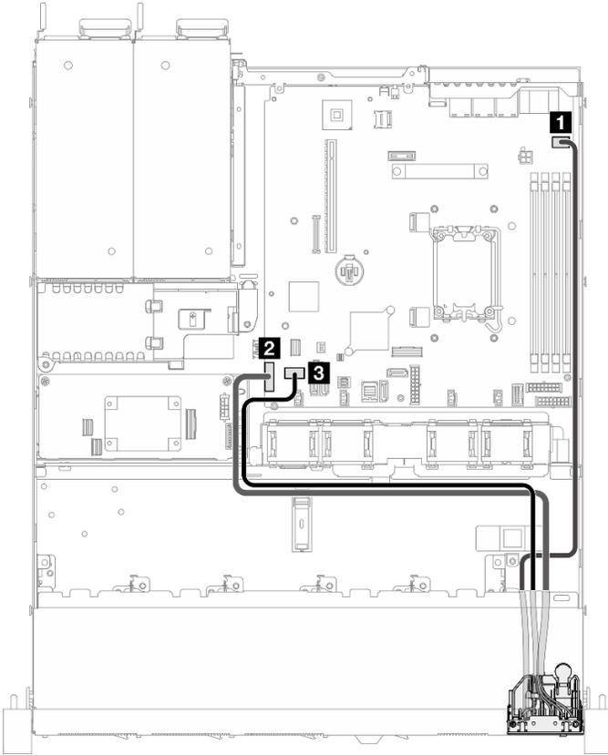
Рис. 130. Прокладка кабелей переднего модуля ввода-вывода для модели с 2,5-дюймовыми дисками
