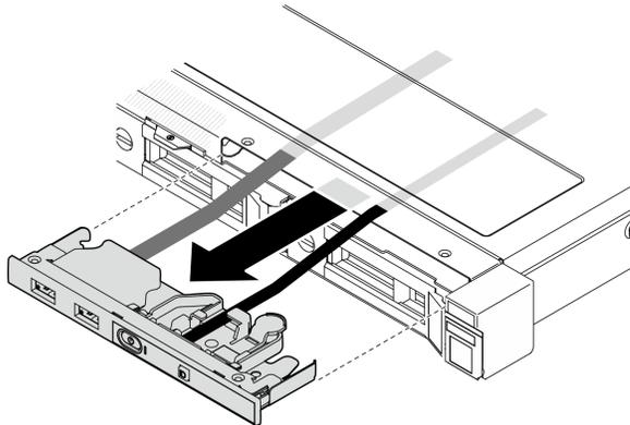
Рис. 39. Снятие переднего модуля ввода-вывода
