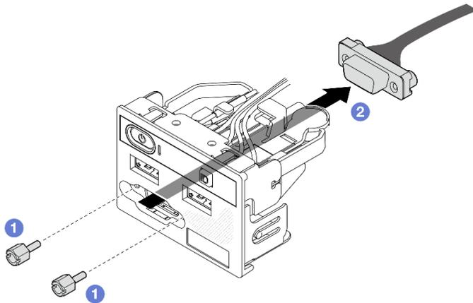
Рис. 116. Снятие кабеля VGA
