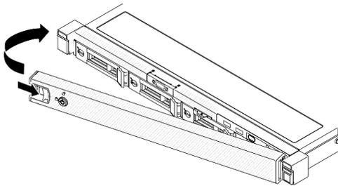
Рис. 106. Установка защитной панели
