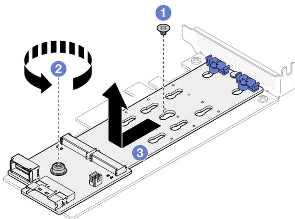
Рис. 53. Снятие адаптера загрузки M.2
