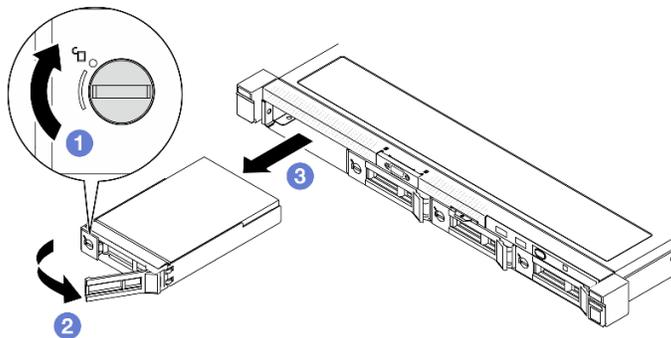
Рис. 24. Снятие диска с обычной заменой
