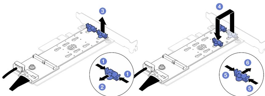
Рис. 54. Регулировка фиксатора M.2
