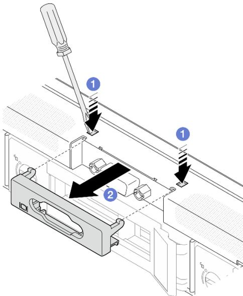
Рис. 118. Снятие крышки кабеля VGA
