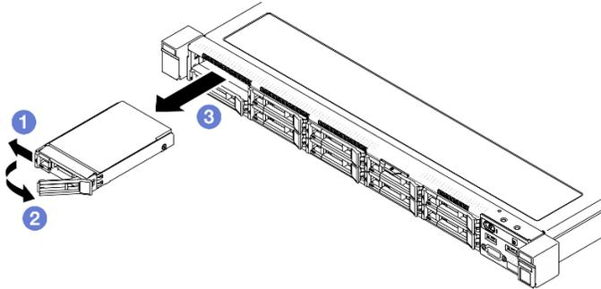
Рис. 26. Снятие 2,5-дюймового оперативно заменяемого диска
