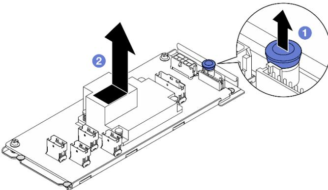
Рис. 16. Снятие внутреннего адаптера CFF
