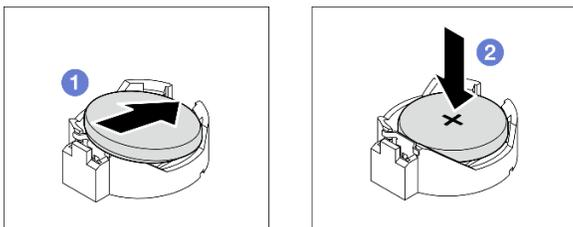
Рис. 23. Установка батарейки CMOS
