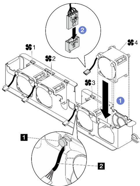
Рис. 31. Установка вентилятора
