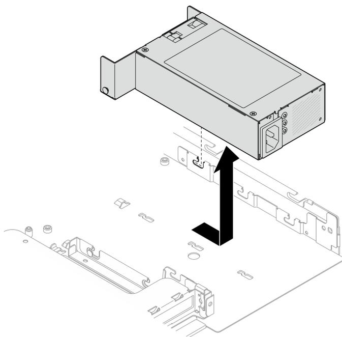
Рис. 77. Снятие модуля стационарного блока питания
