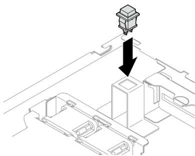
Рис. 49. Установка датчика вмешательства
