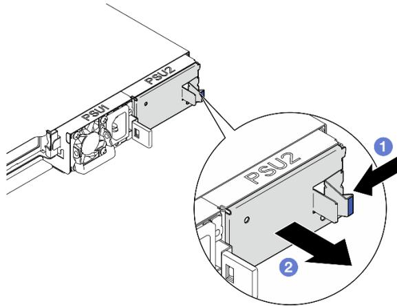
Рис. 84. Снятие заглушки модуля блока питания
