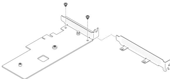
Рис. 55. Установка низкопрофильной скобы
