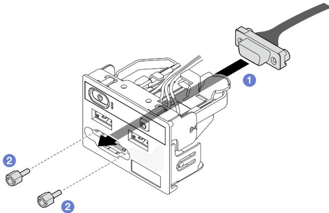
Рис. 117. Установка кабеля VGA
