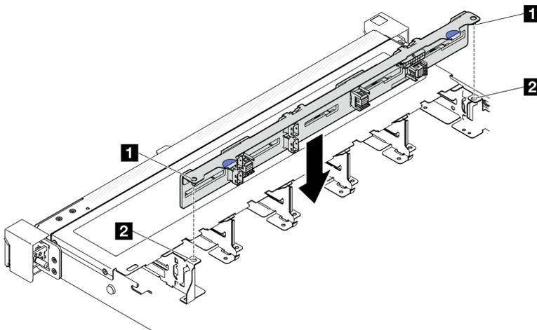
Рис. 4. Установка объединительной панели с 10 отсеками для 2,5-дюймовых оперативно заменяемых дисков
