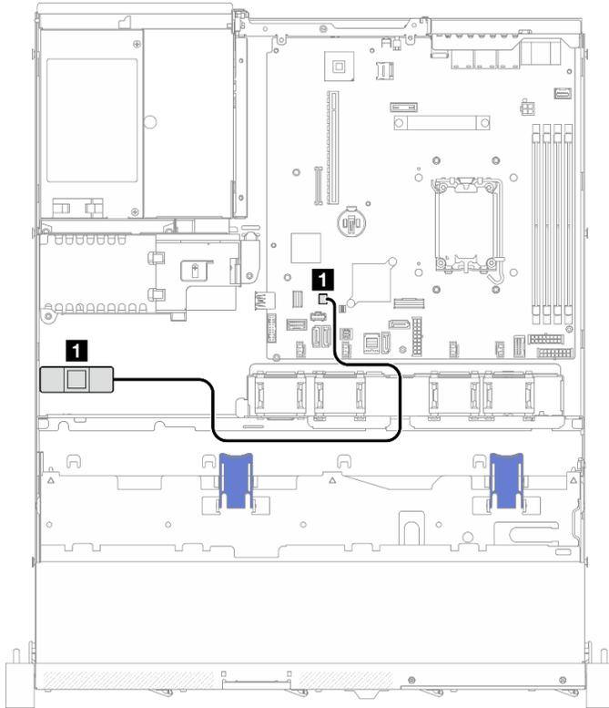
Рис. 135. Прокладка кабелей датчика вмешательства для 3,5-дюймовой модели
