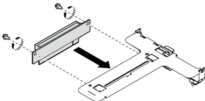
Рис. 71. Установка платы-адаптера Riser PCIe
