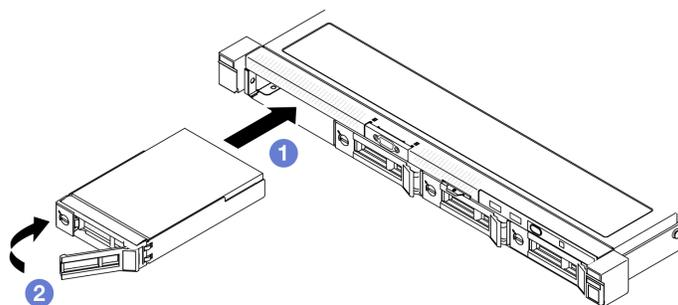
Рис. 25. Установка диска с обычной заменой
