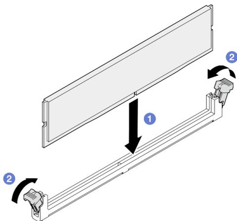
Рис. 64. Установка модуля памяти
