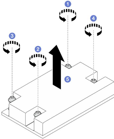
Рис. 42. Снятие радиатора
