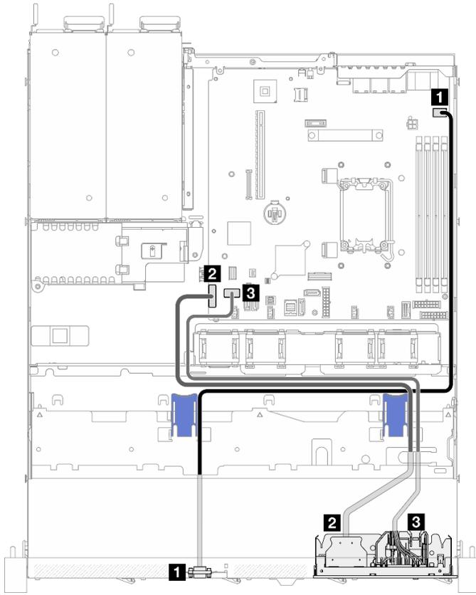
Рис. 129. Прокладка кабелей переднего модуля ввода-вывода для модели с 3,5-дюймовыми дисками
