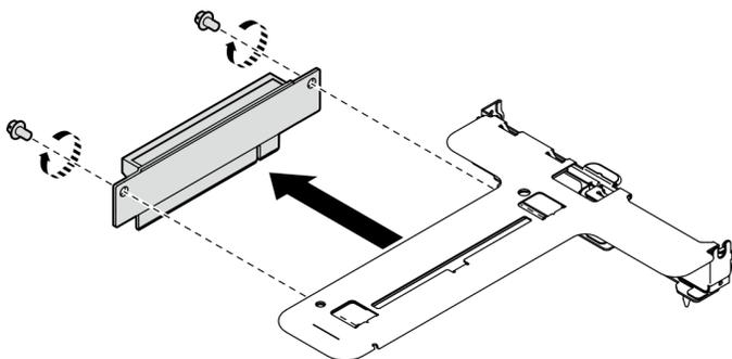
Рис. 66. Снятие платы-адаптера Riser PCIe
