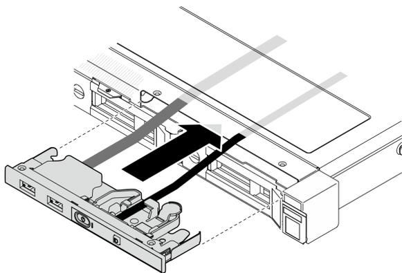
Рис. 40. Установка модуля ввода-вывода
