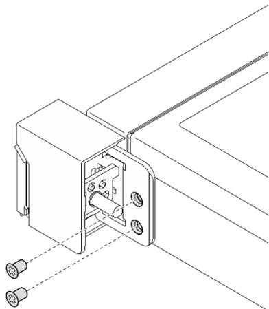
*Рис. 102. Установка защелок стойки*
