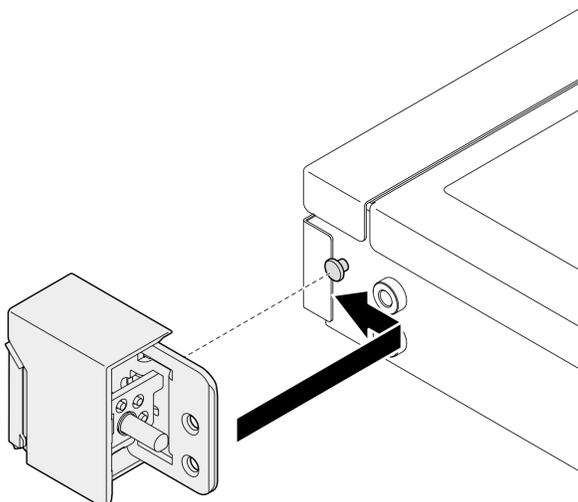
*Рис. 101. Установка защелок стойки*
