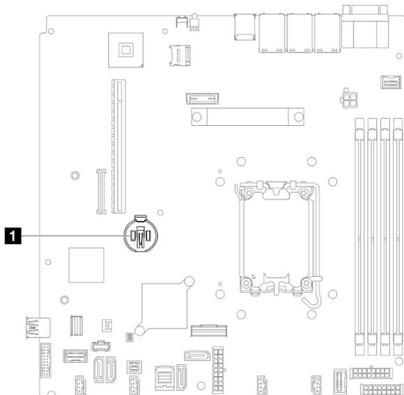
Рис. 20. Расположение батарейки CMOS
