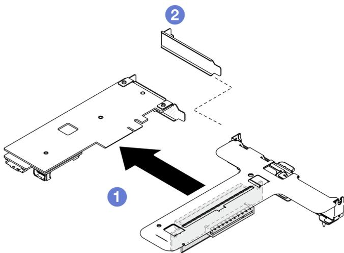
Рис. 68. Снятие адаптера PCIe (гнездо 2)
