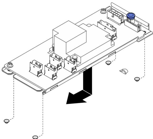
Рис. 19. Установка внутреннего адаптера CFF
