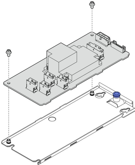
Рис. 18. Установка лотка внутреннего адаптера CFF
