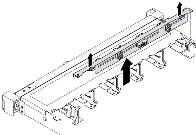
Рис. 3. Снятие объединительной панели с 8 отсеками для 2,5-дюймовых оперативно заменяемых дисков
