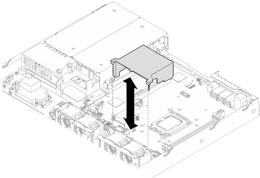
Рис. 14. Снятие дефлектора
