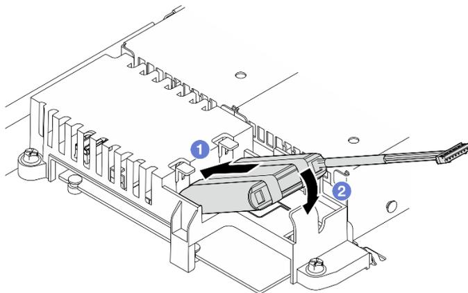
Рис. 33. Установка модуля питания флэш-памяти
