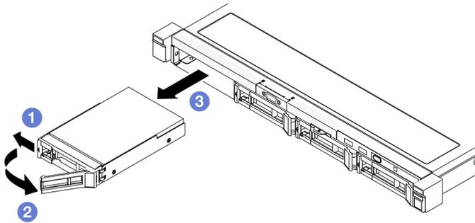
Рис. 27. Снятие 3,5-дюймового оперативно заменяемого диска
