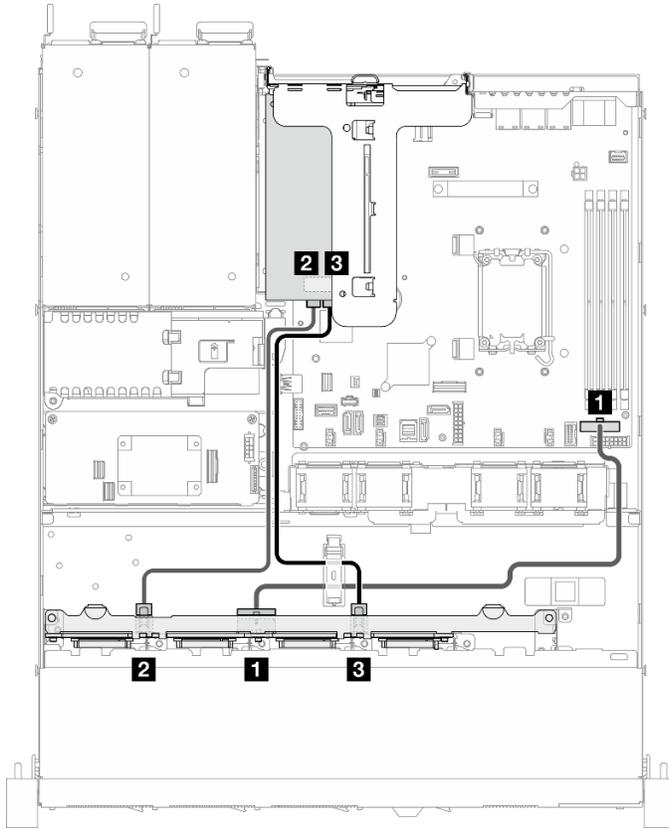
Рис. 145. Восемь дисков SATA/SAS с одним 8i (аппаратный массив RAID/HBA)
