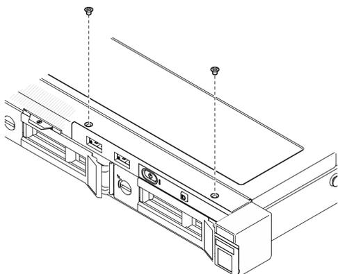
Рис. 41. Установка модуля ввода-вывода
