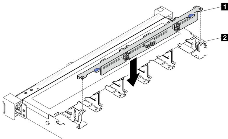
Рис. 5. Установка объединительной панели с 8 отсеками для 2,5-дюймовых оперативно заменяемых дисков
