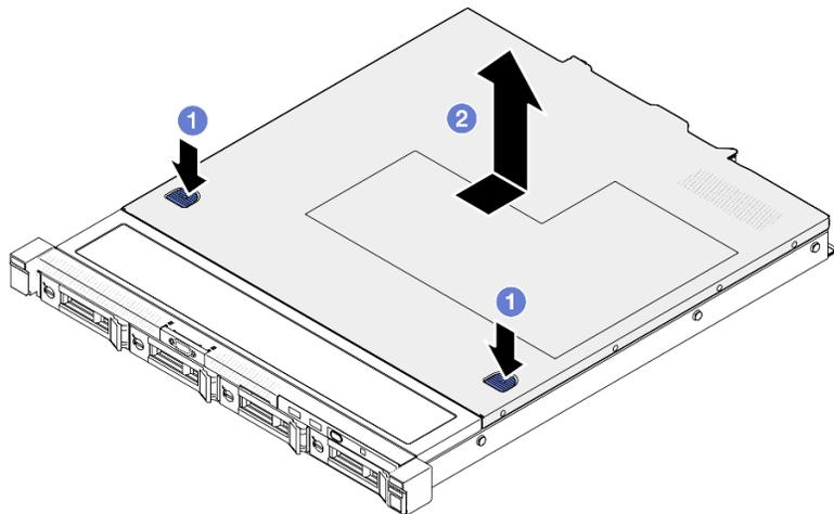
Рис. 114. Снятие верхнего кожуха
