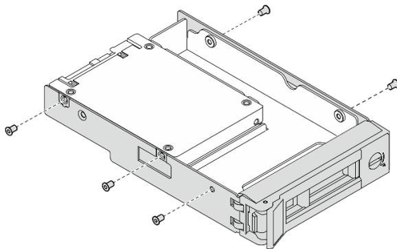
Рис. 6. Снятие винтов с адаптера для дисков
