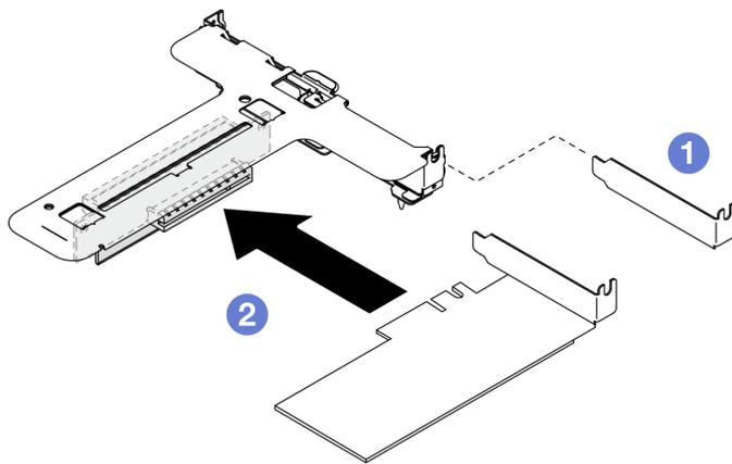
Рис. 69. Установка адаптера PCIe (гнездо 1)
