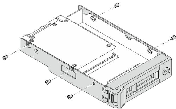
Рис. 9. Установка винтов на адаптер для дисков
