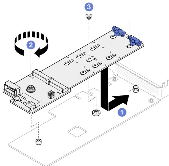
Рис. 56. Установка адаптера загрузки M.2
