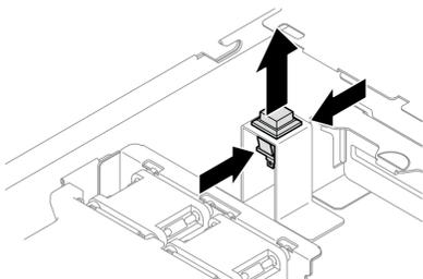
Рис. 46. Снятие датчика вмешательства
