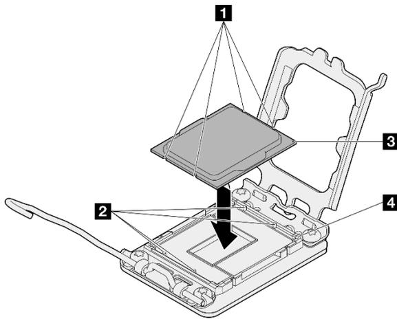
Рис. 95. Установка процессора
