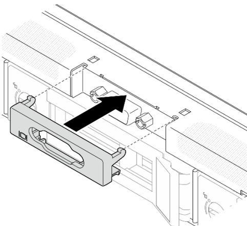
Рис. 121. Установка кожуха VGA
