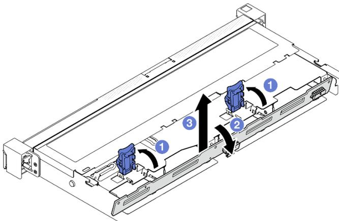
Рис. 12. Снятие задней панели
