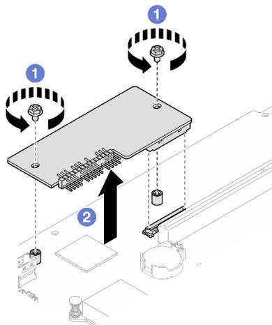
Рис. 108. Снятие модуля безопасности микропрограммы и RoT
