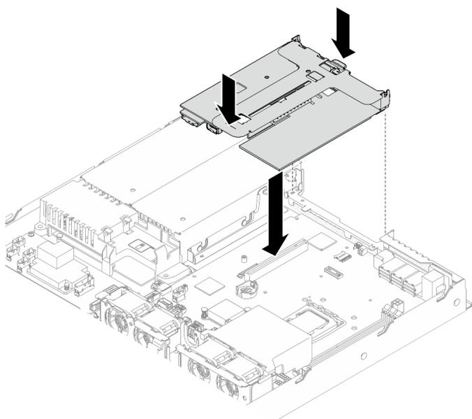
Рис. 72. Установка блока платы-адаптера Riser PCIe
