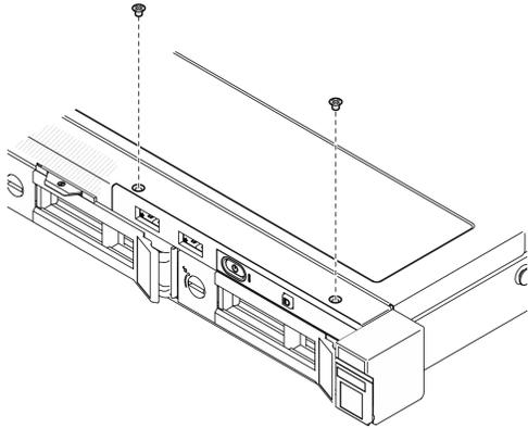
Рис. 38. Снятие переднего модуля ввода-вывода
