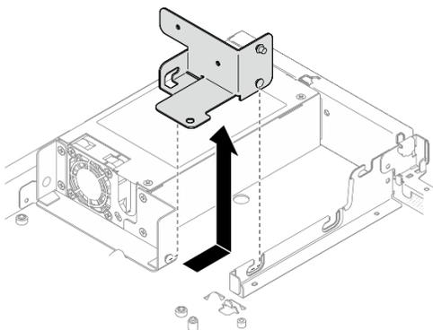
Рис. 74. Снятие скобы модуля блока питания
