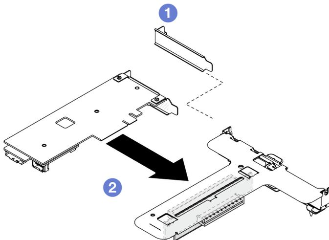
Рис. 70. Установка адаптера PCIe (гнездо 2)
