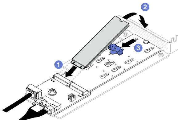
Рис. 60. Установка диска M.2
