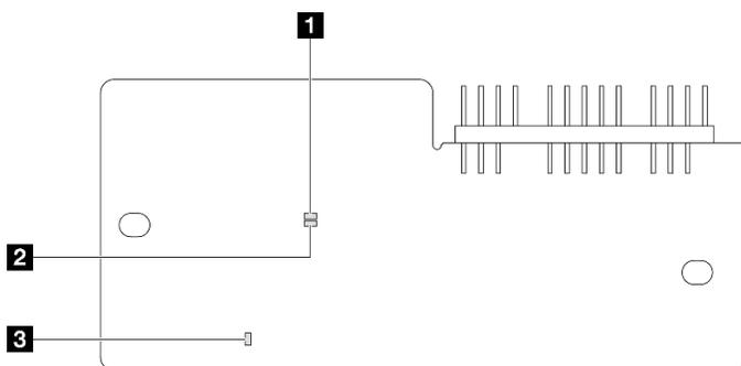
Рис. 159. Светодиодные индикаторы на компоненте «модуль безопасности микропрограммы и RoT»
