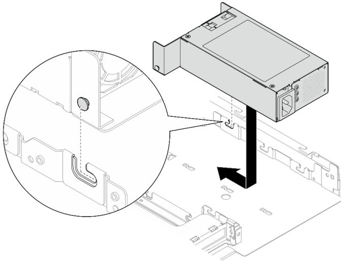
Рис. 78. Установка модуля стационарного блока питания
