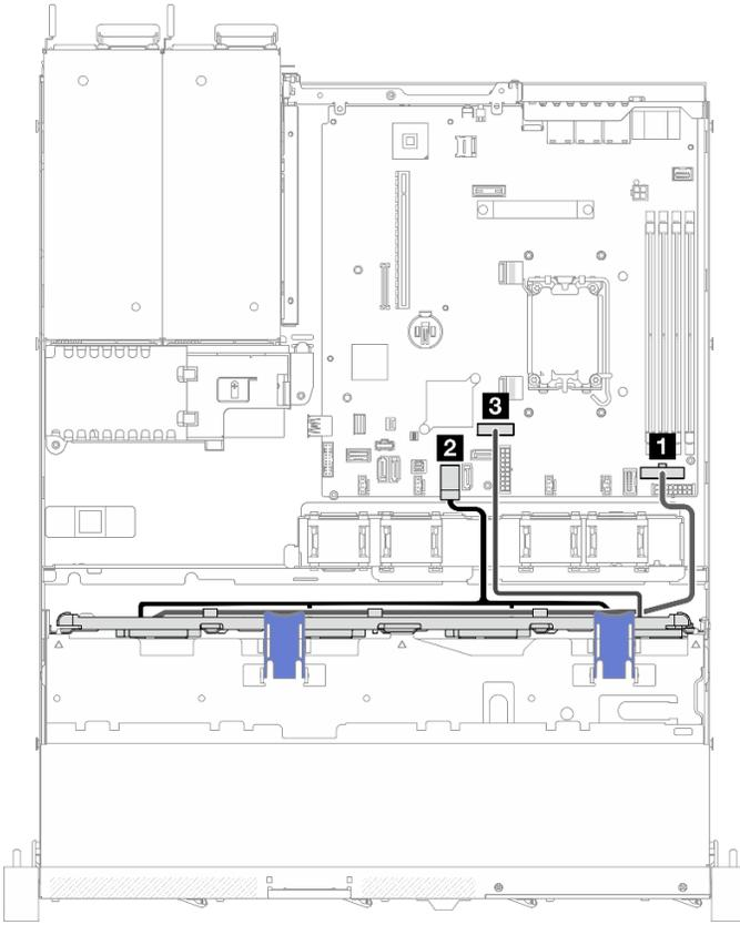
Рис. 140. Два диска SATA и два диска NVMe (программный массив RAID)
