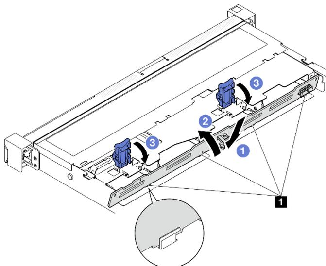
Рис. 11. Установка объединительной панели для 3,5-дюймовых дисков
