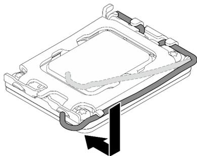
Рис. 96. Закрытие фиксатора процессора
