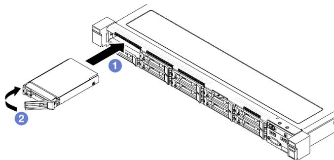
Рис. 28. Установка 2,5-дюймового оперативно заменяемого диска
