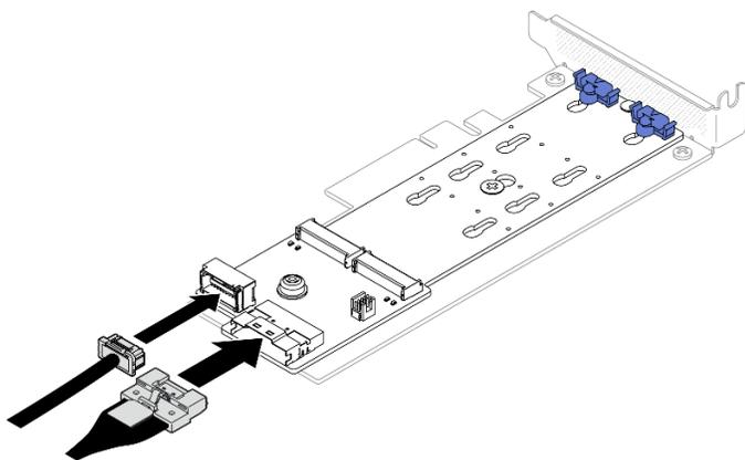
Рис. 57. Подключение кабеля к загрузочному адаптеру SATA/x4 NVMe M.2
