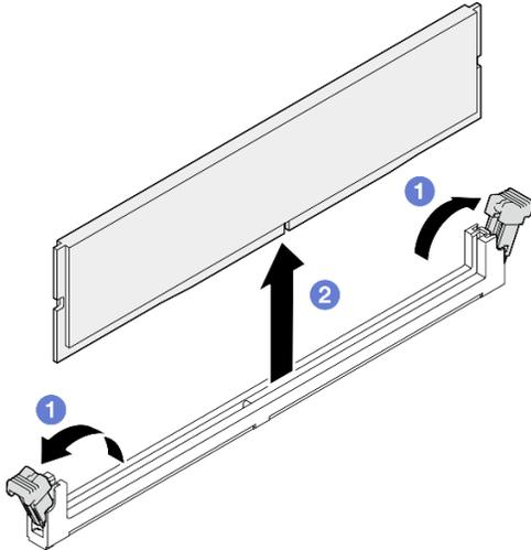
Рис. 62. Снятие модуля памяти
