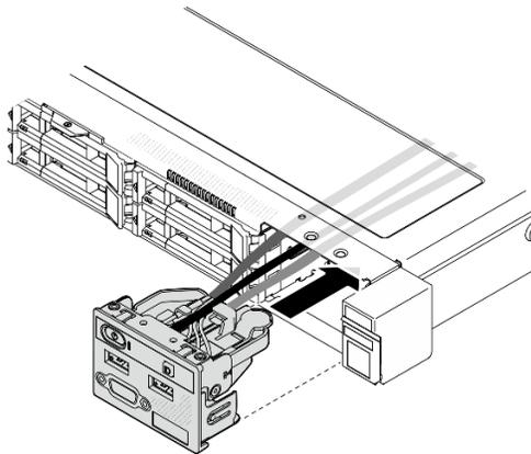
Рис. 36. Установка переднего модуля ввода-вывода (для модели с 2,5-дюймовыми дисками)
