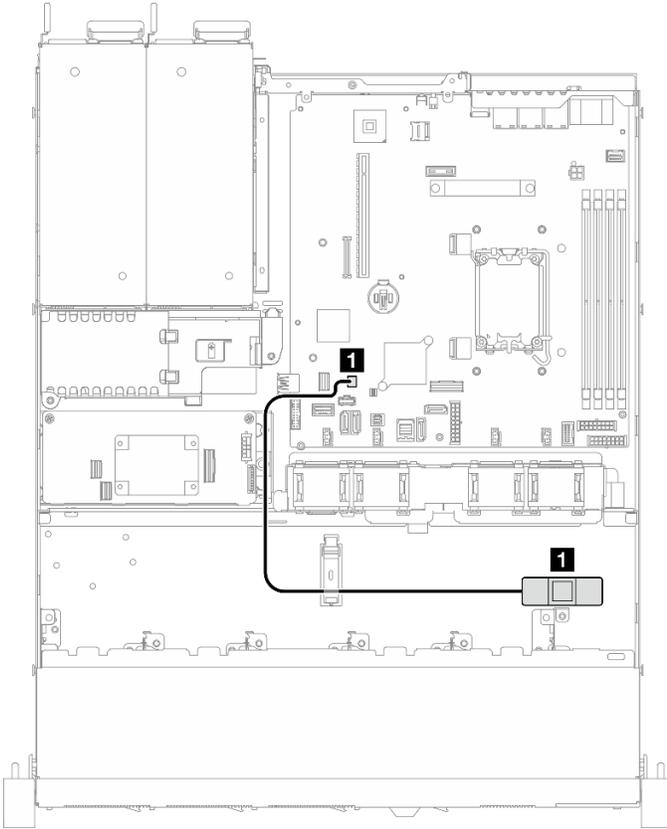
Рис. 136. Прокладка кабелей датчика вмешательства для 2,5-дюймовой модели
