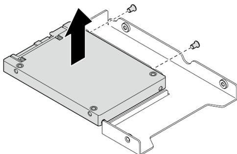
Рис. 7. Снятие 2,5-дюймового диска с адаптера для дисков
