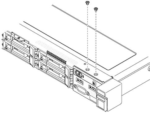
Рис. 34. Снятие винтов переднего модуля ввода-вывода
