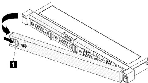
Рис. 105. Снятие защитной панели
