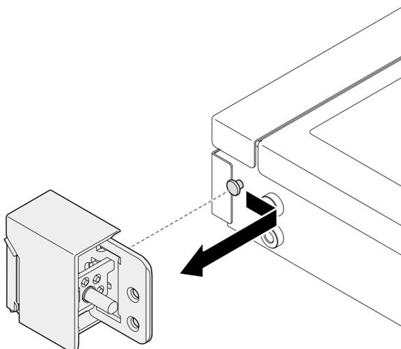
Рис. 100. Снятие защелок стойки
