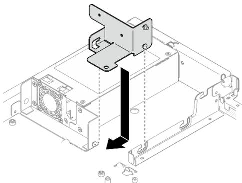
Рис. 81. Установка скобы модуля блока питания
