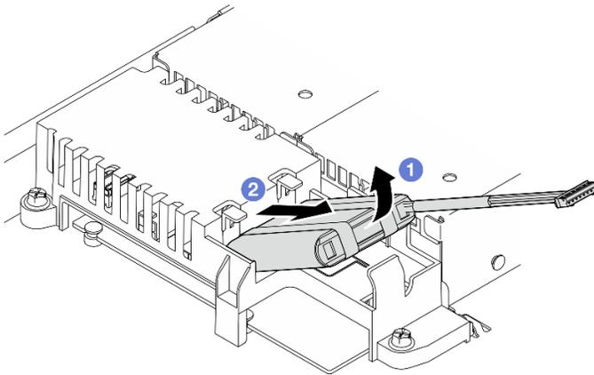
Рис. 32. Снятие модуля питания флэш-памяти
