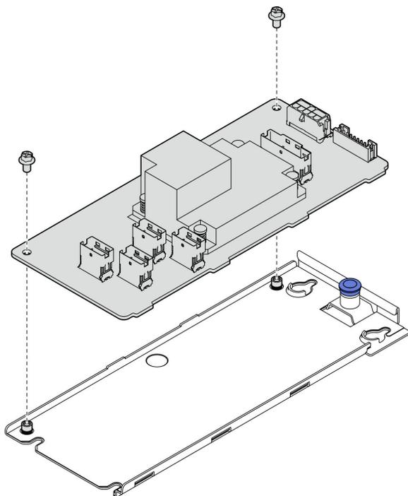
Рис. 17. Снятие лотка внутреннего адаптера CFF
