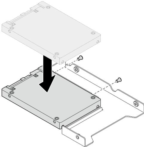
Рис. 8. Установка 2,5-дюймового диска в адаптер для дисков
