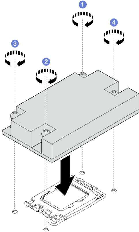
Рис. 43. Установка радиатора
