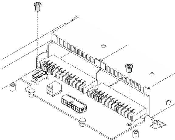
Рис. 88. Снятие винтов с платы распределения питания
