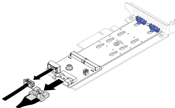
Рис. 51. Отключение кабеля от загрузочного адаптера SATA/x4 NVMe M.2
