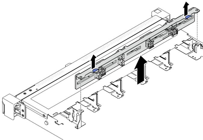
Рис. 2. Снятие объединительной панели с 10 отсеками для 2,5-дюймовых оперативно заменяемых дисков
