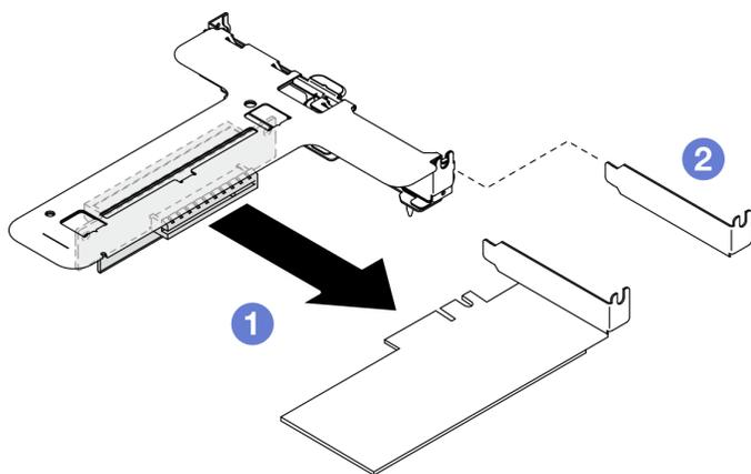
Рис. 67. Снятие адаптера PCIe (гнездо 1)
