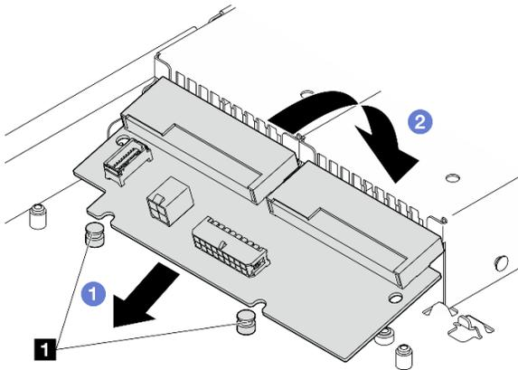
Рис. 90. Установка платы распределения питания
