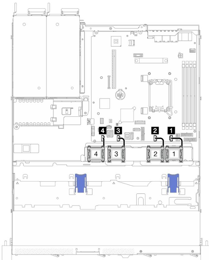
Рис. 131. Прокладка кабелей вентилятора
