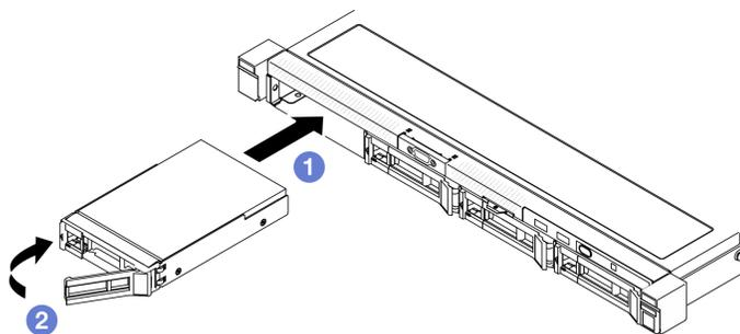
Рис. 29. Установка 3,5-дюймового оперативно заменяемого диска
