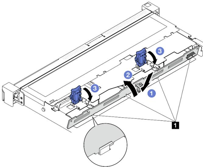
Рис. 13. Установка задней панели
