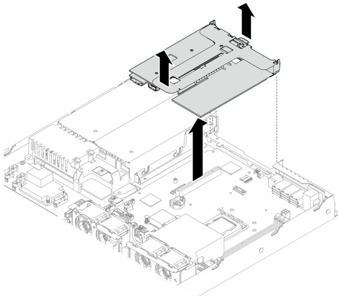
Рис. 65. Снятие блока платы-адаптера Riser PCIe
