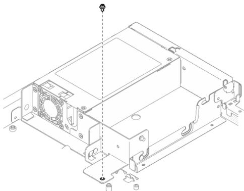
Рис. 82. Установка винта скобы модуля блока питания
