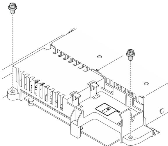
Рис. 93. Установка винтов кожуха платы распределения питания
