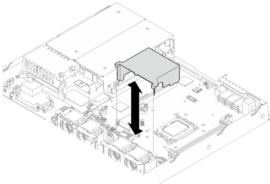
Рис. 15. Установка дефлектора
