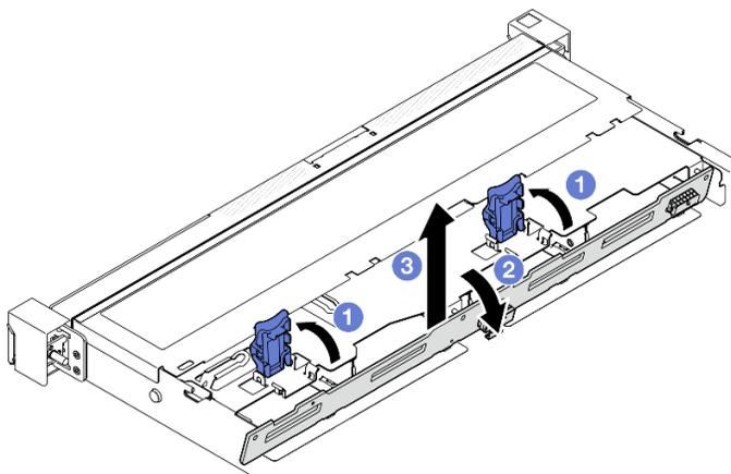
Рис. 10. Снятие объединительной панели для 3,5-дюймовых дисков
