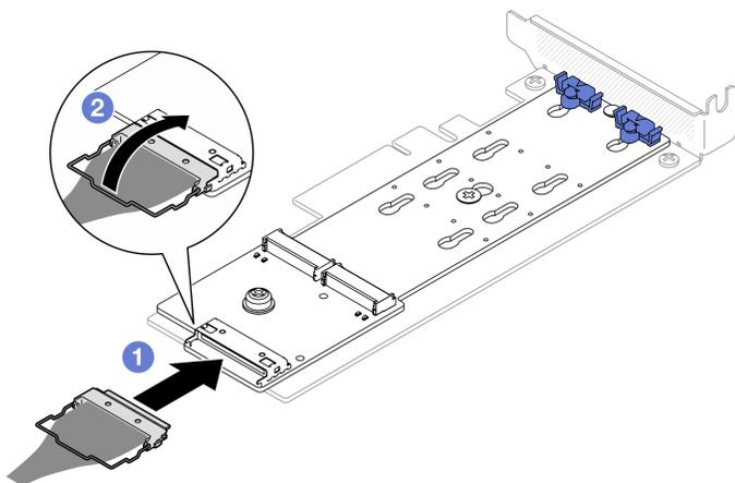
Рис. 58. Подключение кабеля к загрузочному адаптеру SATA/NVMe M.2
