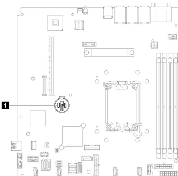
Рис. 22. Расположение батарейки CMOS
