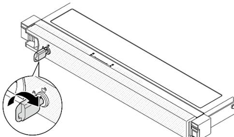
Рис. 104. Разблокирование защитной панели
