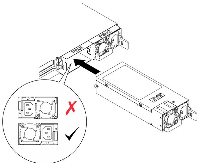
Рис. 85. Установка модуля оперативно заменяемого блока питания
