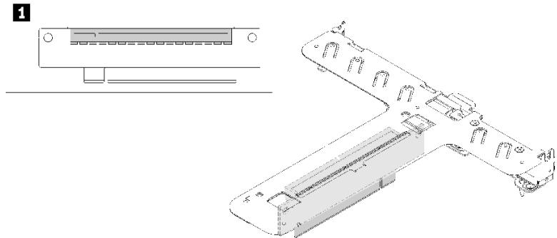
그림 21. x16 PCIe 라이저 어셈블리
