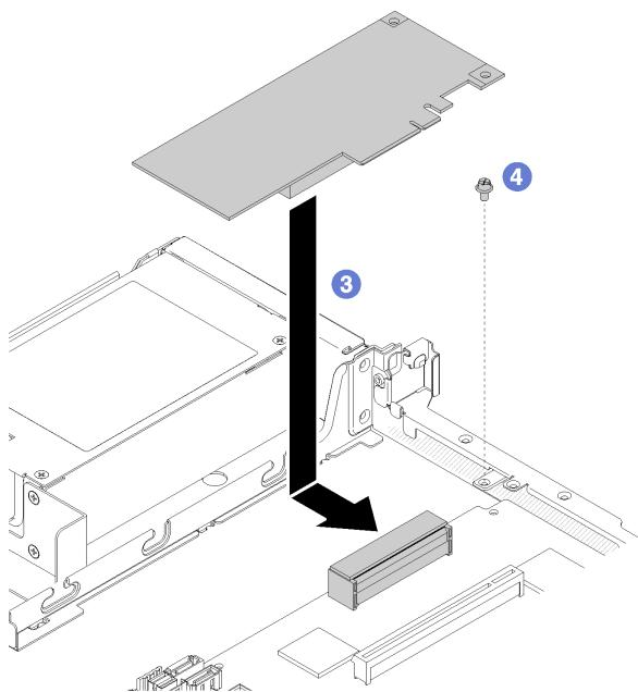
**그림 47. RAID 어댑터 설치**
