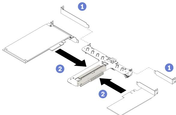
**그림 48. 어댑터 설치**
