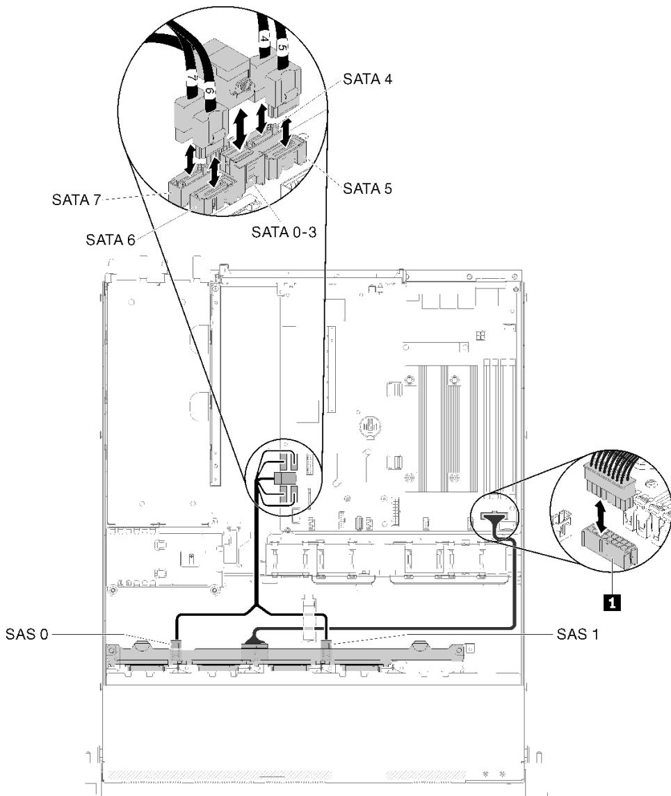
**그림 33. 소프트웨어 RAID가 있는 8개의 2.5인치 핫 스왑 드라이브 모델**
