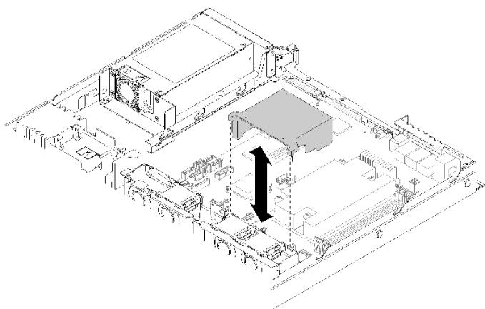
**그림 68. 공기 조절 장치 설치**
