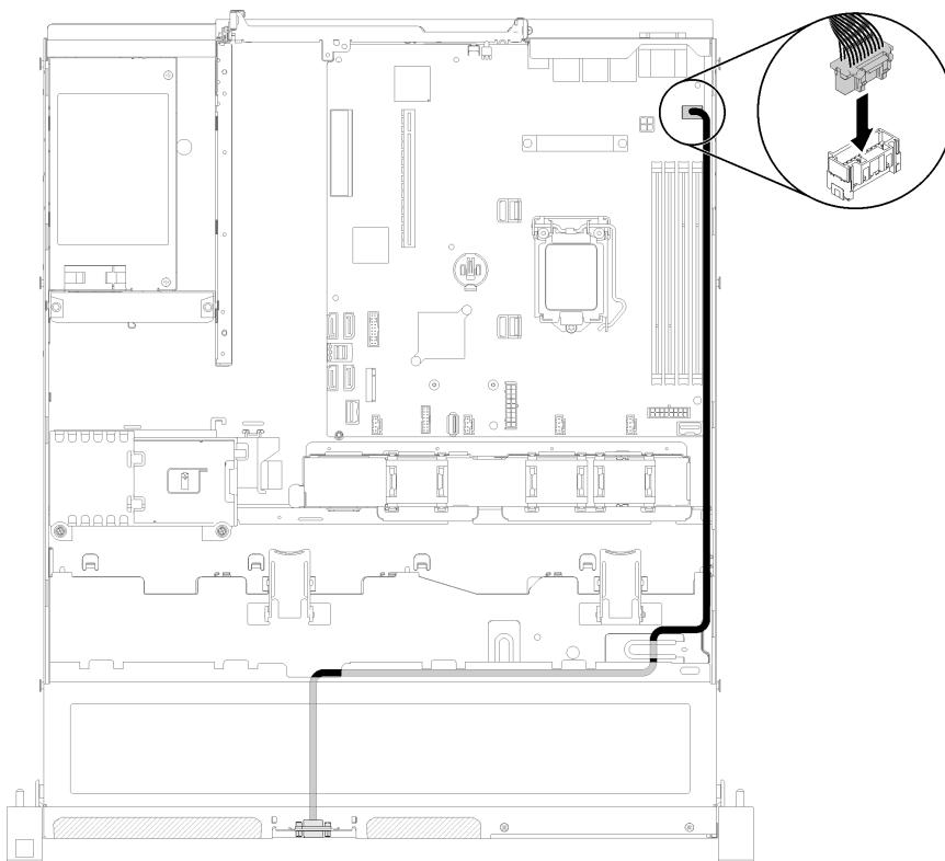
그림 66. VGA 케이블 설치
