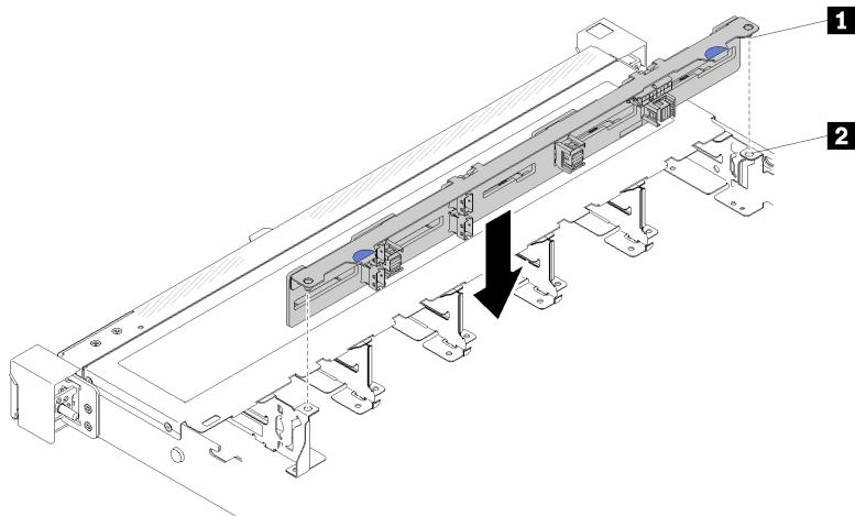
그림 59. 2.5인치 핫 스왑 드라이브 백플레인 설치
