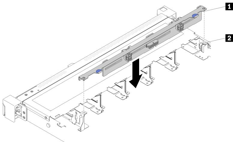
그림 60. 3.5인치 핫 스왑 드라이브 백플레인 설치
