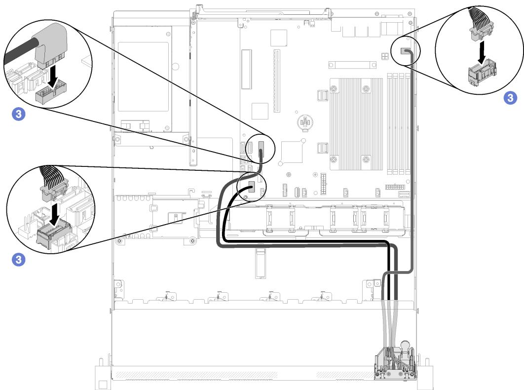
**그림 63. 앞면 오퍼레이터 패널(2.5인치 HDD 모델) 케이블 배선**
