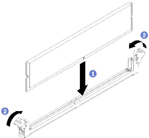
**그림 57. DIMM 설치**
