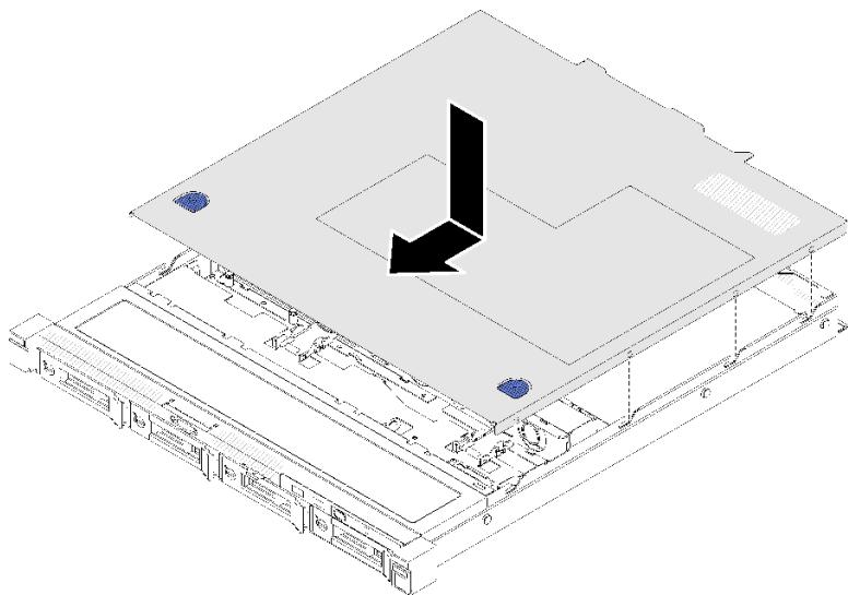
**그림 69. 윗면 덮개 설치**
