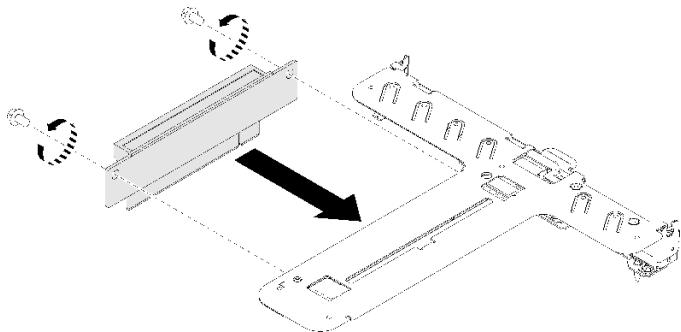
그림 49. PCIe 라이저 카드 설치
