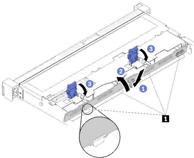
**그림 58. 백플레이트 설치**
