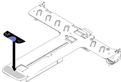
그림 50. PCIe 라이저 어셈블리 설치
