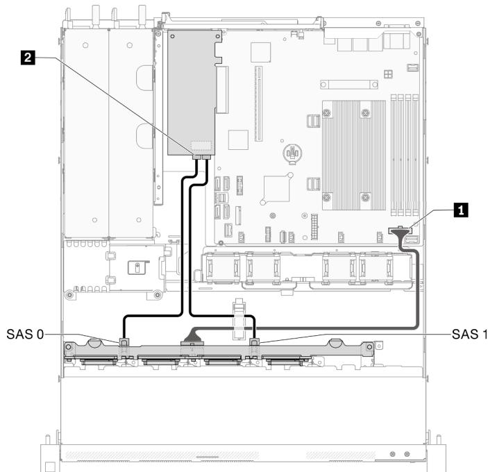
**그림 34. 하드웨어 RAID가 있는 8개의 2.5인치 핫 스왑 드라이브 모델**
