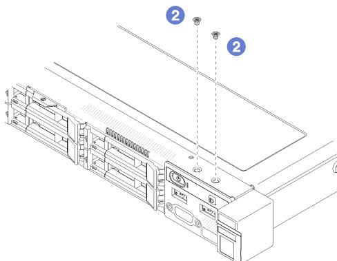
**그림 62. 나사 설치**
