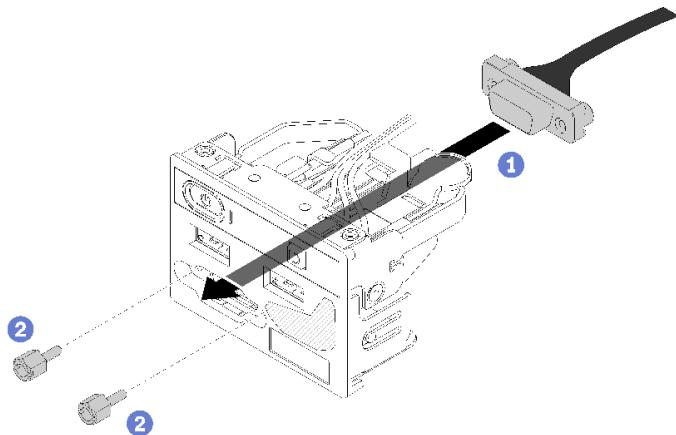
그림 64. VGA 케이블 설치
