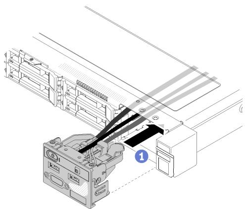
**그림 61. 앞면 오퍼레이터 패널(2.5인치 HDD 모델) 설치**
