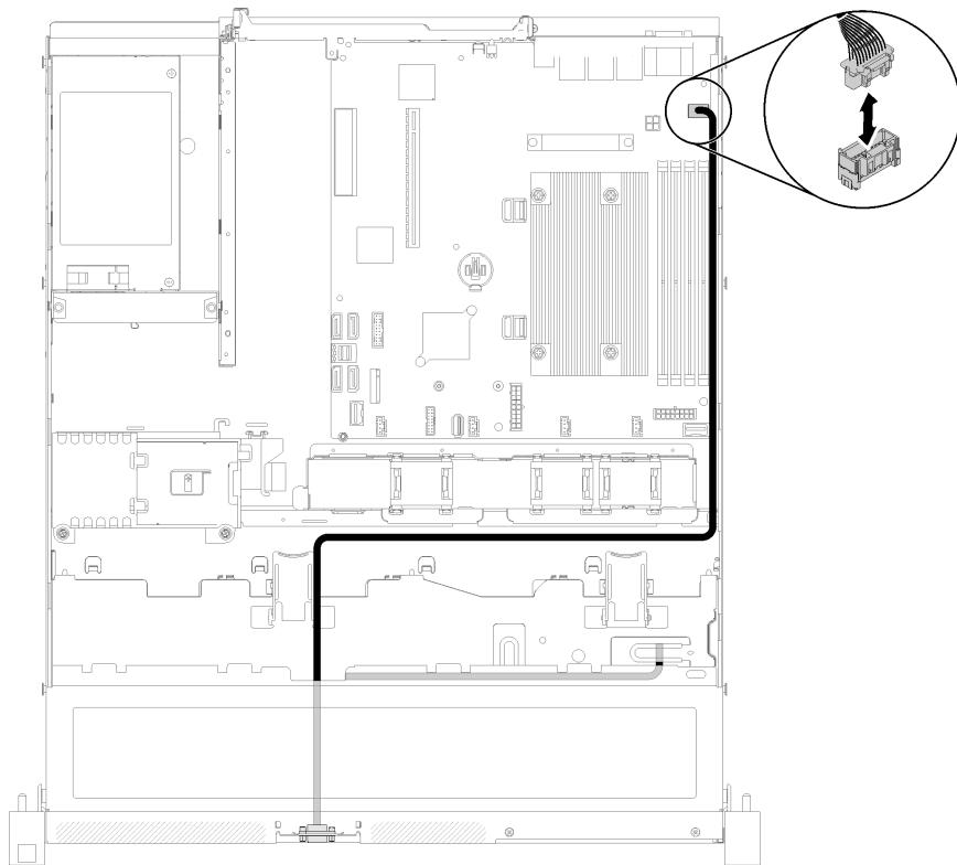
그림 23. 4개의 드라이브가 있는 앞면 VGA 케이블 배선
