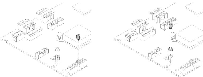
**그림 53. 80mm/42mm M.2 드라이브의 육각 나사 위치**
