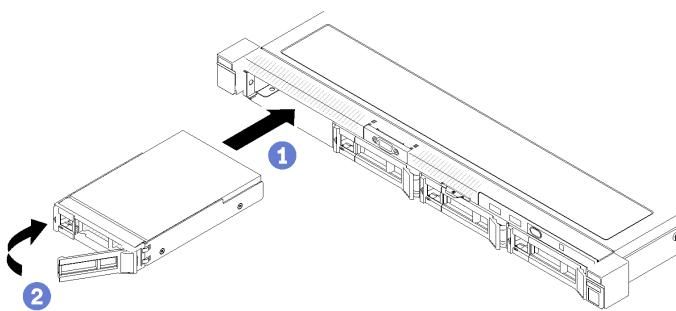
**그림 73. 3.5인치 핫 스왑 드라이브 설치**
