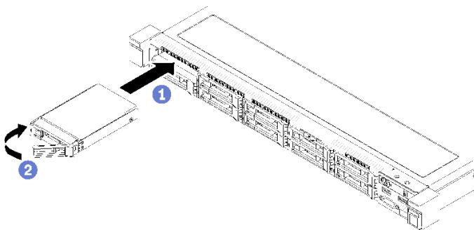
**그림 72. 2.5인치 핫 스왑 드라이브 설치**
