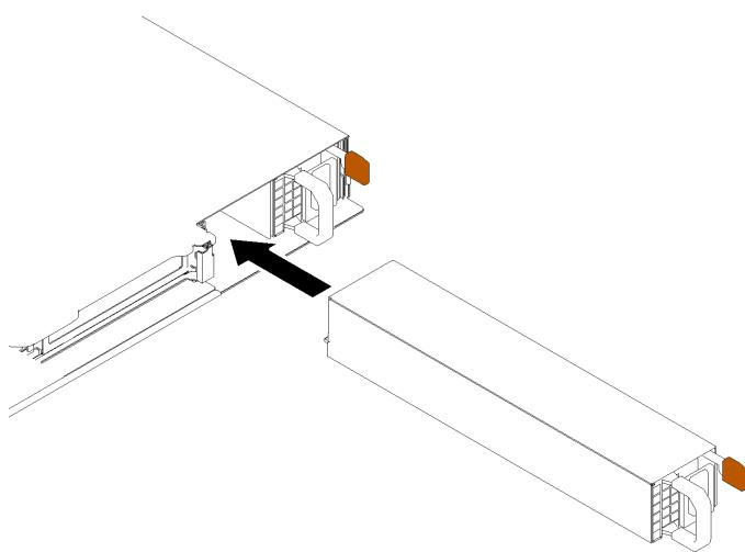
**그림 70. 핫 스왑 전원 공급 장치 설치**
