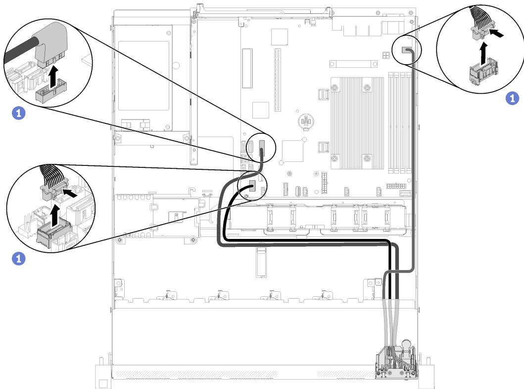
**그림 42. 앞면 오퍼레이터 패널(2.5인치 HDD 모델) 케이블 제거**
