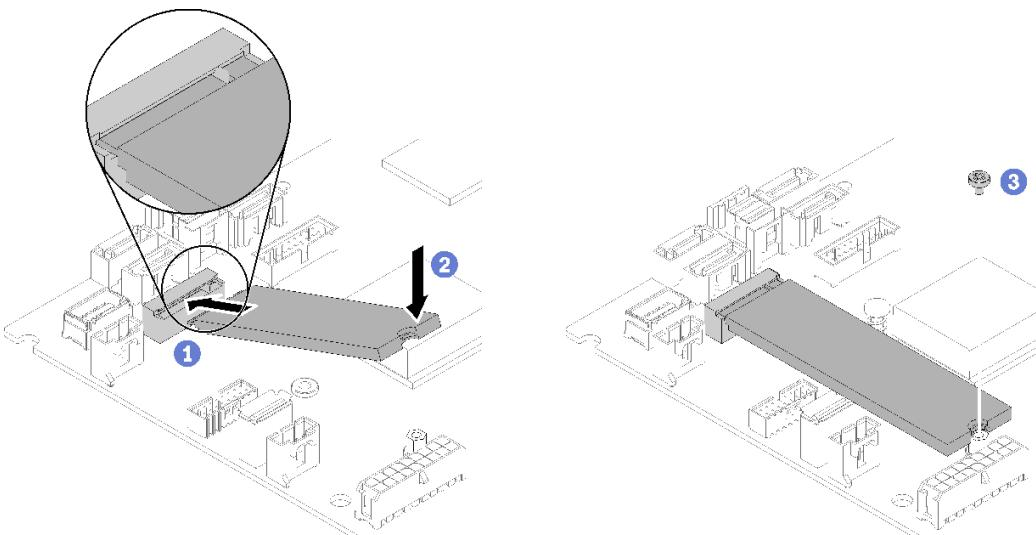
**그림 54. M.2 드라이브 설치**
