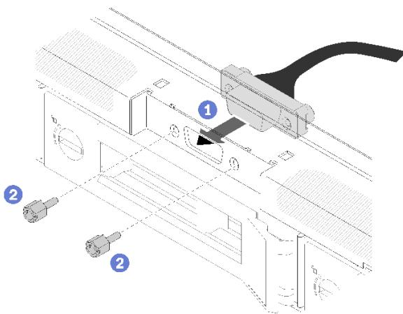
그림 65. VGA 케이블 설치
