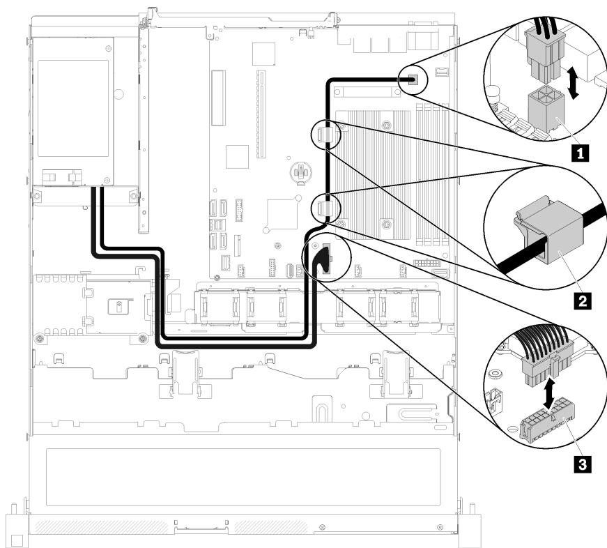
그림 26. 고정 전원 공급 장치 케이블 배선
