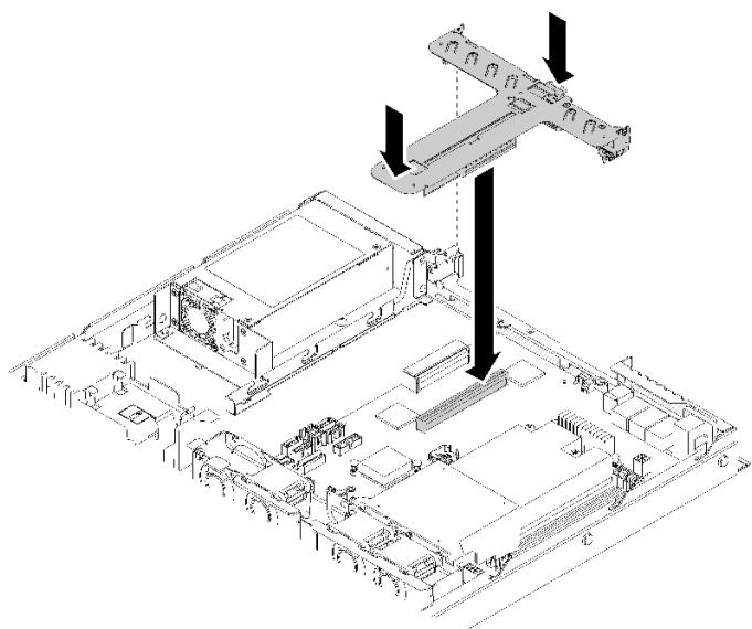
그림 51. PCIe 라이저 어셈블리 설치
