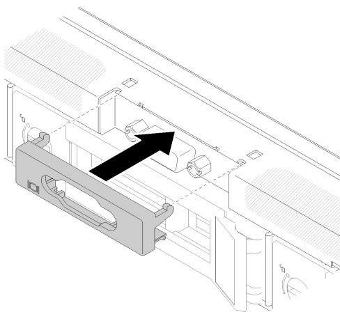
그림 67. VGA 케이블 설치
