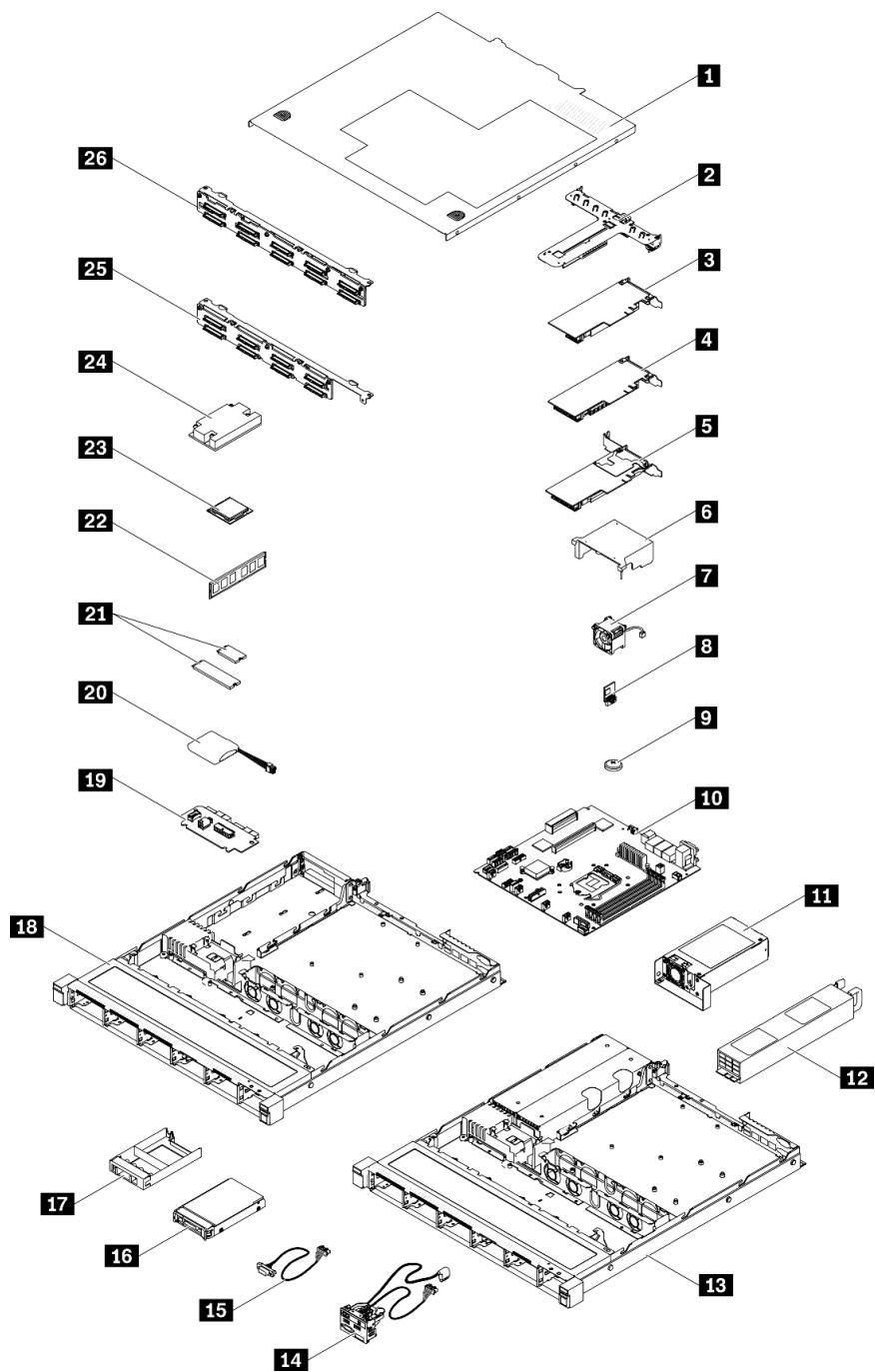
그림 37. 서버 구성 요소 - 2.5인치 드라이브 모델
