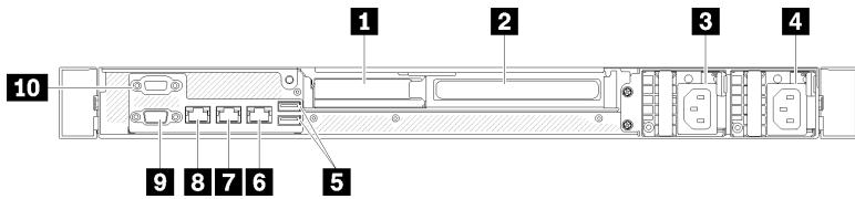
**그림 12. 뒷면 보기 - 중복 전원 공급 장치 모델**
