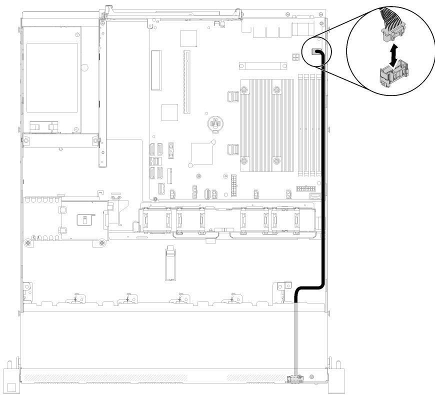
그림 24. 10개의 드라이브가 있는 앞면 VGA 케이블 배선
