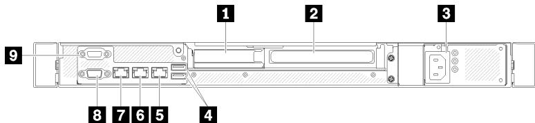
**그림 11. 뒷면 보기 - 비중복 전원 공급 장치 모델**
