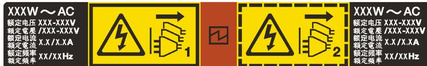
Abbildung 38. Hot-Swap-Netzteil-Etikett auf der Abdeckung
