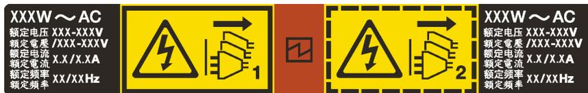
Figura 63. Etiqueta de la fuente de alimentación de intercambio en caliente en la cubierta
