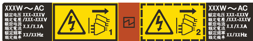
図 63. カバー上のホット・スワップ・パワー・サプライのラベル
