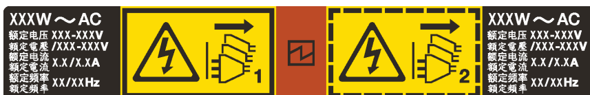
図 66. カバー上のホット・スワップ・パワー・サプライのラベル
