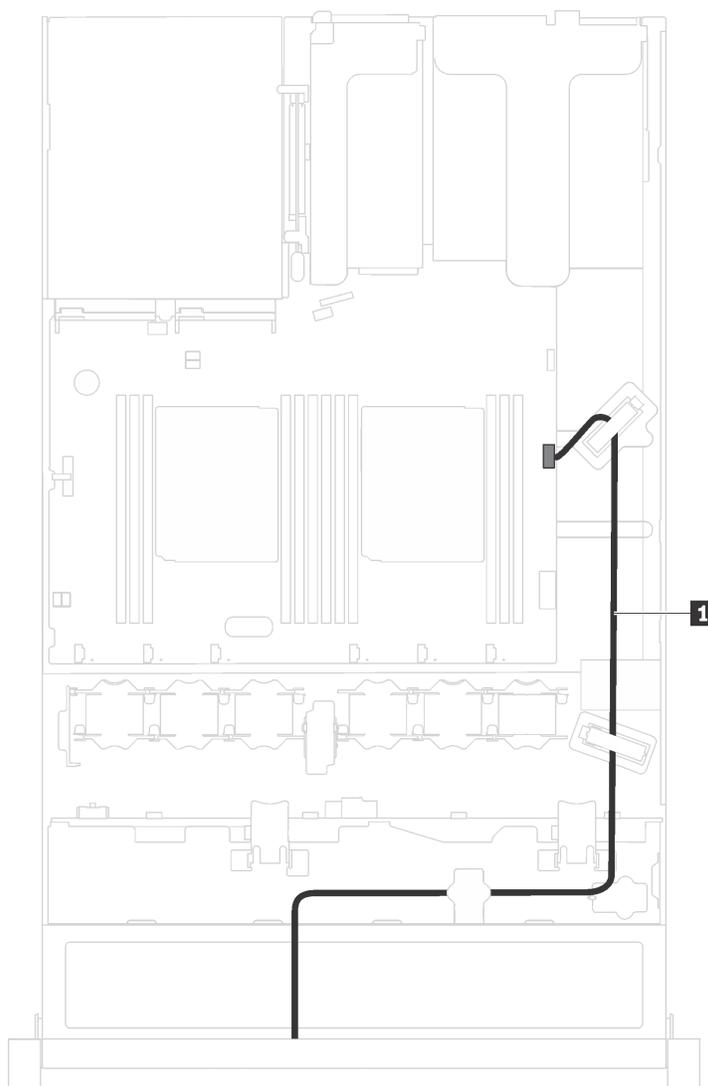
図 11. VGA コネクターのケーブル配線
