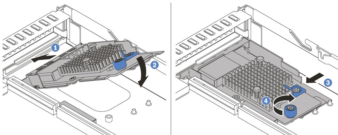
図 37. LOM アダプターの取り付け
