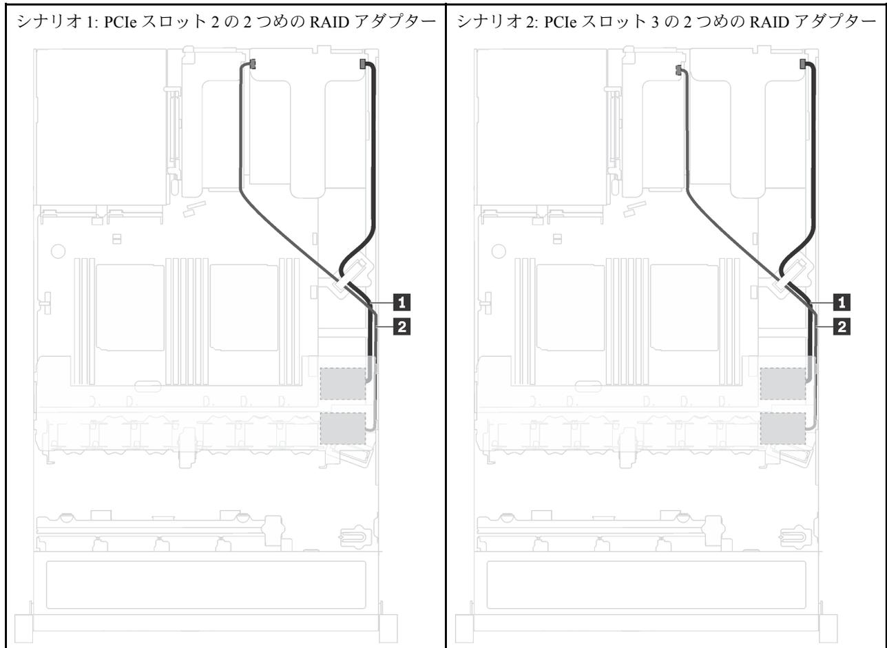
**1** RAID 超コンデンサー・モジュール 1 のケーブル配線 **2** RAID 超コンデンサー・モジュール 2 のケーブル配線
