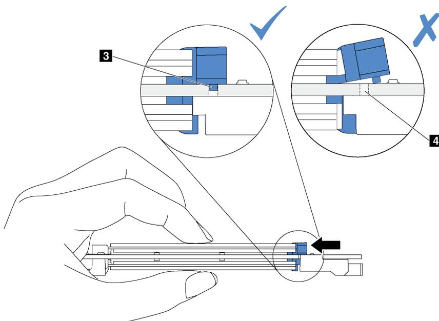
ステップ4. M.2 バックプレーン両端の青いプラスチック製サポート器具を、システム・ボードのガイド・ピンと位置合わせします。次に、M.2 バックプレーンをシステム・ボードの M.2 スロットに挿入し、押し下げて完全に差し込みます。
