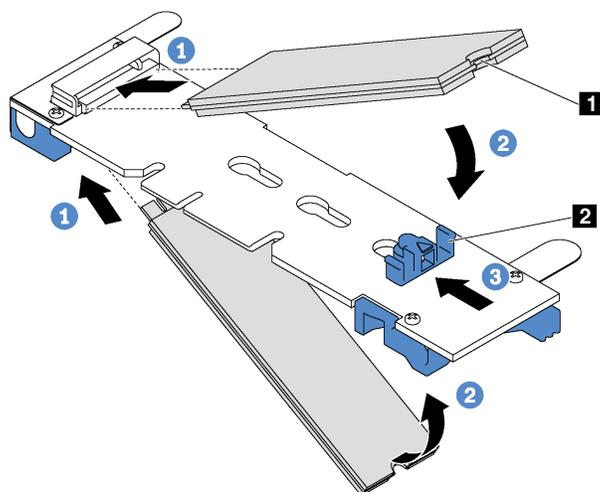
図 32. M.2 ドライブの取り付け
