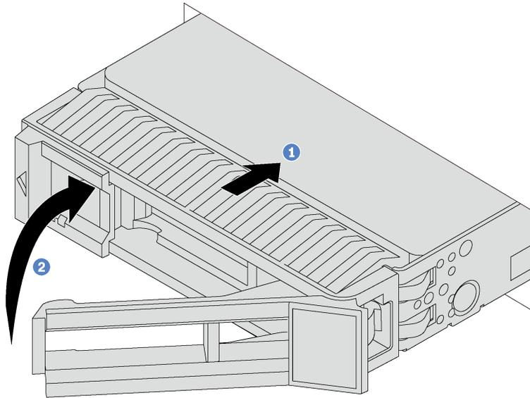
図44. ホット・スワップ・ドライブの取り付け
