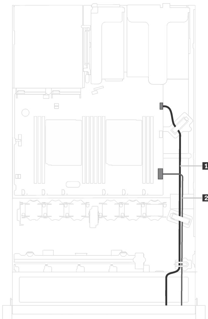
図 13. 前面 I/O 部品のケーブル配線
