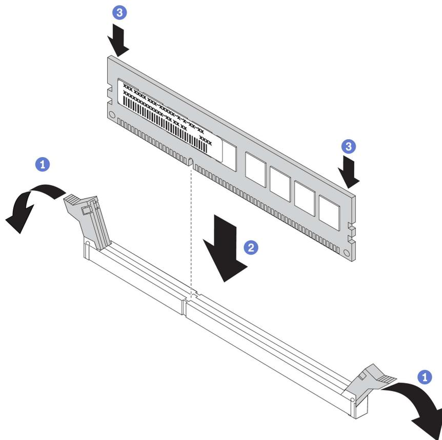
図 24. メモリー・モジュールの取り付け
