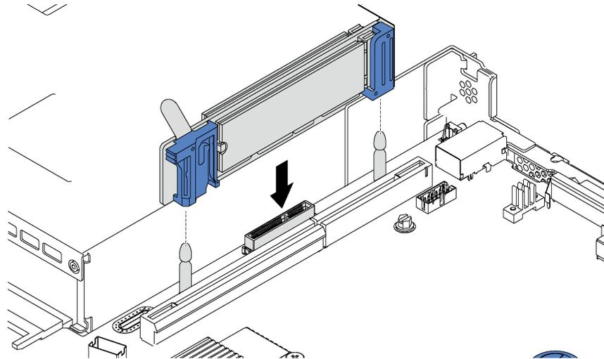
図33. M.2 バックプレーンの取り付け
