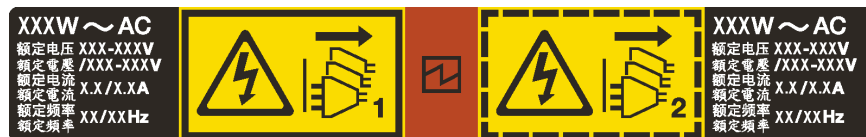
Рис. 63. Этикетка оперативно заменяемого блока питания на крышке
