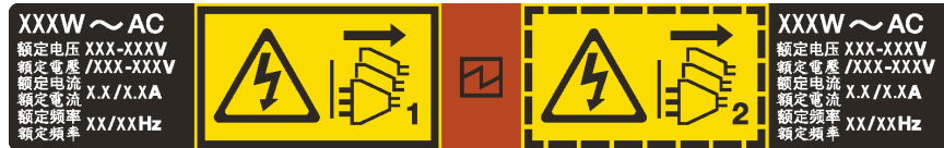
Figure 49. Étiquette du bloc d'alimentation remplaçable à chaud sur le carter
