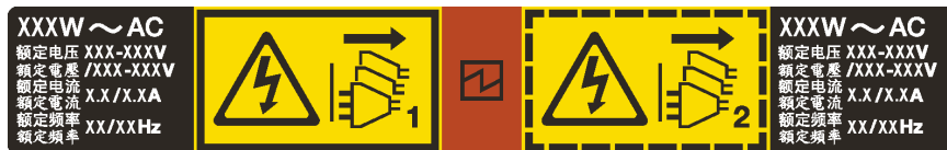
Figura 70. Etichetta dell'alimentatore hot-swap sul coperchio
