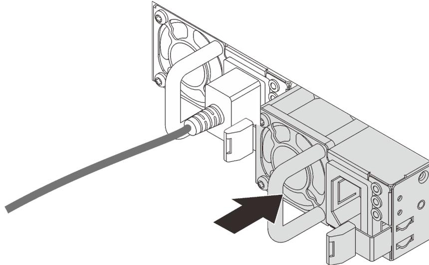
Figura 51. Installazione di un alimentatore hot-swap
