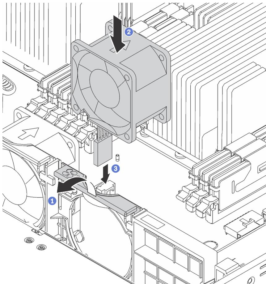
Figura 38. Installazione della ventola di sistema
