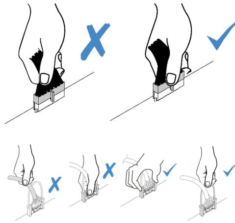
Alcune opzioni, come gli adattatori RAID, potrebbero richiedere un cablaggio interno aggiuntivo. Vedere la documentazione fornita per determinare i requisiti e le istruzioni di cablaggio aggiuntivi.
