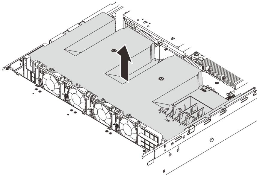
Figura 30. Rimozione del deflettore d'aria
