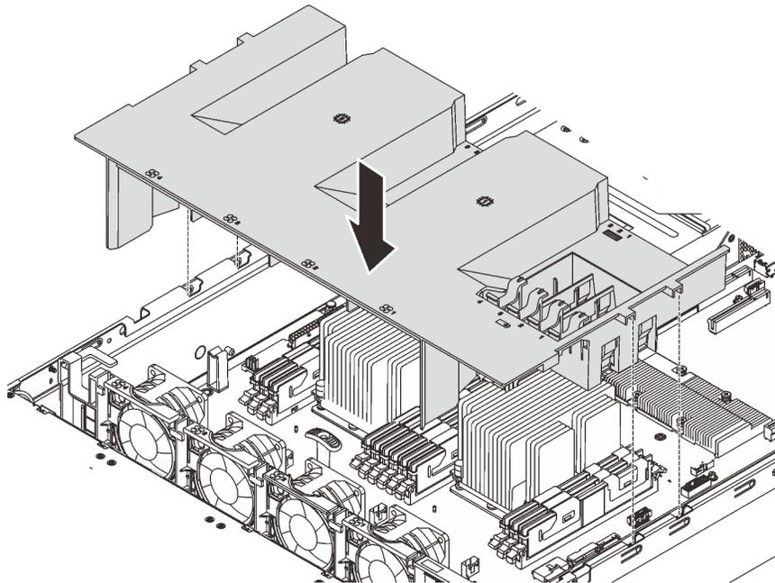
Figura 52. Installazione del deflettore d'aria
