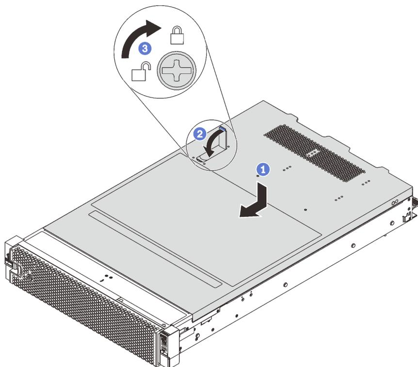
Figura 55. Installazione del coperchio superiore
