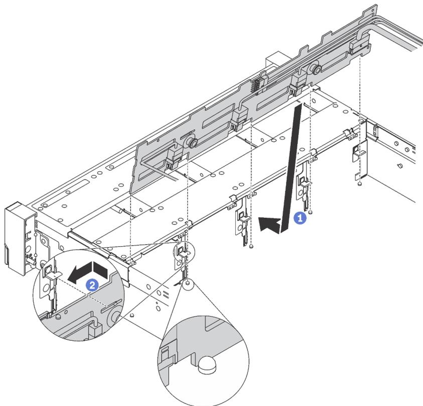
Figura 36. Installazione del backplane dell'unità da 3,5"
