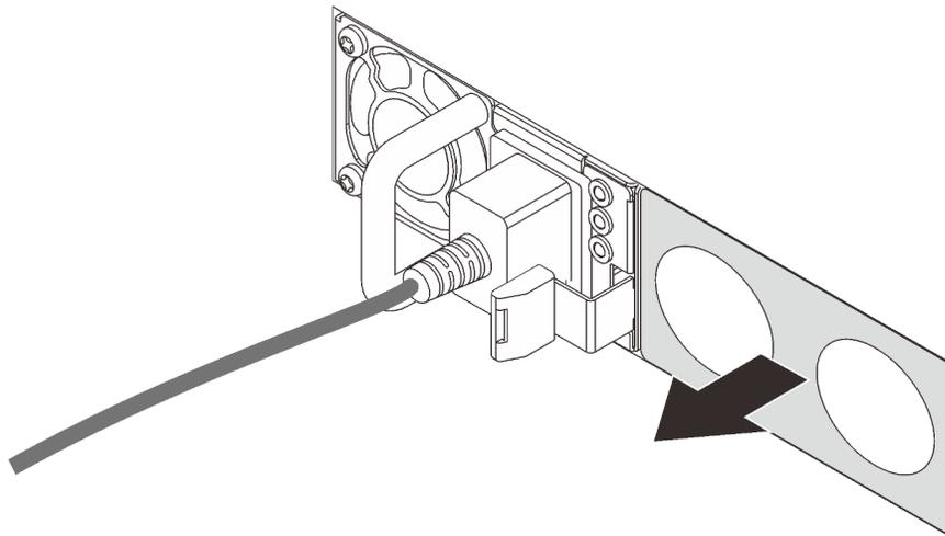
*Figura 50. Rimozione dell'elemento di riempimento dell'alimentatore hot-swap*
