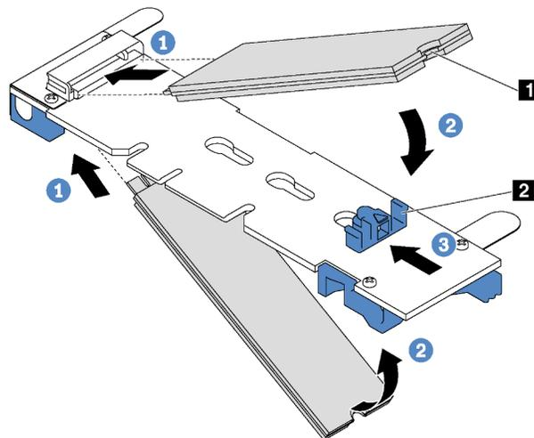
Figura 45. Installazione di un'unità M.2
