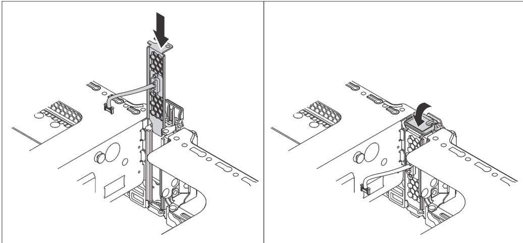
Figura 39. Installazione del modulo della porta seriale
