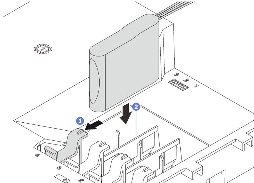
Figura 53. Installazione del modulo a supercondensatore RAID
