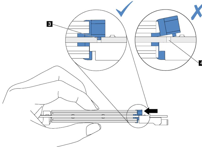
Passo 4. Allineare i supporti in plastica blu a ogni estremità del backplane M.2 con i piedini guida sulla scheda di sistema. Inserire quindi il backplane M.2 nello slot M.2 sulla scheda di sistema e premere verso il basso fino a portarlo in posizione.
