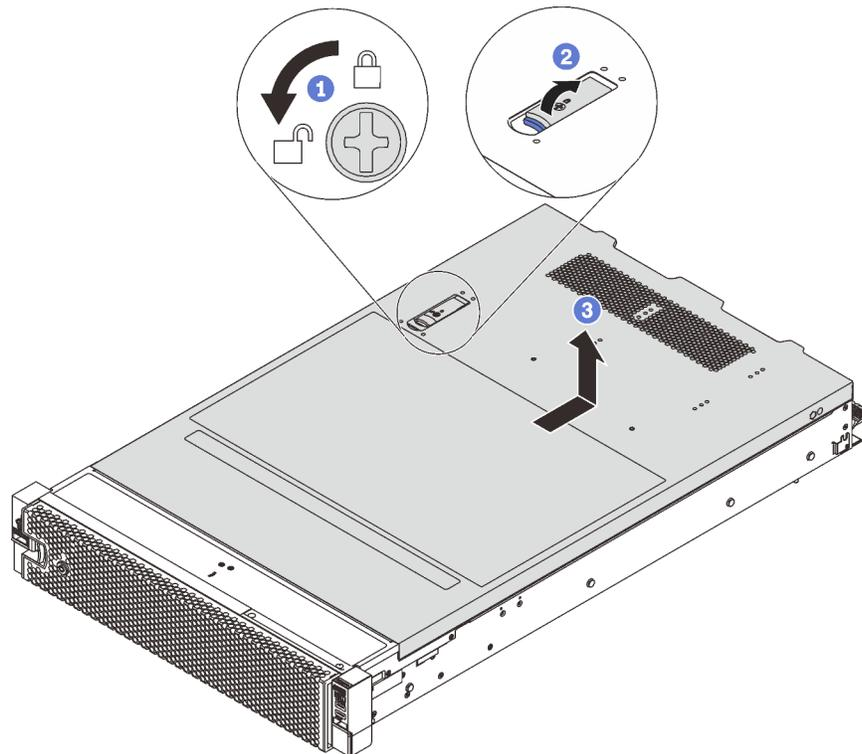
Figura 29. Rimozione del coperchio superiore
