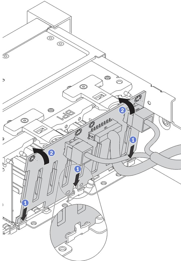
Figura 34. Installazione del backplane dell'unità da 2,5"
