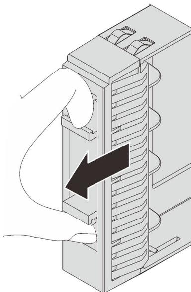
Figura 56. Rimozione dell'elemento di riempimento dell'unità da 2,5"
