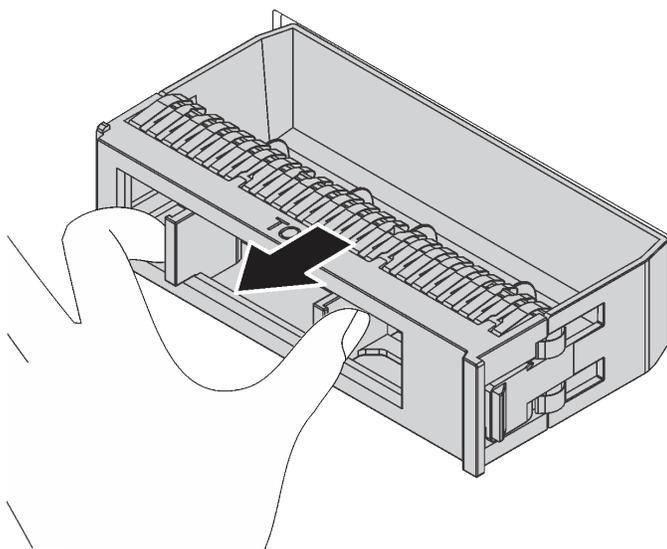
Figura 57. Rimozione dell'elemento di riempimento dell'unità da 3,5"
