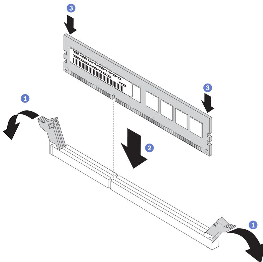
Figura 32. Installazione del modulo di memoria
