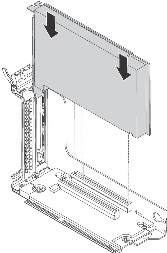
Figura 41. Installazione di un adattatore PCIe sull'assieme verticale
