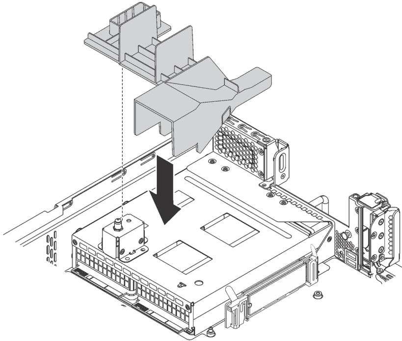
Figura 47. Installazione del deflettore d'aria dell'unità M.2
