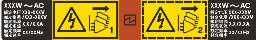
그림 49. 덮개에 있는 핫 스왑 전원 공급 장치 레이블
