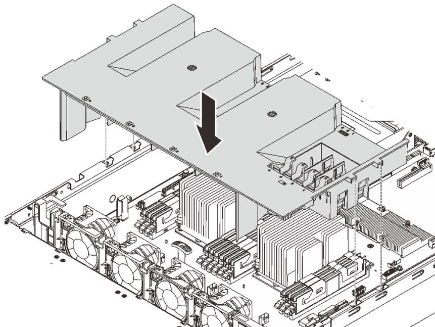
圖例 52. 安裝空氣擋板
