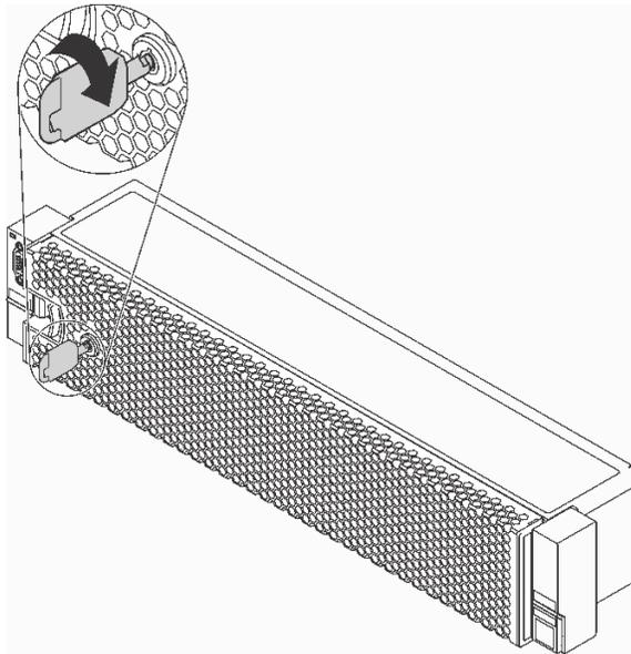
圖例 27. 解鎖安全擋板
