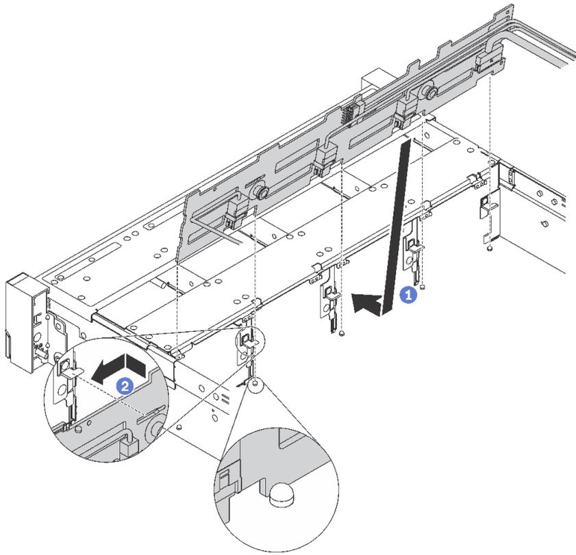
圖例 36. 3.5 吋硬碟背板安裝
