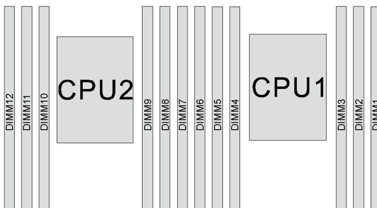
圖例 33. 主機板上的記憶體模組插槽
