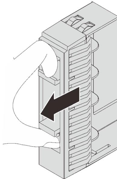
圖例 56. 卸下 2.5 吋硬碟填充板
