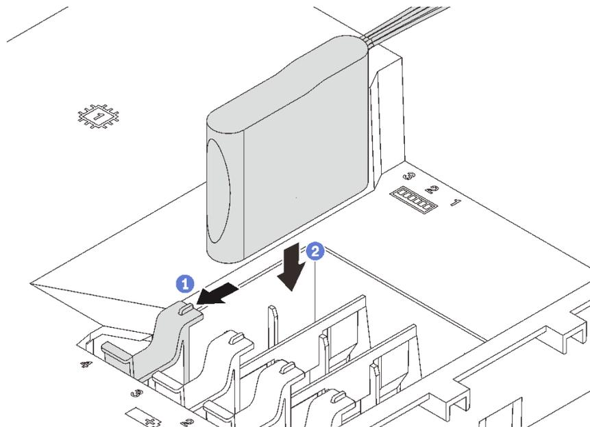
圖例 53. RAID 超級電容器模組安裝
