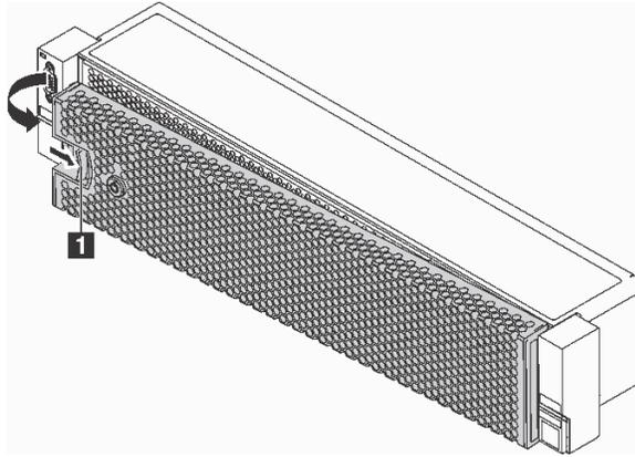
圖例 28. 卸下安全擋板
