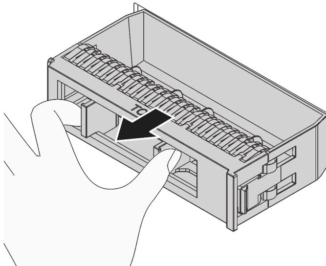
圖例 57. 卸下 3.5 吋硬碟填充板
