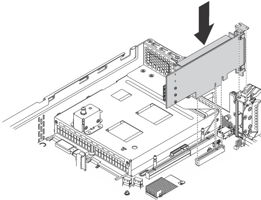
圖例 43. 將 PCIe 配接卡安裝在主機板上
