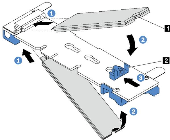
圖例 45. M.2 硬碟安裝
