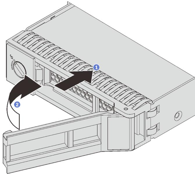
圖例 61. 簡易抽換硬碟安裝
