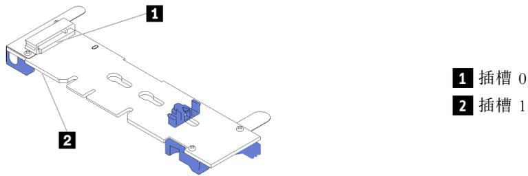
圖例 44. M.2 硬碟插槽
