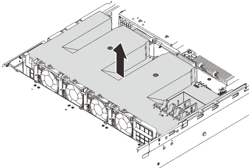
圖例 30. 卸下空氣擋板
