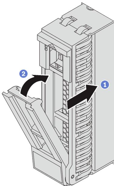
圖例 58. 安裝 2.5 吋熱抽換硬碟
