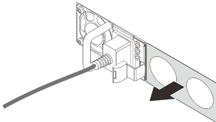
圖例 50. 卸下熱抽換電源供應器填充板
