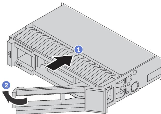
圖例 59. 安裝 3.5 吋熱抽換硬碟
