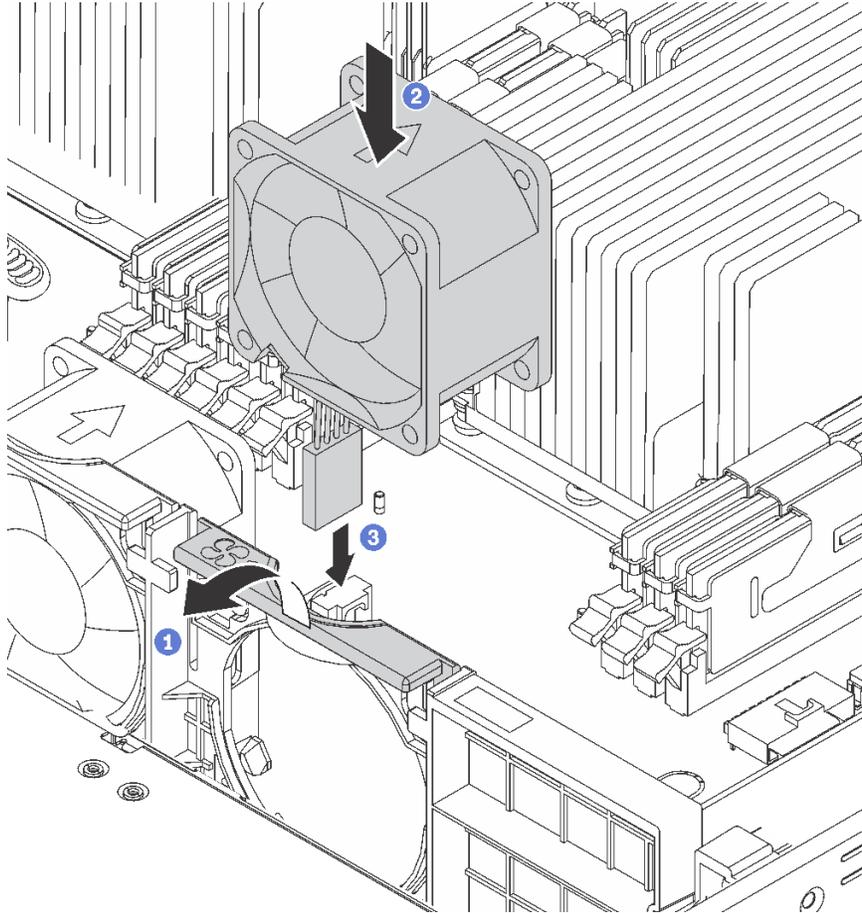
**圖例 38. 安裝系統風扇**
