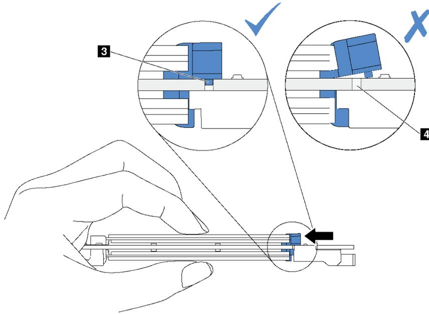
步驟 4. 將 M.2 背板兩端的藍色塑膠支撐裝置對齊主機板上的導件插腳。然後將 M.2 背板插入主機板上的 M.2 插槽，並向下按壓，使其完全裝妥。
