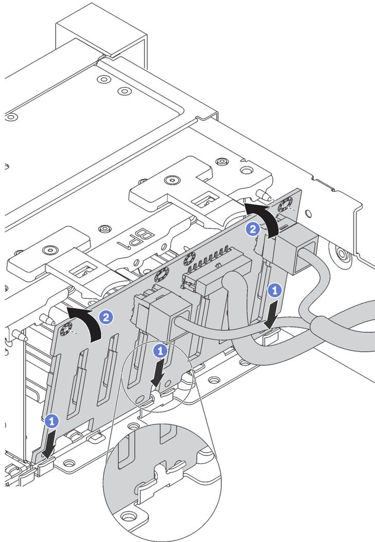
圖例 34. 2.5 吋硬碟背板安裝
