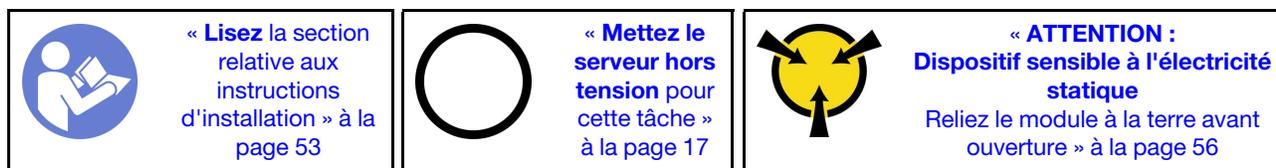
Avant d'installer le bloc d'E-S avant, mettez l'emballage antistatique contenant le nouveau bloc d'E-S avant en contact avec une surface non peinte du serveur. Ensuite, déballez le nouveau bloc d'E-S avant et posez-le sur une surface antistatique.
