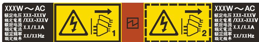
Рис. 97. Этикетка оперативно заменяемого блока питания на крышке
