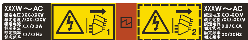
Рис. 100. Этикетка оперативно заменяемого блока питания на крышке
