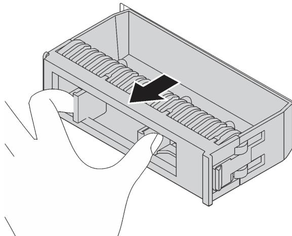
圖例 52. 卸下硬碟填充板
