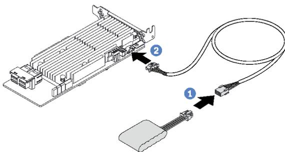
圖例 12. 將 RAID 超級電容器模組連接至 RAID 配接卡
