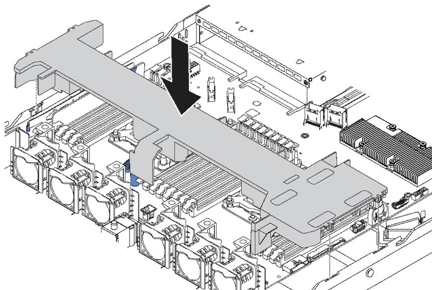
圖例 49. 安裝空氣擋板
