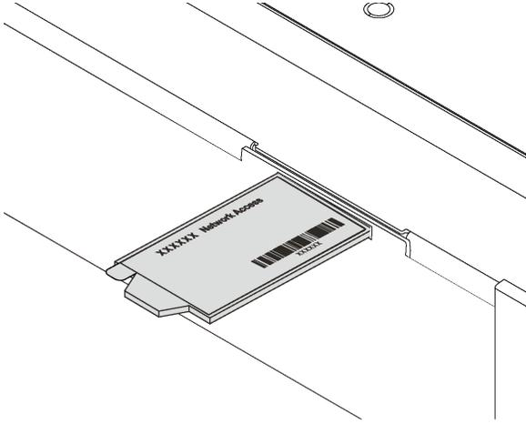
圖例 2. XClarity Controller 網路存取標籤的位置
