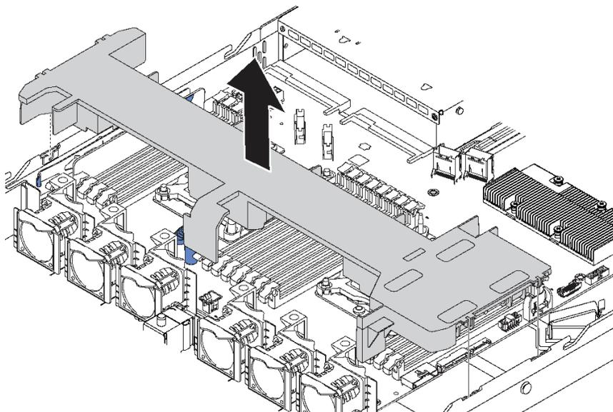
圖例 27. 卸下空氣擋板
