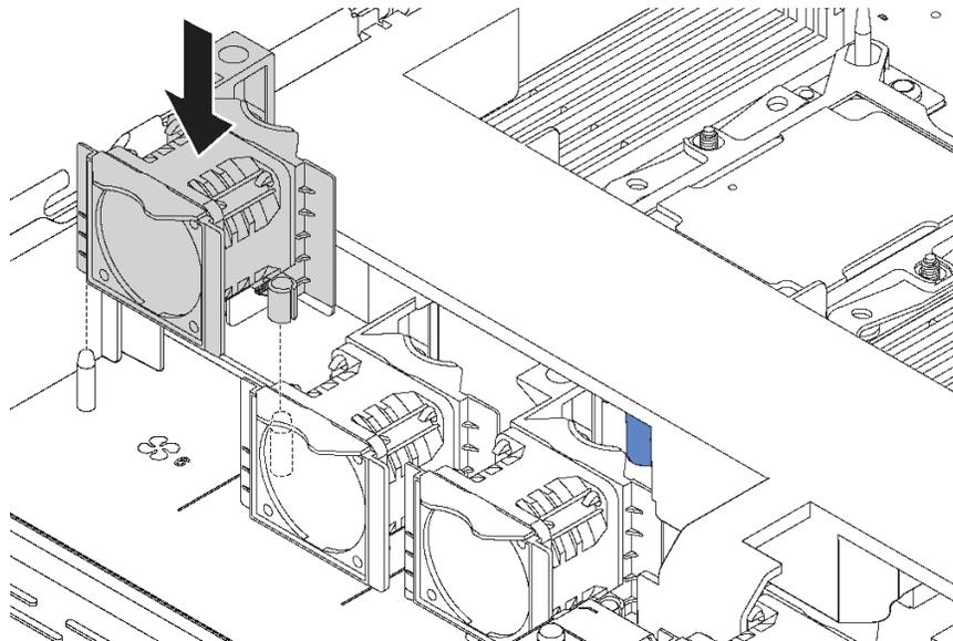
圖例 29. 安裝系統風扇
