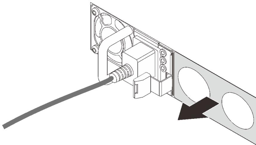
圖例 38. 卸下熱抽換電源供應器填充板
