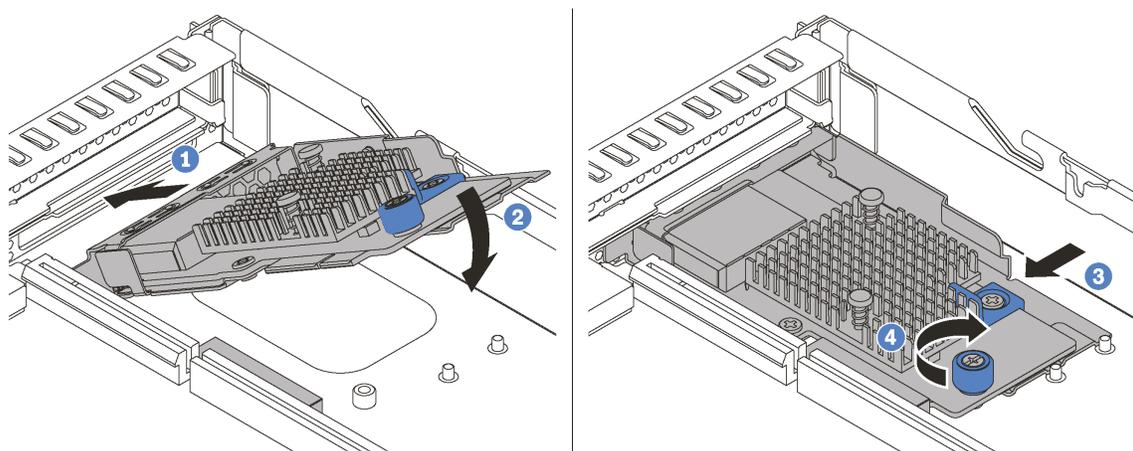
圖例 40. 安裝 LOM 配接卡
