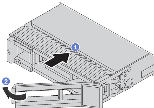
**圖例 53. 熱抽換硬碟安裝**
