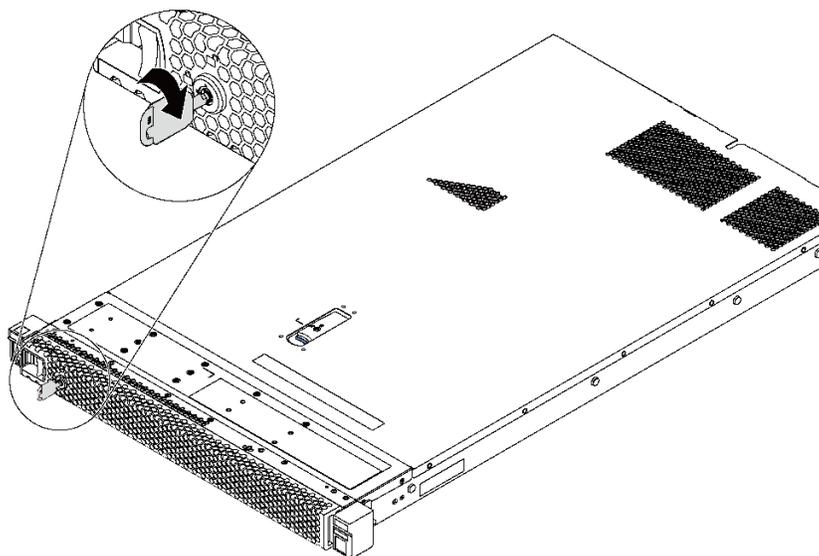
圖例 24. 安全擋板解除鎖定
