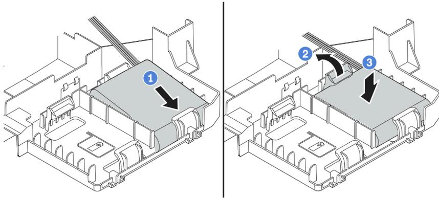
圖例 48. RAID 超級電容器模組的安裝
