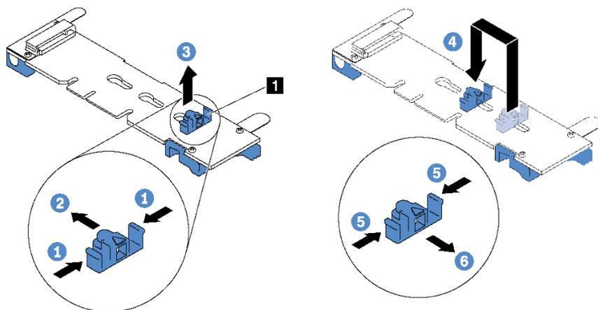
圖例 36. 調整 M.2 固定器
