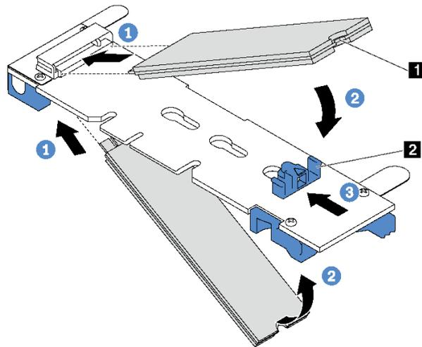
圖例 33. M.2 硬碟安裝
