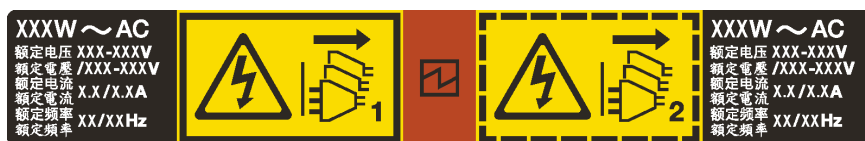
Figure 111. Etiquette du bloc d'alimentation remplaçable à chaud sur le carter
